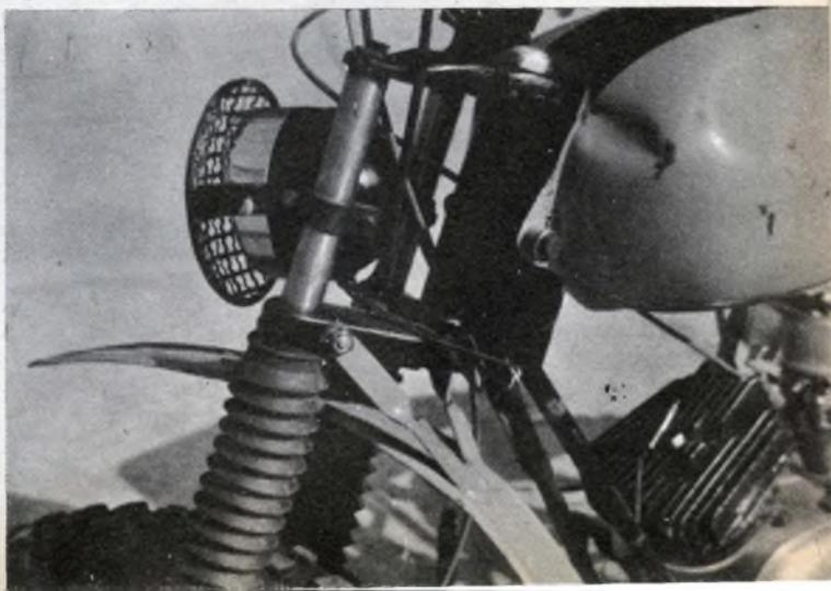
**Particolare del bloccaggio del manubrio alla testa di forcella e del parafrangente anteriore.**
