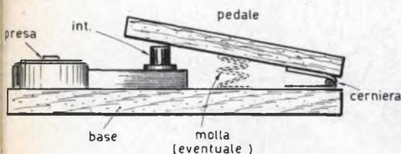
A sinistra schema elettrico dell'interruttore: delle due prese una è collegata alla rete, l'altra riceve la spina dell'ingranditore. In alto disegno riproducente il profilo schematizzato del piccolo apparecchio.
