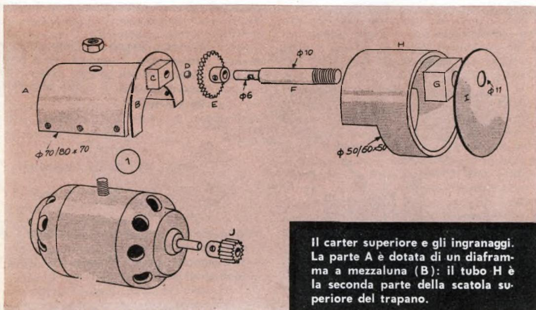
Il carter superiore e gli ingranaggi. La parte A è dotata di un diaframma a mezzaluna (B); il tubo H è la seconda parte della scatola superiore del trapano.
