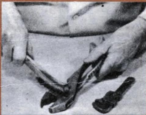
Dopo il bagno anti-ruggine spazzolate energicamente gli utensili con una spazzola di fili metallici o un tampone di lana di ferro.
