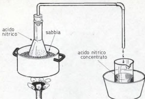
Nel disegno qui presentato appare lo svolgimento del bagno di sabbia, metodo di riscaldamento assai vantaggioso.
