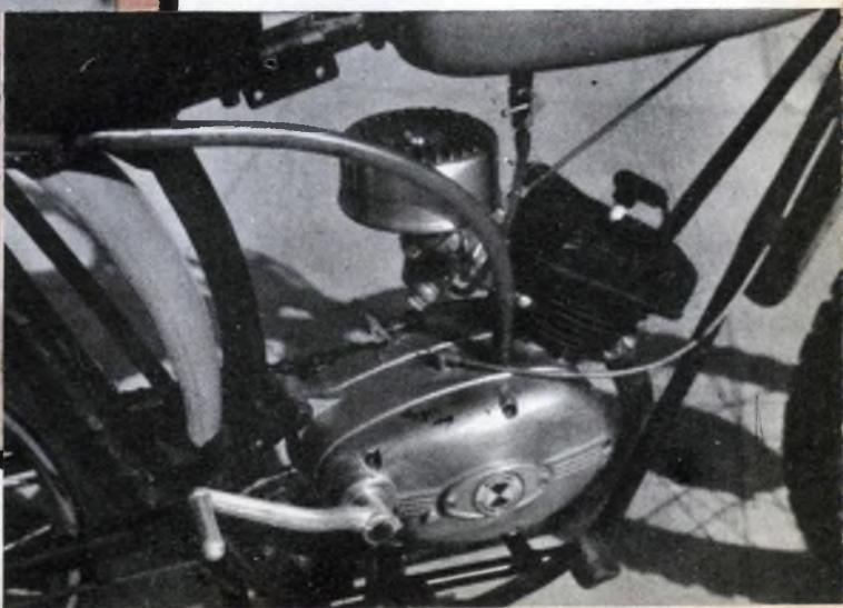
**Il grosso filtro d'aria Del-l'Orto si smonta con tutta facilità. Il coperchio è fissato da un galletto. La paglietta metallica che fa da filtro è imbevuta da una miscela olio - benzina al 50 %. Si noti la testa speciale Turbo generosamente dimensionata e alettata.**
