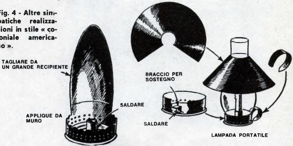
Anche la lanterna è realizzata con una sola scatola di grandezza sufficiente. La svasatura dei bordi del riflettore è ottenuta appoggiando la scatola su un blocco di legno. La lampada è costruita quasi nell'identico modo. Per realizzare piatti e vassoi di vario tipo dovete pren-
