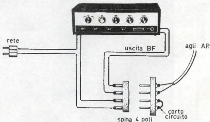
Può capitare, a volte, di accendere il nostro amplificatore a transistor, magari ad Hi-Fi, dimenticandoci di controllare se il cavo degli altoparlanti risulta inserito, con la spiacevole conseguenza di veder andare in un filo di fumo migliaia di lire e di fatica.
