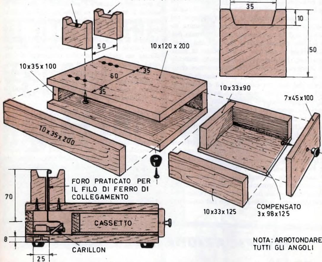
Sopra: disegno riprodotto il procedimento costruttivo del poggiatelefono. Nella fotografia in basso a sinistra si vede chiaramente che il cassetto non occupa tutto il vano ma lascia lo spazio necessario per il carillon. A destra: la chiavetta di ricarica del movimento ad orologeria deve sporgere dalla base del poggiatelefono in modo da poter ruotare liberamente.
