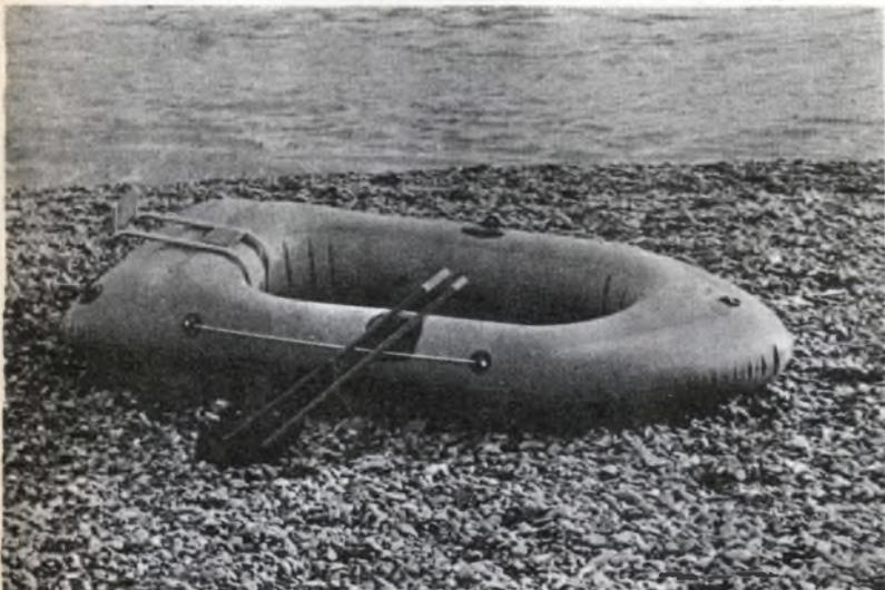
Canotto pneumatico spazioso, a fondo piatto con due derive: eccovi il « Super Atlantic » provvisto di tre compartimenti stagni a gonfiaggio separato.
