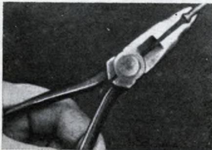
Per fissare le viti, specie in posti reconditi, fate così. Prendete un paio di pinze, anche vecchie e sballate, praticate con la lima, una tacca a V nella parte interna dei becchi. Questa tacca vi permetterà di tenere la vite, dalla parte della testa, ben ferma senza le deviazioni laterali che sono così facili usando pinze normali. L'idea è di usare pinze dritte e sottili.
