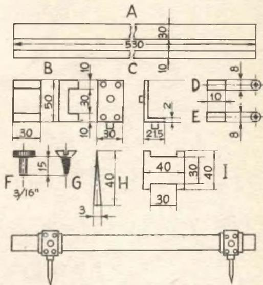
minori i due cilindretti **D**. Con una punta da 3,5 ripassate poi i fori di **E** sfondando anche la lamiera di **C** e filettate con maschio da 3/16";
