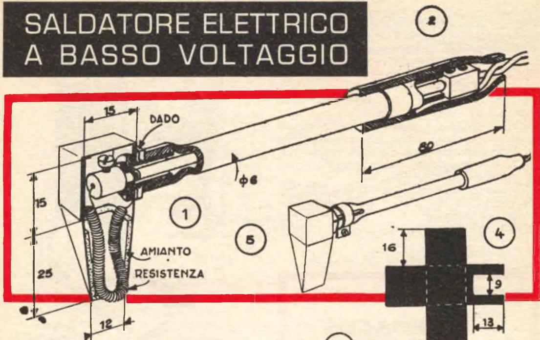
**E**cco un modello di saldatore elettrico a basso voltaggio, assai facile a costruire e di ottimo funzionamento.
