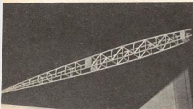
La fusoliera di un modello Coupe d'Hiver in costruzione, realizzata con traversini dritti, rinforzati con diagonali nelle fiancate della parte anteriore, che sopporta la matassa.
