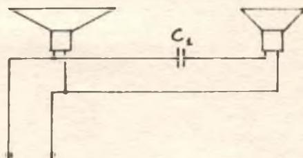
$C_L$  = condensatore 2 mf 50 V
