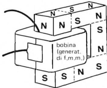
In qualunque parte del circuito magnetico, e anche all'interno della bobina, di fronte ad un polo nord si forma un polo sud e viceversa.
