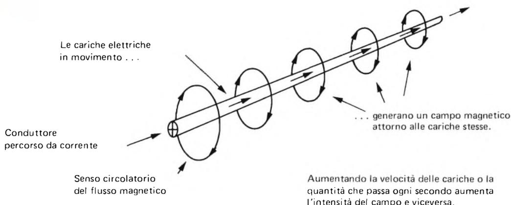
**ESPERIMENTI DI OERSTED SU CONDUTTORI PERCORSI DA CORRENTE**
