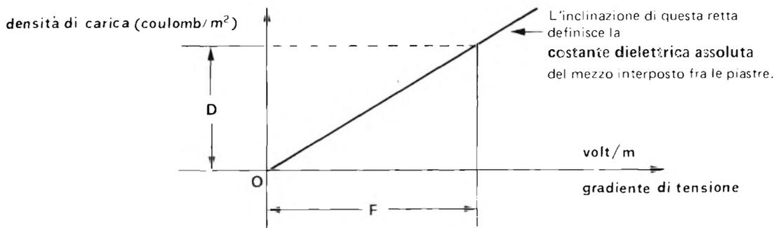
Il diagramma dice che, fissata la superficie e la distanza fra le piastre, se si fa aumentare il gradiente di tensione (aumentando la quantità di carica e quindi la tensione fra le piastre), aumenta nello stesso rapporto la densità di carica
