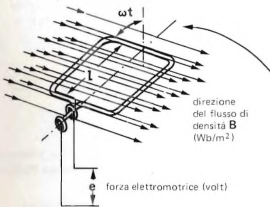
Abbiamo già visto (12.23-3) che una spira rotante, immersa in un campo magnetico, è sede ai suoi capi di una forza elettromotrice.
