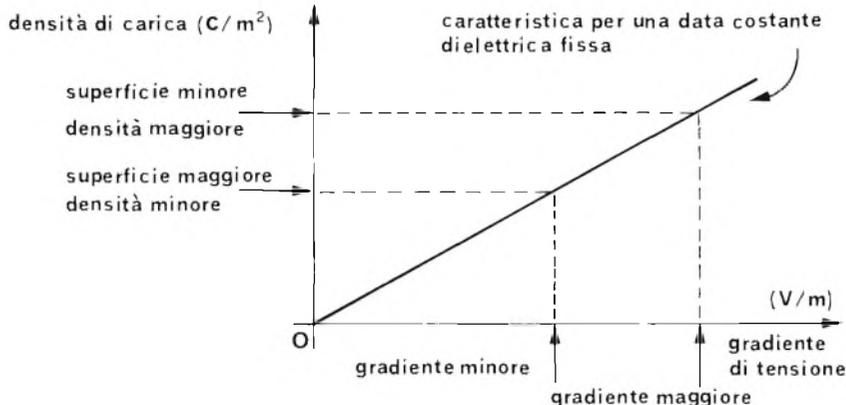
Le cariche presenti in un condensatore carico a circuito aperto, non possono scappare, quindi si addenseranno più o meno a seconda delle variazioni della superficie utile delle armature.
