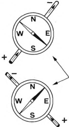
**Conduttore percorso da corrente continua nel senso indicato dalle frecce**
