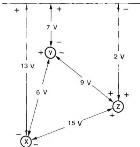
La carica **Z** si trova di **2 V** superiore al potenziale del suolo essendo di **9 V** superiore alla carica **Y**, la quale si trova di **7 V** inferiore al potenziale del suolo
