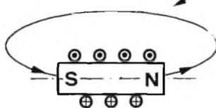
Anche se il percorso analogo per i due magneti uniti coi poli dello stesso nome è inferiore alla somma dei singoli percorsi, le singole f.m.m. ed i rispettivi flussi sono opposti.
