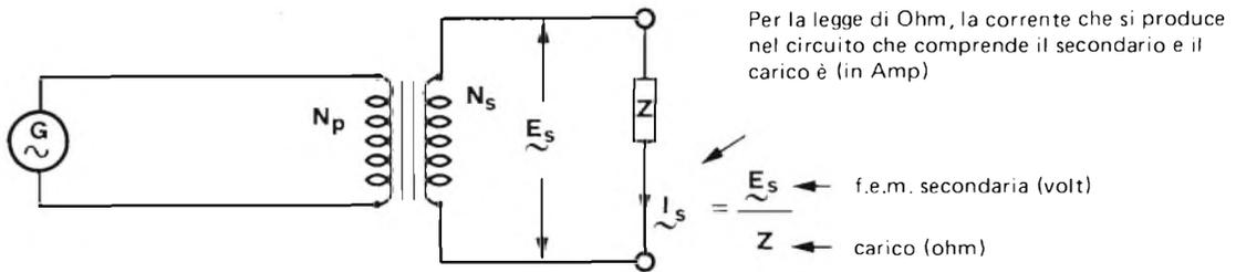
Questa corrente (in Amp), che attraversa l'avvolgimento secondario produce (12.24-2) un flusso smagnetizzante (in Wb) per la legge di Hopkinson
