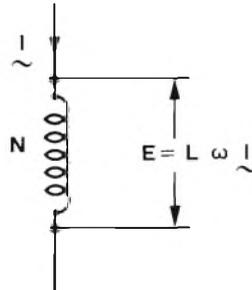
La f.e.m. indotta è pure di tipo alternato sinusoidale, ma è sfasata di  $90^\circ$  ( $\pi/2$  rad)
