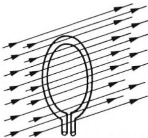
Spirale di materiale conduttore immersa in un campo magnetico costante.
