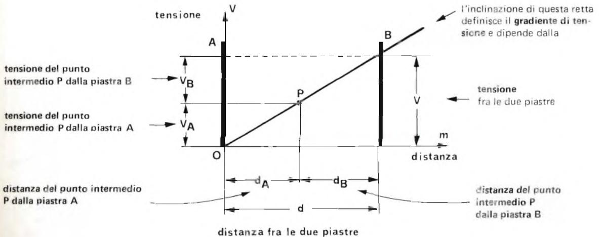
**Conclusione.** Poichè è fissa la superficie delle piastre, la densità di carica aumenta con la tensione fra le piastre; e poichè è fissa anche la distanza fra le piastre, il gradiente di tensione aumenta con la tensione stessa fra le piastre.
