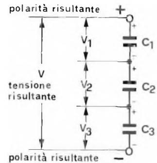
A) **La tensione risultante**  $V = V_1 + V_2 + V_3$
