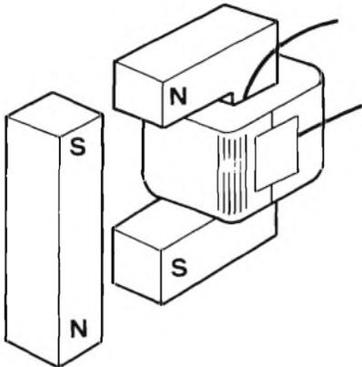
La presenza di ferro anche non magnetizzato, crea forze di attrazione, perchè il ferro ha una riluttanza minore di un uguale spazio di aria.
