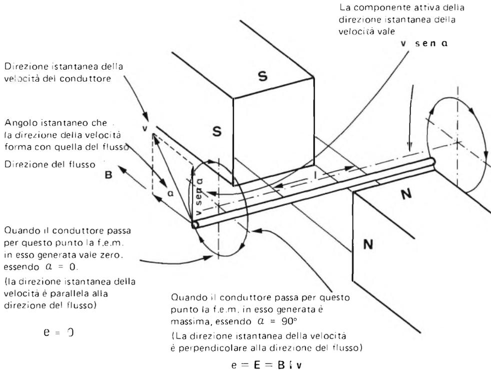
Se chiamiamo  $E = B l v$  la f.e.m. massima, cioè quella che si ottiene quando  $\alpha = 90^\circ$ , cioè quella che si ha istantaneamente quando il conduttore taglia perpendicolarmente la direzione del flusso, in un punto qualsiasi della circonferenza descritta da un'estremità del conduttore avremo
