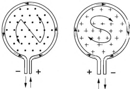
Ogni spira di un solenoide attraversata da corrente come nelle figure, è sollecitata da un'azione che tende a dilatarla, perchè, dilatandosi, aumenta la sezione di spazio abbracciata dal flusso e perciò diminuisce la riluttanza magnetica.
