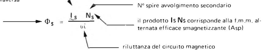
La smagnetizzazione, così provocata nel circuito magnetico, obbliga il richiamo di ulteriore corrente dal generatore per ripristinare la magnetizzazione perduta.
