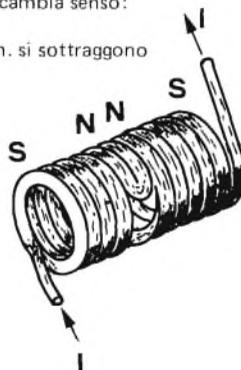
Laddove la bobina cambia senso si inserisce una presa intermedia
