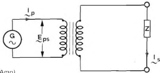
Supponiamo, come è vero, che l'impedenza propria del generatore sia trascurabile. La corrente che si genera nel circuito primario chiuso sul generatore è data (legge di Ohm)
