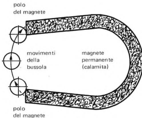
Se poi poniamo la bussola in altri punti della zona non appartenenti a linee già tracciate e continuiamo l'esperimento, alla fine avremo tracciato un insieme di linee che vanno da un polo all'altro del magnete.
