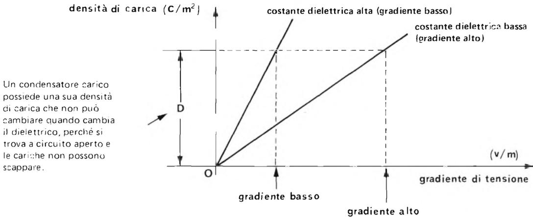
Un condensatore carico possiede una sua densità di carica che non può cambiare quando cambia il dielettrico, perché si trova a circuito aperto e le cariche non possono scappare.
