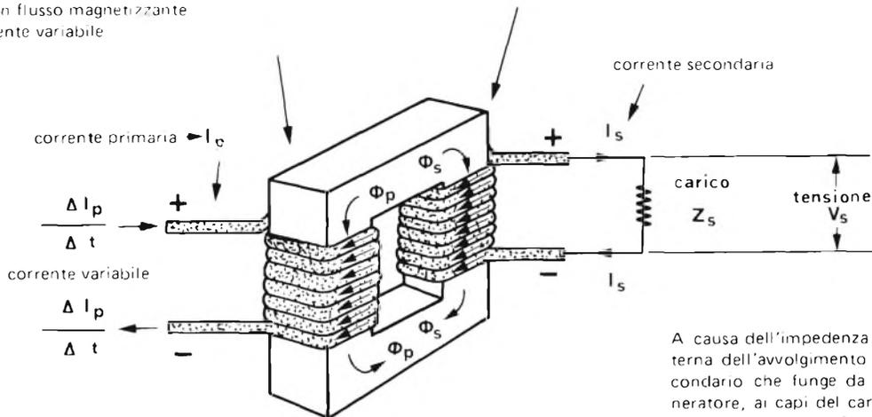
A causa dell'impedenza interna dell'avvolgimento secondario che funge da generatore, ai capi del carico la f.e.m. si abbassa in tensione.
