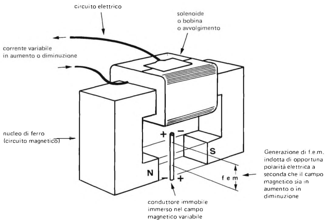
**Attenzione** - La f.e.m. ai capi del conduttore si produce solo quando ci sia **variazione di flusso**, che, in questo caso, è ottenuta mediante **variazione di forza magneto-motrice** nel circuito magnetico e perciò, in ultima analisi, mediante **variazione di corrente** (che si chiama corrente magnetizzante).
