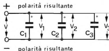
A) La tensione risultante  $V = V_1 = V_2 = V_3$
