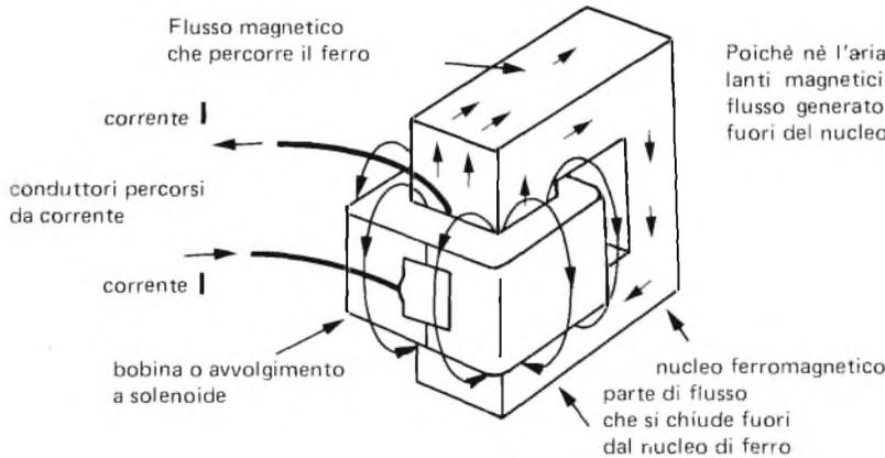
Poichè nell'aria, né il vuoto sono buoni isolanti magnetici, è inevitabile che parte del flusso generato nella bobina si chiuda al di fuori del nucleo ferromagnetico
