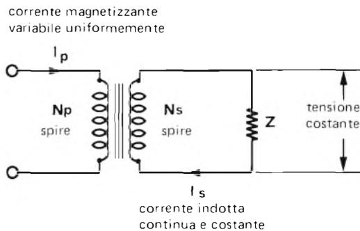
E' ormai noto che, per avere una corrente continua nel carico, è indispensabile avere una tensione costante ai capi dell'avvolgimento indotto  $N_s$ , e che per avere una tensione costante è sufficiente fare variare uniformemente la corrente magnetizzante nell'induttore.
