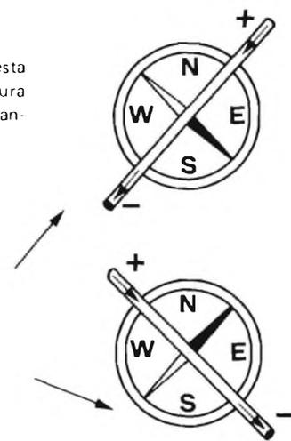
**Attenzione:** Quale senso della corrente si è assunto quello convenzionale delle cariche positive, cioè quello secondo il quale la corrente esce dal polo positivo del generatore ed entra nel polo positivo dell'utilizzatore.
