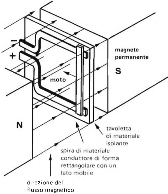
Su una tavoletta di materiale isolante si costruisca una spira di materiale conduttore di forma rettangolare con un lato mobile.
