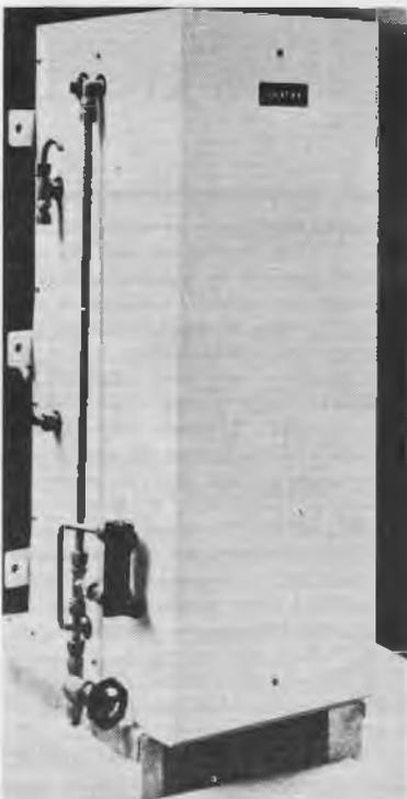
Il dispositivo ha le dimensioni di 90 x 35 x 40 cm, con un peso totale in servizio di appena 90 kg e può essere montato a parete o su paratia. È alimentato da tre riscaldatori ad immersione da 2000 W a 240 V, che possono essere impiegati separatamente oppure insieme, secondo la produzione d'acqua potabile che si richiede. L'energia elettrica, per l'impianto di Bell Rock, è fornita dagli alternatori, comandati da motore Diesel, che generano la corrente per il faro stesso.
