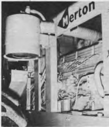
La fig. mostra il gruppo turbo-compressore montato in testa al motore, e un filtro dell'aria auto-pulitore Cooper King prodotto, per l'impiego in ambienti molto polverosi, dalla Cooper Mechanical Joints Ltd. di bergavenny. La Merton monta tale tipo di filtro per le ordinazioni che ricada dai suoi distributori del Medio Oriente. Tali filtri sono a pulitura automatica, e scaricano continuamente e in modo automatico la polvere che estraggono dall'aria.
