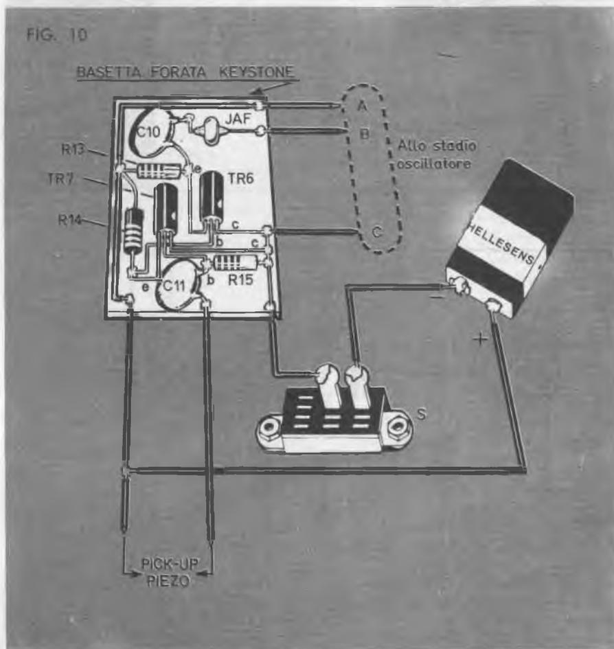
In alto: schema pratico del modulatore multivibratore; lo schema elettrico appare nella figura 6. A lato: schema pratico del modulatore ed alta impedenza d'ingresso; si veda anche la figura 5.
