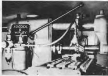
una miscela di aria compressa e di fluido atomizzato e la manda attraverso una tubazione flessibile ad un ugello distributore Mistcool e poi alla superficie ricevente.
