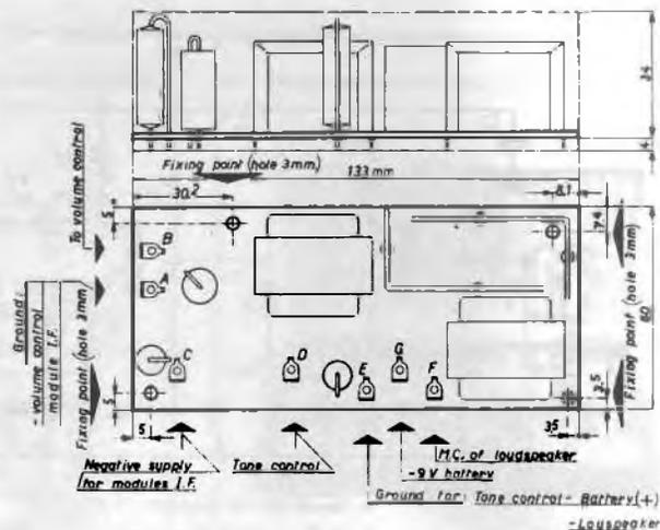
A lato, si vede la modifica per rendere plurigamma il ricevitore; in alto lo schema di montaggio dell'amplificatore Z164 con i relativi terminali.
