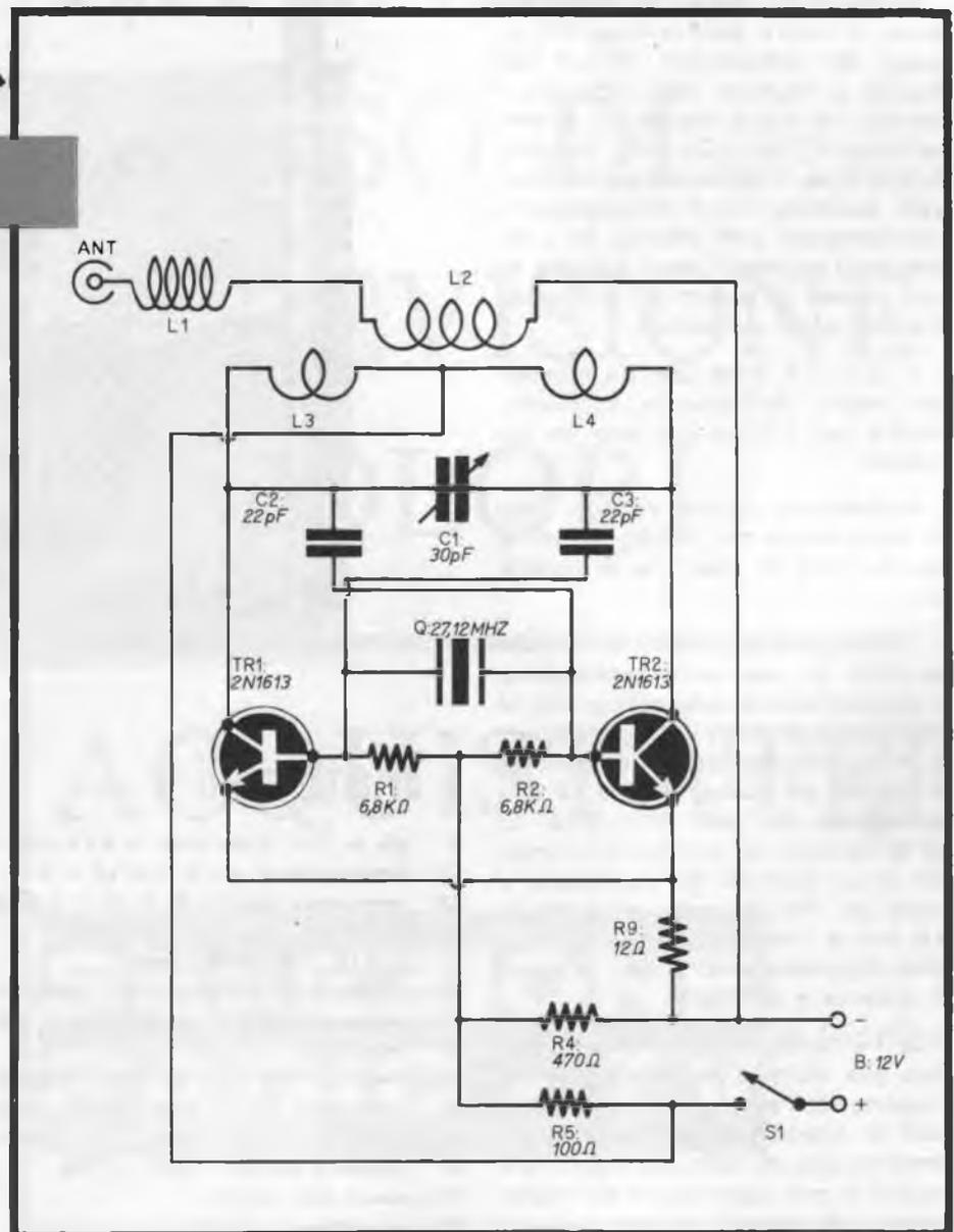
È possibile « allungare » elettricamente lo stilo mediante una bobina di carico però, e tale bobina è la L1, che consente l'impiego di uno stilo lungo appena un metro, cioè dalle dimensioni sufficientemente ridotte per il pratico impiego.
