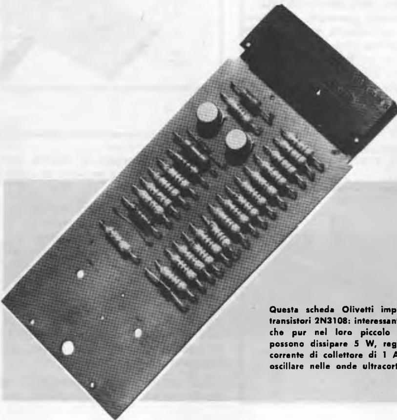
Questa scheda Olivetti impiega due transistori 2N3108: interessanti modelli che pur nel loro piccolo involucro possono dissipare 5 W, reggere una corrente di collettore di 1 A, nonché oscillare nelle onde ultracorte!
