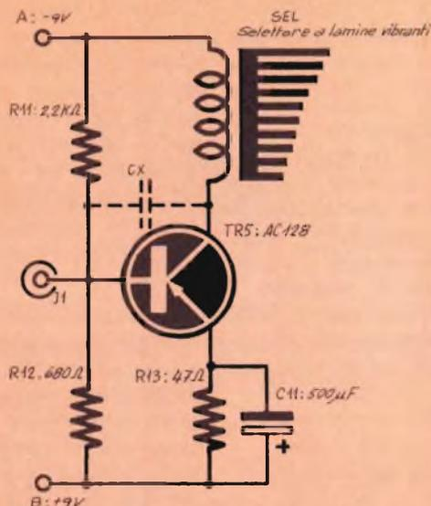
Attuatore pluricanale che impiega il Selettore a lamine vibranti. Il condensatore « CX » può essere impiegato solo se durante la messa a punto si nota una certa instabilità, nel funzionamento in « area marginale ».
