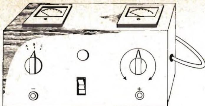
Fig. 4 - Aspetto dell'apparecchio visto frontalmente. I due strumenti sono stati applicati sulla parete superiore, per comodità di lettura. Sono visibili i vari comandi, la gemma della lampada spia, i morsetti di uscita, ed il cordone di rete.
