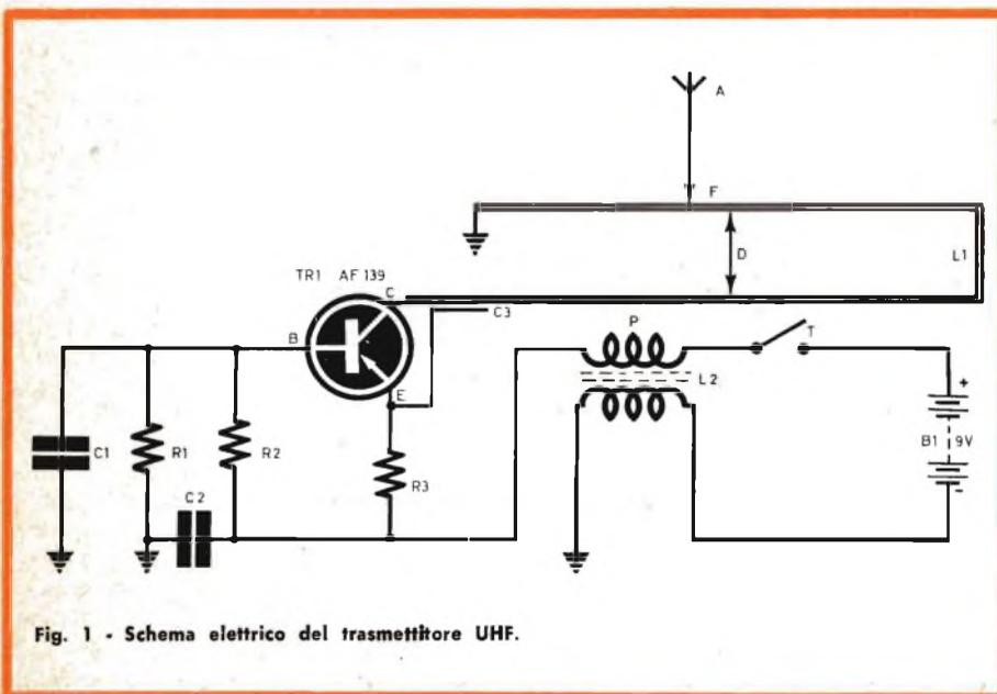
Fig. 1 - Schema elettrico del trasmettitore UHF.
