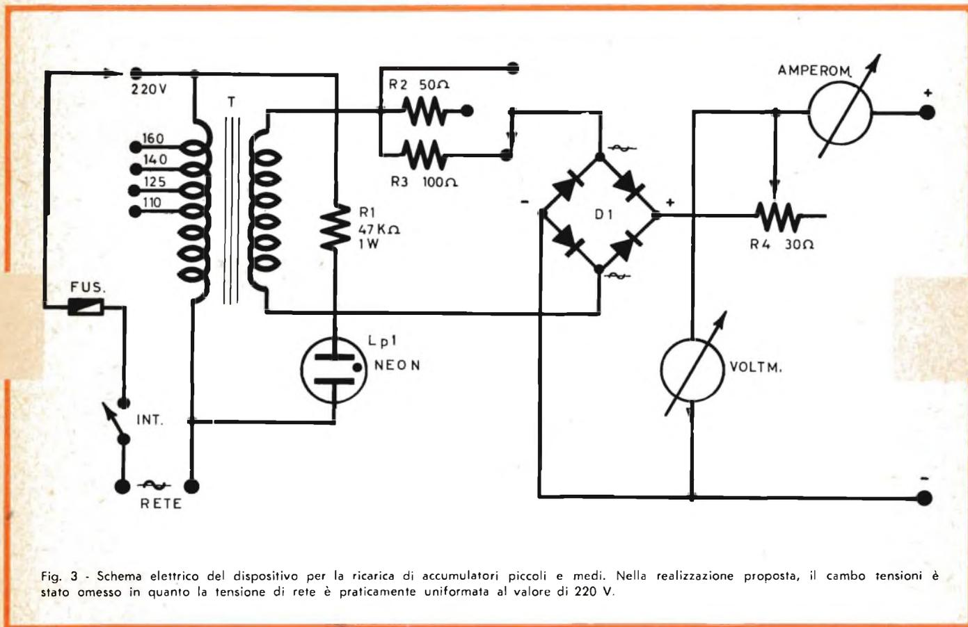
Fig. 3 - Schema elettrico del dispositivo per la ricarica di accumulatori piccoli e medi. Nella realizzazione proposta, il cambio tensioni è stato omesso in quanto la tensione di rete è praticamente uniformata al valore di 220 V.
