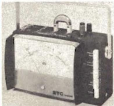
la taratura interna, è di  $\pm 0,25$  dB con una lettura di 0 dB a 100 kc/s su circuiti da 75 Ω, e la si può migliorare se si impiega come standard per la taratura un gruppo di misura STC 74166 mW. Alle altre frequenze, su circuiti da 75 Ω, la lettura sarà entro  $\pm 0,1$  dB del valore che si legge a 100 kc/s.
