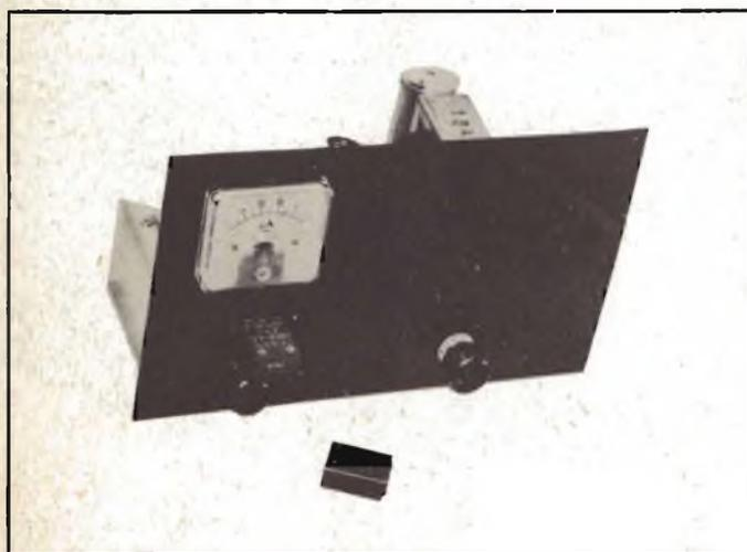
Quarzi normali, di buona efficienza, tenendo il controllo della sensibilità (R4) a circa metà corsa, producono la deflessione dell'indice dello strumento a circa metà scala o poco più.
