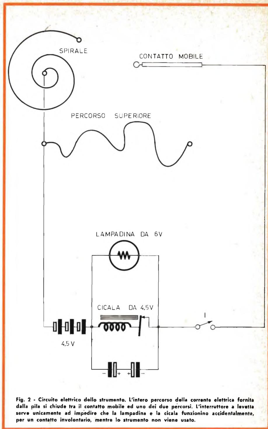
Fig. 2 - Circuito elettrico dello strumento. L'intero percorso della corrente elettrica fornita dalla pila si chiude tra il contatto mobile ed uno dei due percorsi. L'interruttore a levetta serve unicamente ad impedire che la lampadina e la cicala funzionino accidentalmente, per un contatto involontario, mentre lo strumento non viene usato.
