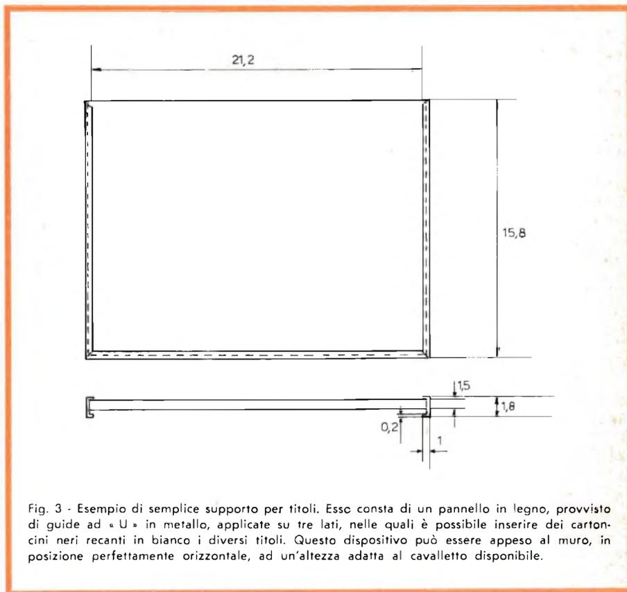
Fig. 3 - Esempio di semplice supporto per titoli. Esso consta di un pannello in legno, provvisto di guide ad « U » in metallo, applicate su tre lati, nelle quali è possibile inserire dei cartoncini neri recanti in bianco i diversi titoli. Questo dispositivo può essere appeso al muro, in posizione perfettamente orizzontale, ad un'altezza adatta al cavalletto disponibile.
