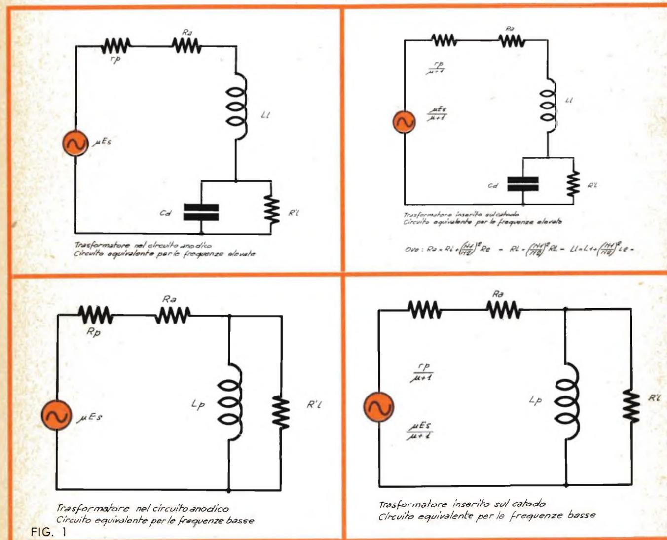
L'amplificatore con l'uso di questo trasformatore, vediamo per un momento la figura 1, che mostra il circuito equivalente semplificato del trasformatore d'uscita inserito nella placca o nel catodo di una valvola.
