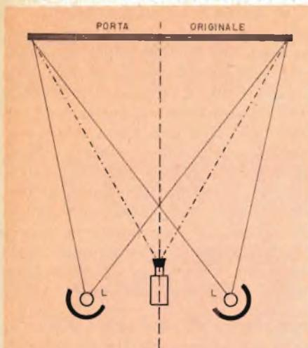
Fig. 5 - Per riprendere titoli con luce artificiale, occorre disporre di un minimo di due lampade, disposte nel modo illustrato. In questi casi, è sempre opportuno applicare alla cinepresa il parasole.
