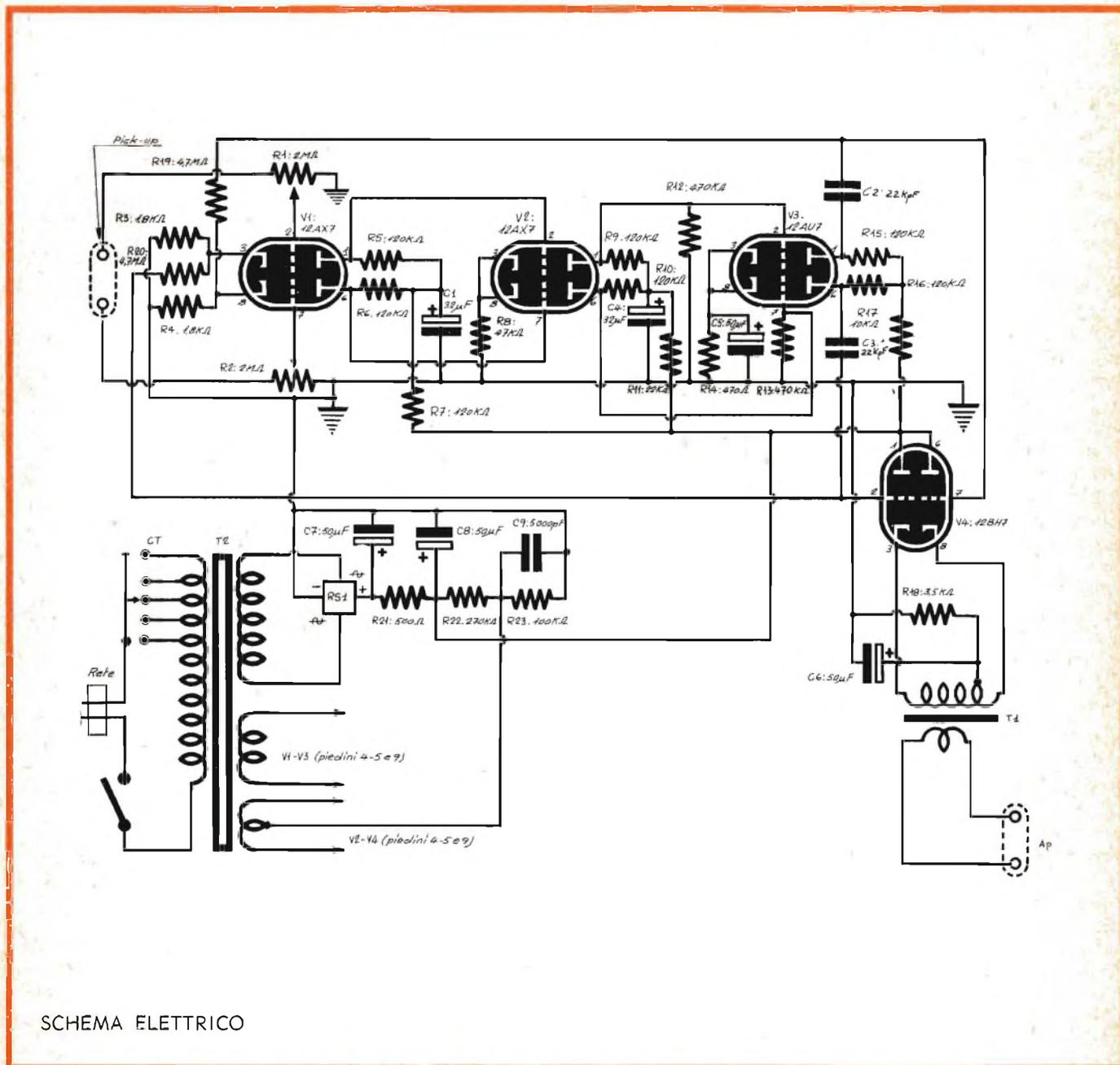
trasformatore G.B.C. « H/135 » e con un trasformatore occasionale « Surplus » pescato nella cassetta dei rotami. Quest'ultimo, usato per pura curiosità, era il « Merit A/2936 » che dovrebbe avere 10 k $\Omega$  d'impedenza primaria e 10-12 W di potenza essendo usato in origine come carico di una « 6N7 » di un interfonico d'aereo USA.
