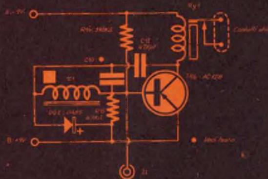
Attuatore monocanale a relais. « Z1 » e « C10 » formano il filtro audio che potenzia la sensibilità del sistema, consentendo il funzionamento « reflex » dello stadio.
