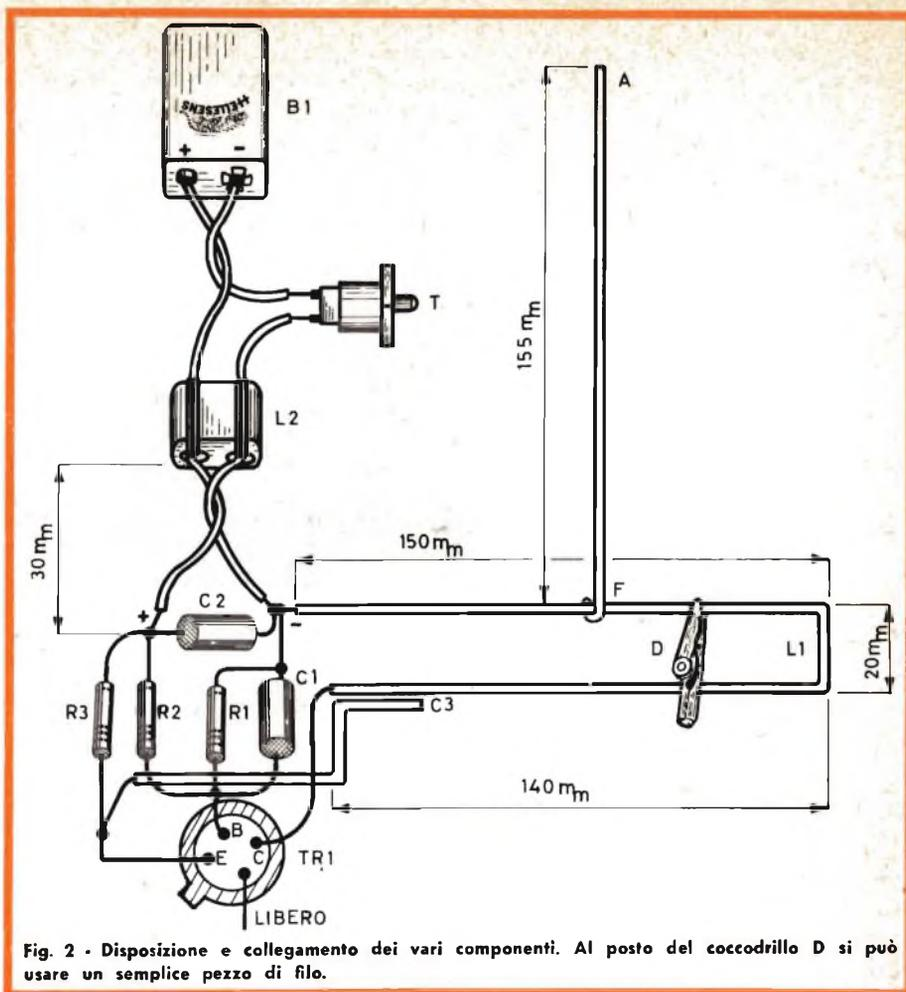
Fig. 2 - Disposizione e collegamento dei vari componenti. Al posto del coccodrillo D si può usare un semplice pezzo di filo.
