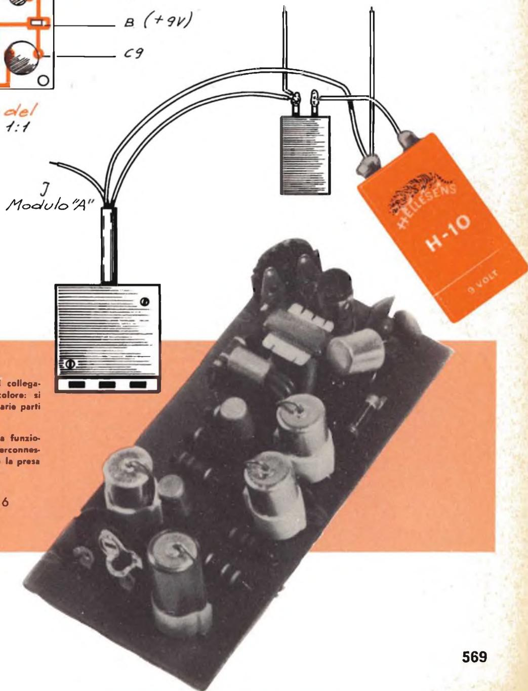
In alto: Montaggio del « modulo A ». I collegamenti « stampati » sono riprodotti a colore: si vedono chiaramente le connessioni alle varie parti dell'apparecchio.
