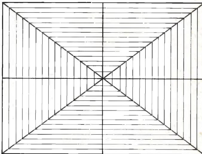
Fig. 2 - Aspetto del quadro campione, recante varie cornici concentriche, e tutte di dimensioni proporzionali a quelle del fotogramma, mediante il quale è possibile stabilire le dimensioni del campo abbracciato dalla cinepresa alla distanza minima di messa a fuoco.
