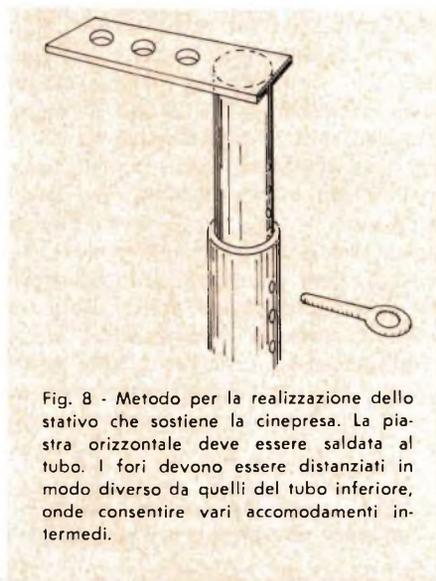
Fig. 8 - Metodo per la realizzazione dello stativo che sostiene la cinepresa. La piastra orizzontale deve essere saldata al tubo. I fori devono essere distanziati in modo diverso da quelli del tubo inferiore, onde consentire vari accomodamenti intermedi.
