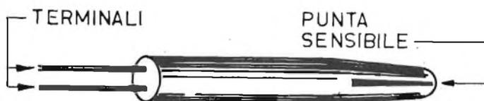
Fig. 1 - Aspetto dell'elemento termosensibile Siemens K17. La sua struttura permette l'applicazione di un tubetto di ottone per prolungarlo, che deve avere una lunghezza di 40-50 millimetri.
