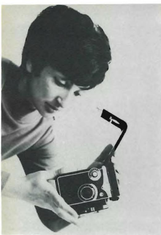
Fig. 5 - Per il controllo dell'otturatore e per osservare eventuali segni o graffi nell'ottica, occorrerà aprire il dorso della macchina e puntarla contro una sorgente di luce, con l'otturatore aperto sulla posa B.
