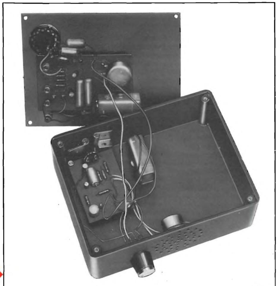
Fig. 2 - Aspetto dell'amplificatore all'interno del contenitore del capacimetro. In secondo piano è visibile il pannello recante tutti i componenti dell'UK440.
