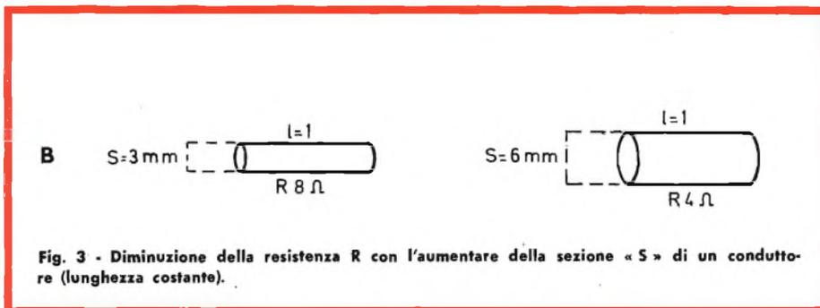
Fig. 3 - Diminuzione della resistenza R con l'aumentare della sezione « S » di un conduttore (lunghezza costante).
