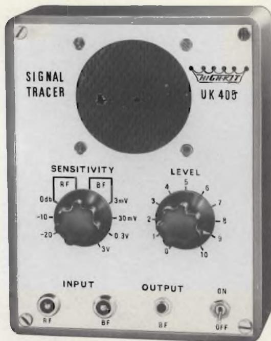
**L**e industrie elettroniche europee, a differenza di quelle d'oltre oceano, non sembrano particolarmente attratte dall'immettere sul mercato quel prezioso strumento che gli americani chiamano « Signal-Tracer » e che consiste in una apparecchiatura capace di seguire il segnale in un apparato elettronico partendo dalla presa di ingresso fino a quella di uscita.
