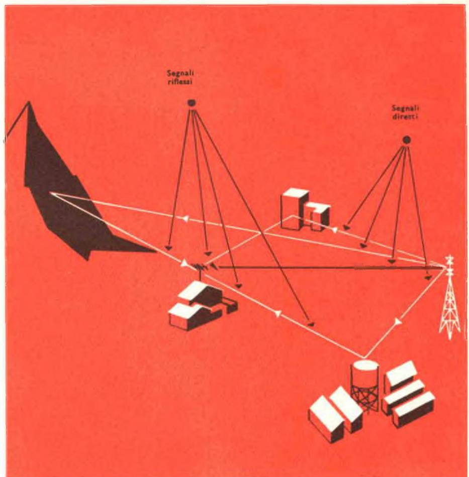
Fig. 1 - Esempio tipico di ricezione multipla per riflessione delle onde e.m. da parte di più ostacoli.
