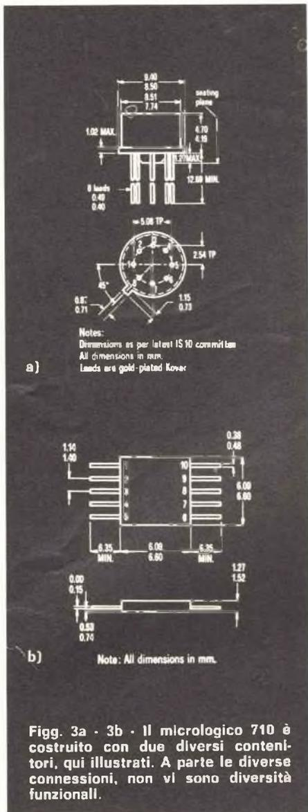
Fig. 3a - 3b - Il micrologico 710 è costruito con due diversi contenitori, qui illustrati. A parte le diverse connessioni, non vi sono diversità funzionali.
