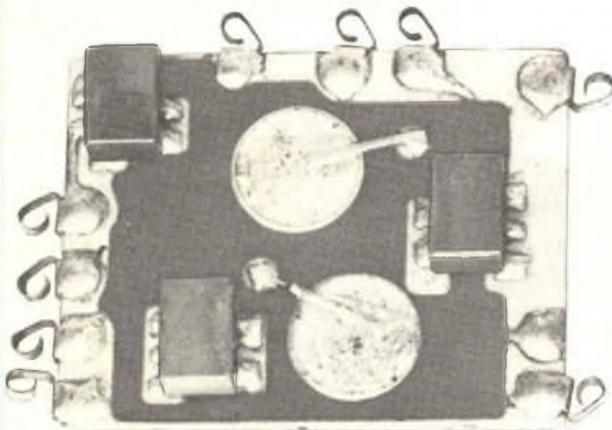
Fig. 6 - Basetta in Steatite per otofono che si deve alla «Centralab», anni 1952-53. In questa, ogni condensatore ed ogni resistenza sono direttamente «formati» sulla ceramica con i metodi descritti nel testo.
