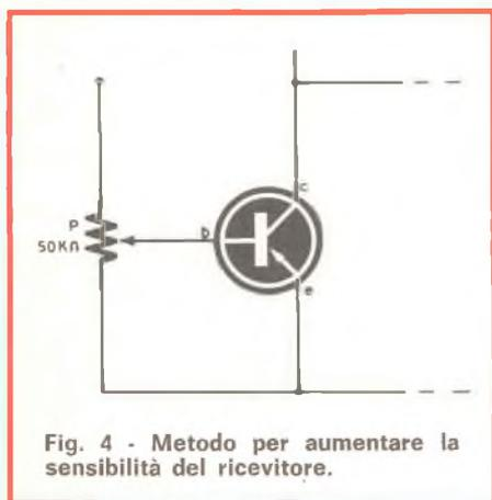
Fig. 4 - Metodo per aumentare la sensibilità del ricevitore.
