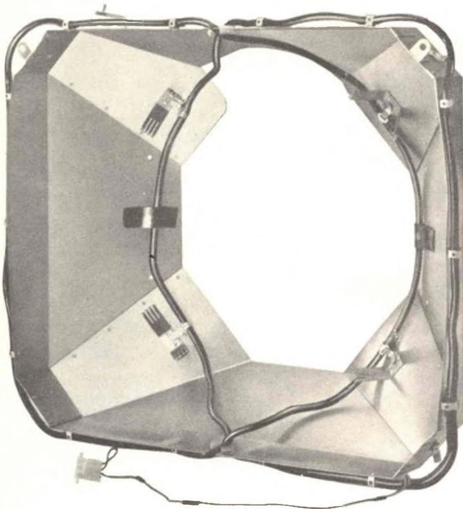
Fig. 12 - Schermatura magnetica con bobina automatica di smagnetizzazione.
