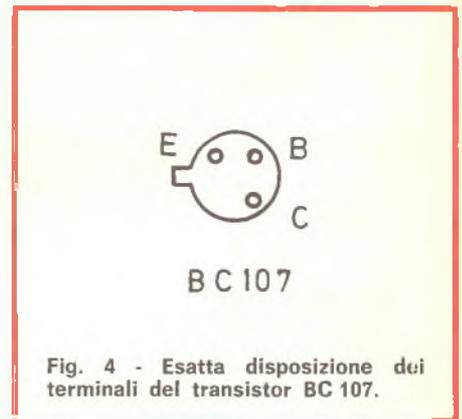
Fig. 4 - Esatta disposizione dei terminali del transistor BC 107.
