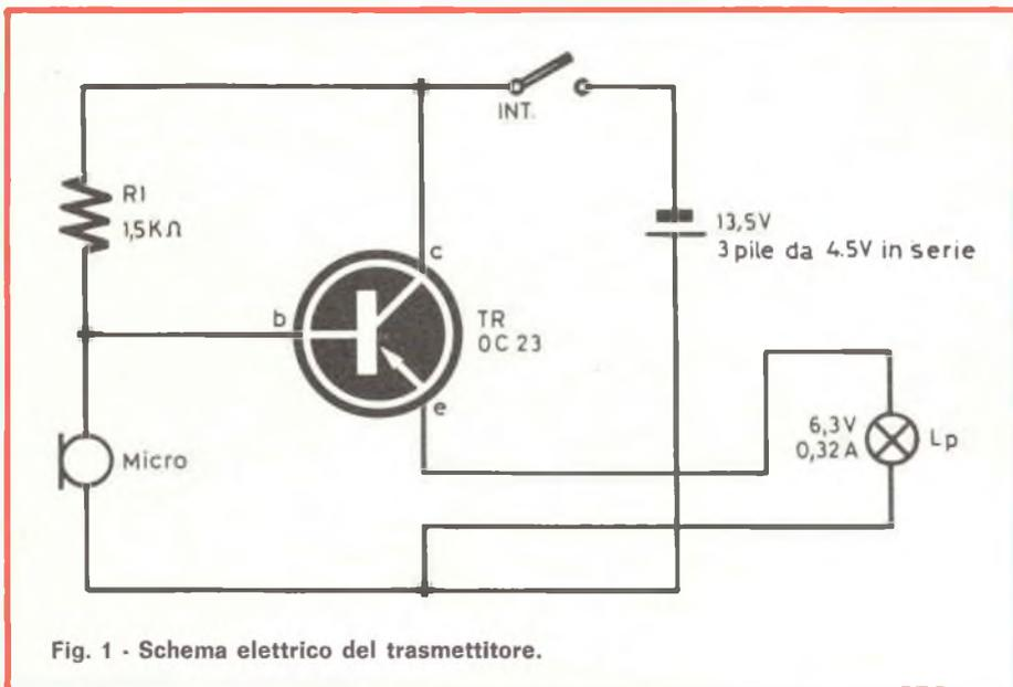
Fig. 1 - Schema elettrico del trasmettitore.
