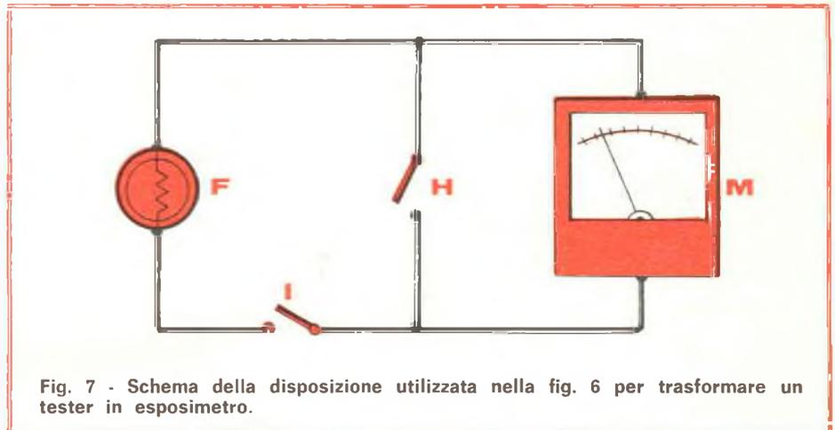
Fig. 7 - Schema della disposizione utilizzata nella fig. 6 per trasformare un tester in esposimetro.
