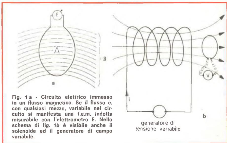
Fig. 1 a - Circuito elettrico immerso in un flusso magnetico. Se il flusso è, con qualsiasi mezzo, variabile nel circuito si manifesta una f.e.m. indotta misurabile con l'elettrometro E. Nello schema di fig. 1b è visibile anche il solenoide ed il generatore di campo variabile.
