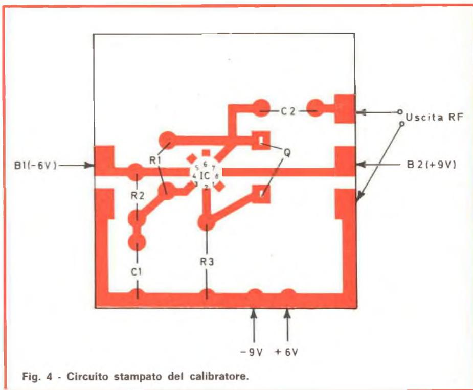
Fig. 4 - Circuito stampato del calibratore.
