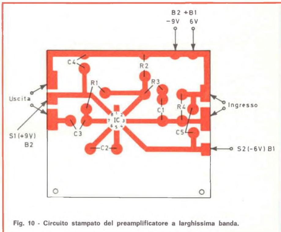
Fig. 10 - Circuito stampato del preamplificatore a larghissima banda.
