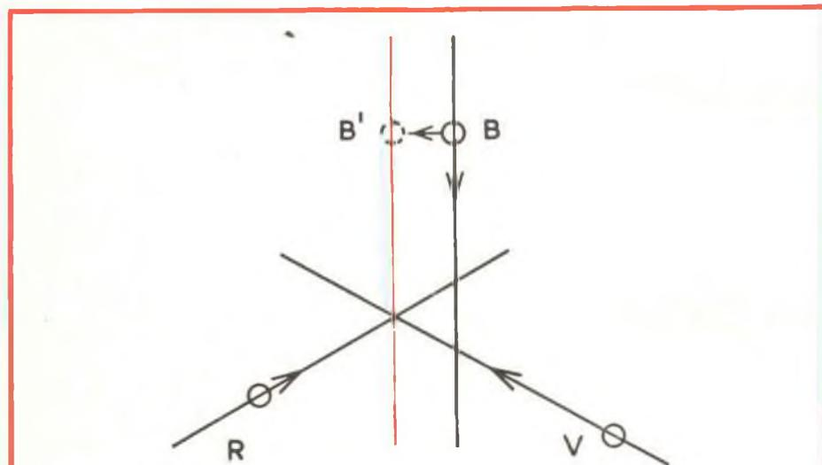
Fig. 16 - Spostamento dei fasci R, V e B per mezzo della convergenza radiale e dei magneti laterali del blu.
