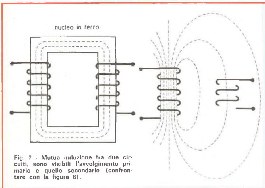
Fig. 7 - Mutua induzione fra due circuiti, sono visibili l'avvolgimento primario e quello secondario (confrontare con la figura 6).
