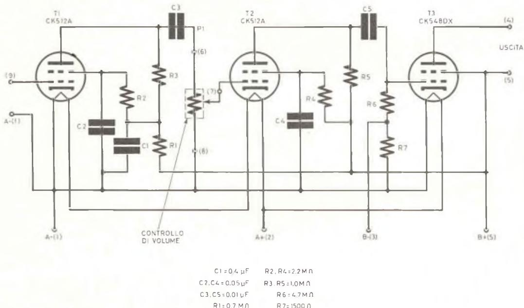
Fig. 7 - Schema elettrico dello chassis di figura 6.
