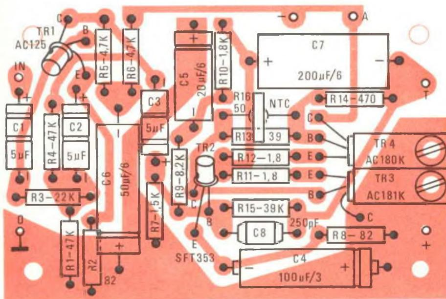
Fig. 3 - Disposizione dei componenti sul circuito stampato.
