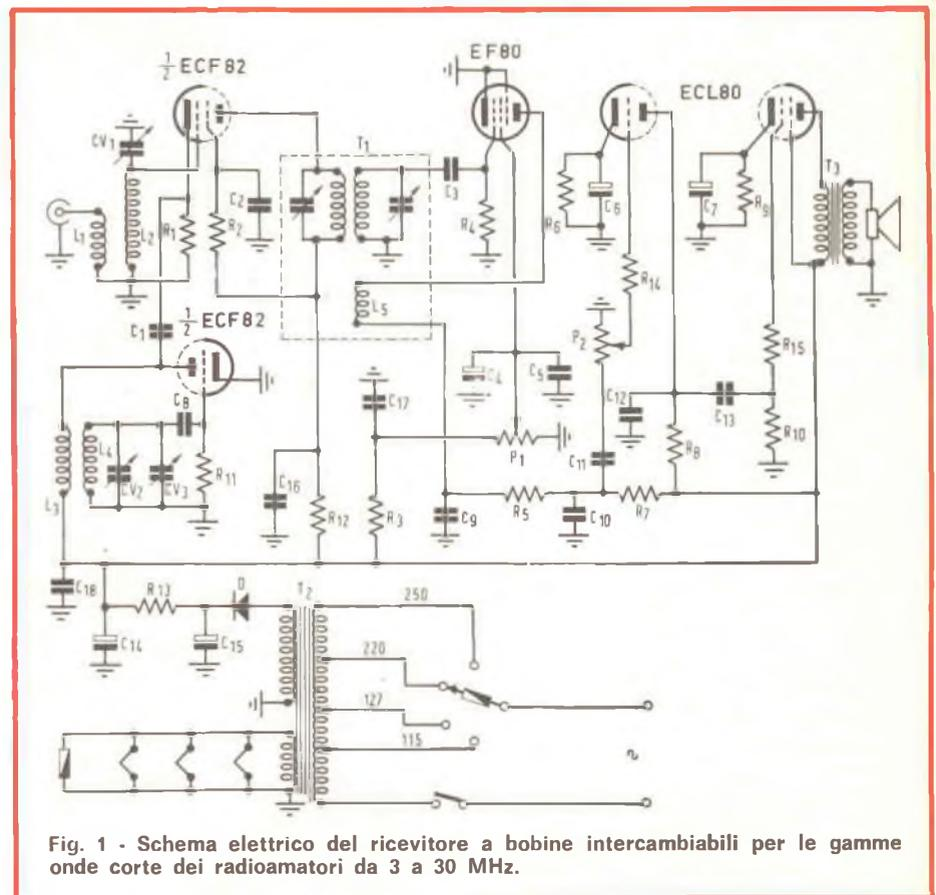
Fig. 1 - Schema elettrico del ricevitore a bobine intercambiabili per le gamme onde corte dei radioamatori da 3 a 30 MHz.
