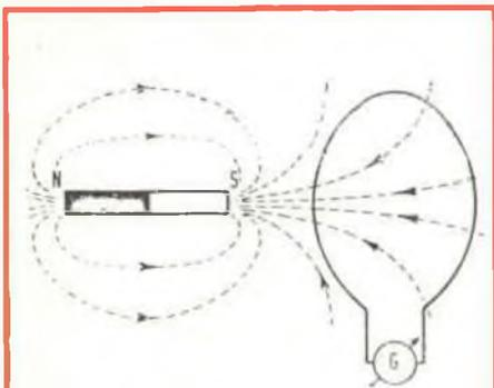
Fig. 2 - L'induzione elettromagnetica può essere ottenuta variando il campo magnetico, in questo caso spostando alternativamente il magnete oppure il circuito.
