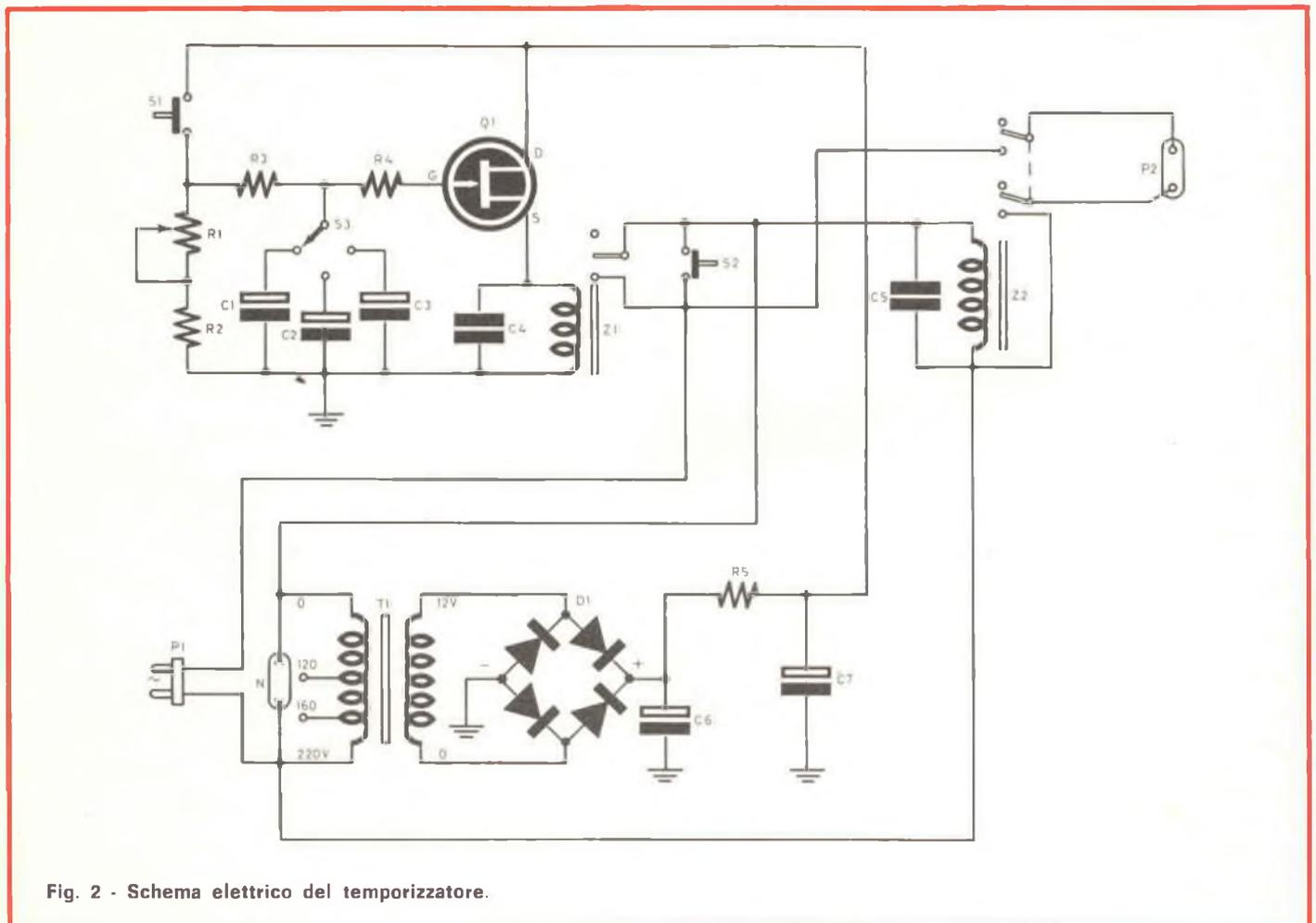
Fig. 2 - Schema elettrico del temporizzatore.
