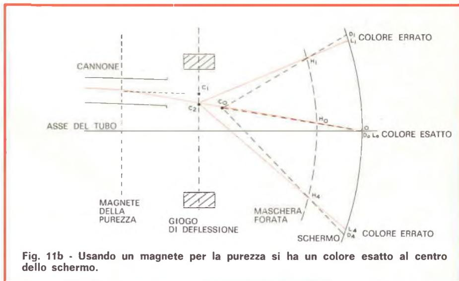
Fig. 11b - Usando un magnete per la purezza si ha un colore esatto al centro dello schermo.
