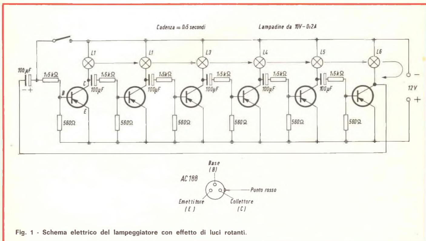
Fig. 1 - Schema elettrico del lampeggiatore con effetto di luci rotanti.
