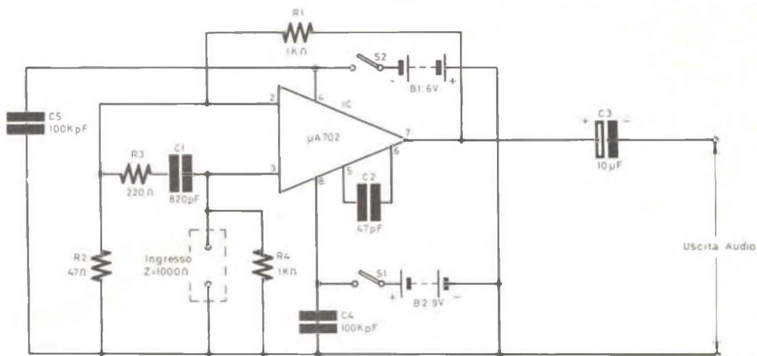
Fig. 9 - Schema elettrico del preamplificatore a larghissima banda.
