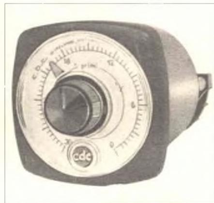
In figura 1 riportiamo la foto di un relé ritardatore tipo RAT, a tempi regolabili, della C.D.C. i cui contatti si aprono e si chiudono dopo un periodo di tempo prestabilito, regolabile a piacere. Il funzionamento avviene tramite un motorino sincrono stagno e l'alimentazione è possibile da 24 V a 220 V c.a.
