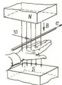
Fig. 4 - Regola della mano destra, per l'induzione elettromagnetica.
