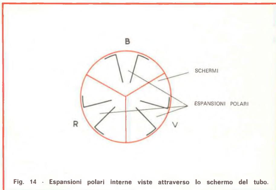
Fig. 14 - Espansioni polari interne viste attraverso lo schermo del tubo.
