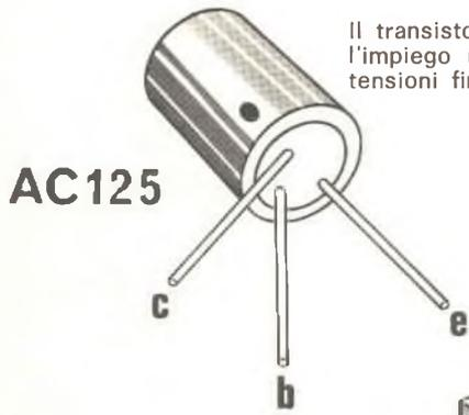
Il transistor PNP a lega AC 125 è adatto per l'impiego negli stadi preamplificatori e con tensioni fino a 14 Vc.c.
