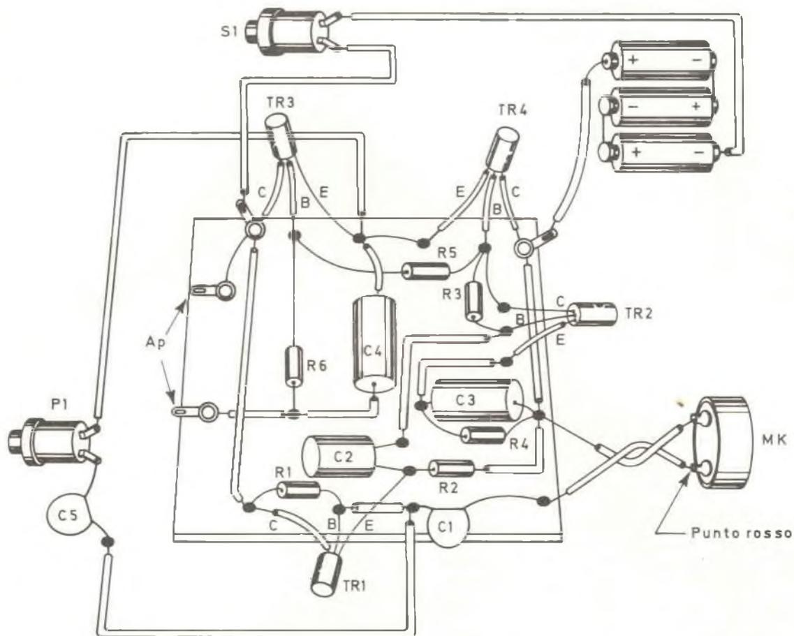
Fig. 4 - Schema di cablaggio.
