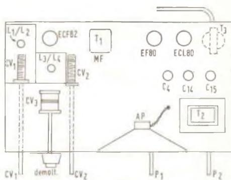
Fig. 4 - Chassis del ricevitore visto dalla parte superiore.
