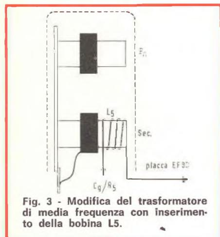
Fig. 3 - Modifica del trasformatore di media frequenza con inserimento della bobina L5.
