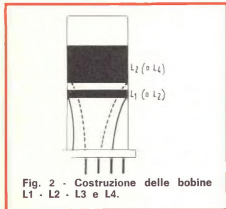
Fig. 2 - Costruzione delle bobine L1 - L2 - L3 e L4.
