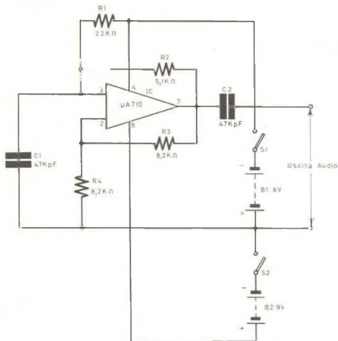
Fig. 5 - Schema elettrico del multivibratore astabile.
