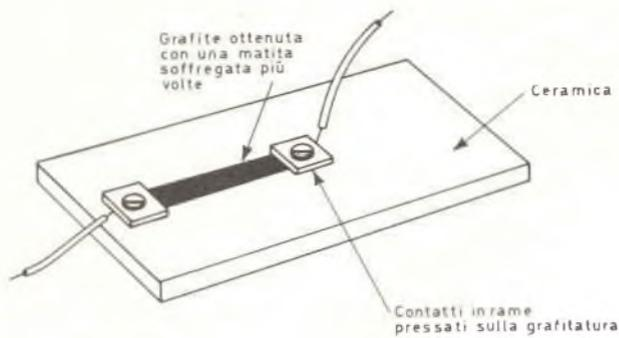
Fig. 5 - Come realizzare una resistenza sperimentale.
