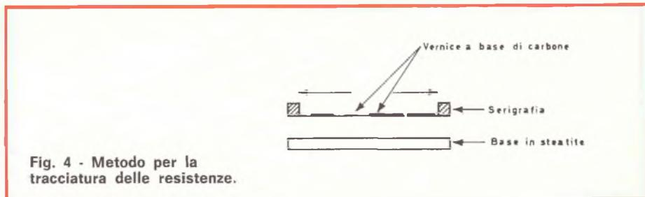
Fig. 4 - Metodo per la tracciatura delle resistenze.
