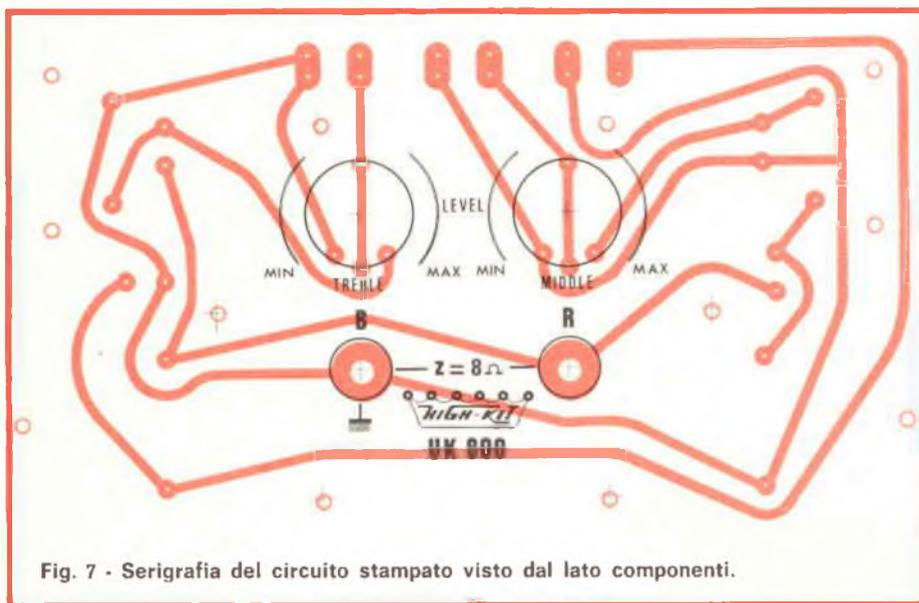
Fig. 7 - Serigrafia del circuito stampato visto dal lato componenti.
