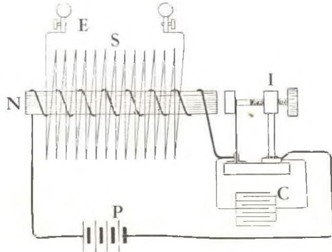
Fig. 9 - Schema elettrico di un rocchetto di Ruhmkorff.
