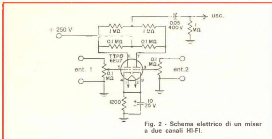
Fig. 2 - Schema elettrico di un mixer a due canali HI-FI.
