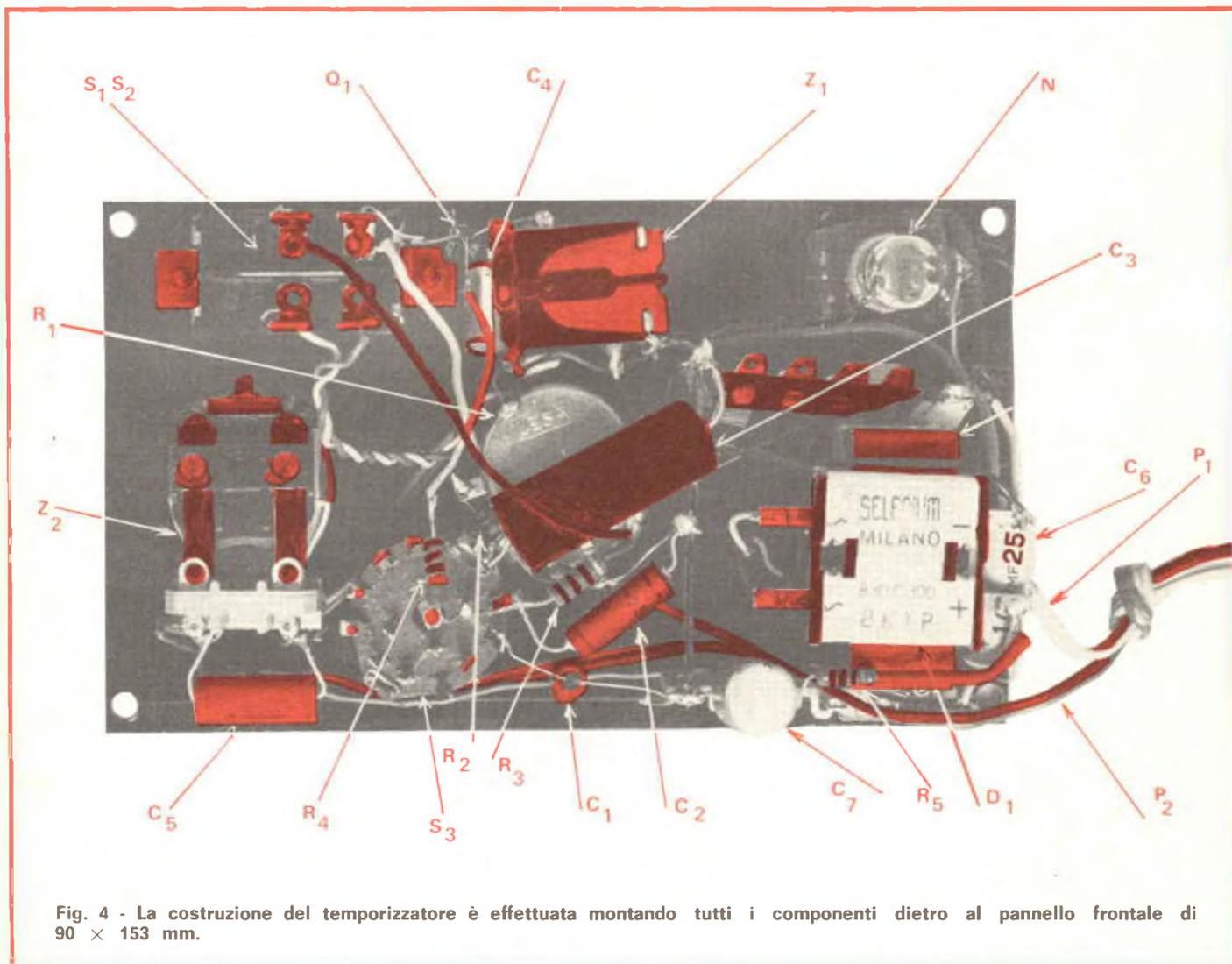
Fig. 4 - La costruzione del temporizzatore è effettuata montando tutti i componenti dietro al pannello frontale di 90 × 153 mm.
