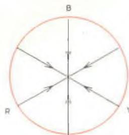
Fig. 19b - Possibili direzioni della correzione per mezzo di magneti per la convergenza, viste frontalmente.
