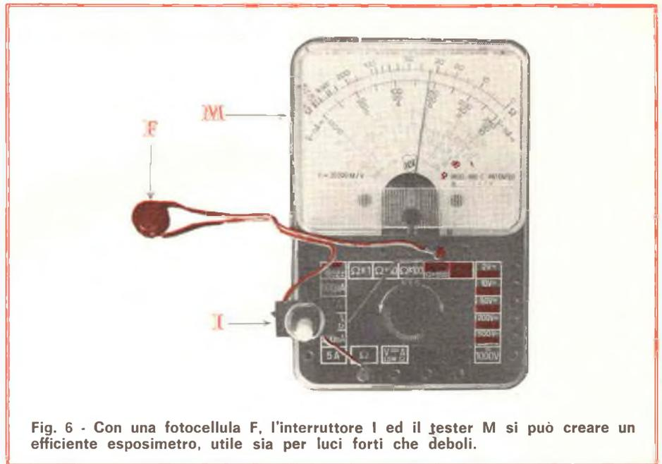
Fig. 6 - Con una fotocellula F, l'interruttore I ed il tester M si può creare un efficiente esposimetro, utile sia per luci forti che deboli.
