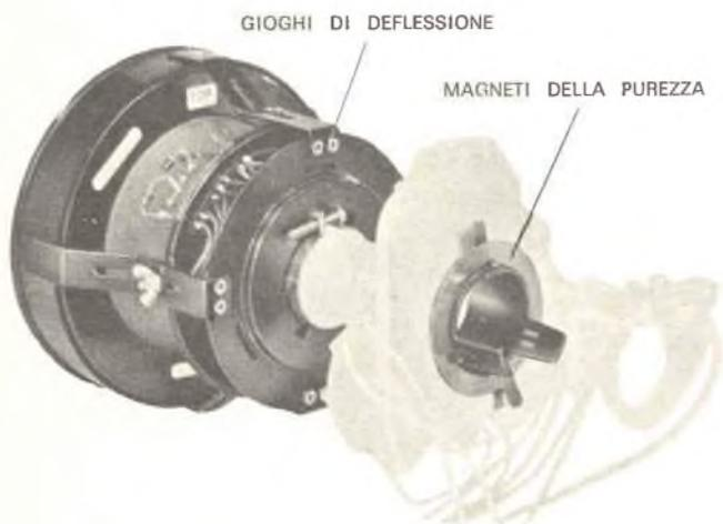
Fig. 10 - Componenti esterni al collo del tubo usati per la correzione della purezza del colore.
