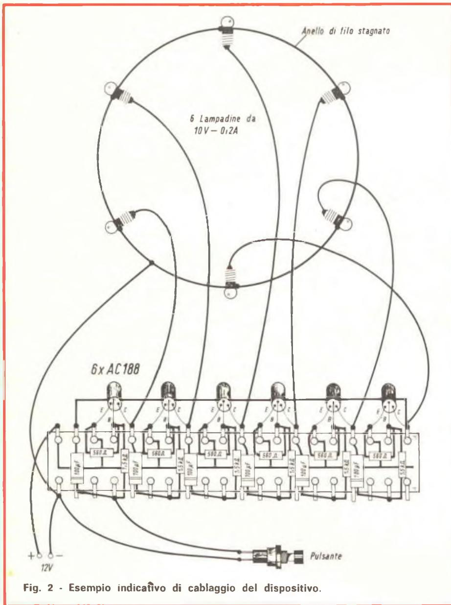
Fig. 2 - Esempio indicativo di cablaggio del dispositivo.
