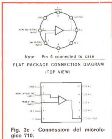
Fig. 3c - Connessioni del micrologico 710.
