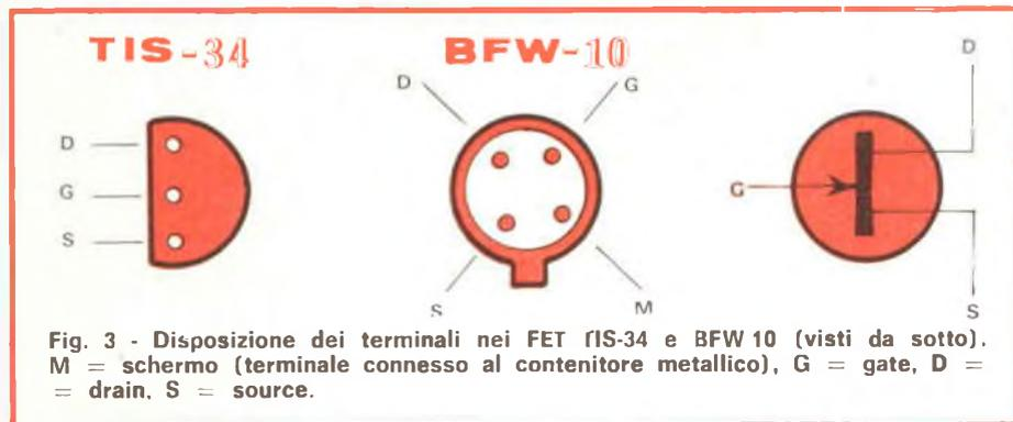
Fig. 3 - Disposizione dei terminali nei FET TIS-34 e BFW 10 (visti da sotto). M = schermo (terminale connesso al contenitore metallico), G = gate, D = drain, S = source.
