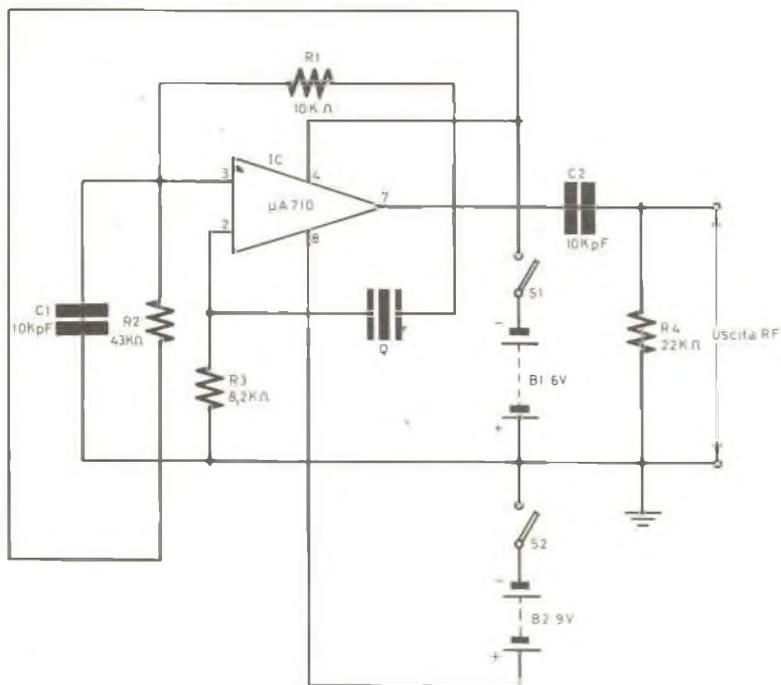
Fig. 2 - Schema elettrico del calibratore RF.
