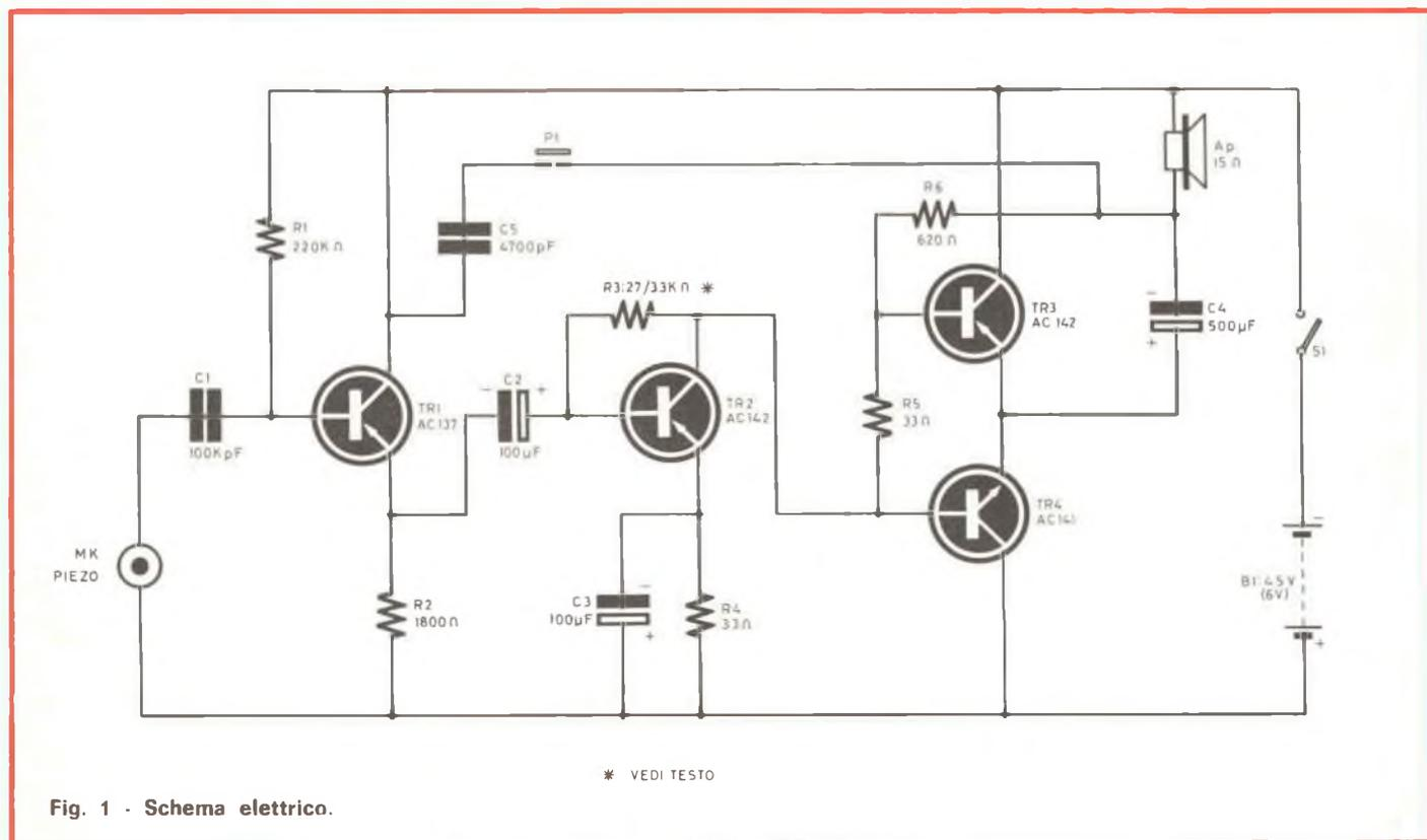
Fig. 1 - Schema elettrico.
