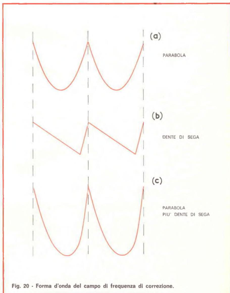
Fig. 20 - Forma d'onda del campo di frequenza di correzione.
