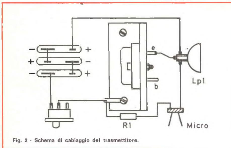
Fig. 2 - Schema di cablaggio del trasmettitore.
