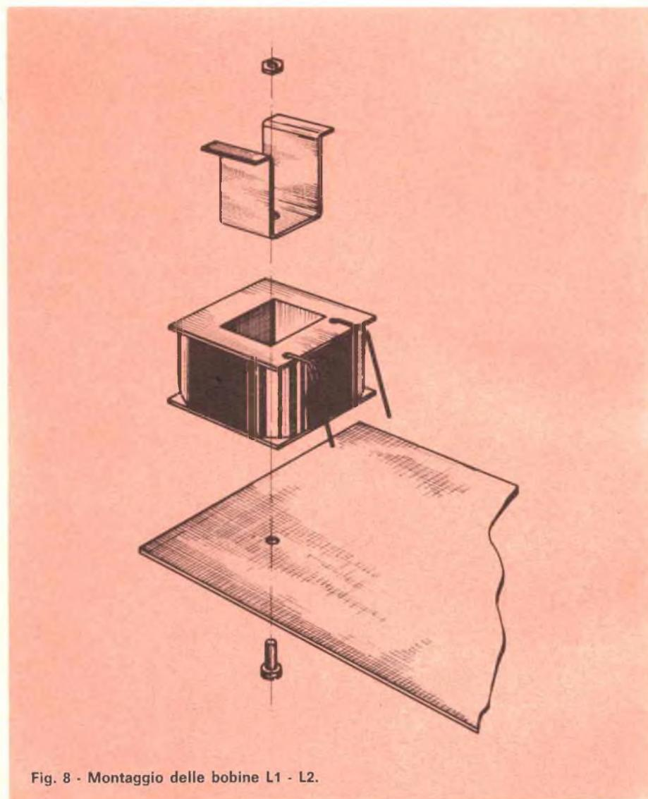
Fig. 8 - Montaggio delle bobine L1 - L2.
