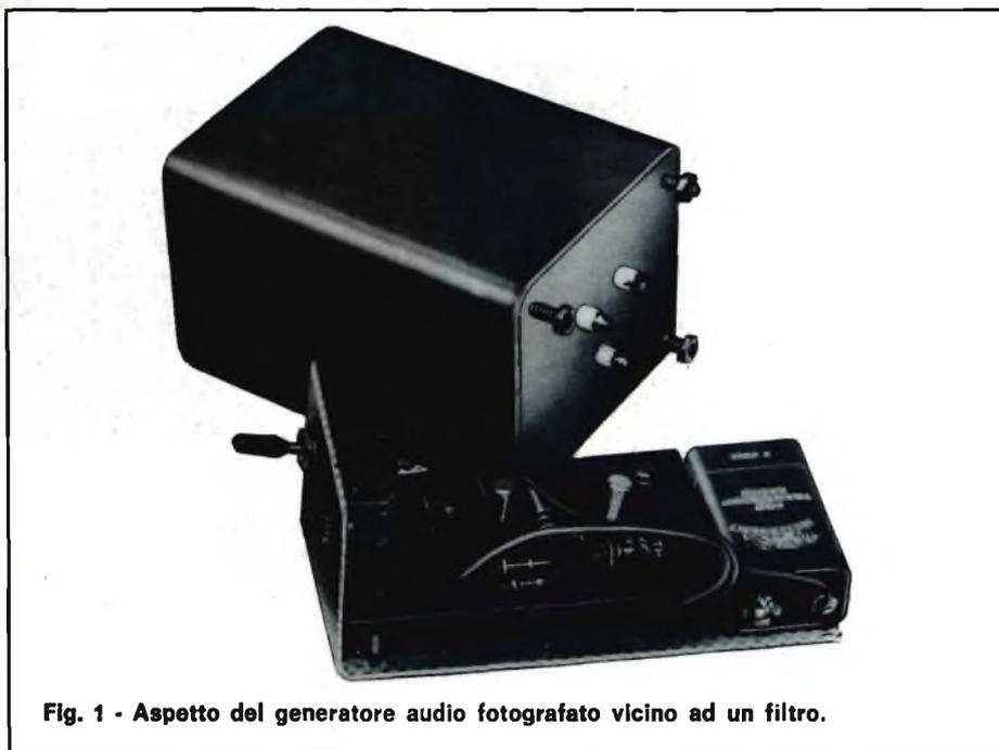
Fig. 1 - Aspetto del generatore audio fotografato vicino ad un filtro.
