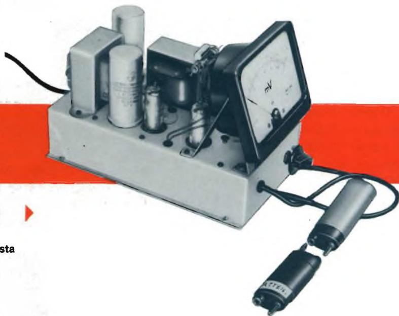
Fig. 1 - Ecco la disposizione di assieme dello chassis sperimentale del millivoltmetro. E' possibile notare la sonda, gli angolari di sostegno dello strumento le due EF 80, l'impedenza di filtro correttamente disposta ad angolo retto con il trasformatore di alimentazione. Di lato si nota la basetta con i diodi ed il circuito di controeazione da applicare allo strumento.
