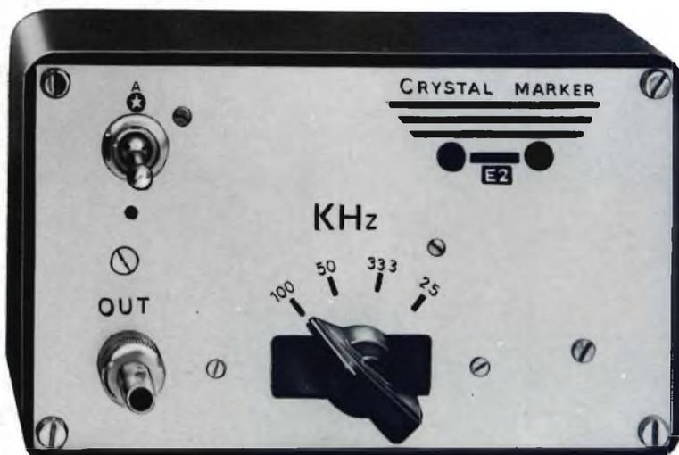
Fig. 1 - Generatore di segnali, campioni di frequenza da 25.000 Hz a 200 MHz. Fornisce impulsi, controllati a quarzo, con cadenza preselezionabile di 10, 20, 33 e 40  $\mu$ s. Dimensioni esterne: 51 x 96 x 159 millimetri.
