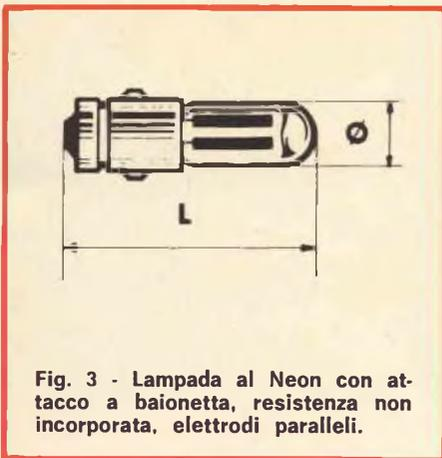
Fig. 3 - Lampada al Neon con attacco a baionetta, resistenza non incorporata, elettrodi paralleli.
