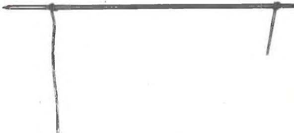
Fig. 3c - Mine «dure» del tipo 3+6 H, possono servire per realizzare resistori semifissi del valore massimo pari a 20-30Ω. Quello qui illustrato (mina 4H) ha un valore massimo di 26 Ω.
