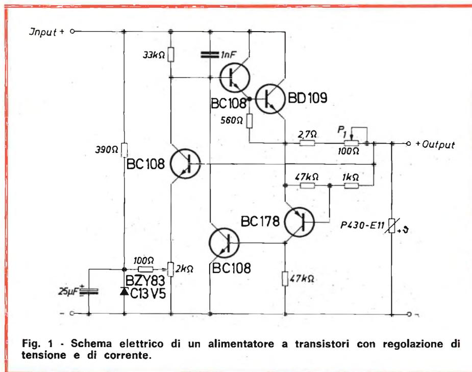
Fig. 1 - Schema elettrico di un alimentatore a transistori con regolazione di tensione e di corrente.
