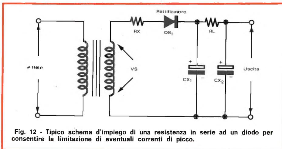
Fig. 12 - Tipico schema d'impiego di una resistenza in serie ad un diodo per consentire la limitazione di eventuali correnti di picco.
