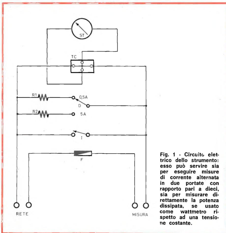
Fig. 1 - Circuito elettrico dello strumento: esso può servire sia per eseguire misure di corrente alternata in due portate con rapporto pari a dieci, sia per misurare direttamente la potenza dissipata, se usato come wattmetro rispetto ad una tensione costante.
