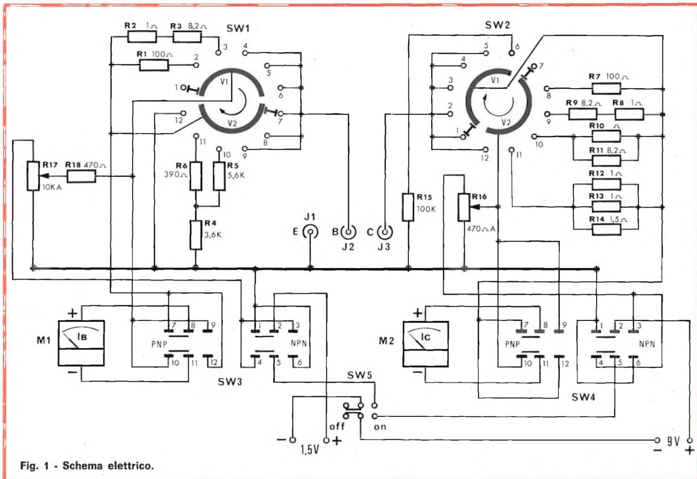
Fig. 1 - Schema elettrico.
