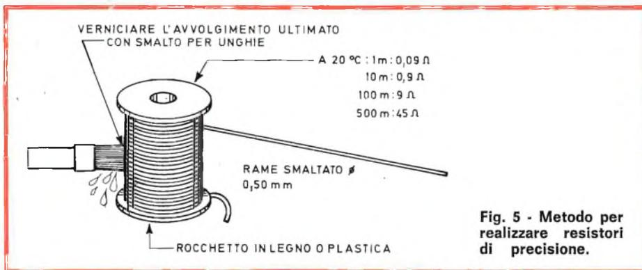
Fig. 5 - Metodo per realizzare resistori di precisione.
