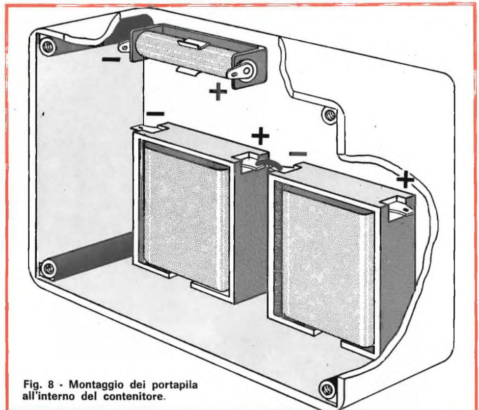
Fig. 8 - Montaggio dei portapila all'interno del contenitore.
