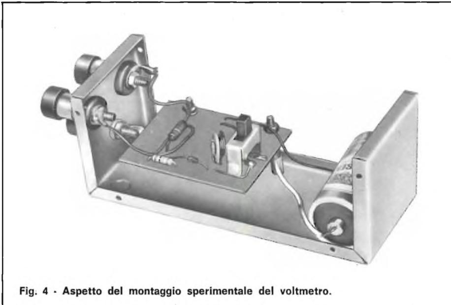
Fig. 4 - Aspetto del montaggio sperimentale del voltmetro.
