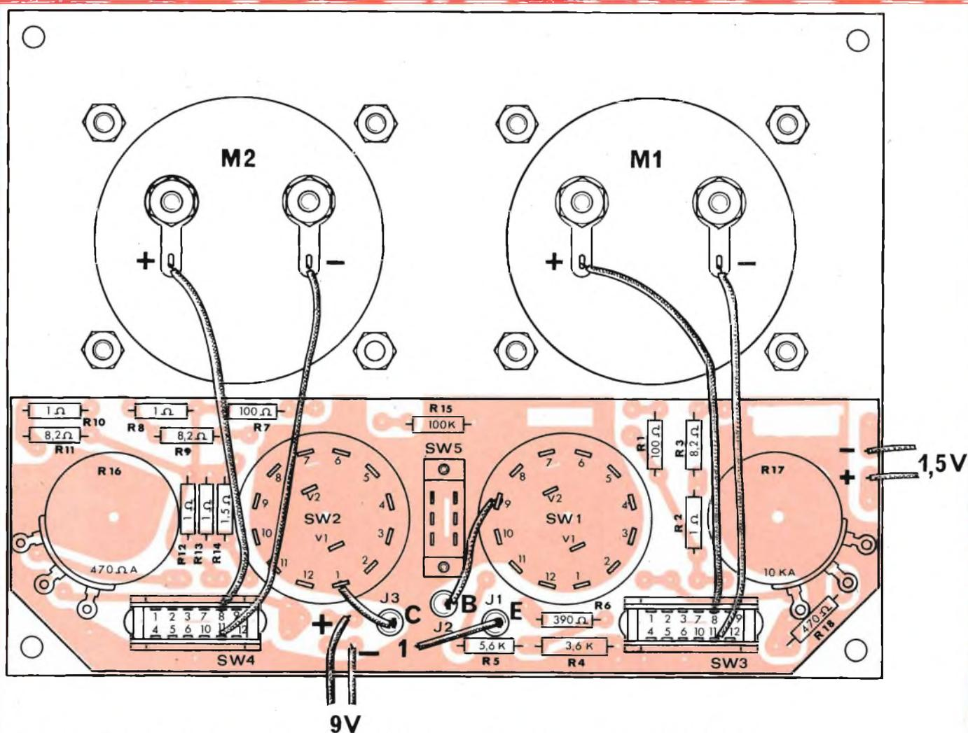
Fig. 6 - Collegamenti degli strumenti M1-M2, delle prese J1-J2-J3 e delle batterie di alimentazione.
