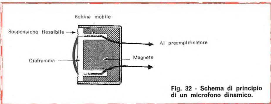
Fig. 32 - Schema di principio di un microfono dinamico.
