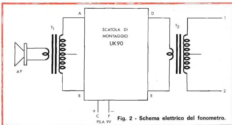
Fig. 2 - Schema elettrico del fonometro.
