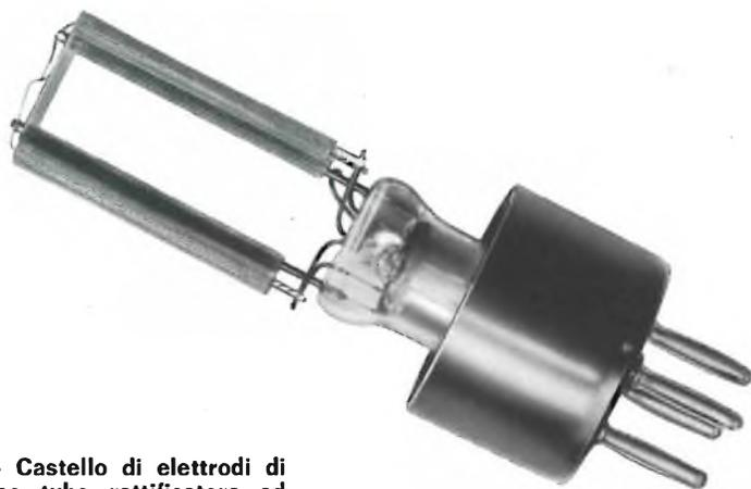
Fig. 1 - Castello di elettrodi di un tipico tubo rettificatore ad alto vuoto.
