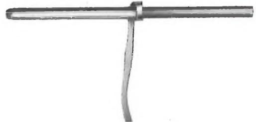
Fig. 3e - Per realizzare resistori di valori molto bassi (frazioni di ohm) conviene l'uso del carbone per saldatura elettrica. Questi elettrodi, per altro, sono rivestiti di una pellicola di rame che nel nostro caso va asportata.
