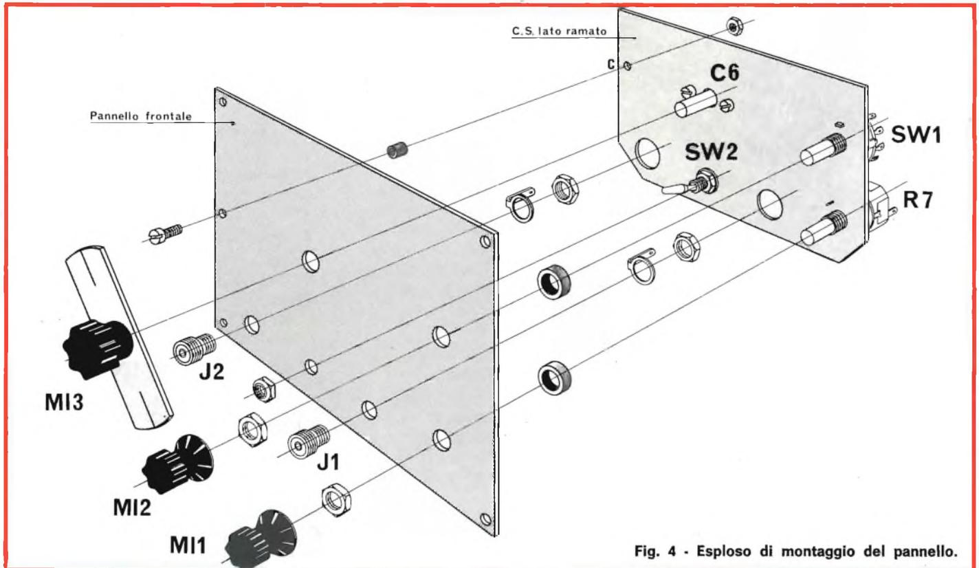
Fig. 4 - Esploso di montaggio del pannello.
