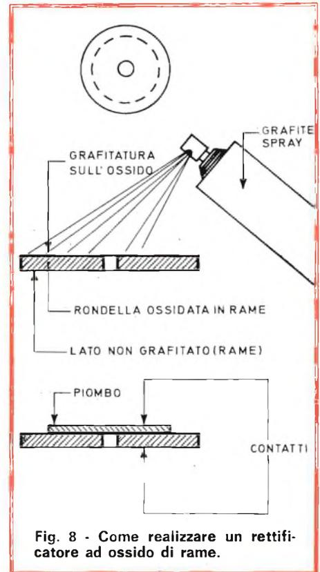
Fig. 8 - Come realizzare un rettificatore ad ossido di rame.
