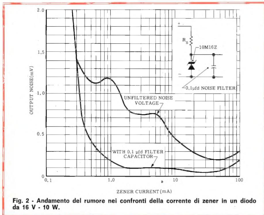
Fig. 2 - Andamento del rumore nei confronti della corrente di zener in un diodo da 16 V - 10 W.
