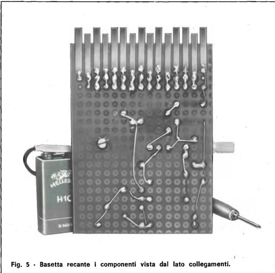
Fig. 5 - Basetta recante i componenti vista dal lato collegamenti.
