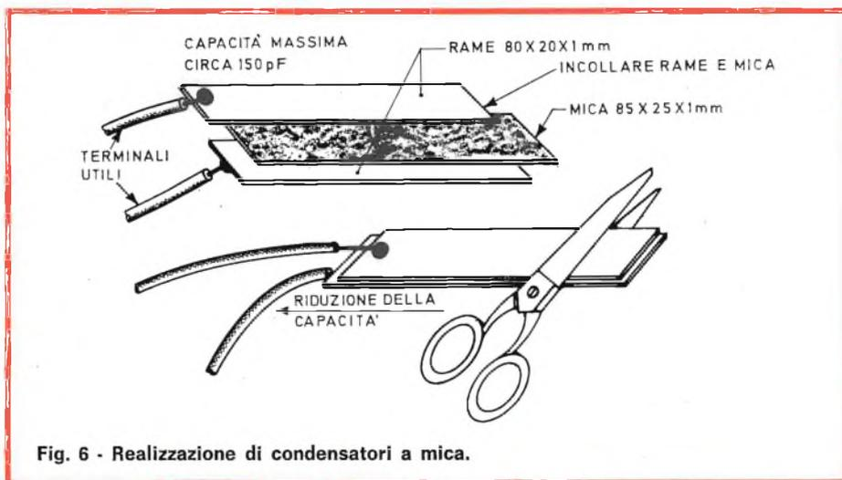
Fig. 6 - Realizzazione di condensatori a mica.
