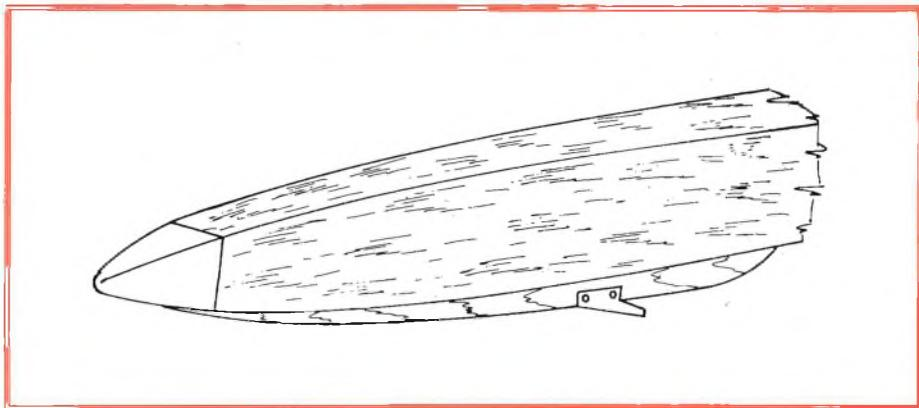
Fig. 1 - Esempio di pattino d'atterraggio usato per i veleggiatori.
