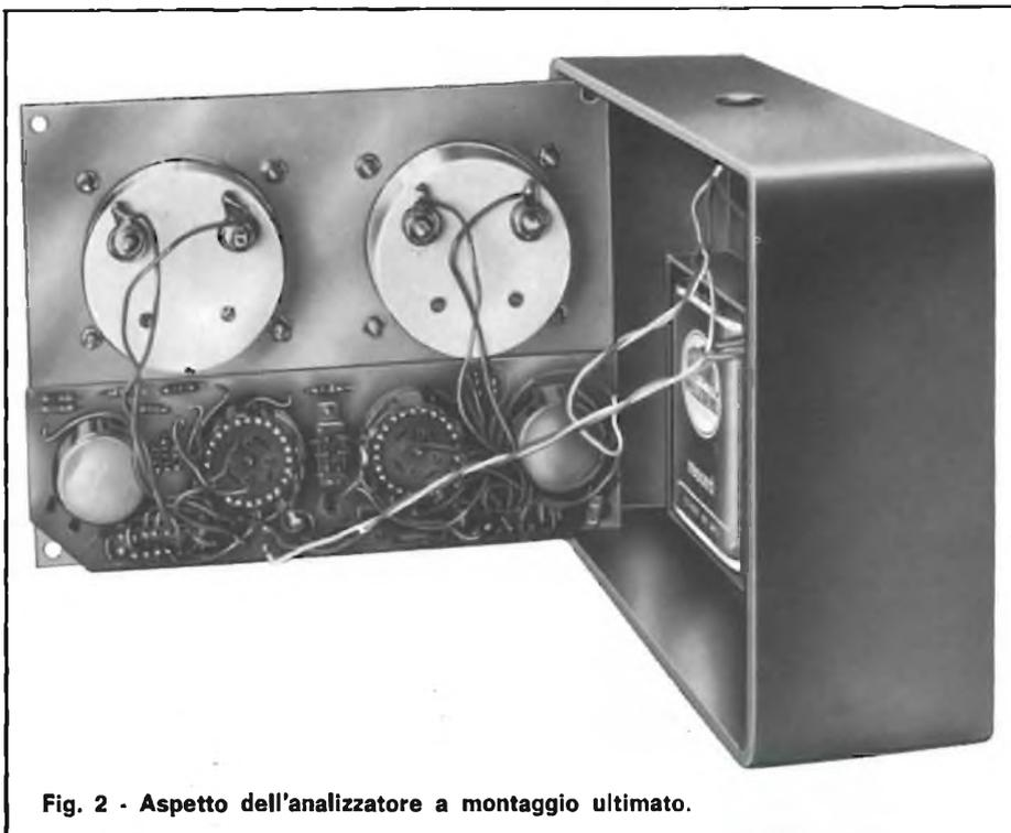
Fig. 2 - Aspetto dell'analizzatore a montaggio ultimato.
