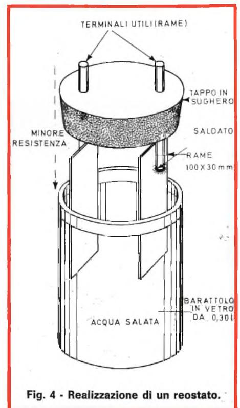
Fig. 4 - Realizzazione di un reostato.
