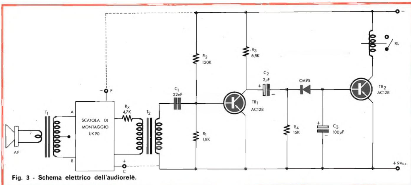
Fig. 3 - Schema elettrico dell'audiorelè.
