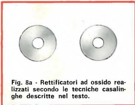
Fig. 8a - Rettificatori ad ossido realizzati secondo le tecniche casalinghe descritte nel testo.
