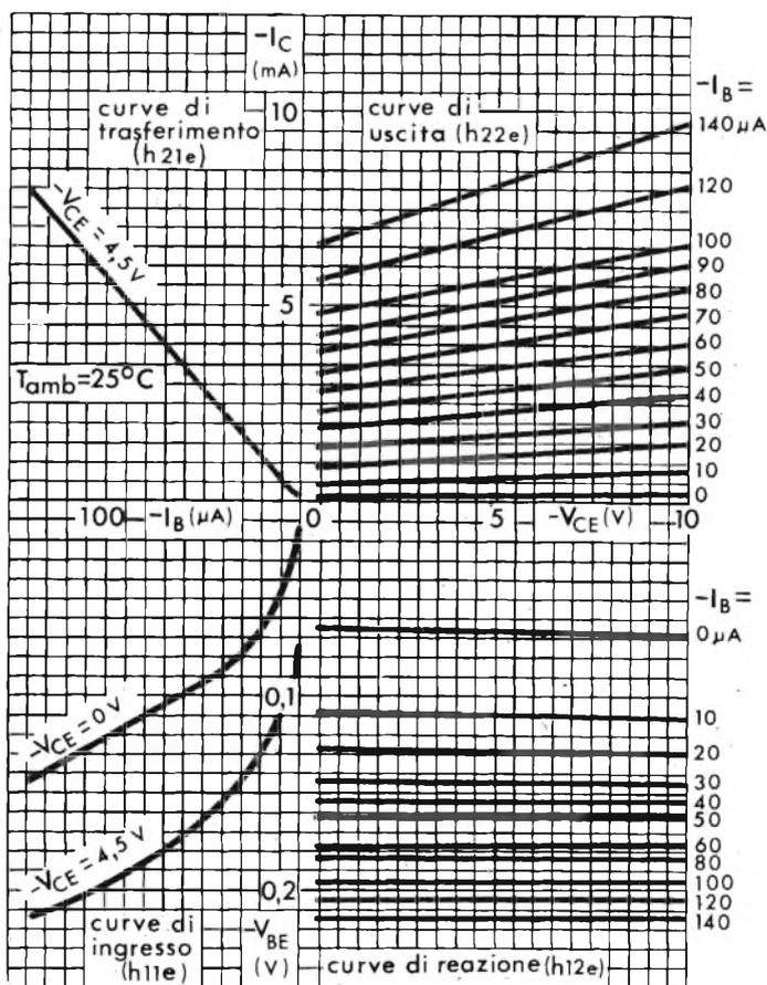
Fig. 11 - Curve caratteristiche di un transistor.
