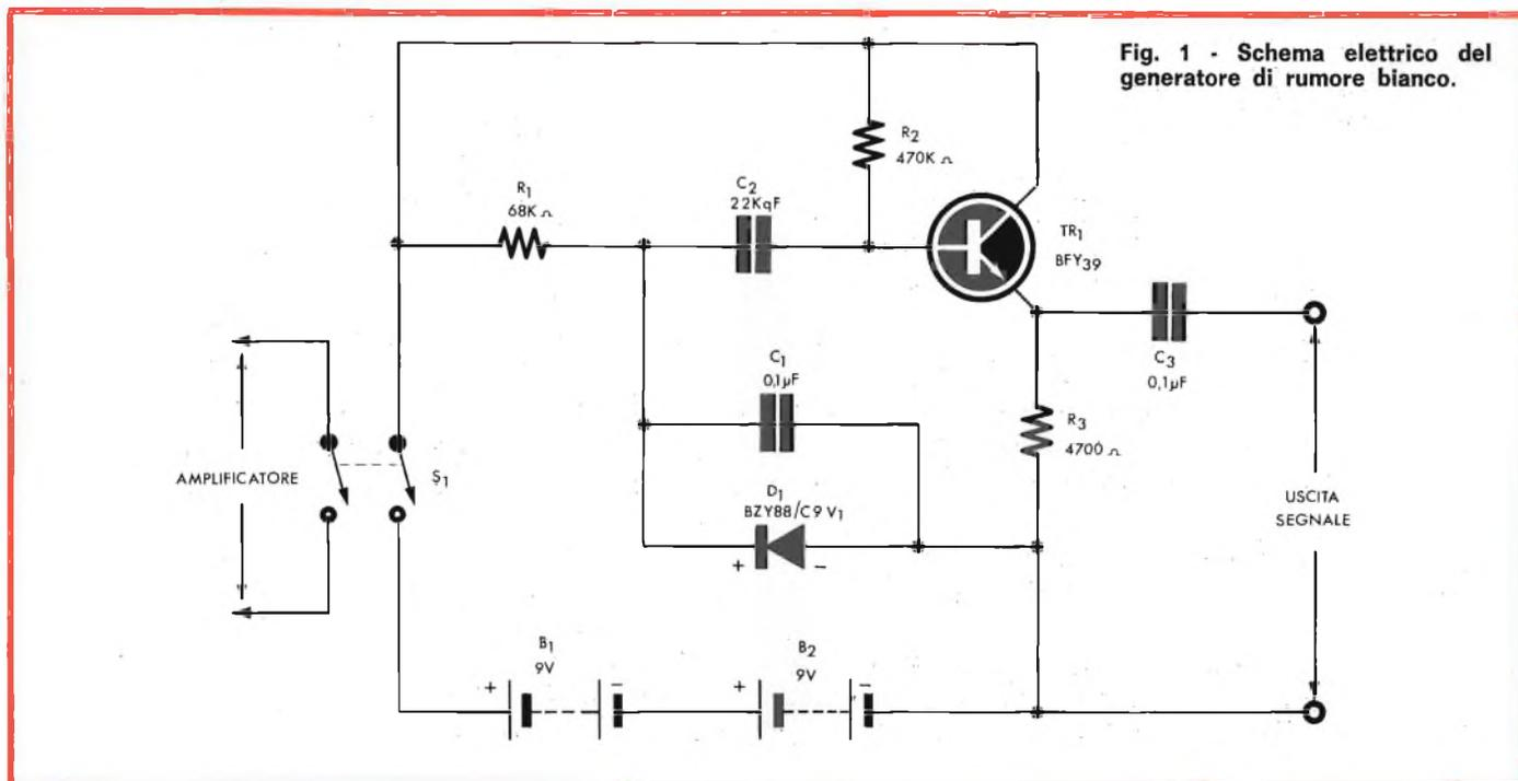
Fig. 1 - Schema elettrico del generatore di rumore bianco.
