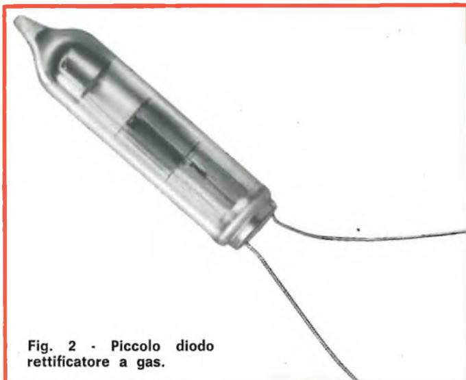
Fig. 2 - Piccolo diodo rettificatore a gas.
