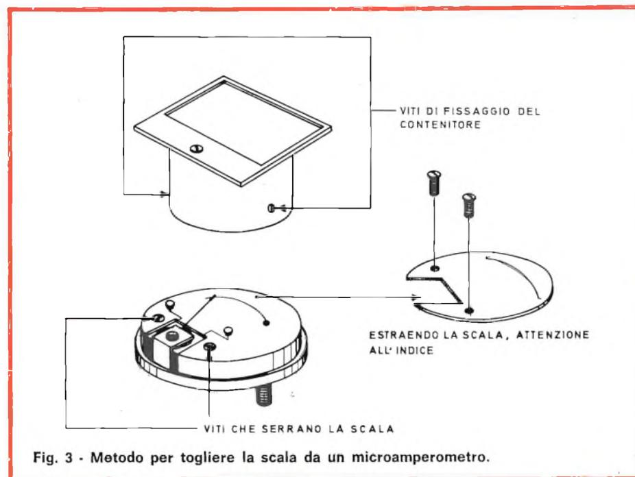
Fig. 3 - Metodo per togliere la scala da un microamperometro.
