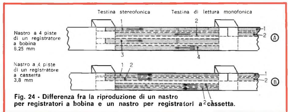
Fig. 24 - Differenza fra la riproduzione di un nastro per registratori a bobina e un nastro per registratori a cassetta.
