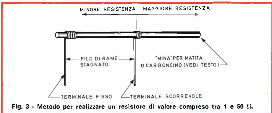
Fig. 3 - Metodo per realizzare un resistore di valore compreso tra 1 e 50 Ω.
