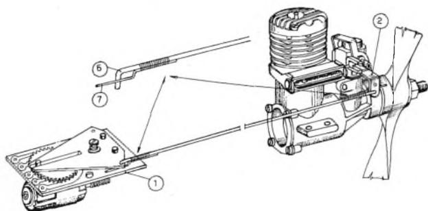
Fig. 3 - Applicazione pratica di servocomando meccanico.
