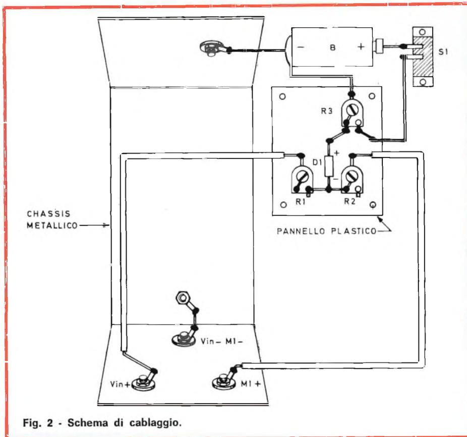
Fig. 2 - Schema di cablaggio.
