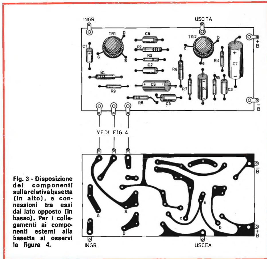
Fig. 3 - Disposizione dei componenti sulla relativa basetta (in alto), e connessioni tra essi dal lato opposto (in basso). Per i collegamenti ai componenti esterni alla basetta si osservi la figura 4.
