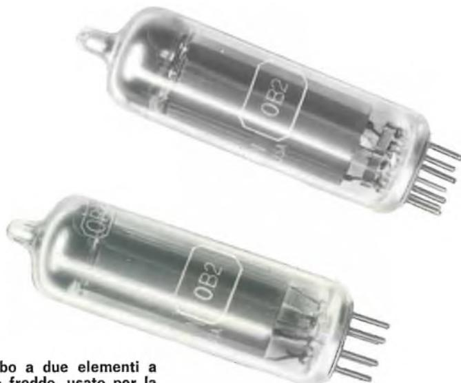
Fig. 7 - Tubo a due elementi a gas, catodo freddo, usato per la stabilizzazione di tensione.
