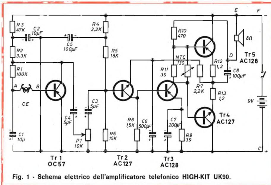
Fig. 1 - Schema elettrico dell'amplificatore telefonico HIGH-KIT UK90.
