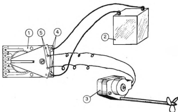
Fig. 4 - Applicazione pratica di servocomando elettrico.
