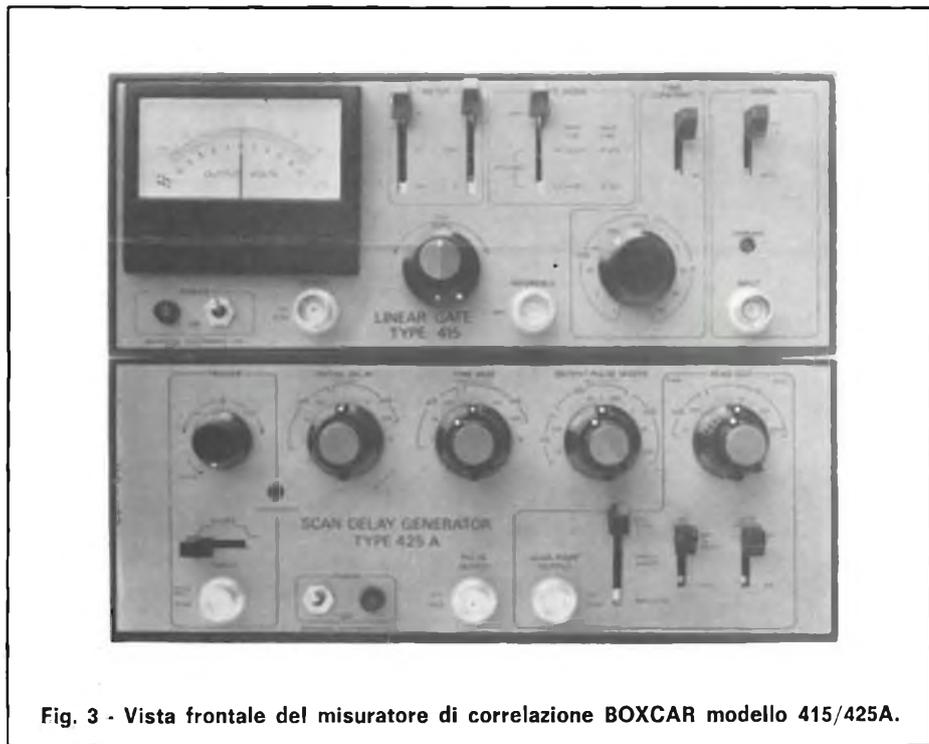
**Fig. 3 - Vista frontale del misuratore di correlazione BOXCAR modello 415/425A.**
