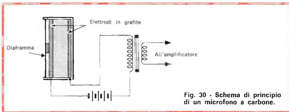
Fig. 30 - Schema di principio di un microfono a carbone.
