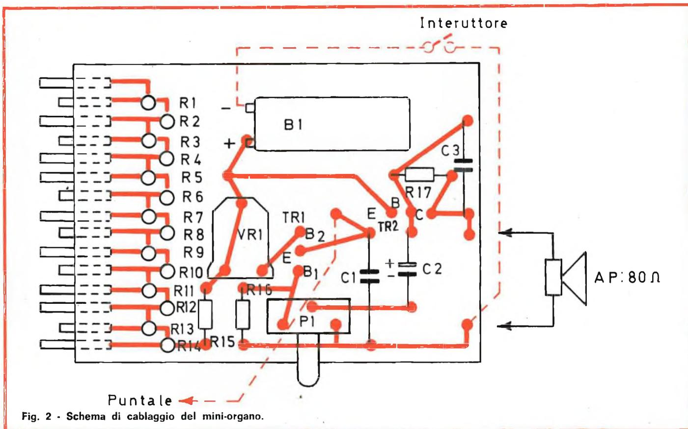
Con una regolazione del volume al massimo il consumo della batteria da 9 V è di soli 15 mA.
