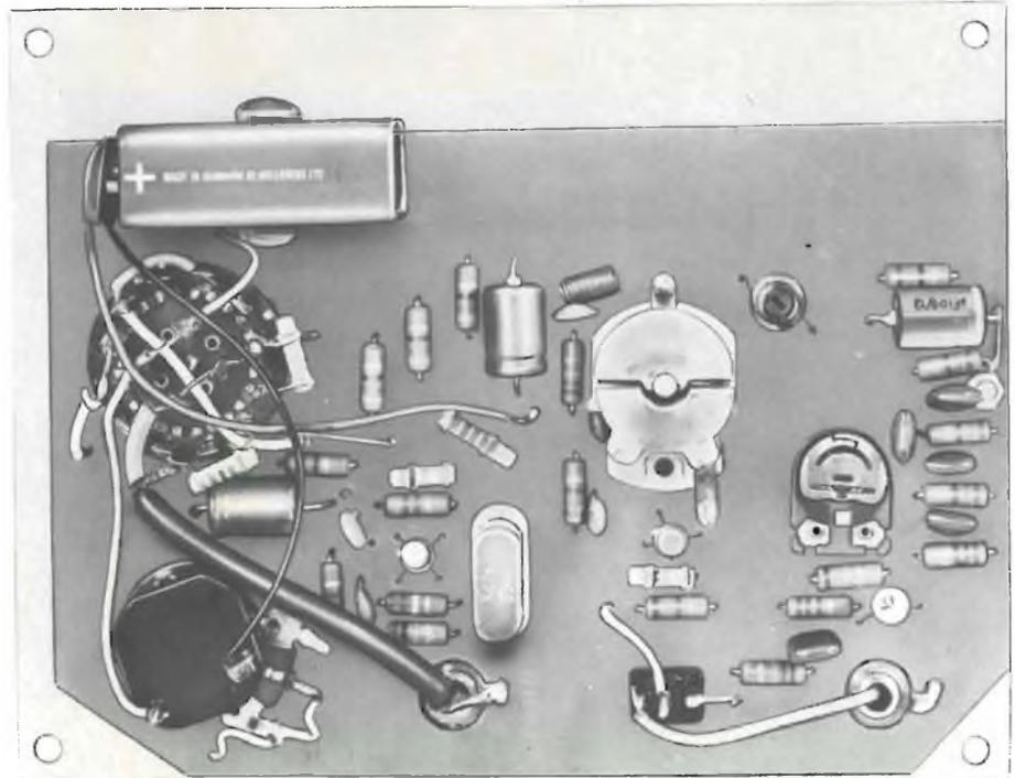
Fig. 2 - Il generatore marker a montaggio ultimato.
