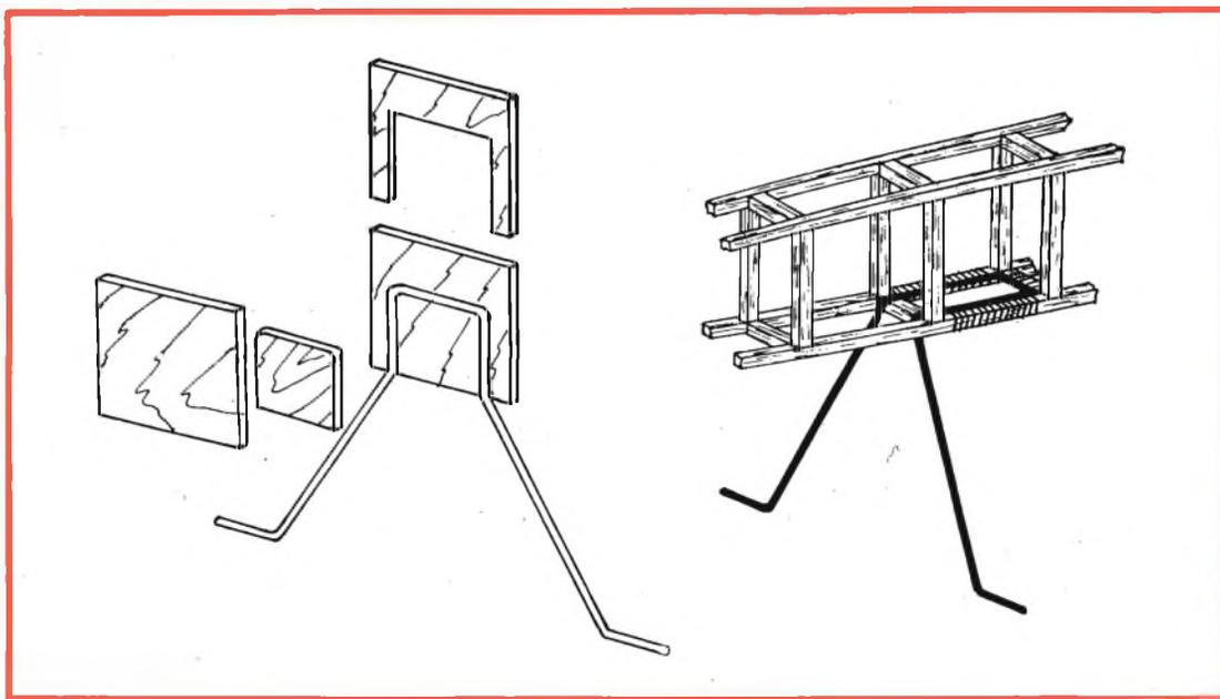
Fig. 3 - Esempio di fissaggio del carrello al modello.
