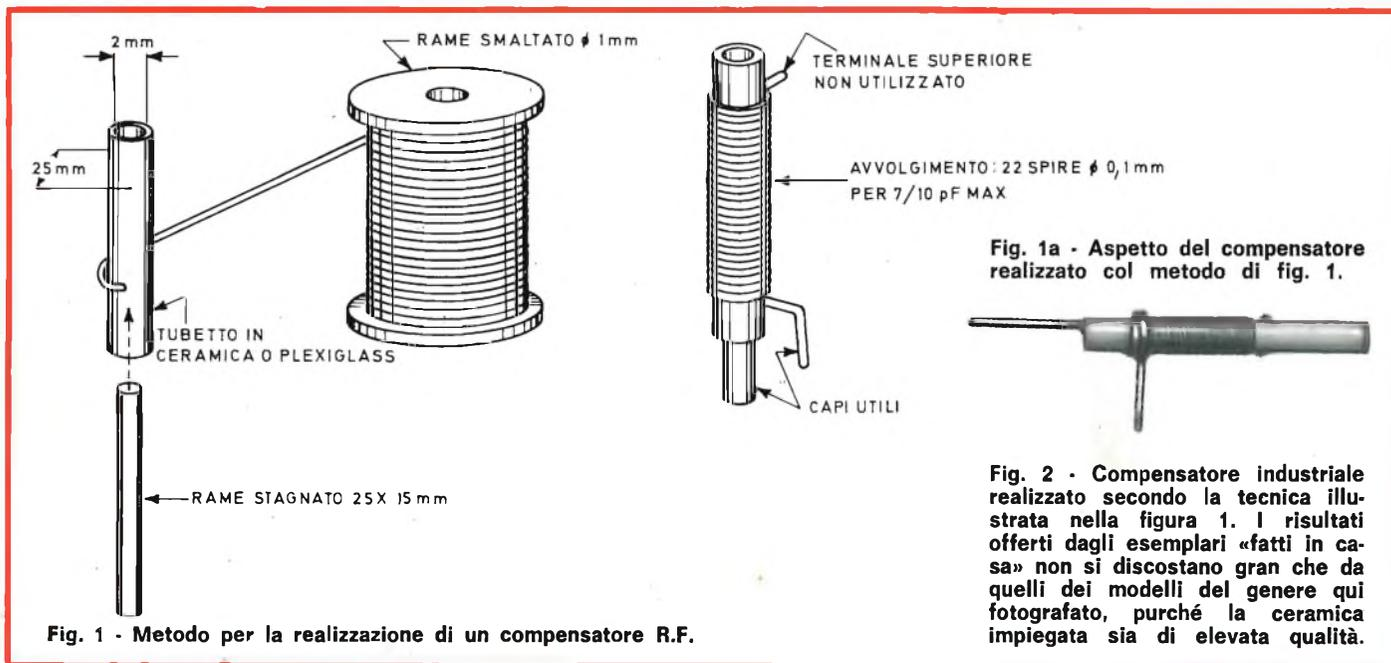
Fig. 1a - Aspetto del compensatore realizzato col metodo di fig. 1.
