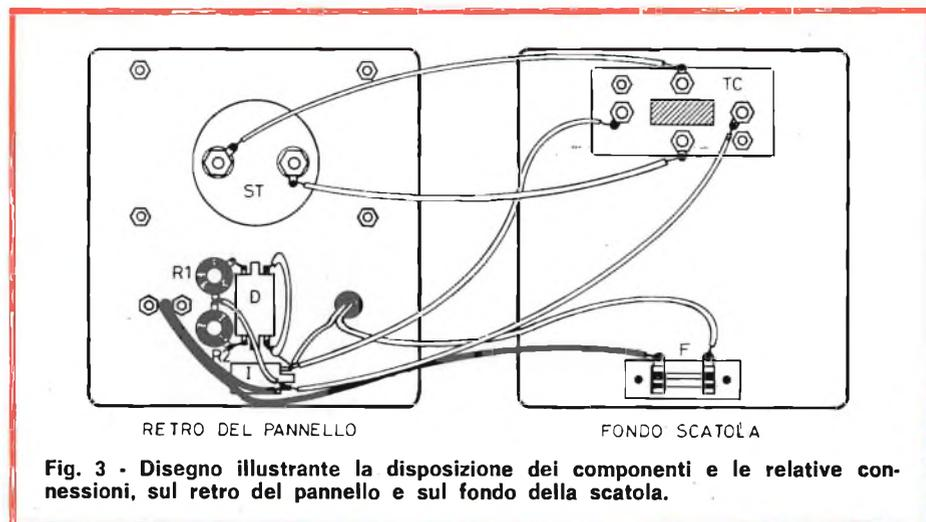
Fig. 3 - Disegno illustrante la disposizione dei componenti e le relative connessioni, sul retro del pannello e sul fondo della scatola.
