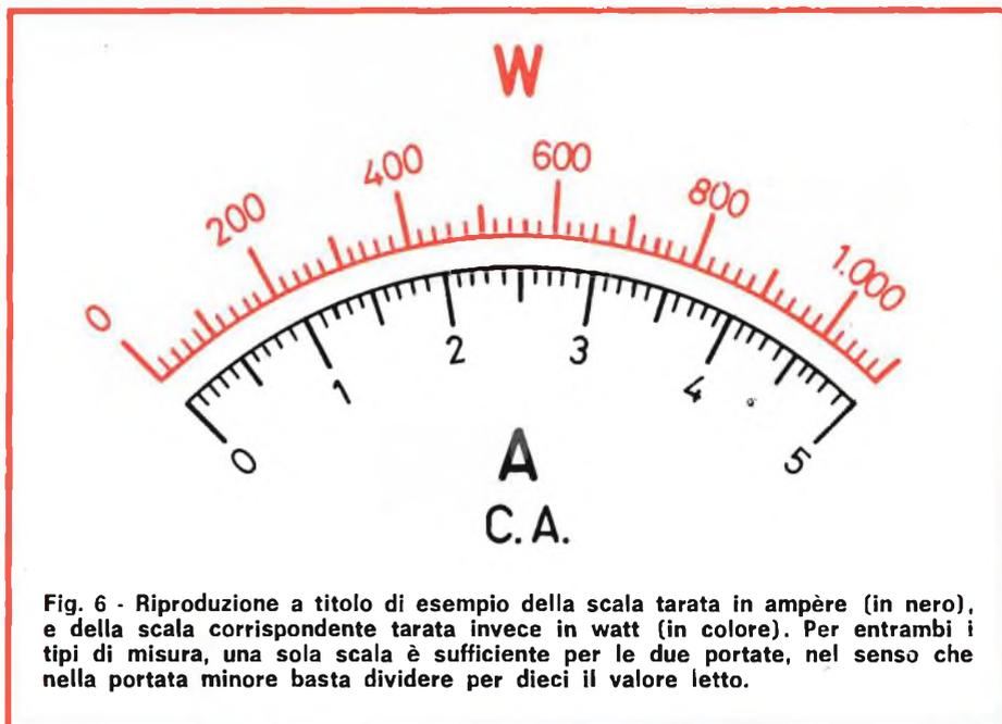
Fig. 6 - Riproduzione a titolo di esempio della scala tarata in ampère (in nero), e della scala corrispondente tarata invece in watt (in colore). Per entrambi i tipi di misura, una sola scala è sufficiente per le due portate, nel senso che nella portata minore basta dividere per dieci il valore letto.
