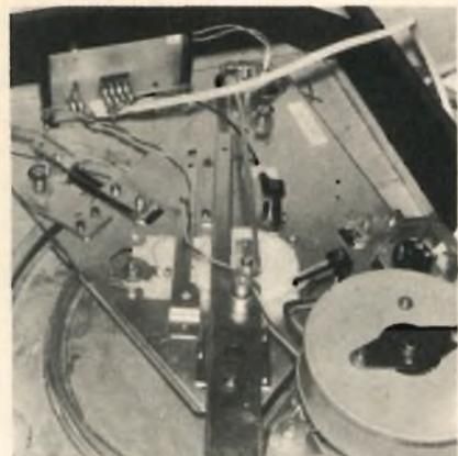
Fig. 12 - Foto illustrante un particolare di un giradischi con cambio dischi automatico, munito di dispositivo di arresto automatico, e di ritorno alla posizione di riposo del braccio che contiene la testina.
