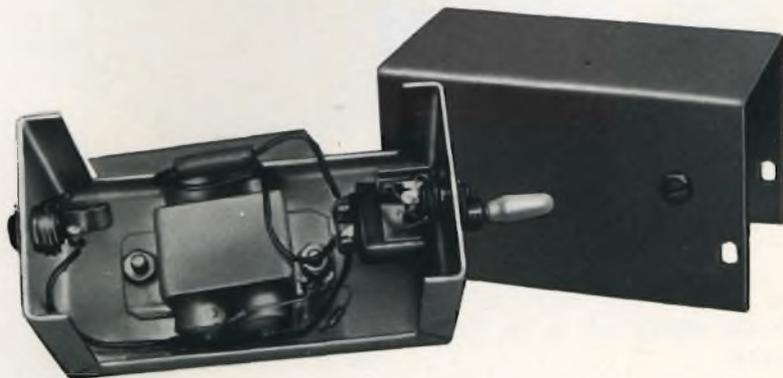
Fig. 3 - Aspetto interno del limitatore di disturbi a montaggio ultimato.
