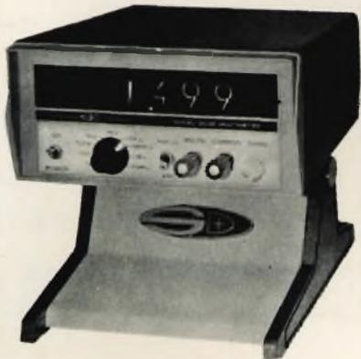
Fig. 2 - Voltmetro ohmetro digitale a 4 cifre Sytron-Donner mod. 9015.
