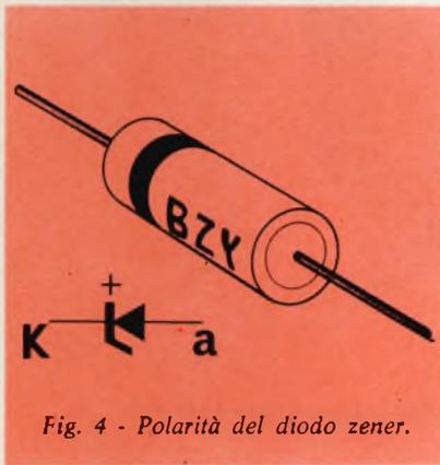
Fig. 4 - Polarità del diodo zener.
