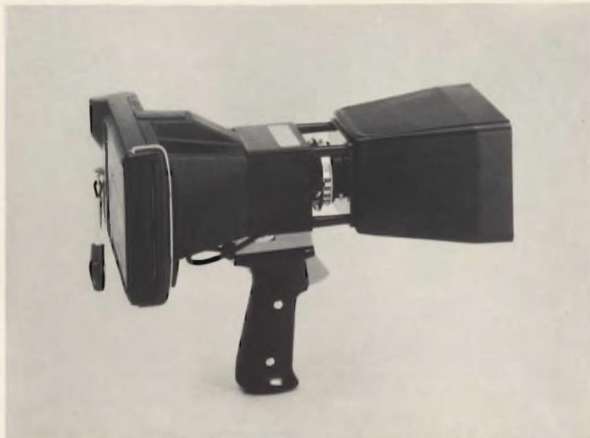
Aspetto della nuova Polaroid CR-9 con innestato uno degli adattori per schermi oscilloscopici.
