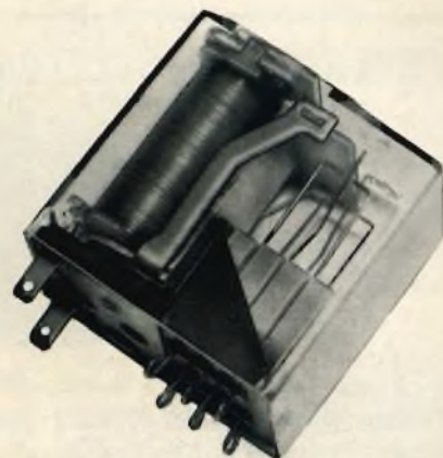
Fig. 10 - Dettagli del micro-relè a 12 V di tipo specialissimo e di costo veramente modesto, che si presta a realizzare commutazioni a Radiofrequenza con bassa capacità fra i terminali e con una notevole corrente (1A) con protezione in coppa plastica.
