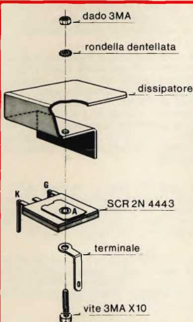
Fig. 3 - Esploso di montaggio dell'SCR.
