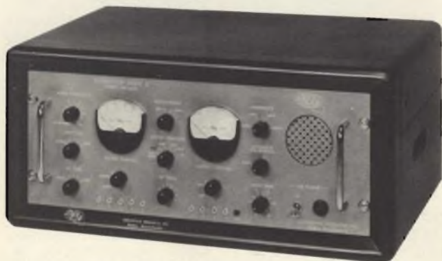
Fig. 2 - Un misuratore della intensità di campo elettromagnetico ad elevata sensibilità ed ultra stabilità per la gamma 3-250 MHz costruito dalla Aerospace Research Inc. di Boston.
