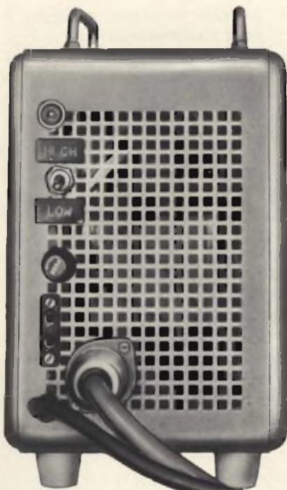
Fig. 2 - Vista posteriore dell'alimentatore. Si noti l'attacco per l'altoparlante interno, il morsetto di massa, il porta fusibili ed il commutatore che permette in posizione di «High» o «Low» di alimentare rispettivamente più o meno lo stadio finale del trasmettitore nonché lo zoccolo per la connessione al RX-TX.
