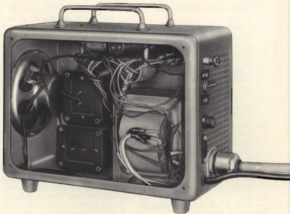
Fig. 3 - Vista interna delle connessioni e della disposizione dei componenti. Si noti la rotazione fra loro degli assi dei nuclei del trasformatore di alimentazione e impedenze di filtro per evitare accoppiamenti magnetici fonti di rumori di fondo.
