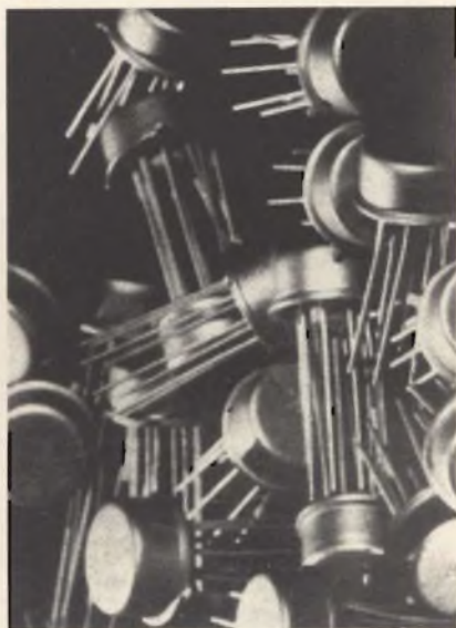
Fig. 1 - Fotografia illustrante alcuni modelli di circuiti integrati, del tipo di comune impiego per la realizzazione delle sezioni audio e di cromaticità nei moderni ricevitori televisivi a colori o in bianco e nero.
