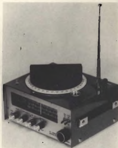
Fig. 2 - Fotografia di un radiogoniometro portatile funzionante nelle gamme 190-420 kHz (radiofari), 500-1400 kHz (radiodiffusione) 1400-3500 kHz (onde marine) alimentato a 12 V, della Finder.
