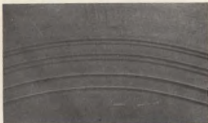
Danno causato da una tensione inco- stante.
