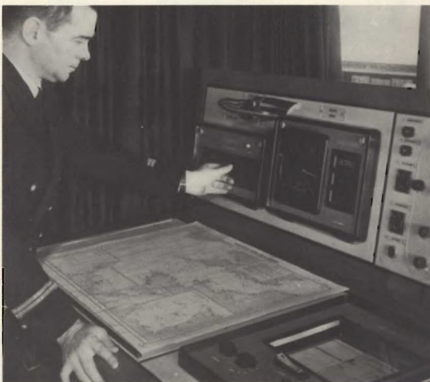
Fig. 7 - Ecoscandaglio ultrasonoro SIMRAD per misure del fondo marino.
