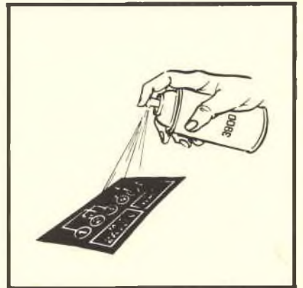
Fig. 17 - Successivamente si deve fissare e proteggere con l'apposito spray 3900.
