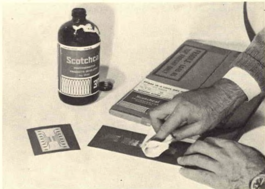
Fig. 23 - Una leggerissima pressione ed un tampone molto imbevuto dell'apposito sviluppo sono sufficienti per un corretto procedimento.
