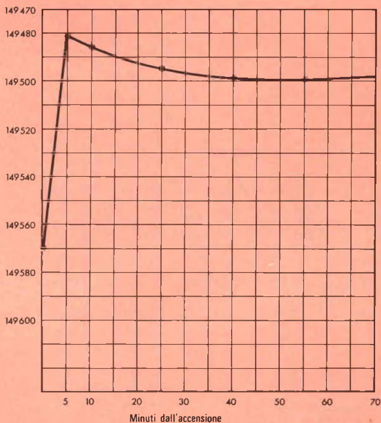
Fig. 55 - Grafico della stabilità di frequenza, sulla gamma A, in funzione del tempo.
