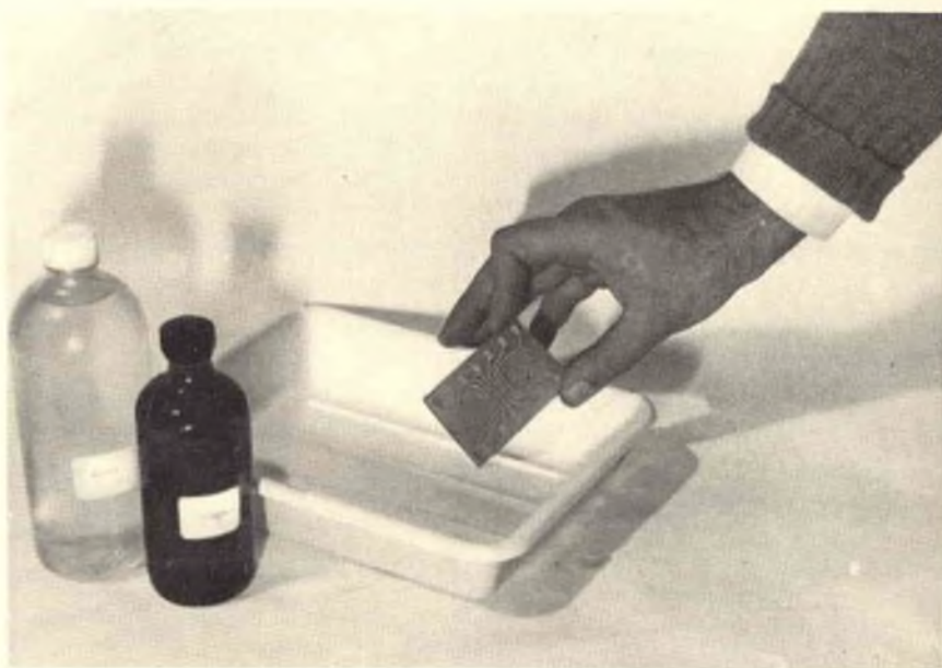
Fig. 13 - Il kit CS53 permette d'argentare perfettamente le superfici metalliche immerse nei suoi due liquidi, come descritto ampiamente nell'articolo.
