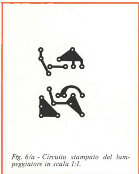
Fig. 6/a - Circuito stampato del lampeggiatore in scala 1:1.
