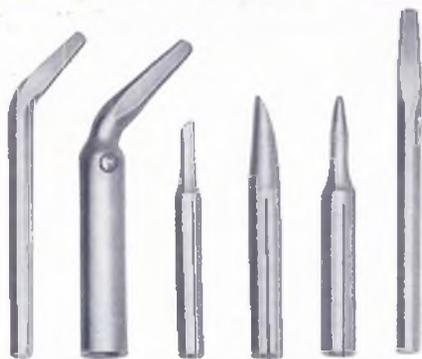
Le punte Ersadur sono costruite in rame purissimo, ricoperto galvanicamente con più strati di metallo protettivo. Il corpo è cromato per evitare la corrosione, la punta stagnata.
