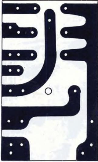
Fig. 6-B - La basetta a circuito stampato, di tipo molto semplice, sulla quale viene montato il circuito di figura 4.
