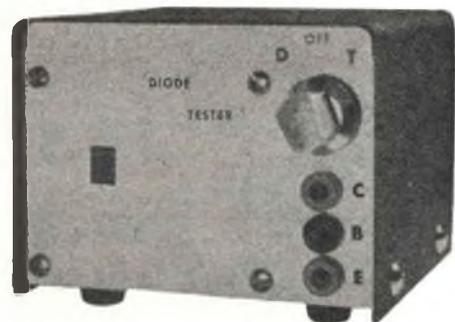
Fig. 6 - Al termine delle operazioni di costruzione, il dispositivo per la prova di diodi digitali può assumere l'aspetto qui illustrato.
