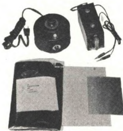
Il kit fornibile da Edmund Scientific Co include un trasformatore variabile da 3-8 V, una bobina di induzione ad alta tensione, un elettrodo piano di alluminio, un dielettrico piano di vetro e un sacco da fotografo da usare come camera oscura portatile.
