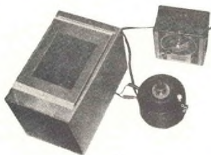
L'elettrodo con la piastra di vetro che lo ricopre sono fissate alla sommità della scatola di cartone usata per spedire il kit. Per sicurezza la bobina di induzione è posta dentro la scatola. Un fototimer (non incluso nel kit Edmund) è un accessorio conveniente quando si devono fare serie di fotografie da confrontare.
