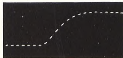
Responso dell'amplificatore ai segnali rettangolari a diverse frequenze (da 40 a 20.000 Hz)
