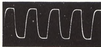
Responso dell'amplificatore ai segnali rettangolari a diverse frequenze (da 40 a 20.000 Hz)
