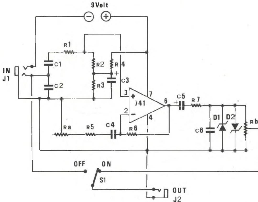
Fig. 1 - Schema elettrico del distorsore per chitarra.
