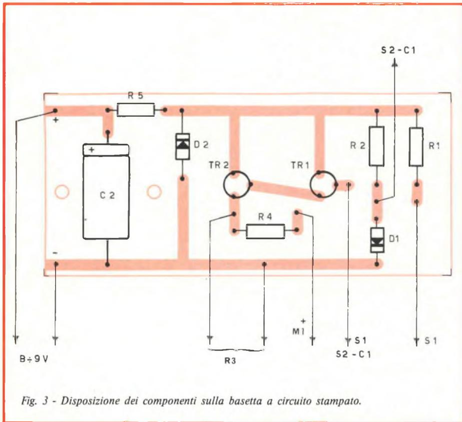
Fig. 3 - Disposizione dei componenti sulla basetta a circuito stampato.
