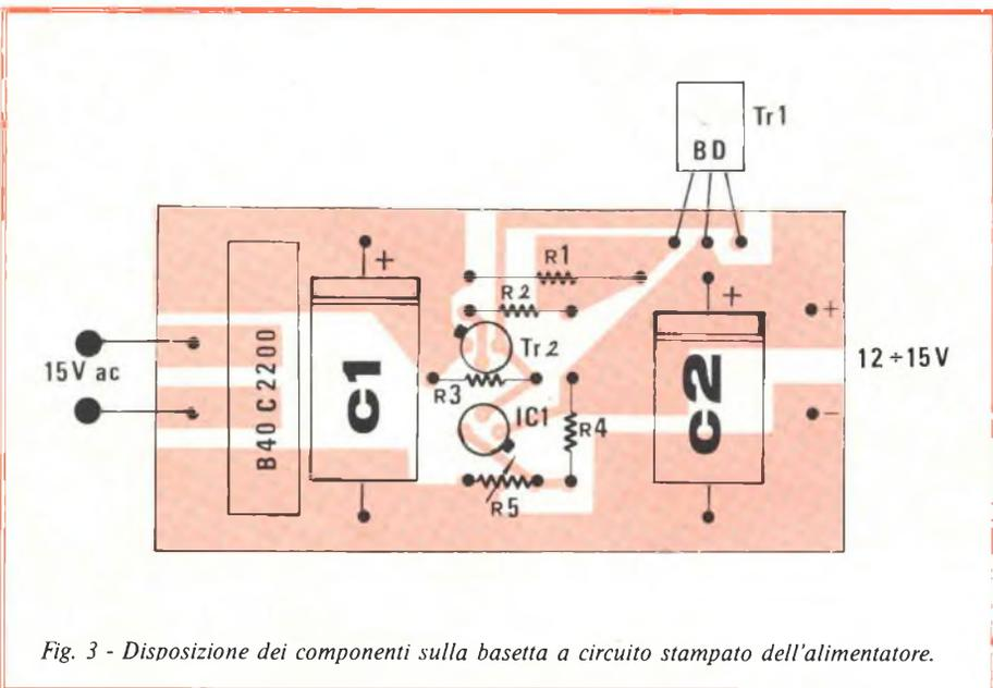
Fig. 3 - Disposizione dei componenti sulla basetta a circuito stampato dell'alimentatore.
