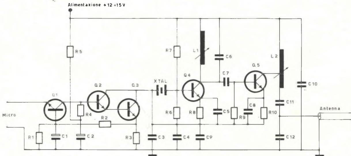
Fig. 2 - Schema elettrico del trasmettitore CB.
