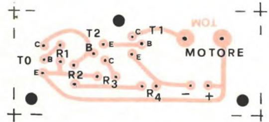
Fig. 3 - Disposizione dei componenti sulla bassetta a circuito stampato.
