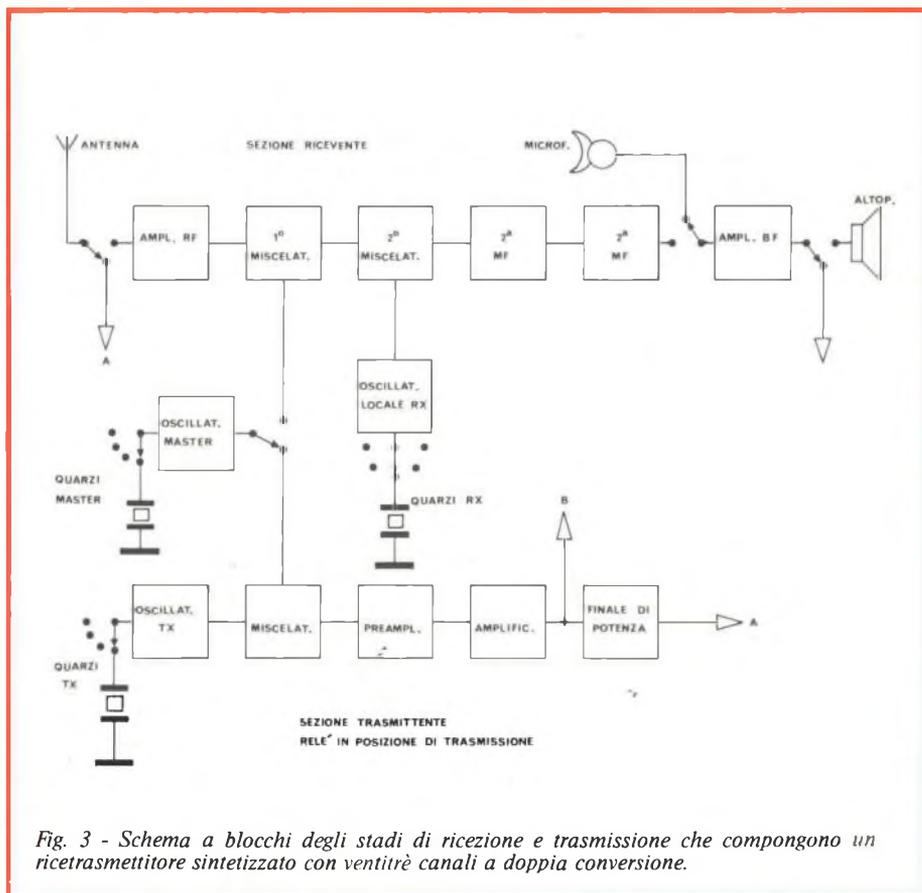
Fig. 3 - Schema a blocchi degli stadi di ricezione e trasmissione che compongono un ricetrasmittitore sintetizzato con ventitré canali a doppia conversione.
