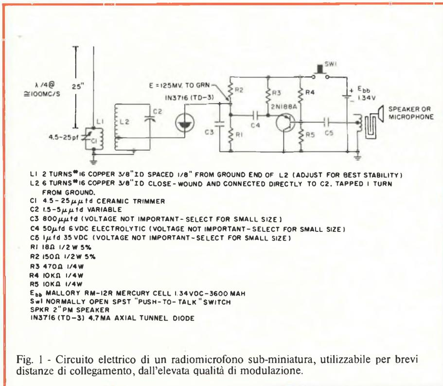
Fig. 1 - Circuito elettrico di un radiomicrofono sub-miniatura, utilizzabile per brevi distanze di collegamento, dall'elevata qualità di modulazione.
