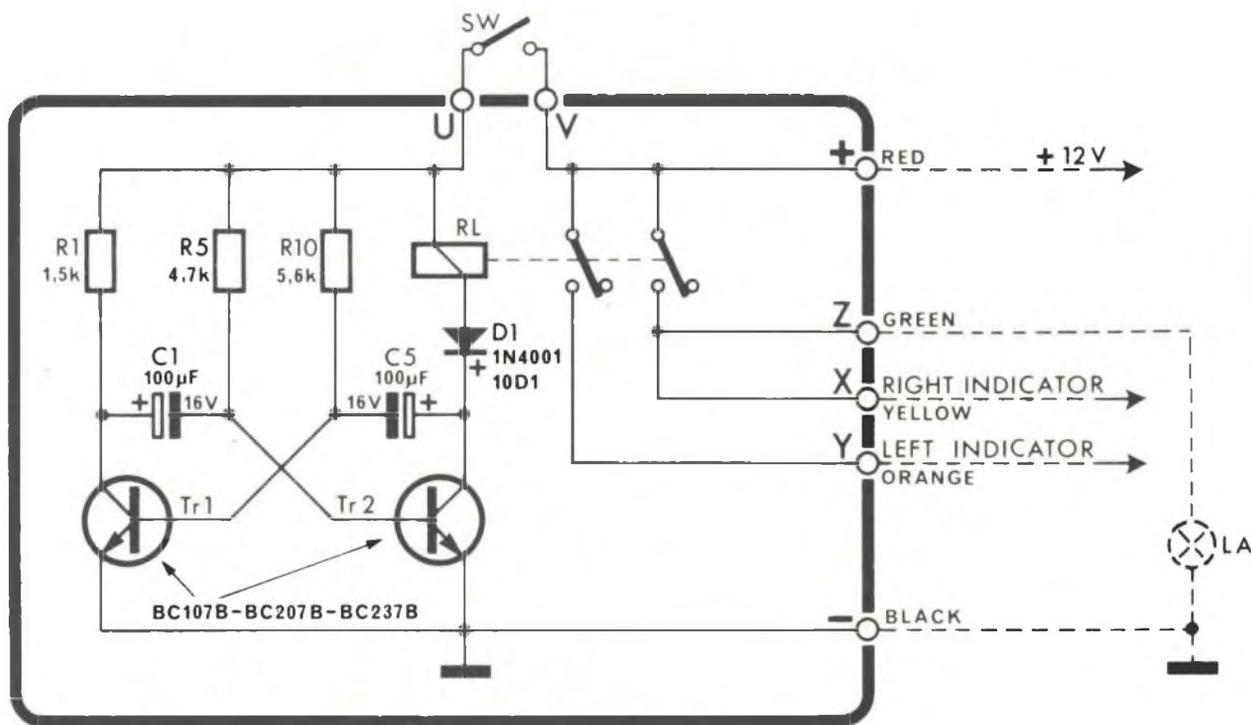
Fig. 1 - Schema elettrico del lampeggiatore elettronico di emergenza.
