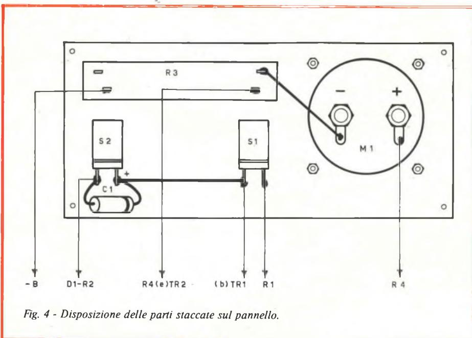
Fig. 4 - Disposizione delle parti staccate sul pannello.
