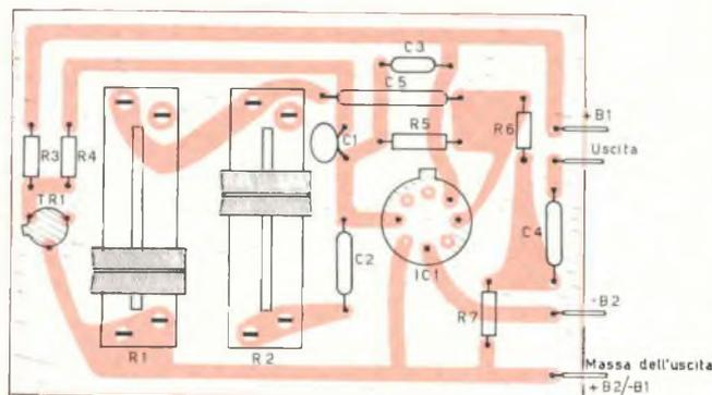
Fig. 3 - Disposizione dei componenti sulla base e a circuito stampato.
