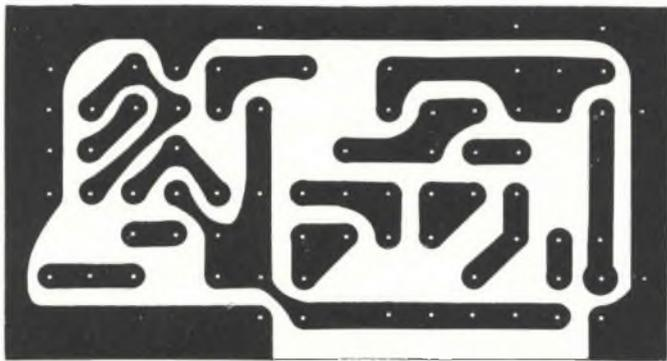
Fig. 3 - Basetta circuito stampato in scala 1:1.
