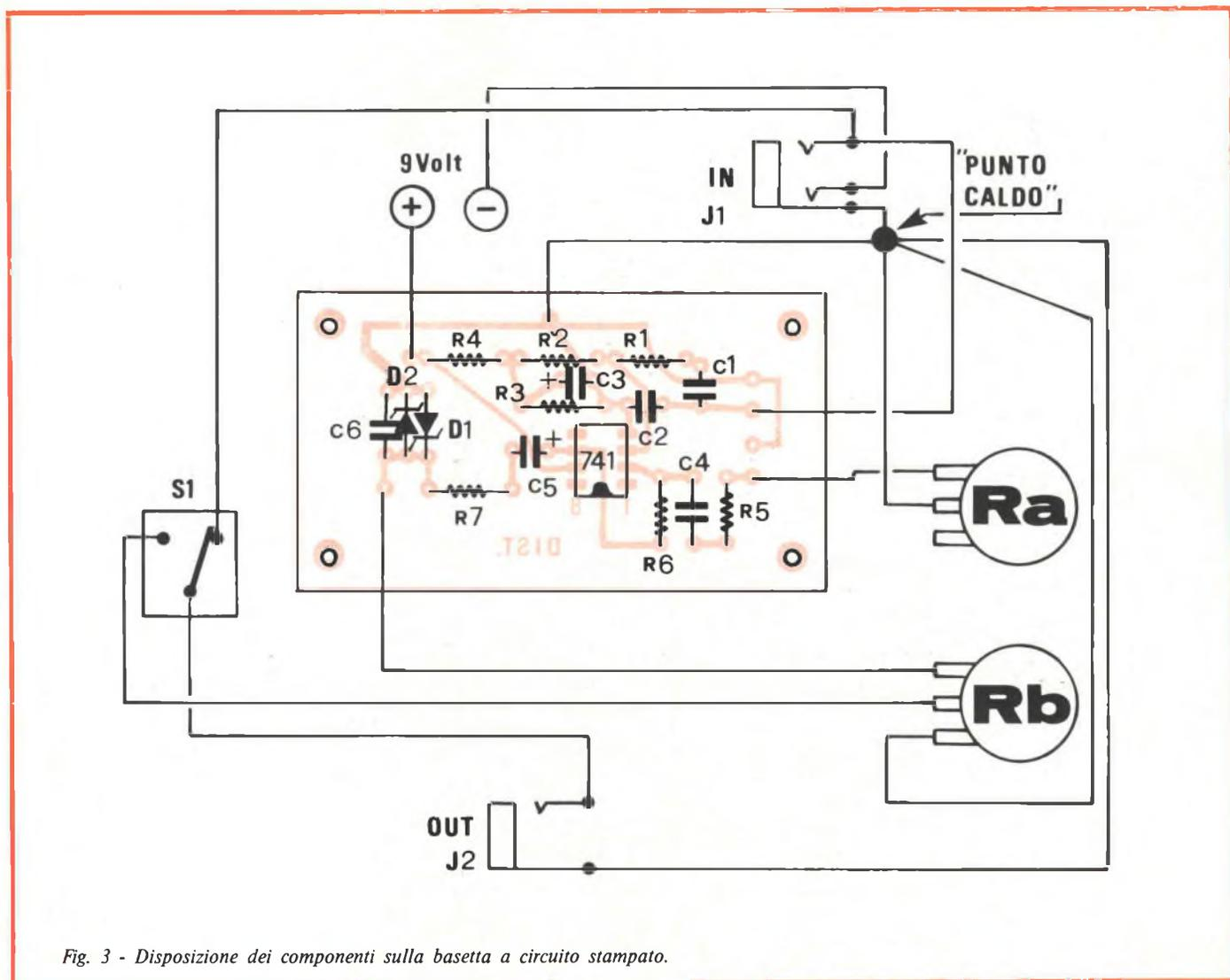
Fig. 3 - Disposizione dei componenti sulla basetta a circuito stampato.
