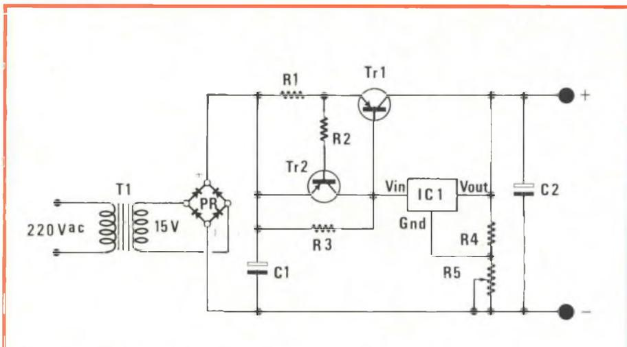
Fig. 1 - Schema elettrico dell'alimentatore.
