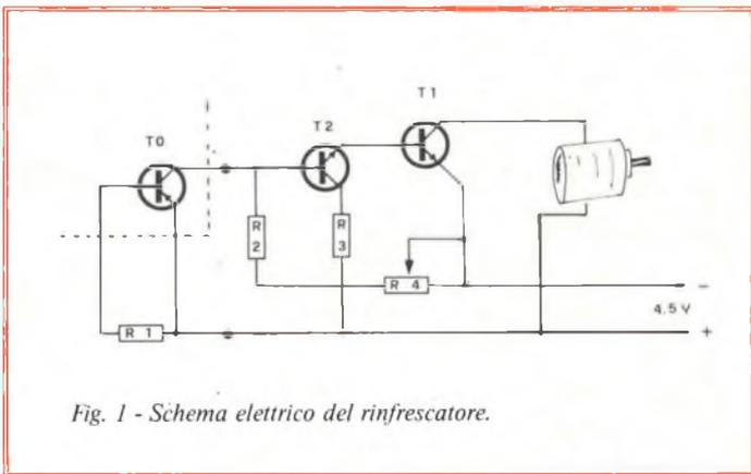
Fig. 1 - Schema elettrico del rinfriscatore.
