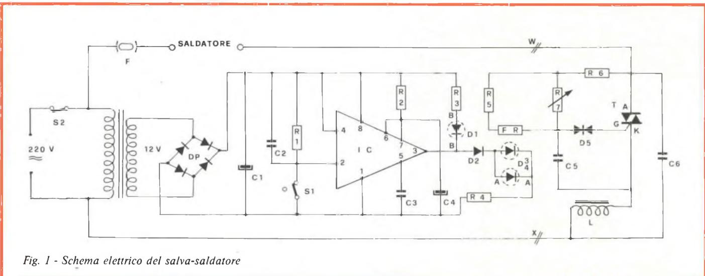
Fig. 1 - Schema elettrico del salva-saldatore
