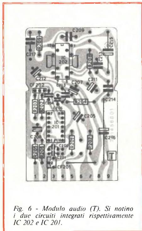
Fig. 6 - Modulo audio (T). Si notino i due circuiti integrati rispettivamente IC 202 e IC 201.
