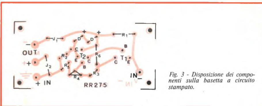
Fig. 3 - Disposizione dei componenti sulla basetta a circuito stampato.
