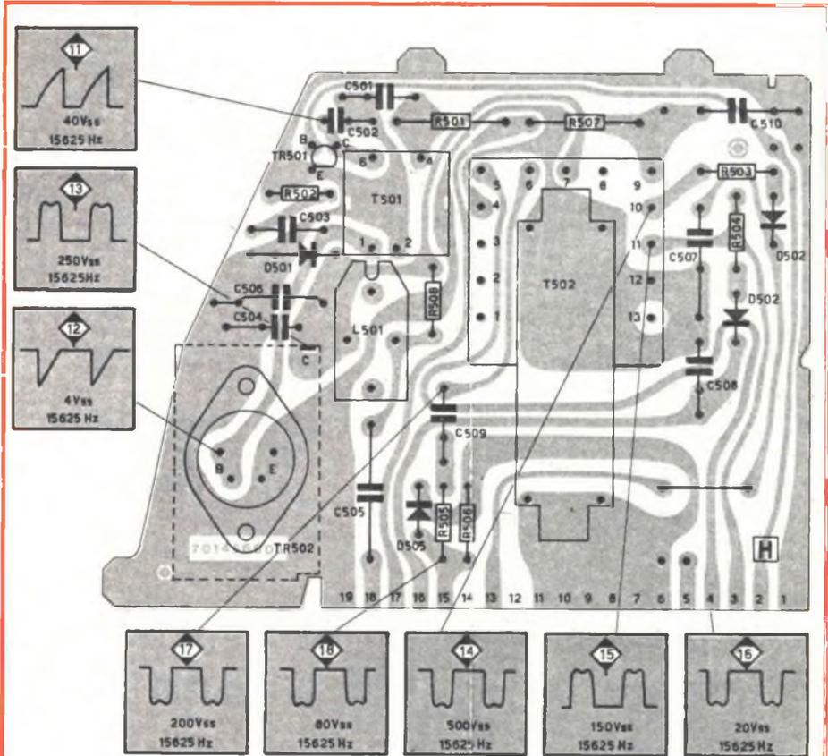
Fig. 8 - Modulo deflessione orizzontale (H). Su questo modulo si trova anche il trasformatore finale di riga T502 unitamente al transistor finale di riga TR502. Sono riportate le forme d'onda caratteristiche che debbono essere presenti nei punti del circuito indicati.
