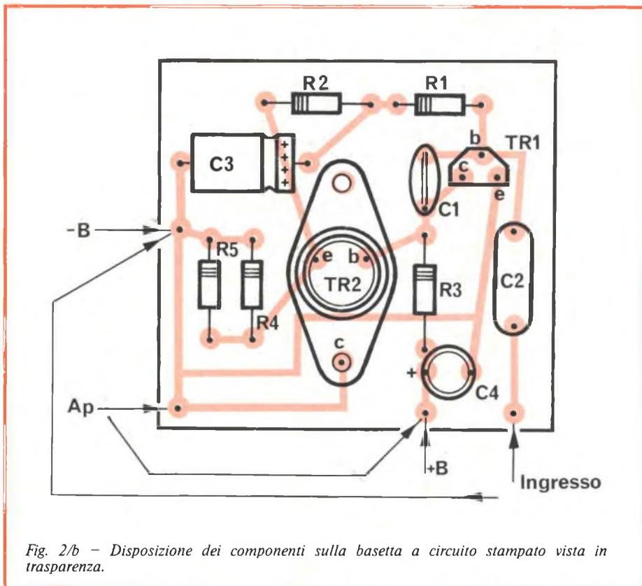
Fig. 2/b - Disposizione dei componenti sulla basetta a circuito stampato vista in trasparenza.
