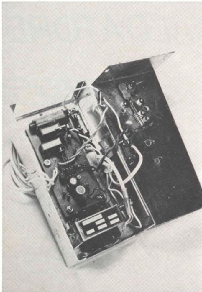
piega, (vedi foto) e altrettanti fori coincidenti con i primi si fanno sul coperchio del contenitore. In ogni foro prende posto una vite, con una molla di metallo, che unisce i due pezzi forati.
