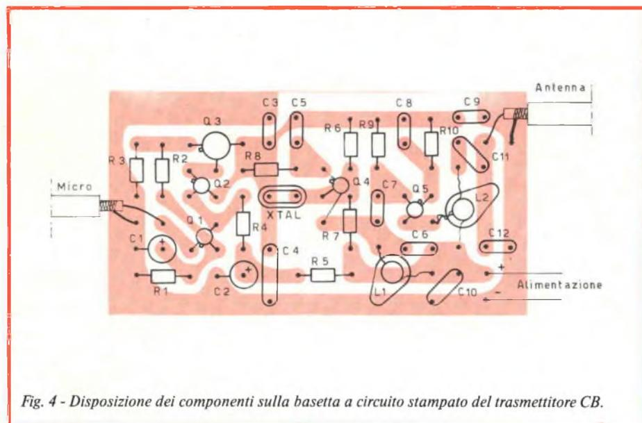
Fig. 4 - Disposizione dei componenti sulla basetta a circuito stampato del trasmettitore CB.
