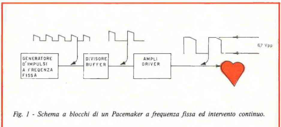
Fig. 1 - Schema a blocchi di un Pacemaker a frequenza fissa ed intervento continuo.
