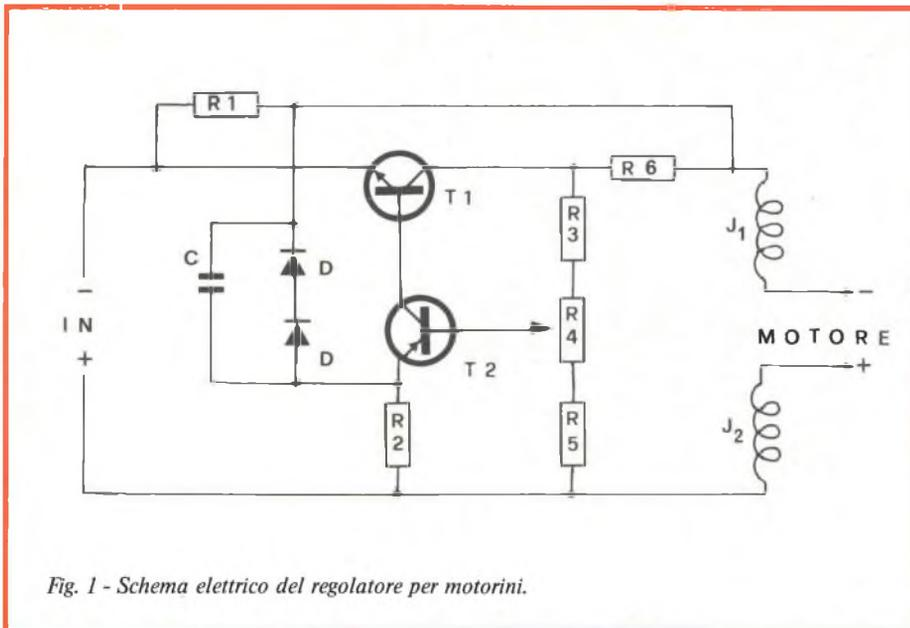
Fig. 1 - Schema elettrico del regolatore per motorini.
