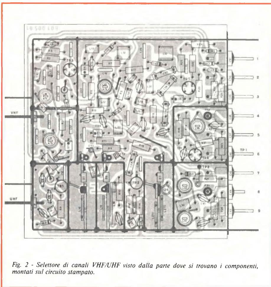
Fig. 2 - Selettore di canali VHF/UHF visto dalla parte dove si trovano i componenti, montati sul circuito stampato.
