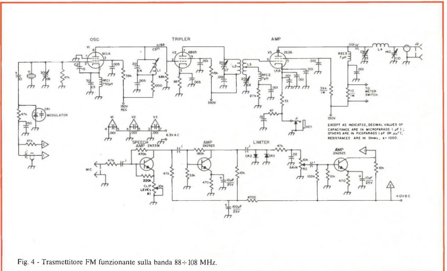
Fig. 4 - Trasmettitore FM funzionante sulla banda 88÷108 MHz.
