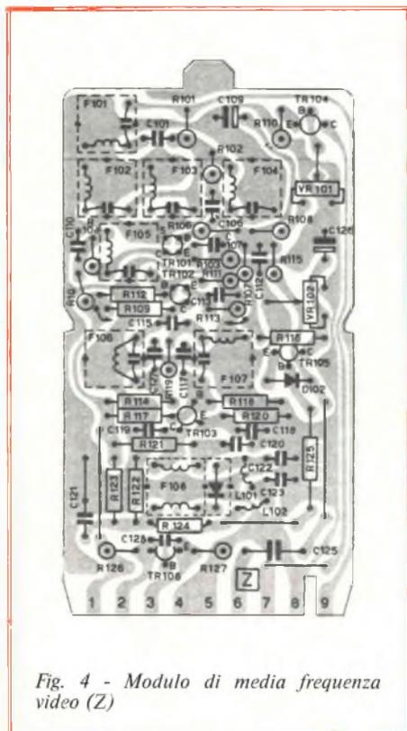
Fig. 4 - Modulo di media frequenza video (Z)
