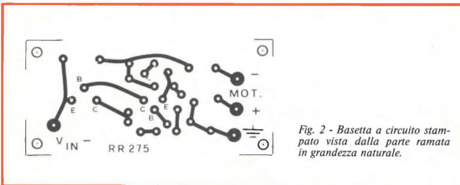
Fig. 2 - Basetta a circuito stampato vista dalla parte ramata in grandezza naturale.
