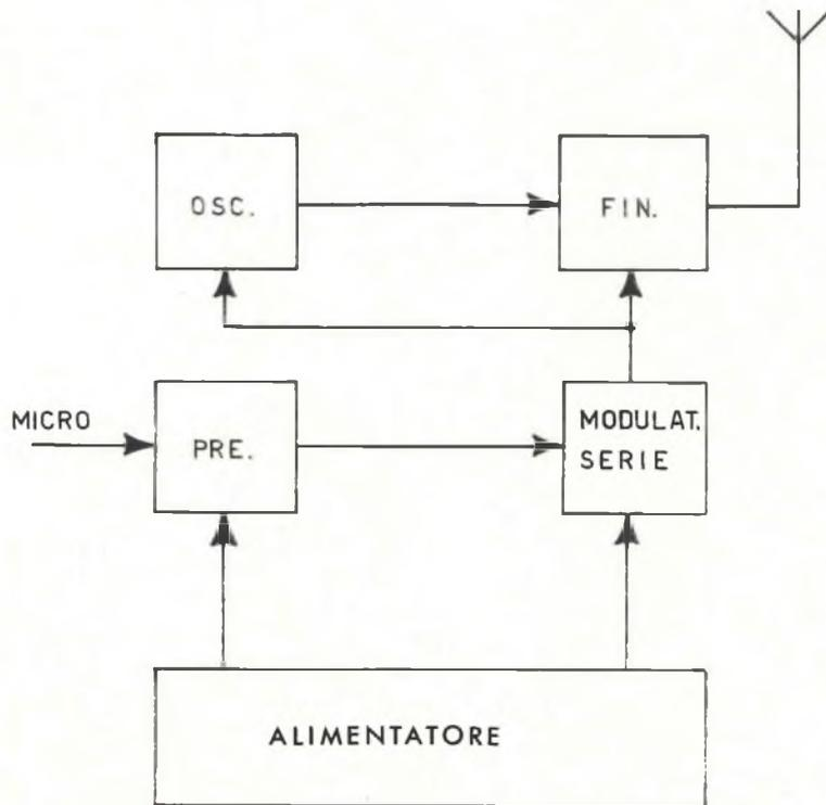
Fig. 1 - Schema a blocchi del trasmettitore con l'alimentatore.
