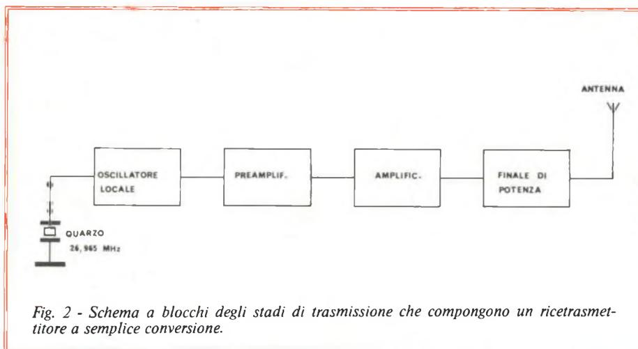
Fig. 2 - Schema a blocchi degli stadi di trasmissione che compongono un ricetrasmittitore a semplice conversione.
