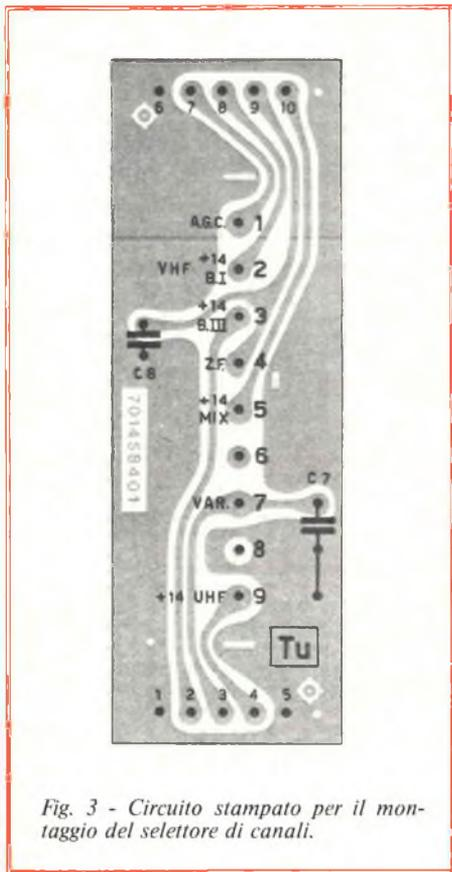
Fig. 3 - Circuito stampato per il montaggio del selettore di canali.
