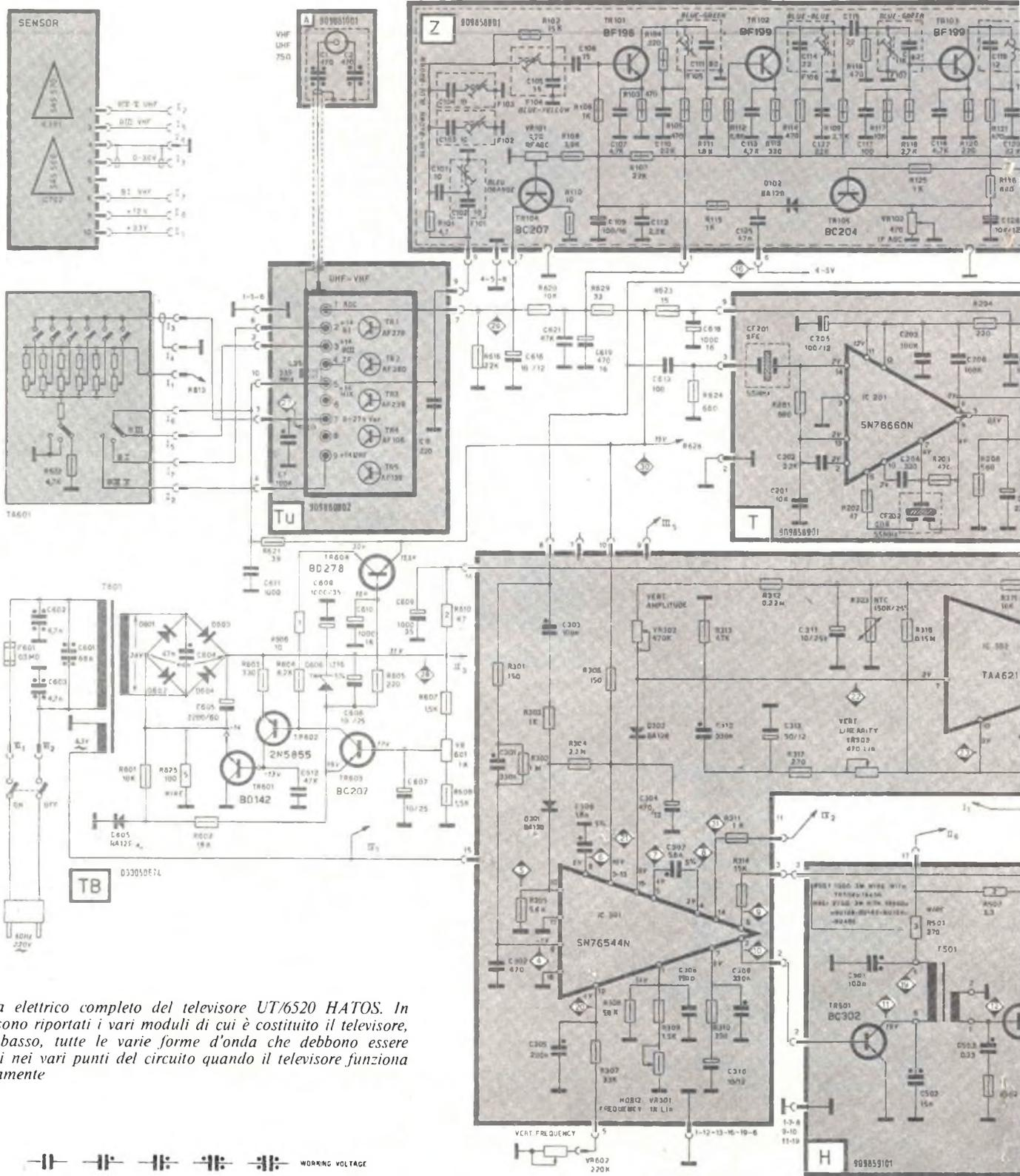
Schema elettrico completo del televisore UT/6520 HATOS. In grigio sono riportati i vari moduli di cui è costituito il televisore, ed in basso, tutte le varie forme d'onda che debbono essere presenti nei vari punti del circuito quando il televisore funziona correttamente
