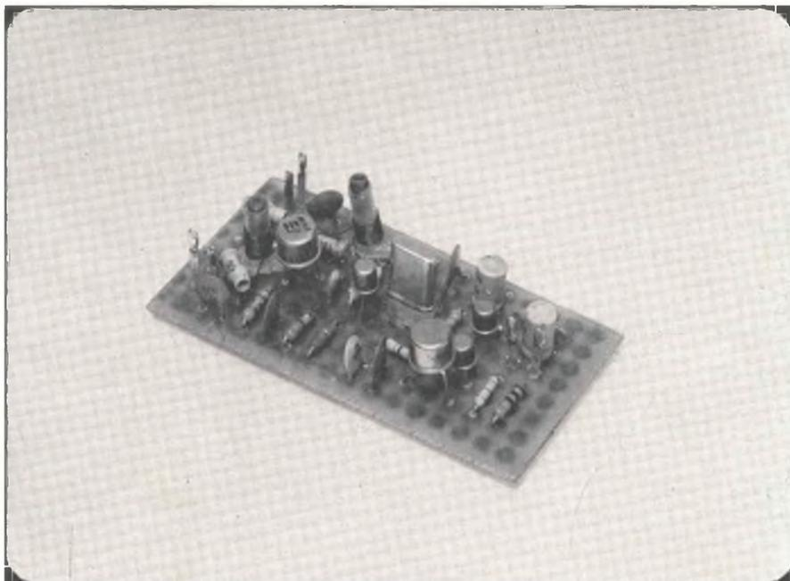
**E possibile costruire un discreto trasmettitore CB, impiegando un numero molto limitato di componenti, magari di recupero e comunque di basso costo? Secondo me sì; e il progetto che vi descrivo vuole essere una proposta in tal senso. Ha una potenza d'uscita compresa fra 0,3 e 0,5 W, la modulazione è positiva e molto buona. L'alimentazione è sui 12 V.**
