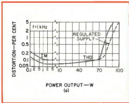
Fig. 7 - Queste curve, relative all'amplificatore di potenza presentato nella figura 6, mostrano l'eccellente qualità ricavabile dall'apparecchio; come si vede, la distorsione armonica totale è incredibilmente modesta. Non si deve però superare la potenza di 70 W, altrimenti si ha un sensibilissimo peggioramento nelle prestazioni.
