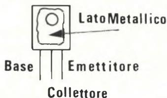
Fig. 4 - Disposizione dei terminali dei transistori impiegati.
