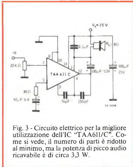
Fig. 3 - Circuito elettrico per la migliore utilizzazione dell'IC "TAA611/C". Come si vede, il numero di parti è ridotto al minimo, ma la potenza di picco audio ricavabile è di circa 3,3 W.
