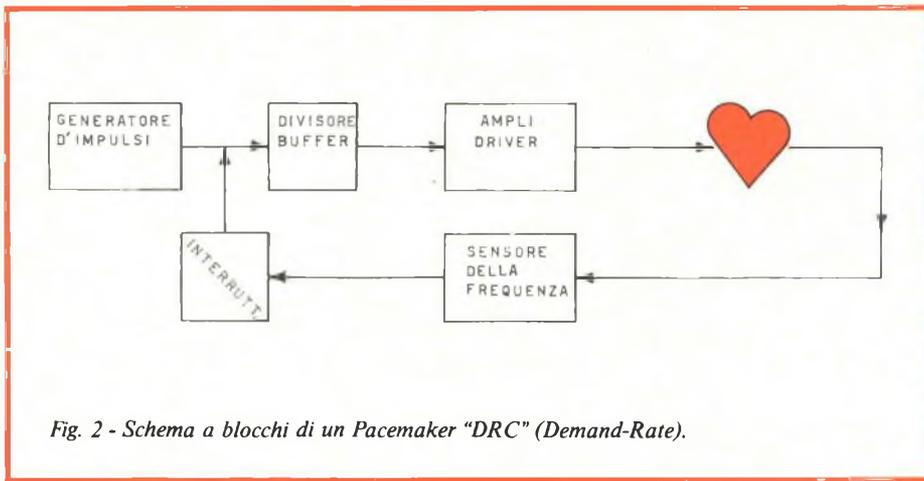
Fig. 2 - Schema a blocchi di un Pacemaker "DRC" (Demand-Rate).
