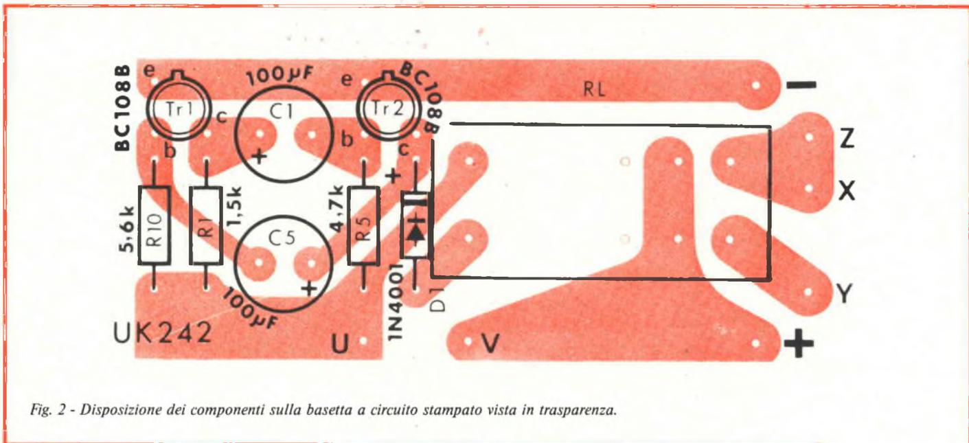
Fig. 2 - Disposizione dei componenti sulla bassetta a circuito stampato vista in trasparenza.
