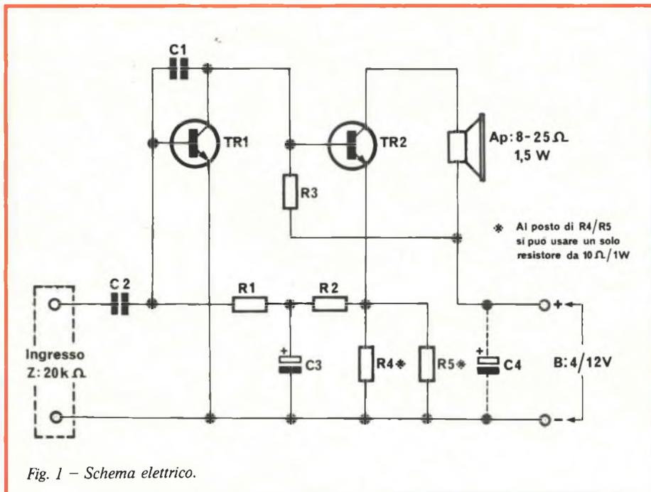
*Bastano due soli transistori e poche altre parti per realizzare un amplificatore audio dalla banda larghissima, distorsione modesta e potenza sufficiente per i più vari impieghi. Questo è un apparecchio di alto valore didattico per il principiante, ma può essere utile anche al professionista.*
