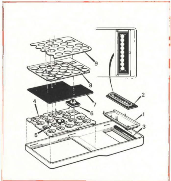
Fig. 11 - Parte della sequenza delle operazioni di montaggio dell'involucro esterno e delle parti in esso contenute. I numeri riportati in questa figura corrispondono alle fasi descritte nel testo.
