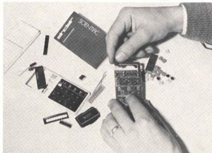
Fig. 9-B - Metodo di inserimento dei terminali di un condensatore elettrolitico negli appositi fori di ancoraggio.
