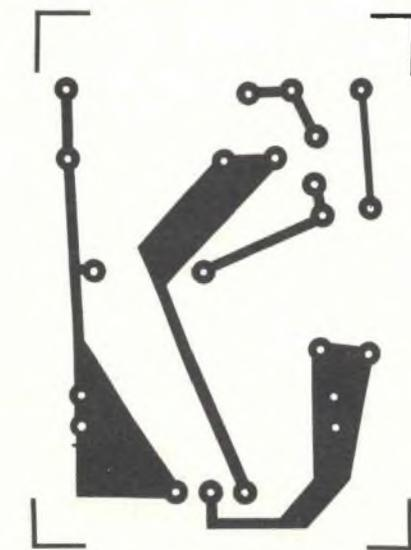
Fig. 2 - Basetta a circuito stampato in scala 1:1.
