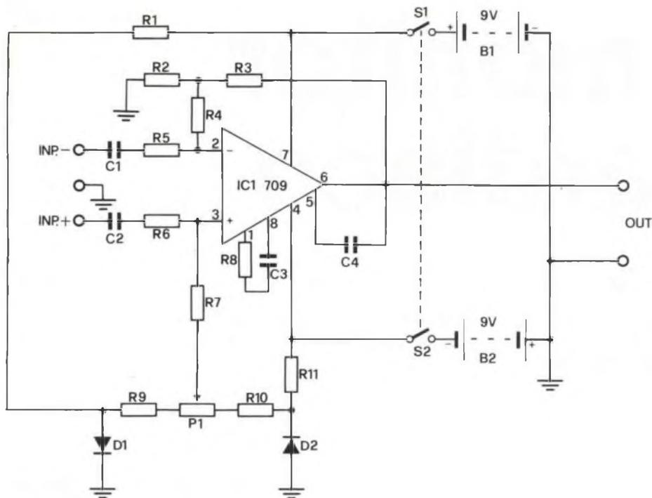
Fig. 1 - Schema elettrico del cardiofono. I terminali indicati con INP. - e INP. + vengono connessi all'elettrodo sensibile (fig. 3); quelli indicati con OUT ad una cuffia ad alta impedenza o ad un circuito amplificatore.
