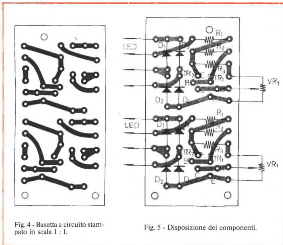
Fig. 4 - Basetta a circuito stampato in scala 1 : 1.
