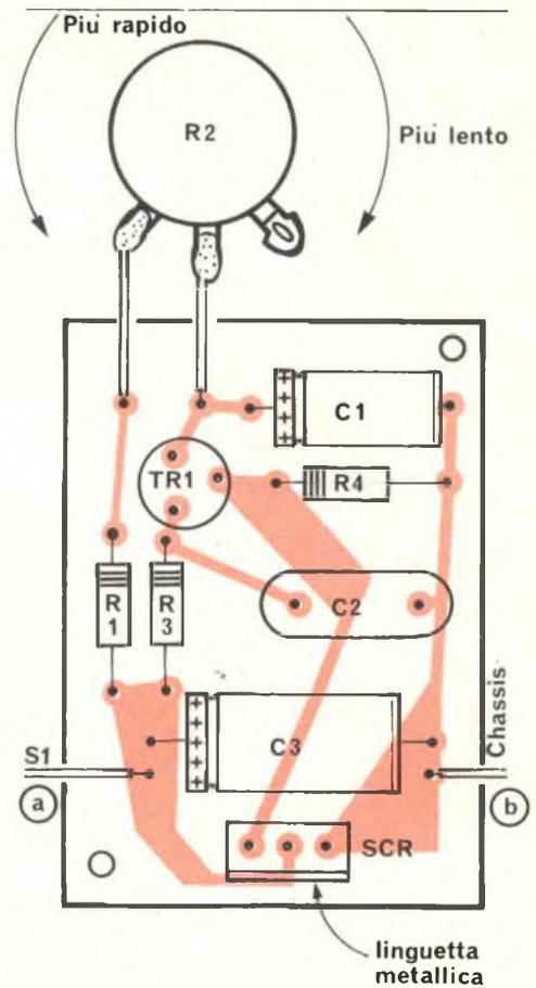
Fig. 3 - Disposizione dei componenti sulla bassetta.
