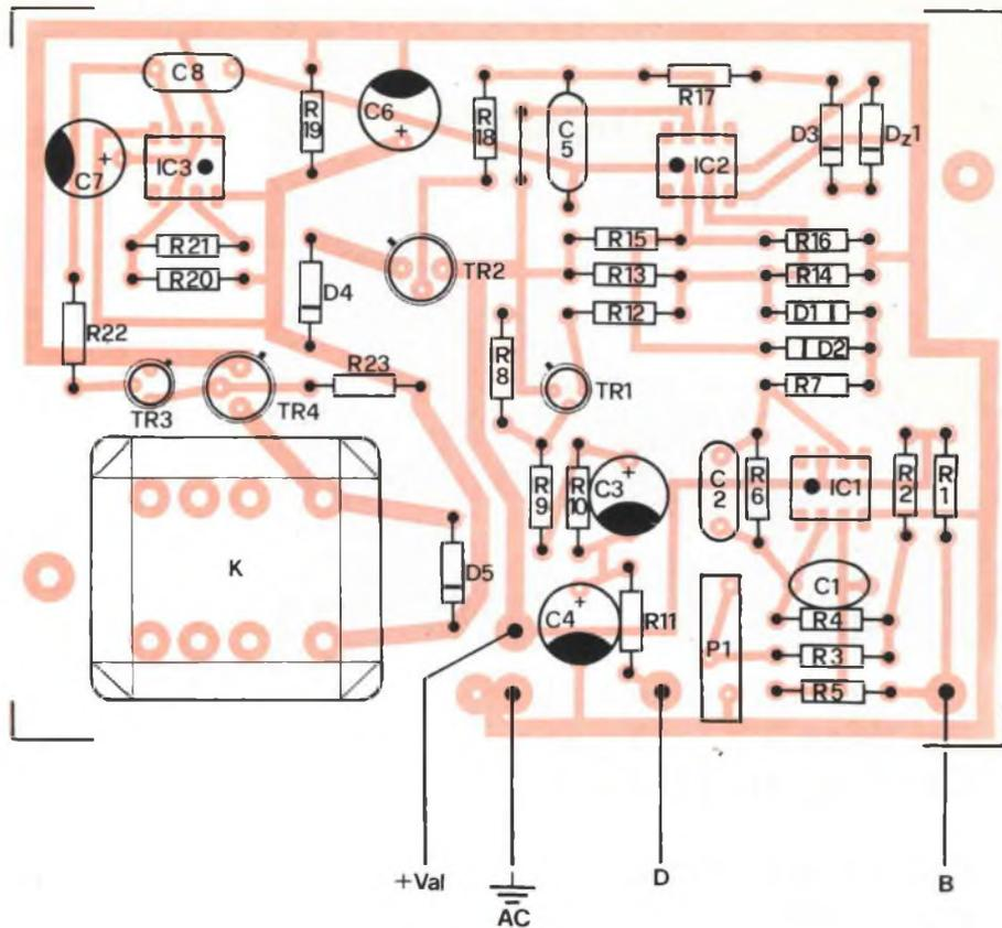
Fig. 7 - Disposizione dei componenti sulla basetta di fig. 6.
