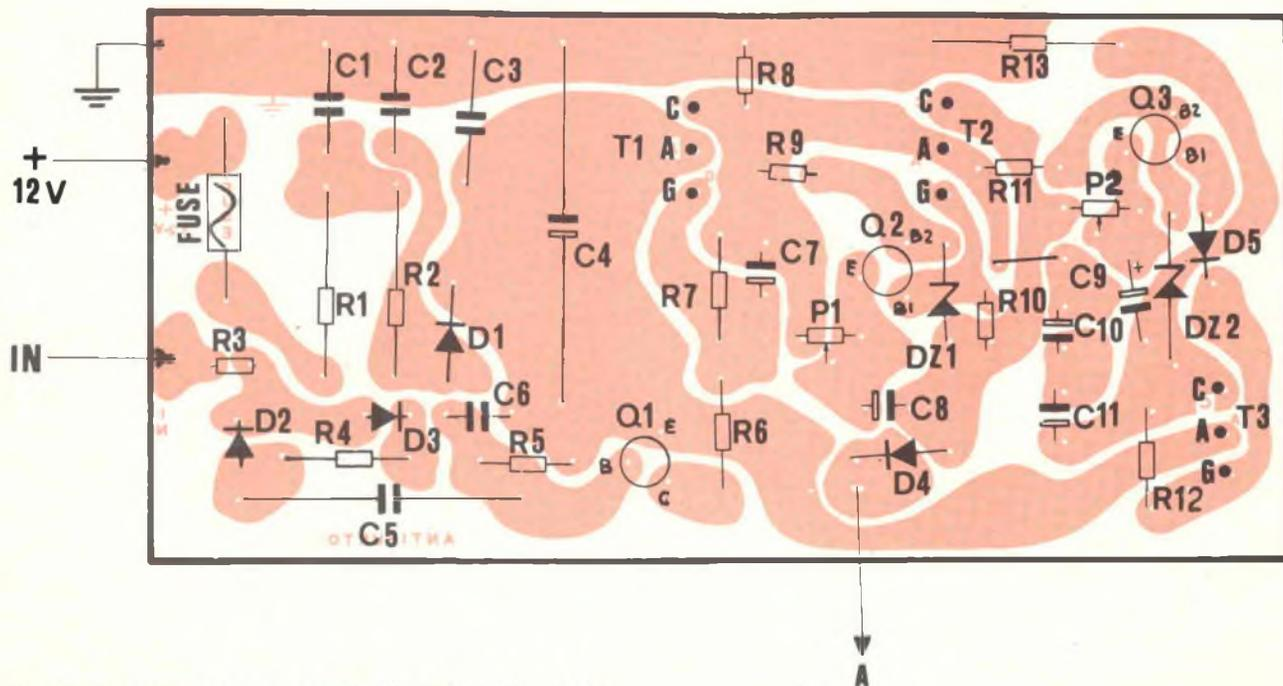
Fig. 13 - Disposizione dei componenti sulla basetta di figura 12.
