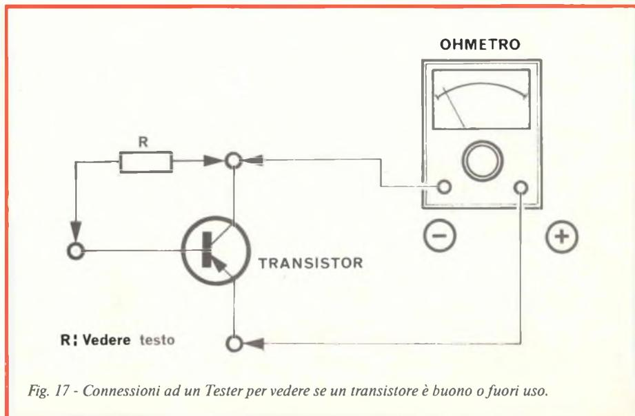
Fig. 17 - Connessioni ad un Tester per vedere se un transistor è buono o fuori uso.
