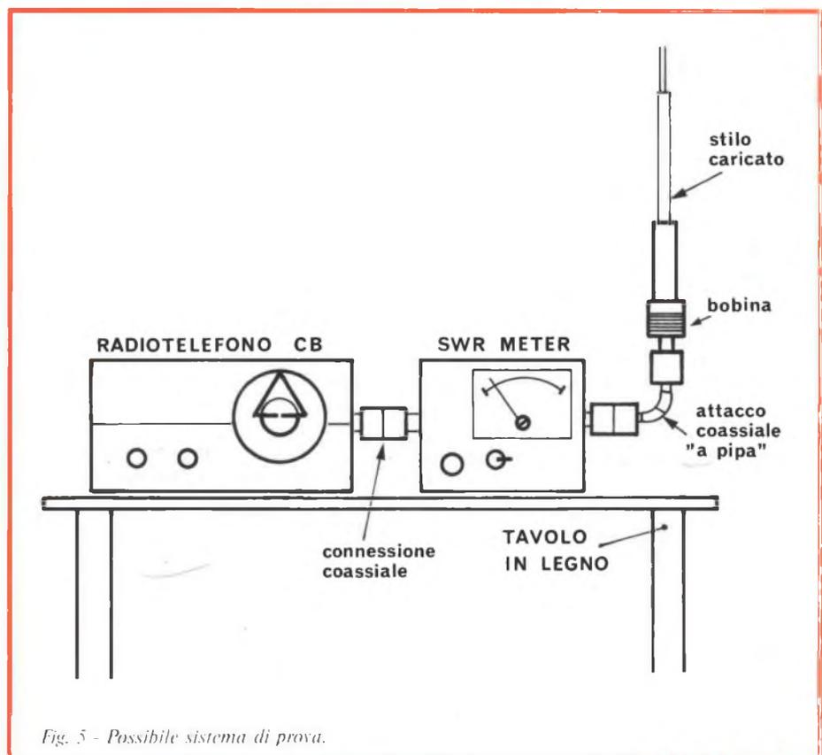
Fig. 5 - Possibile sistema di prova.
