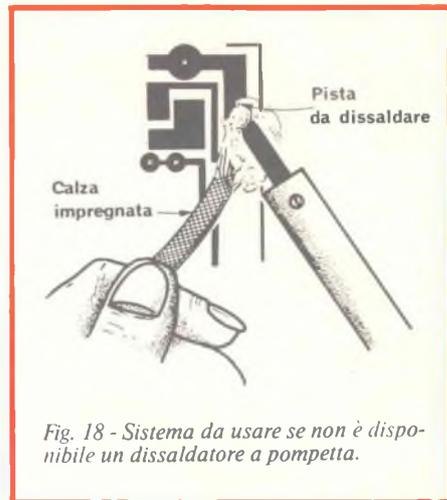
Fig. 18 - Sistema da usare se non è disponibile un dissaldatore a pompetta.
