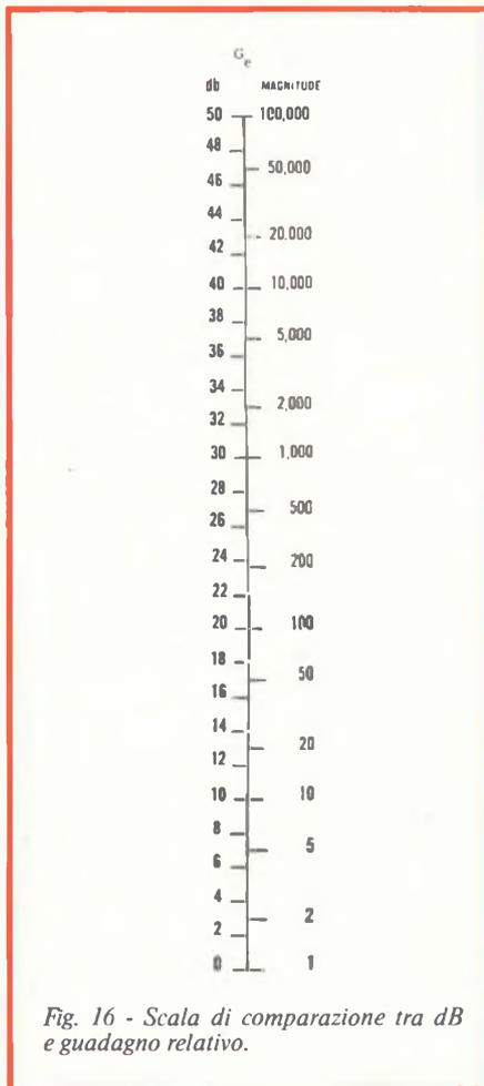
Fig. 16 - Scala di comparazione tra dB e guadagno relativo.
