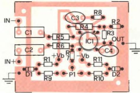
Fig. 2/b - Disposizione dei componenti sulla basetta di fig. 2/a. Alcuni Componenti sono montati verticalmente per contenere l'ingombro. Fare attenzione ai terminali dei diodi e dell'integrato.
