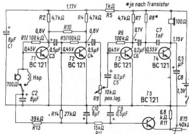
Fig. 9 - Schema elettrico di un amplificatore "s sofisticato".
