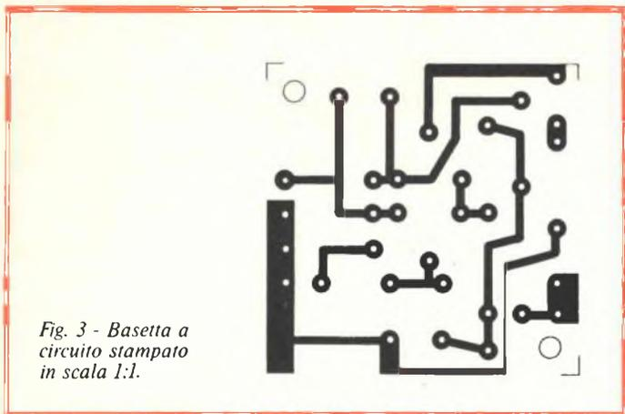
Fig. 3 - Basetta a circuito stampato in scala 1:1.
