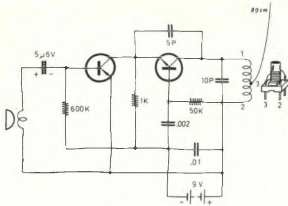
Fig. 14 - Schema elettrico di un radiomicrofono.
