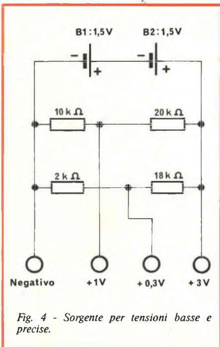
Fig. 4 - Sorgente per tensioni basse e precise.
