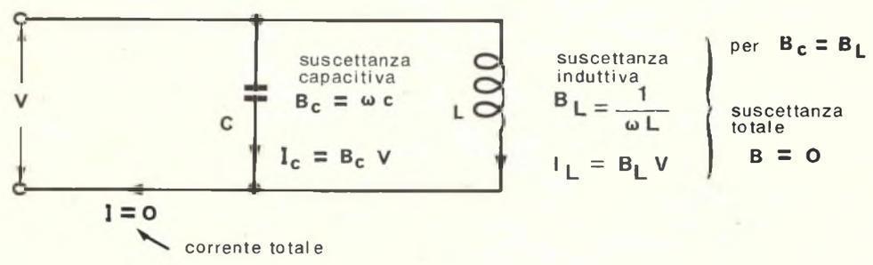
**Nota.** La corrente totale è uguale a zero anche se c'è tensione nel circuito, mentre le due correnti capacitiva e induttiva hanno un valore ben definito.
