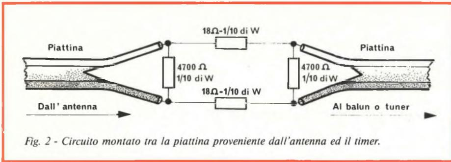
Fig. 2 - Circuito montato tra la piattina proveniente dall'antenna ed il timer.
