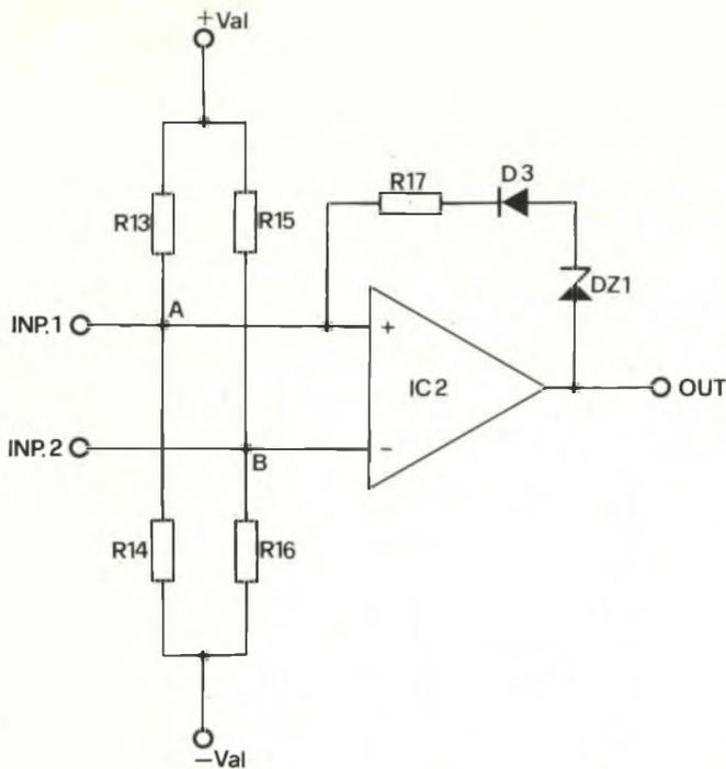
Fig. 3 - Schema semplificato di un circuito bistabile impiegante un amplificatore operazionale.
