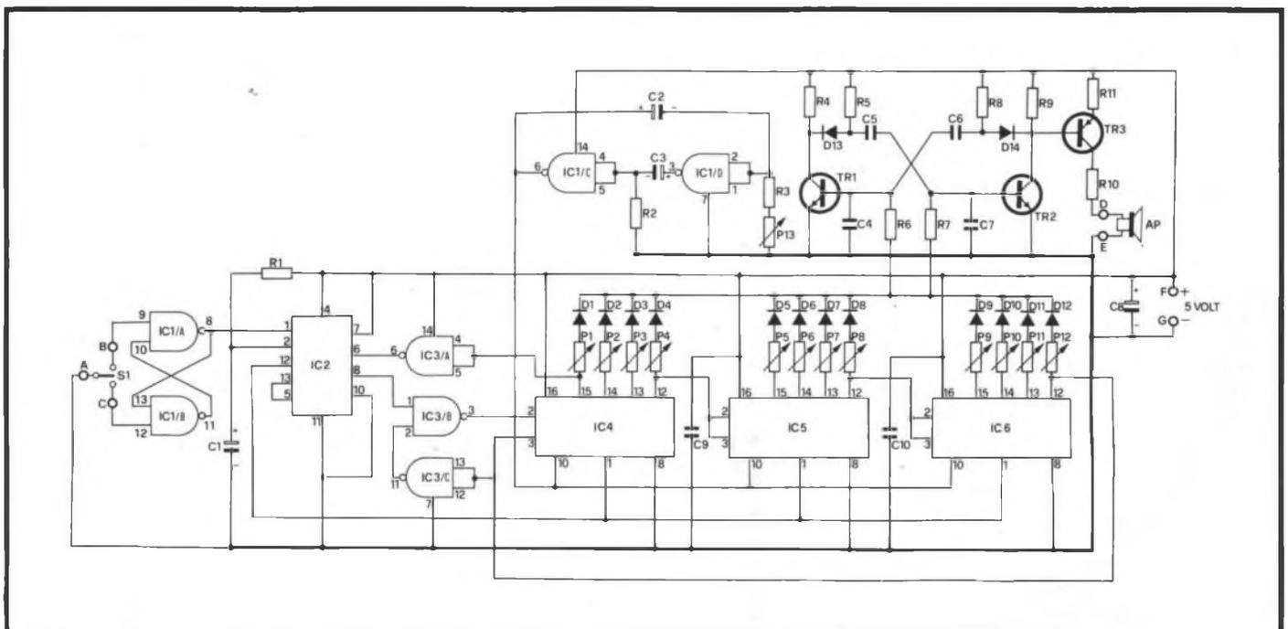
Fig. 5 - Schema elettrico completo del carillon digitale.
