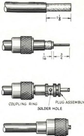
Fig. 9 - Sistema per connettere un Plug standard.
