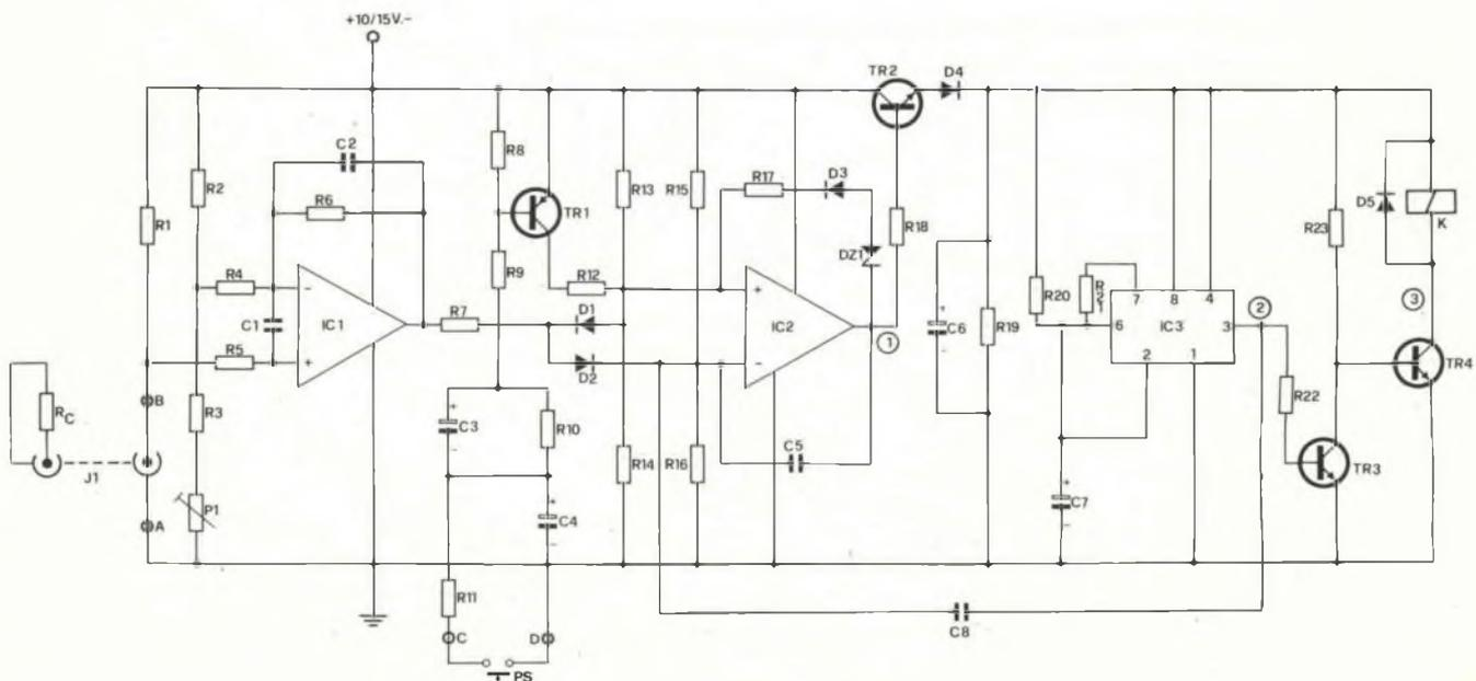
Fig. 4 - Schema completo del sistema a chiave resistiva.
