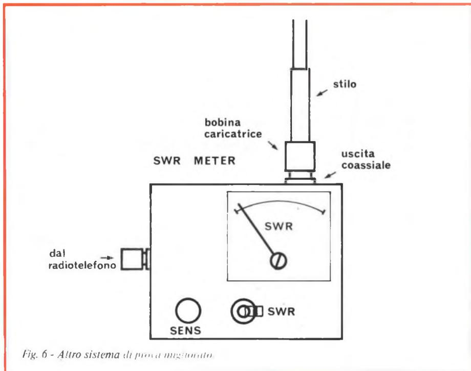
Fig. 6 - Altro sistema di prova migliorato.
