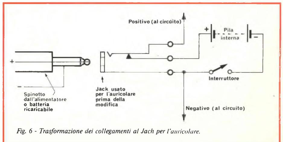
Fig. 6 - Trasformazione dei collegamenti al Jack per l'auricolare.
