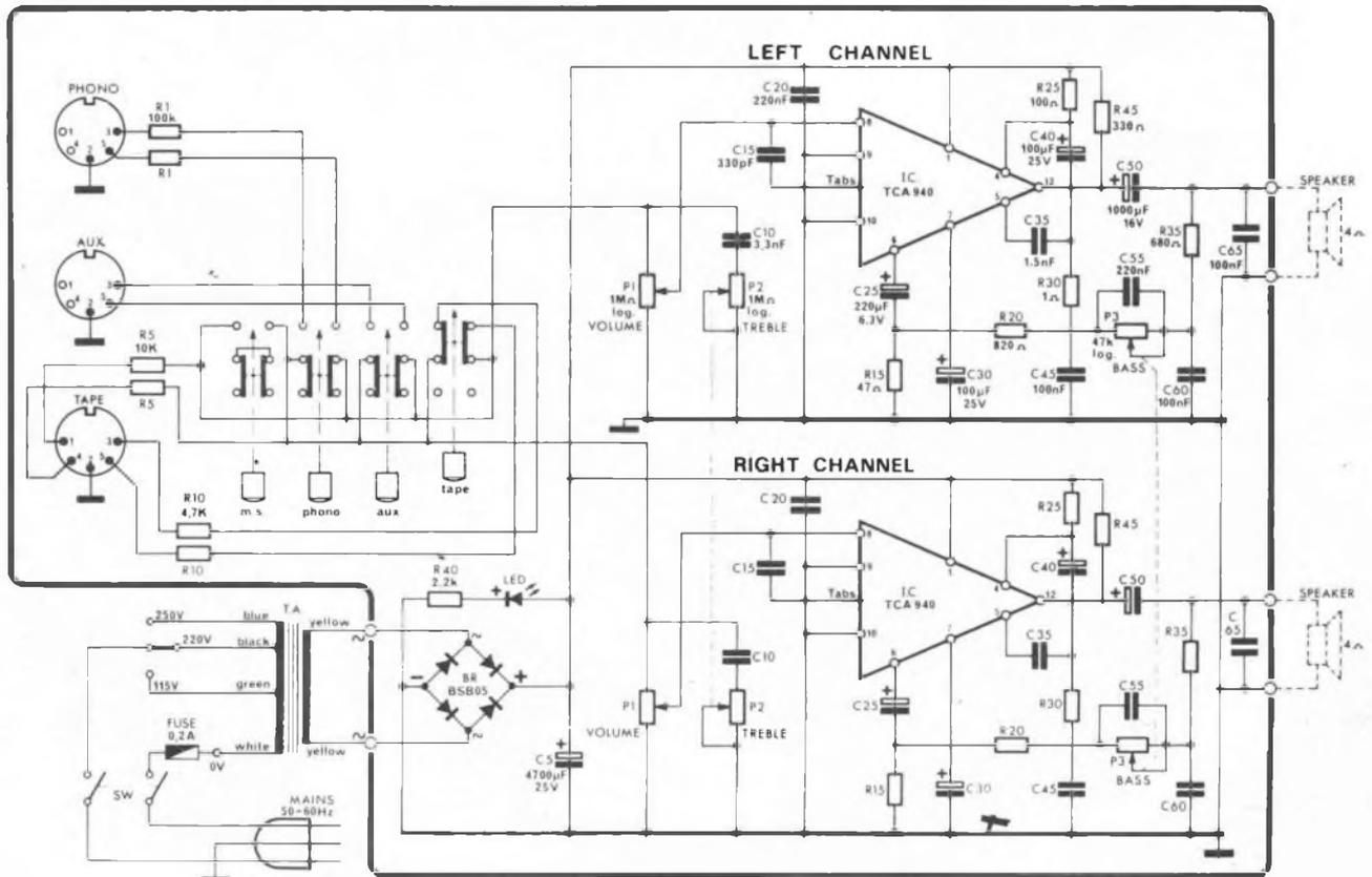
Fig. 1 - Schema elettrico.
