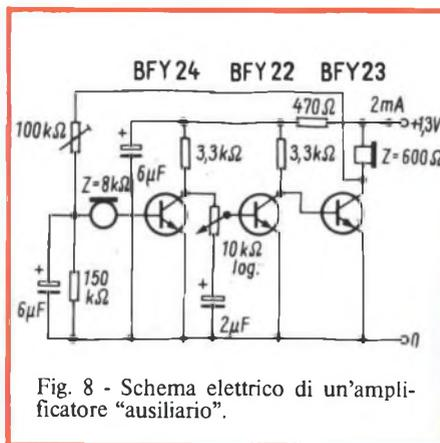
Fig. 8 - Schema elettrico di un'amplificatore "ausiliario".
