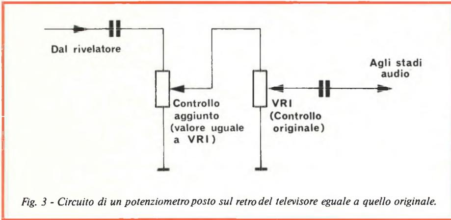
Fig. 3 - Circuito di un potenziometro posto sul retro del televisore eguale a quello originale.
