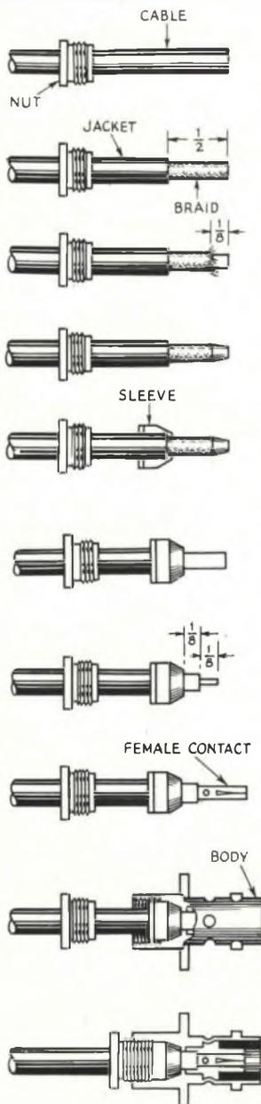
Fig. 8 - Sistema per connettere un BNC.
