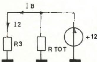
Fig. 8 - Generatore di 0,7 V in corto.
