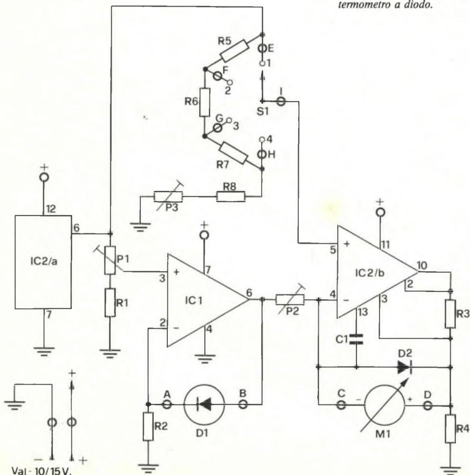
Fig. 1 - Schema elettrico del termometro a diodo.
