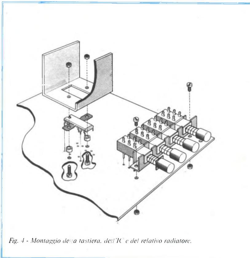
Fig. 4 - Montaggio della tastiera, dell'IC e del relativo radiatore.
