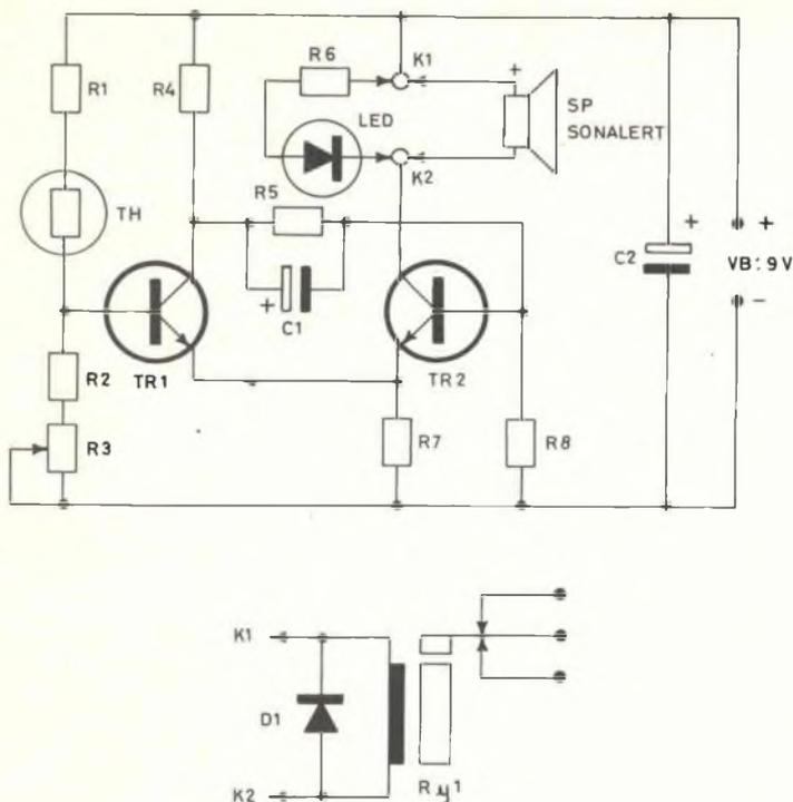
Fig. 1 - Circuito elettrico del termostato.
