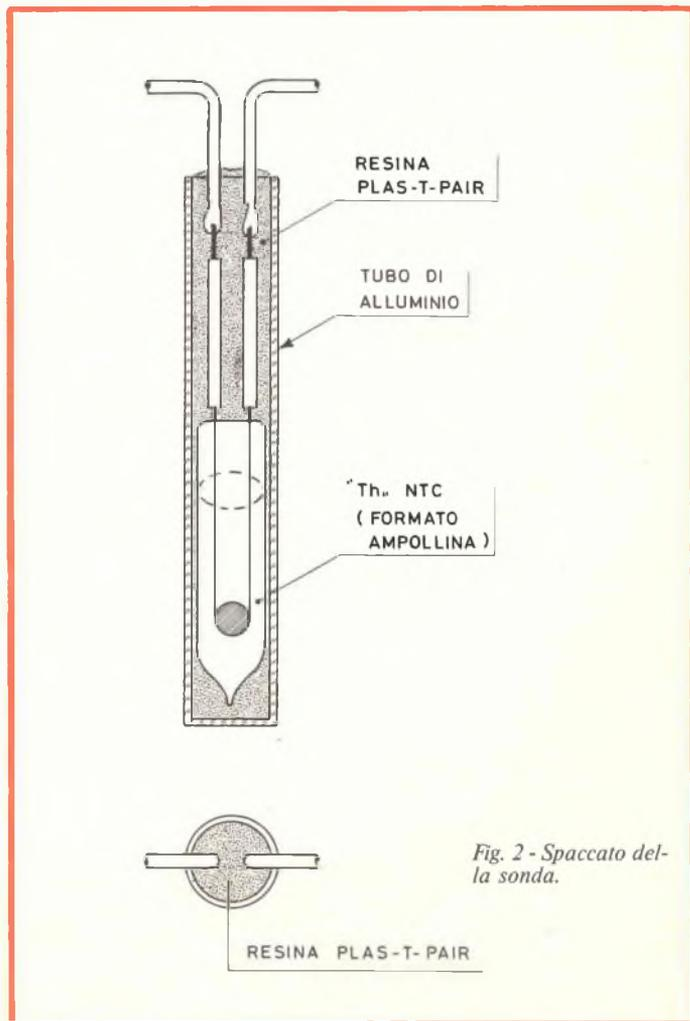
Fig. 2 - Spaccato della sonda.
