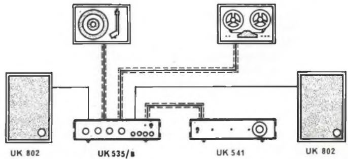
Fig. 6 - Connessioni dell'UK 535/B al giradischi oppure al registratore, sintonizzatore UK 541 e relative casse UK 802.
