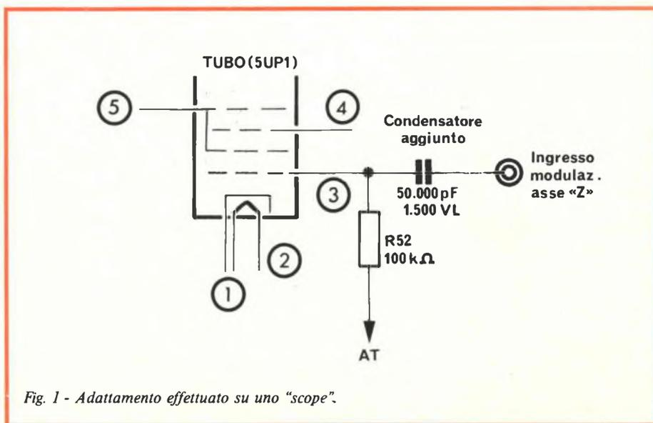
Fig. 1 - Adattamento effettuato su uno "scope".
