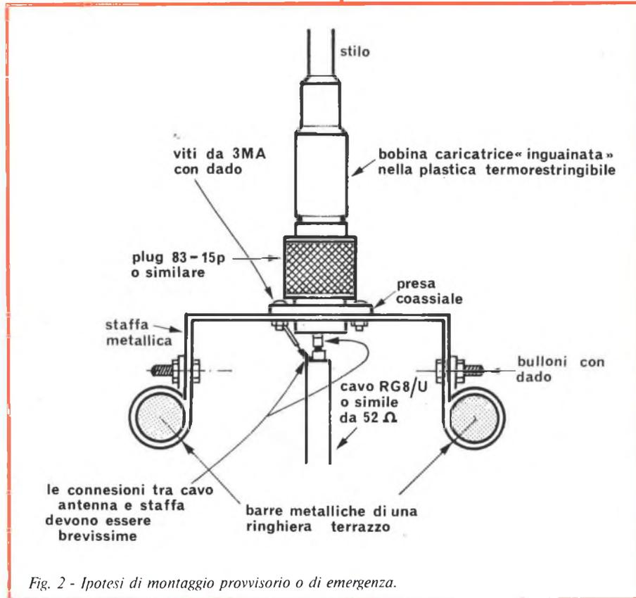
Fig. 2 - Ipotesi di montaggio provvisorio o di emergenza.
