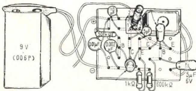
Fig. 15 - Piano di montaggio dello schema di figura 14.
