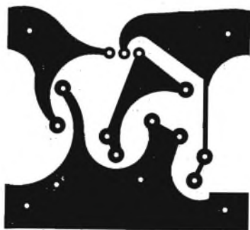
Fig. 2 - Basetta a circuito stampato in scala 1 : 1.
