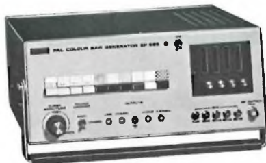
Generatore di barre TV a colori «Unaohm» Mod. EP 686 B. Portanti video: Banda I 48-82 MHz, Banda III 165-230 MHz, Banda IV/V 470-700 MHz.
