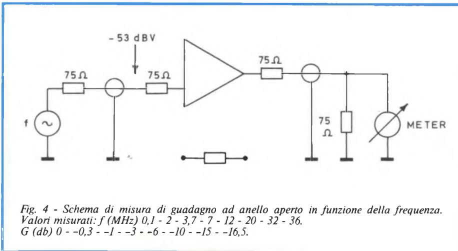
Fig. 4 - Schema di misura di guadagno ad anello aperto in funzione della frequenza. Valori misurati: f (MHz) 0,1 - 2 - 3,7 - 7 - 12 - 20 - 32 - 36. G (db) 0 - -0,3 - -1 - -3 - -6 - -10 - -15 - -16,5.
