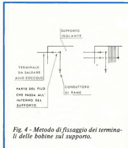
Fig. 4 - Metodo di fissaggio dei terminali delle bobine sul supporto.
