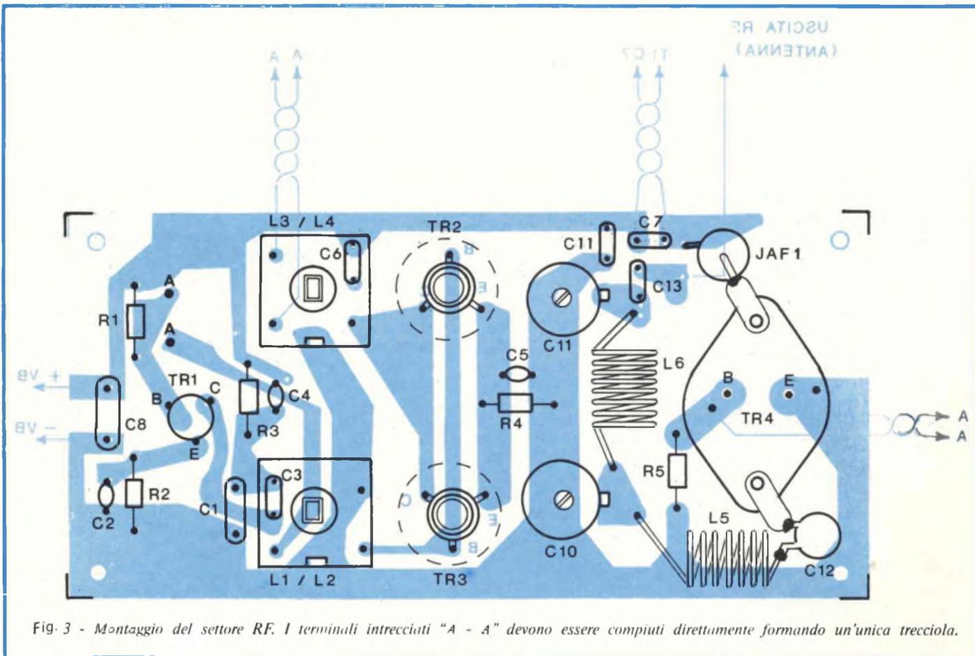
Fig. 3 - Montaggio del settore RF. I terminali intrecciati "A - A" devono essere compiuti direttamente formando un'unica trecciola.
