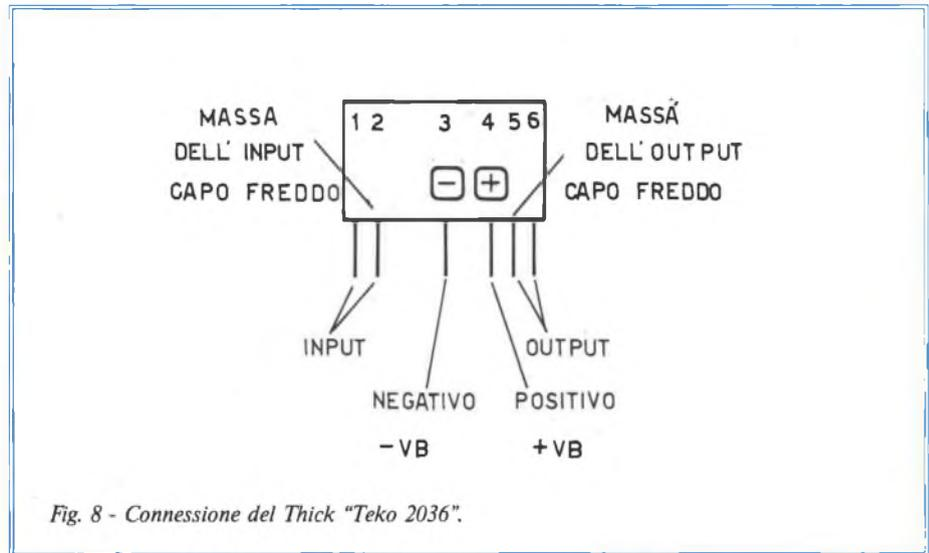
Fig. 8 - Connessione del Thick "Teko 2036".
