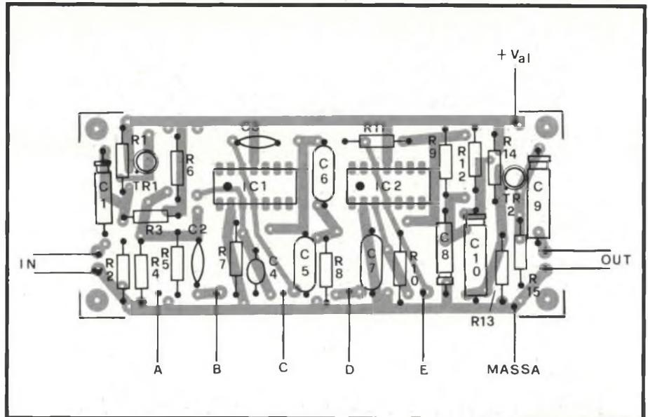
Fig. 4 - Disposizione dei componenti sulla basetta a circuito stampato: per trasparenza si osservano anche le connessioni in rame presenti sul lato opposto. Le lettere A, B, C, D ed E sono state aggiunte per consentire l'identificazione dei punti di ancoraggio per i circuiti di commutazione, rispetto allo schema elettrico di figura 1.
