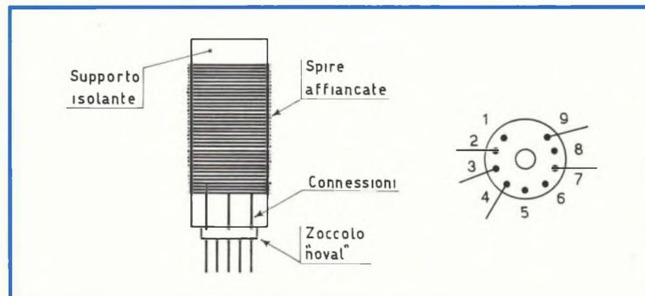
Fig. 7 - A sinistra, una bobina completamente montata; a destra veduta dal di sotto dello zoccolo "noval", attraverso i cui piedini vengono eseguite le connessioni tra la bobina ed il circuito di ricezione.
