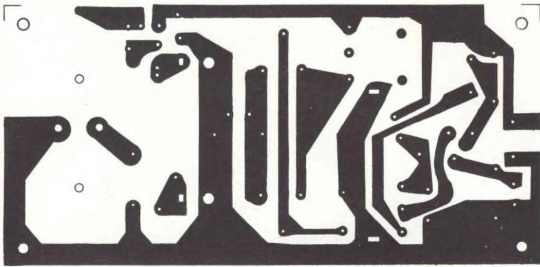
Fig. 2 - Basetta a circuito stampato in scala 1:1.
