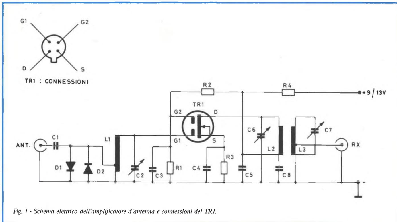
Fig. 1 - Schema elettrico dell'amplificatore d'antenna e connessioni del TR1.
