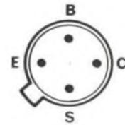
Fig. 3/b - Connessione del BFY 90.
