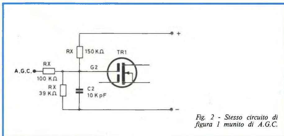
Fig. 2 - Stesso circuito di figura 1 munito di A.G.C.
