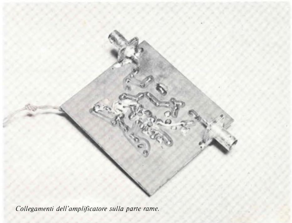
Collegamenti dell'amplificatore sulla parte rame.
