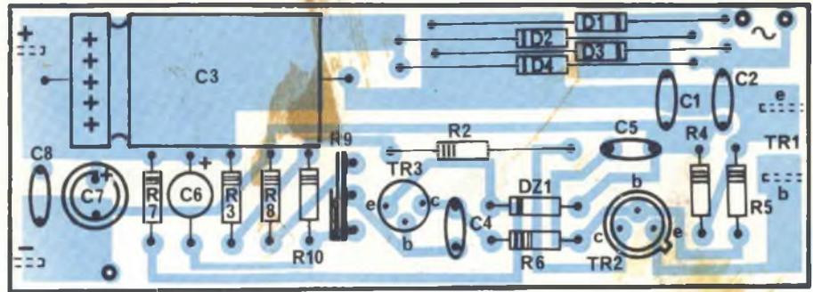
Fig. 3 - Disposizione dei componenti sulla basetta "Master".
