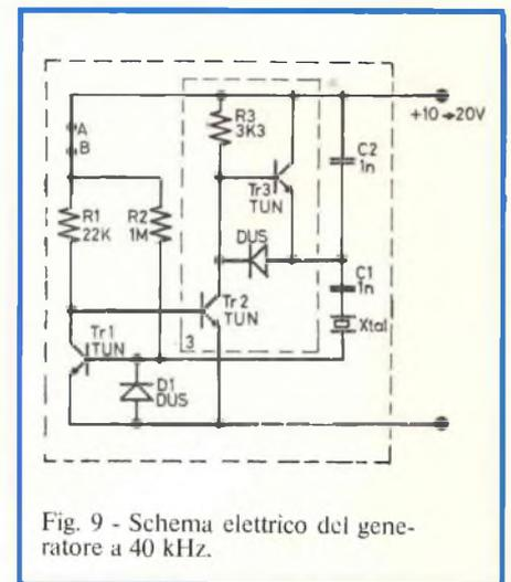
Fig. 9 - Schema elettrico del generatore a 40 kHz.
