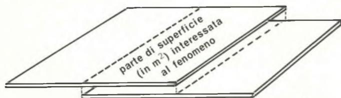
Variare la superficie delle armature significa far scorrere un'armatura parallelamente all'altra, in modo da modificare l'estensione delle superfici che si trovano affacciate.
