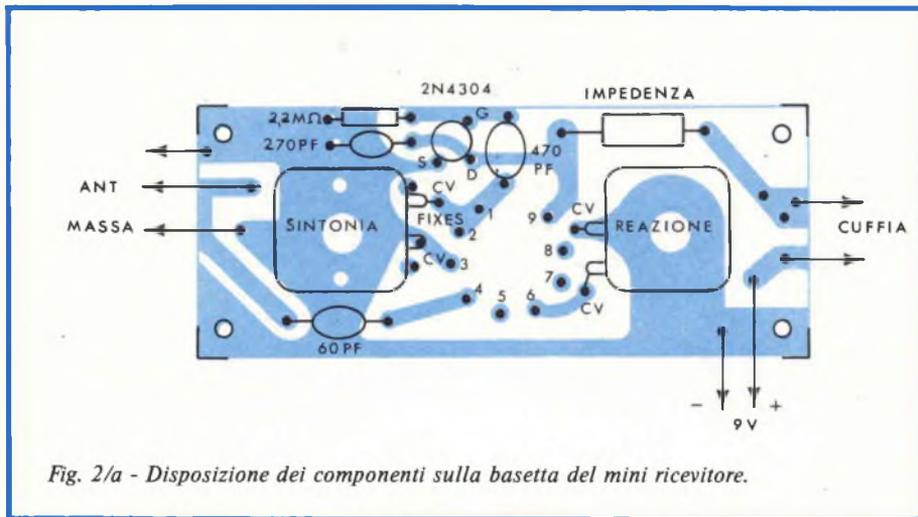
Fig. 2/a - Disposizione dei componenti sulla basetta del mini ricevitore.
