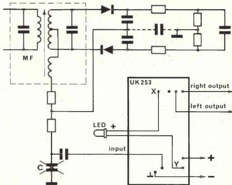
Fig. 3 - Sistema di allacciamento del decoder stereo.
