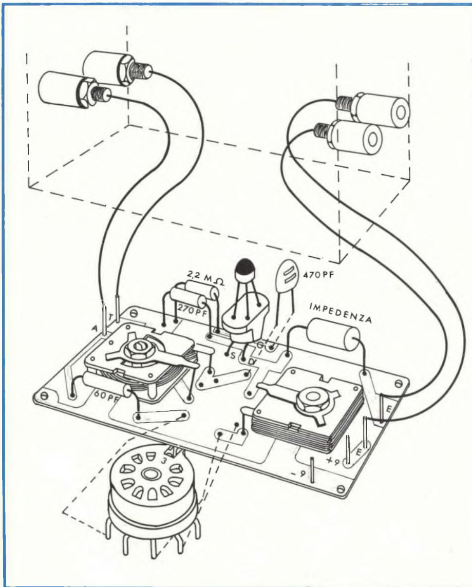
Fig. 9 - Veduta "esplosa" dell'interno del ricevitore, che può essere installato unitamente alla batteria di alimentazione - in una scatola di dimensioni adatte.
