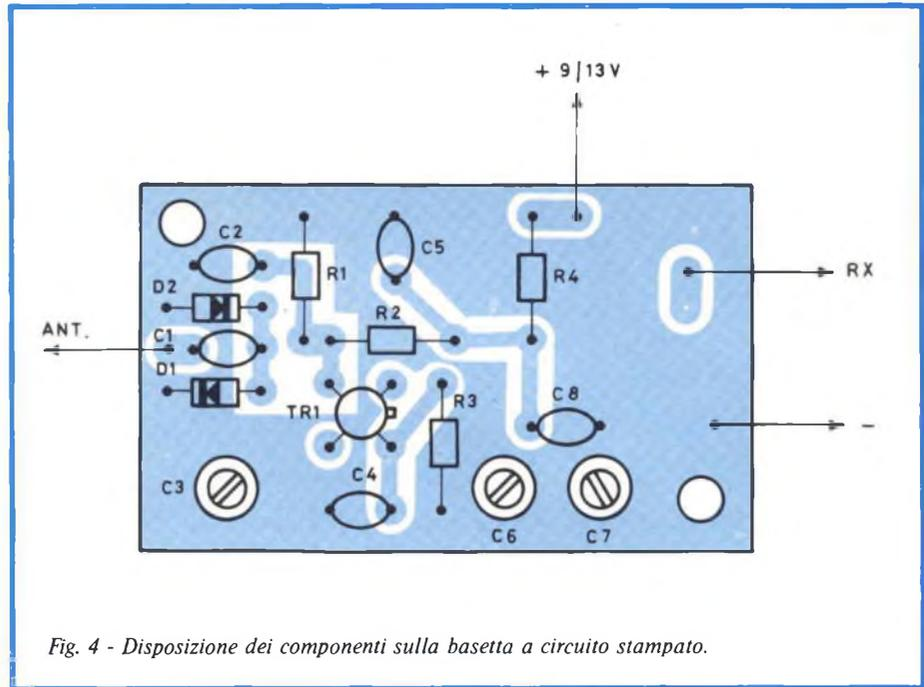
Fig. 4 - Disposizione dei componenti sulla basetta a circuito stampato.
