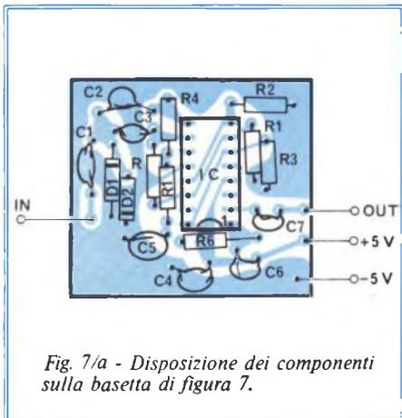
Fig. 7/a - Disposizione dei componenti sulla basetta di figura 7.
