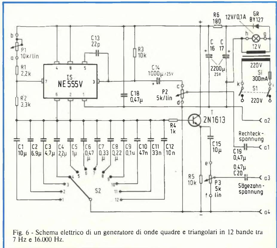
Fig. 6 - Schema elettrico di un generatore di onde quadre e triangolari in 12 bande tra 7 Hz e 16.000 Hz.
