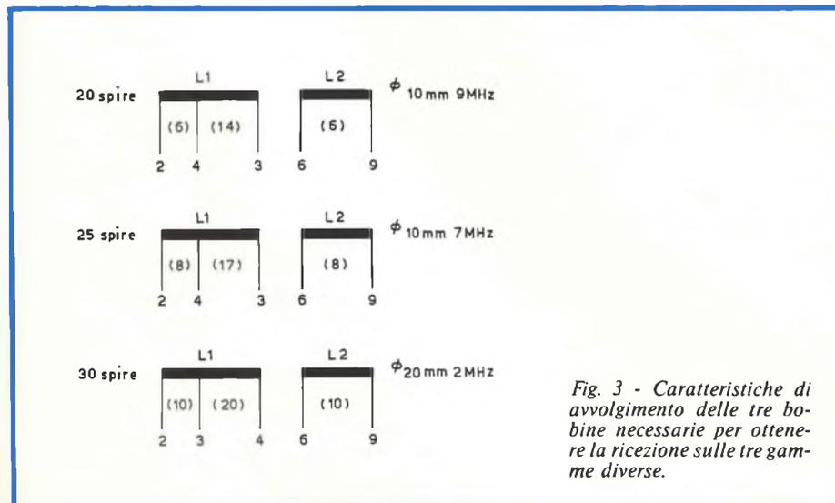
Fig. 3 - Caratteristiche di avvolgimento delle tre bobine necessarie per ottenere la ricezione sulle tre gamme diverse.
