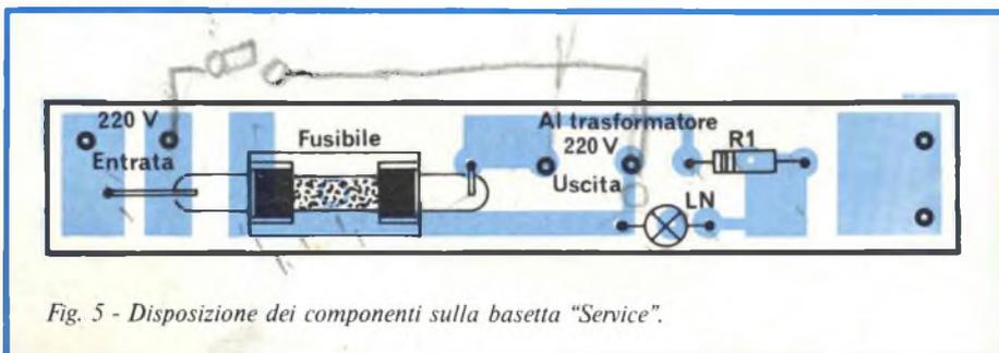
Fig. 5 - Disposizione dei componenti sulla basetta "Service".
