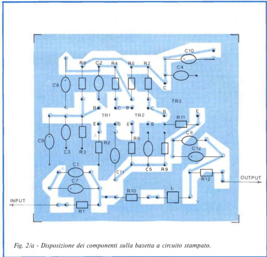
Fig. 2/a - Disposizione dei componenti sulla basetta a circuito stampato.
