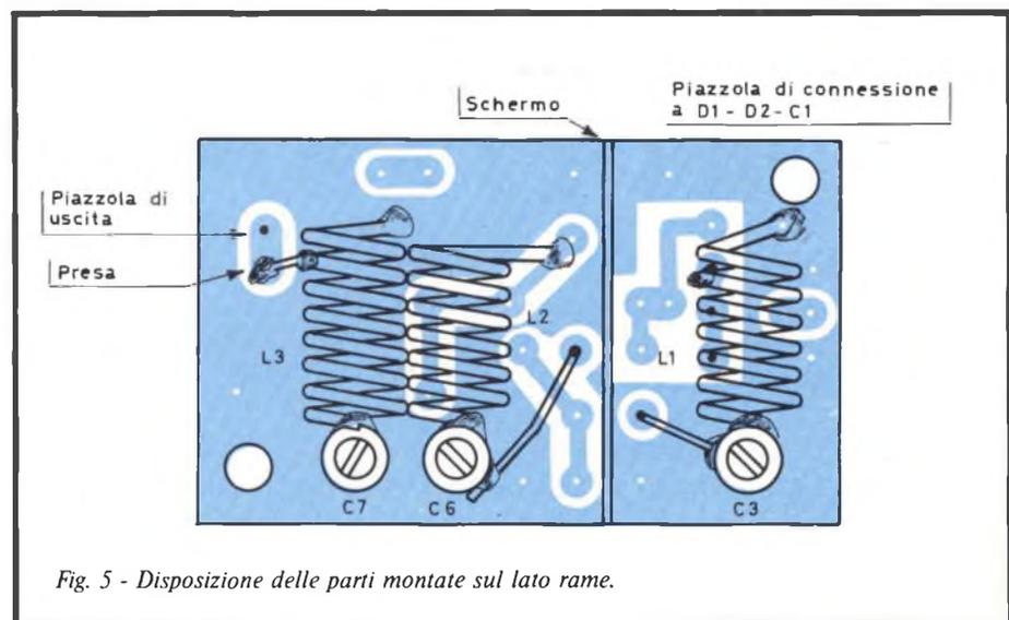
Fig. 5 - Disposizione delle parti montate sul lato rame.
