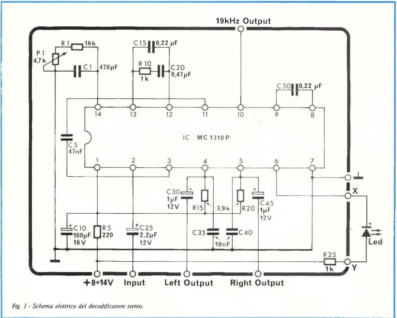
Fig. 1 - Schema elettrico del decodificatore stereo.
