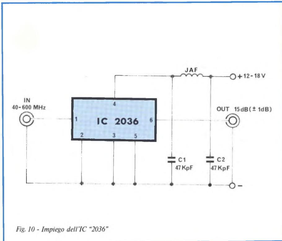
Fig. 10 - Impiego dell'IC "2036"
