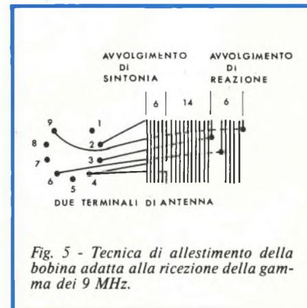
Fig. 5 - Tecnica di allestimento della bobina adatta alla ricezione della gamma dei 9 MHz.
