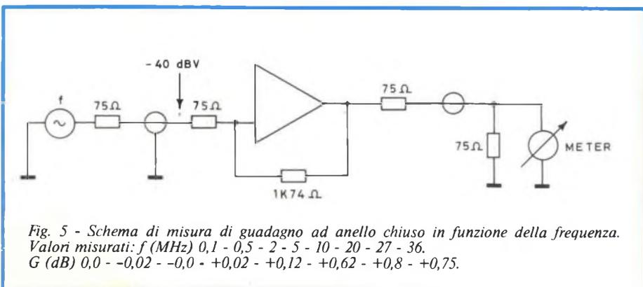
Fig. 5 - Schema di misura di guadagno ad anello chiuso in funzione della frequenza. Valori misurati: f (MHz) 0,1 - 0,5 - 2 - 5 - 10 - 20 - 27 - 36. G (dB) 0,0 - -0,02 - -0,0 - +0,02 - +0,12 - +0,62 - +0,8 - +0,75.
