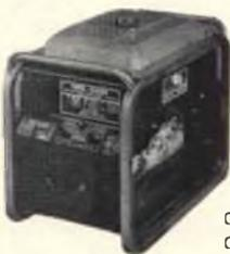
Motore "ASPERA" 4 tempi a benzina 1000 W a 220 Vac (50 Hz) e contemporaneamente 12 Vcc - 20 A o 24 Vcc - 10 A per carica batterie dimensioni 490 per 290 per 420 mm Kg. 28 viene fornito con garanzia e istruzioni per l'uso
