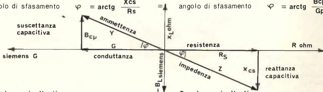
Se il circuito da trasformare è di tipo parallelo, si avrà il seguente
