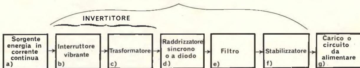
Sorgente e carico intervengono nel progetto del convertitore con le loro caratteristiche e possono modificare il comportamento del convertitore stesso.
