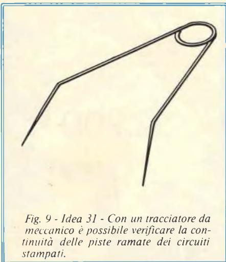
Fig. 9 - Idea 31 - Con un tracciatore da meccanico è possibile verificare la continuità delle piste ramate dei circuiti stampati.
