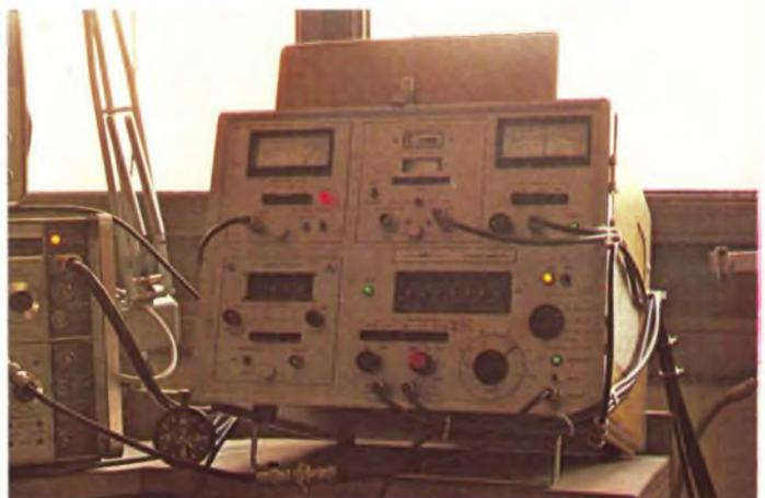
Fig. 1 - Generatore e monitor di frequenza e deviazione in P II Systron-Danner 1327 C (10 kHz ~ 1000 MHz). F = 27.135.0 kHz - 30 dBm CW/FM/AM.
