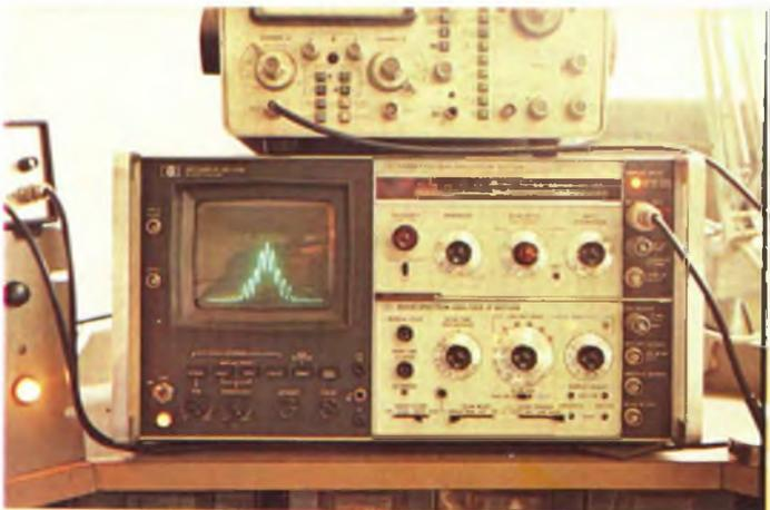
Fig. 5 - AN/SP HP 141T. In display -30 dBm AM/AL 100% di modulazione con tono di 1000 Hz. F = 27.135 kHz.
