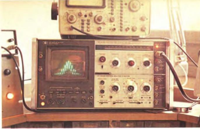
Fig. 6 - AN/SP HP 141T. Display di 5 W riferiti a -30 dBm/AM al 100%.  $F_0 = 27.135 \text{ kHz} - F_{mod} = 1250 \text{ Hz}$ .
