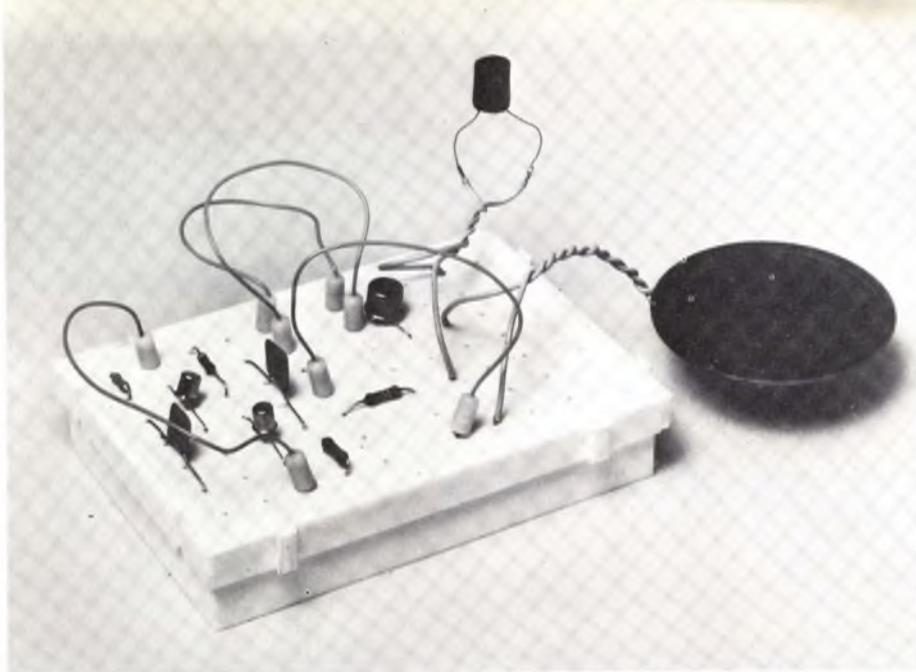
Fig. 2 - Convertitore "luce-frequenza" realizzato su matrice S-DeC.
