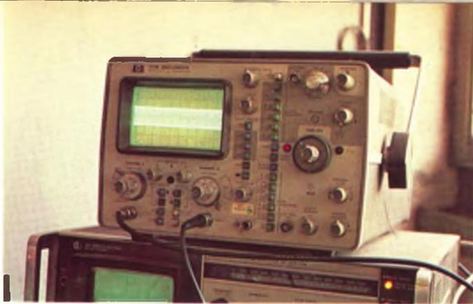
Fig. 2 - Oscilloscopio HP 1710B 2 x 200 MHz 0,5 mV in display -30 dBm/ CW/FM. F = 27.135 kHz.
