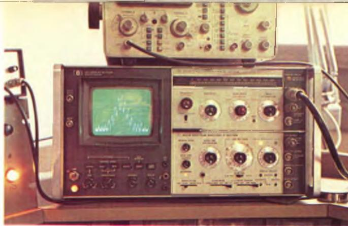
Fig. 13 - AN/SP HP 141T. In display 3 W AM 100% con segnale modulante a prescrizione di eccezionale contenuto armonico.  $F = 27.135$  kHz.
