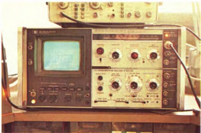
Fig. 4 - AN/SP HP 141T. In display -30 dBm FM/DF 5 kHz con tono di 1000 Hz. F = 27.135 kHz.
