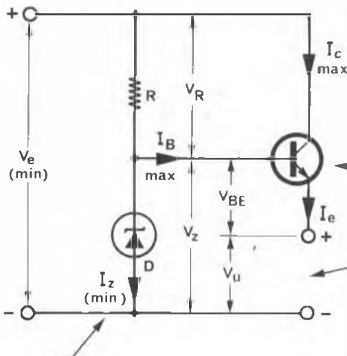
(3) Il transistor prescelto richiederà una certa tensione  $V_{BE}$  per funzionare con la corrente  $I_c$ .
