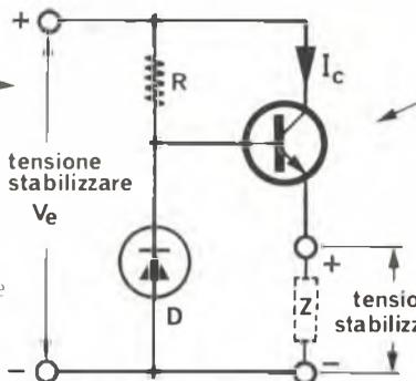
Qui vediamo il transistor in una particolare funzione di resistenza dissipatrice dello stabilizzatore
