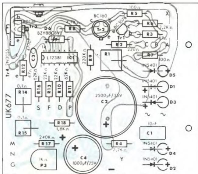
Fig. 2 - Disposizione dei componenti sulla base dell'alimentatore stabilizzato UK 677.
