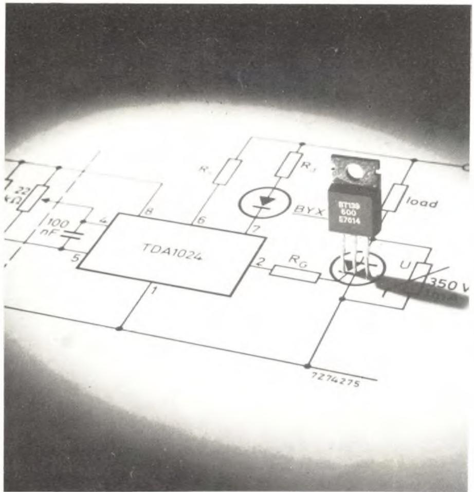
Un sistema di regolazione della temperatura a termostato è costituito essenzialmente da un "sensore" della temperatura (resistore NTC) e da un interruttore che applica la tensione della rete all'elemento riscaldante.
