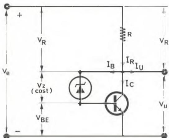
L'aumento della resistenza del carico fa diminuire la corrente  $I_U$  che lo attraversa. Anche la  $I_R$  perciò diminuisce
