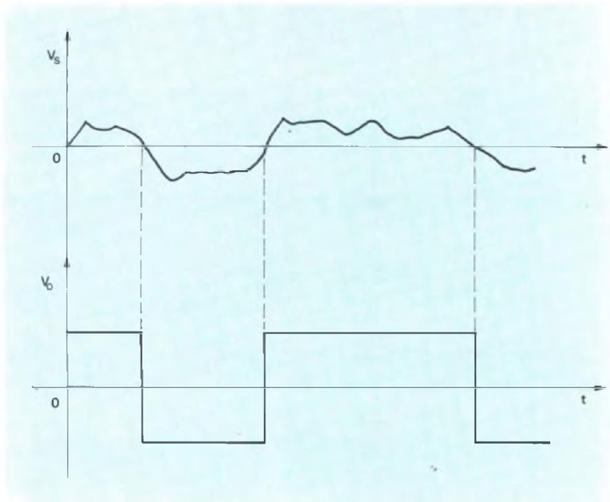
Fig. 3/b - Comportamento di un comparatore semplice nei confronti di una tensione di rumore applicata al suo ingresso.
