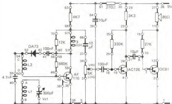
Fig. 1 - Schema elettrico del ricevitore per onde medie.
