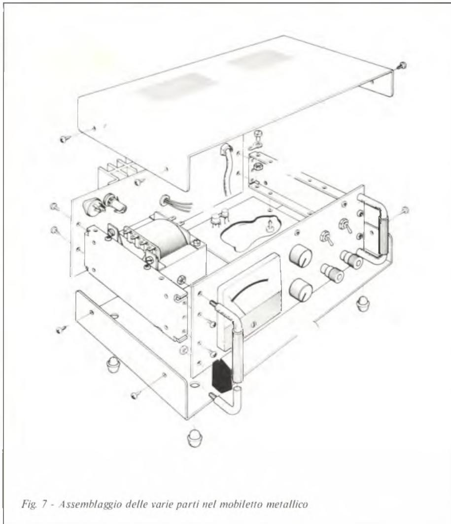
Fig. 7 - Assemblaggio delle varie parti nel mobiletto metallico
