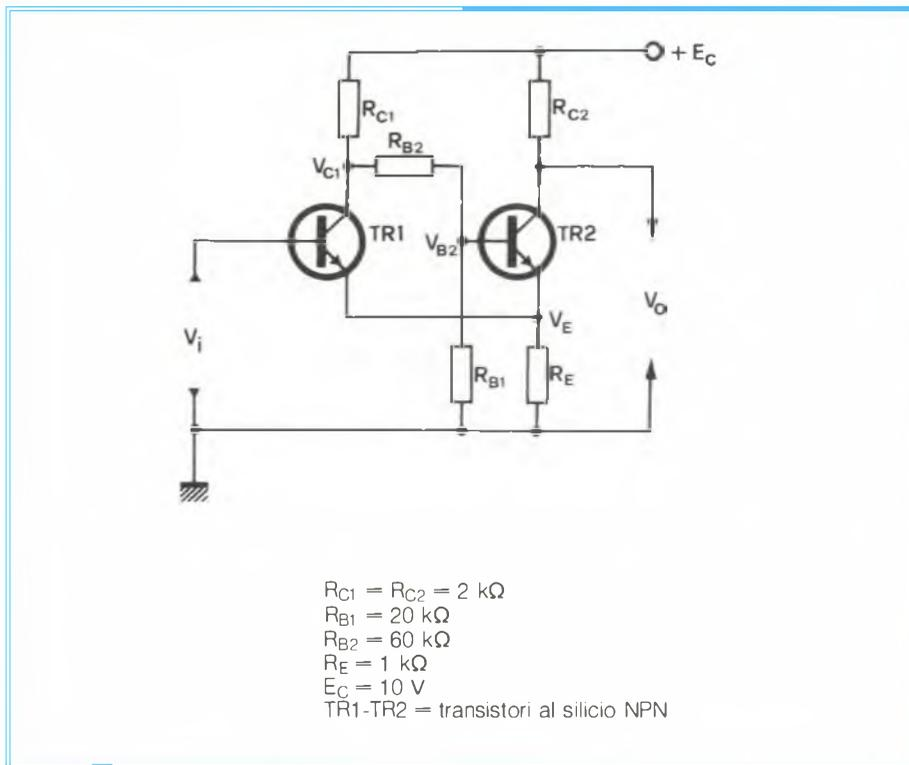
Fig. 1 - Schema di principio di un circuito Trigger di Schmitt a transistori; a fianco è riportato il valore di alcuni componenti a titolo semplificato.
