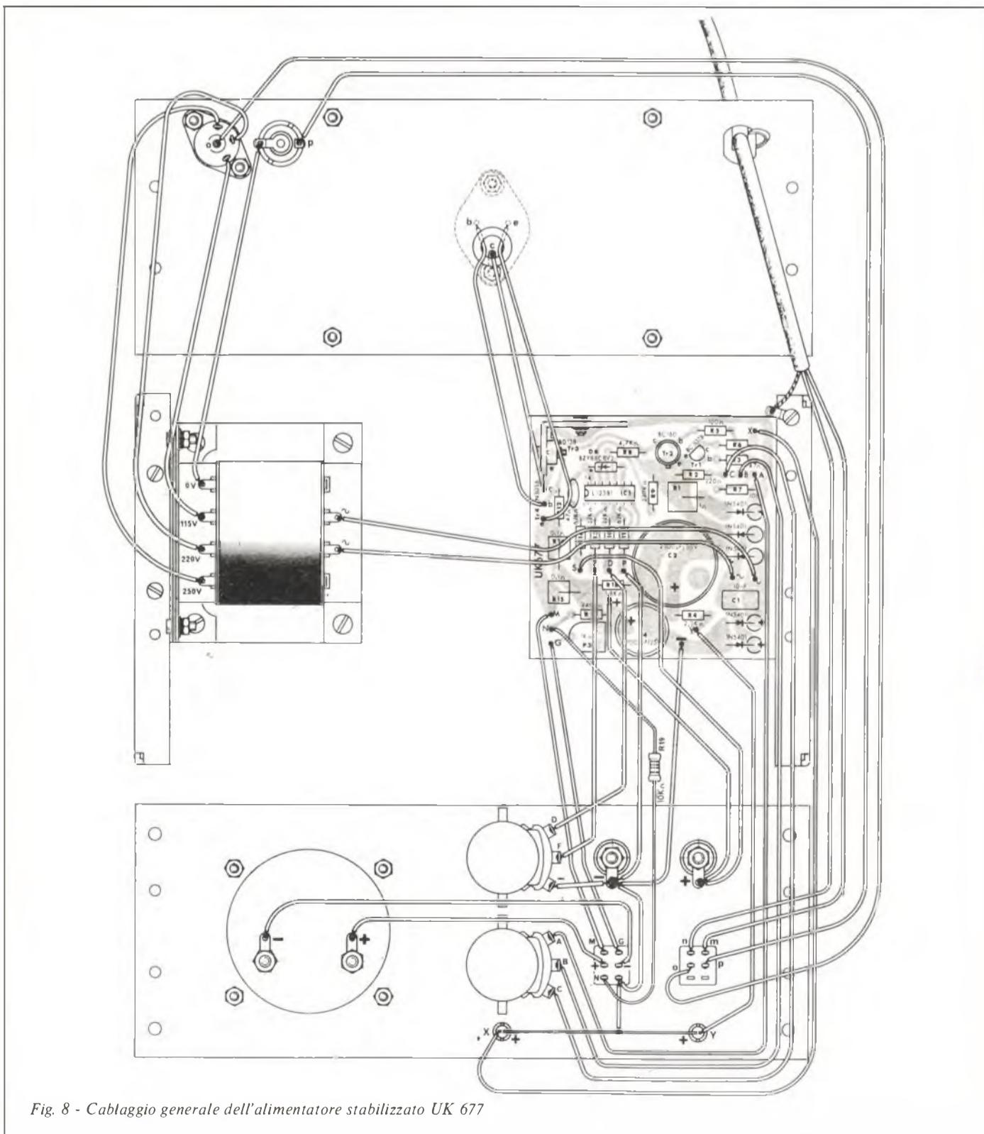
Fig. 8 - Cablaggio generale dell'alimentatore stabilizzato UK 677
