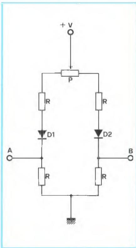
Fig. 8 - Circuito a ponte per la misura differenziale di temperature: la conversione *temperatura/tensione* è realizzata dalla coppia di diodi al silicio D1 e D2.
