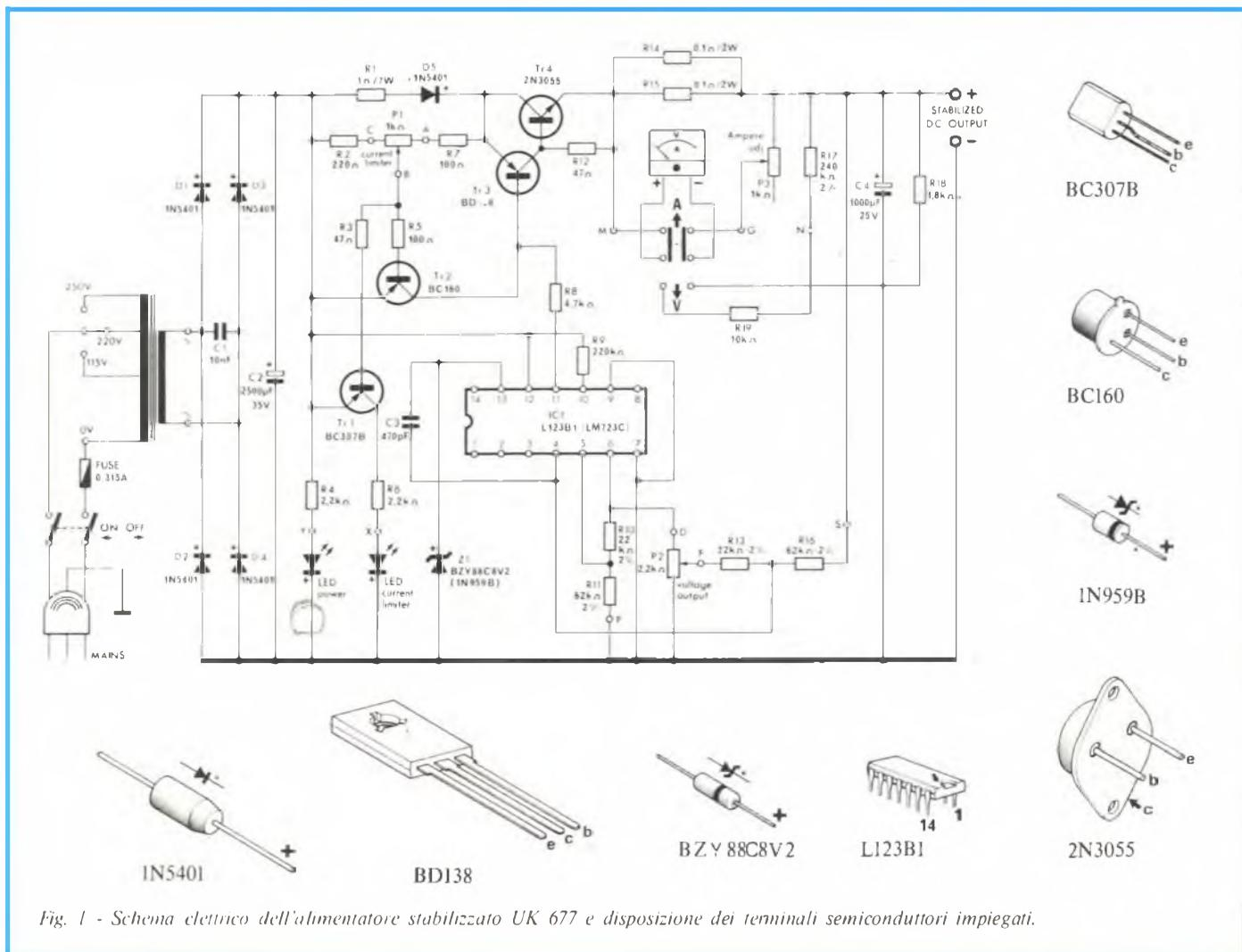
Fig. 1 - Schema elettrico dell'alimentatore stabilizzato UK 677 e disposizione dei terminali semiconduttori impiegati.
