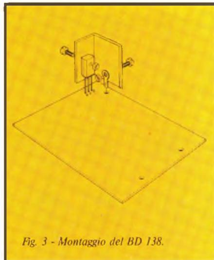
Fig. 3 - Montaggio del BD 138.
