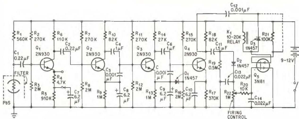
Fig. 1 - Schema elettrico di un rivelatore di infrarossi.
