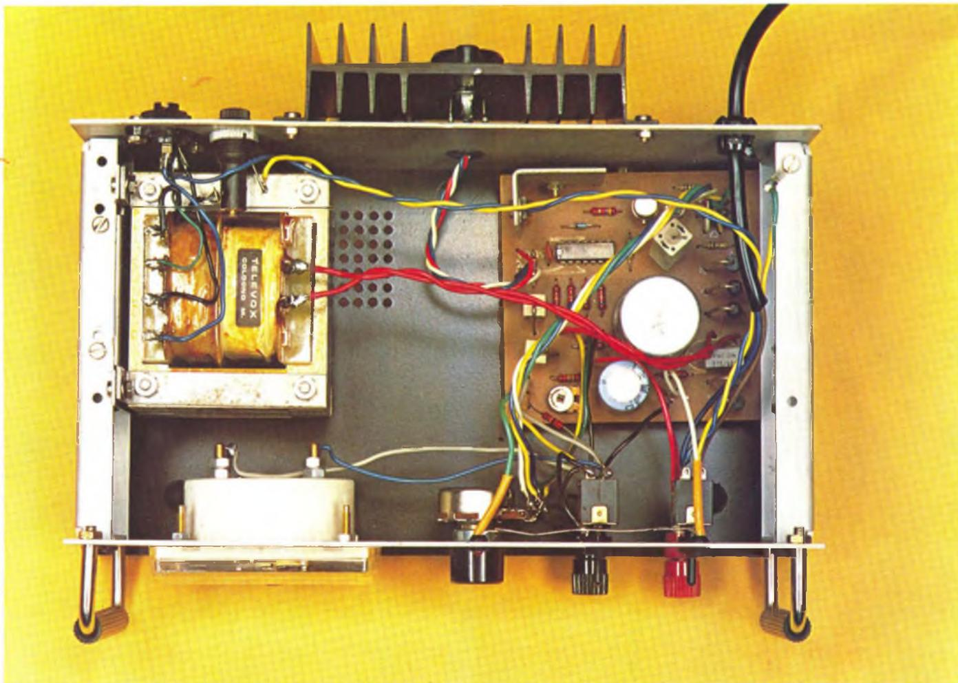
Vista interna dell'alimentatore stabilizzato  $0 \div 20$  Vcc / 2,5 A.
