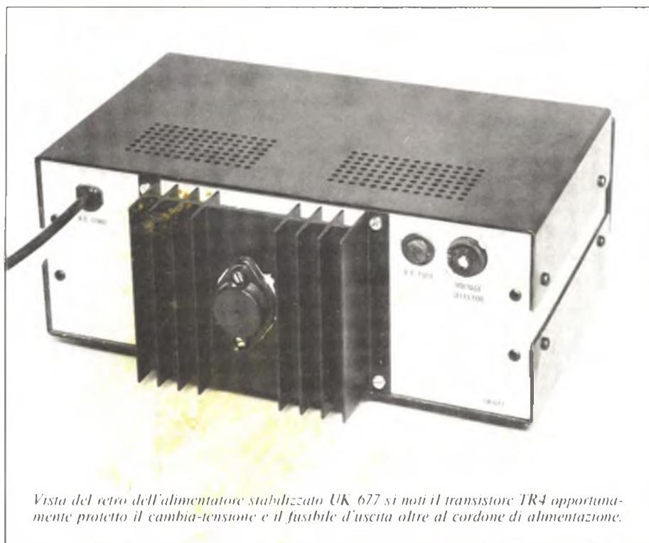
Vista del retro dell'alimentatore stabilizzato UK 677 si noti il transistor TR4 opportunamente protetto il cambia-tensione e il fusibile d'uscita oltre al cordone di alimentazione.
