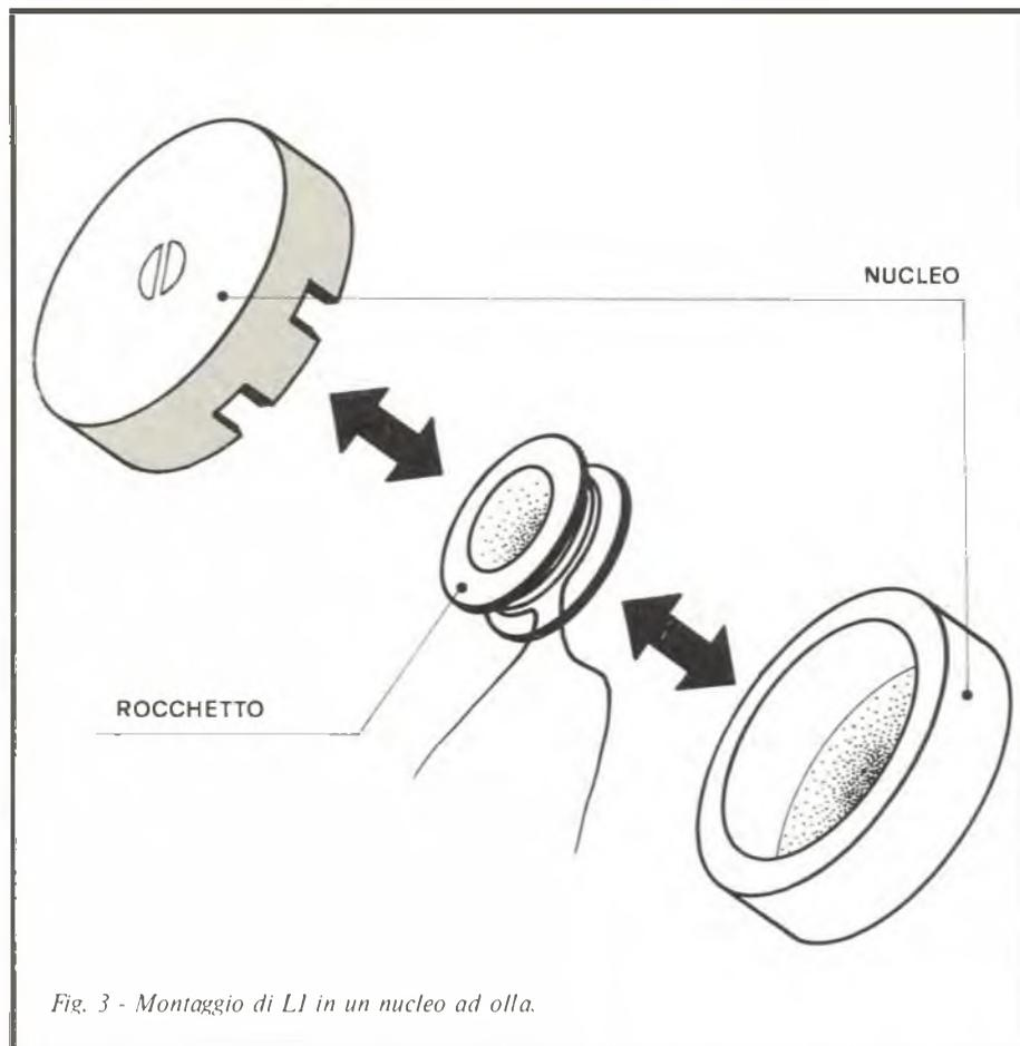
Fig. 3 - Montaggio di L1 in un nucleo ad olla.
