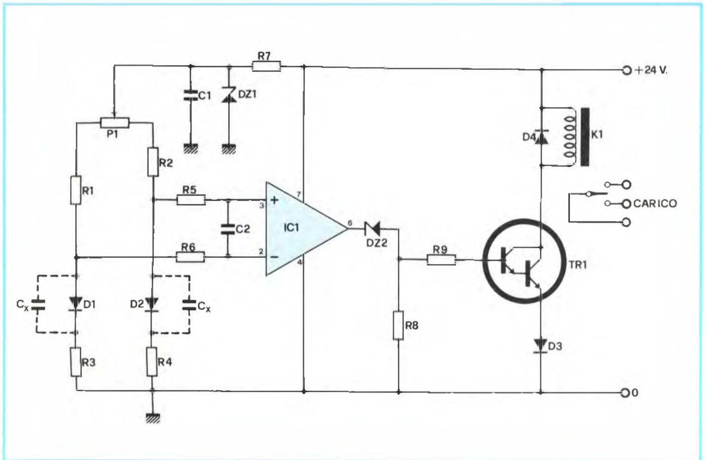
Fig. 9 - Schema elettrico completo della sonda rivelatrice di temperature differenziali con comando di potenza a relè. I condensatori  $C_x$  ( $0,47 \mu F - 50 V$  ceramici) sono usati quando i cavi di collegamento delle due sonde hanno lunghezza notevole.
