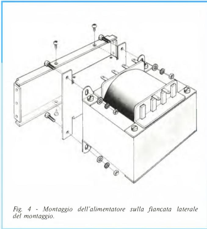
Fig. 4 - Montaggio dell'alimentatore sulla fiancata laterale del montaggio.
