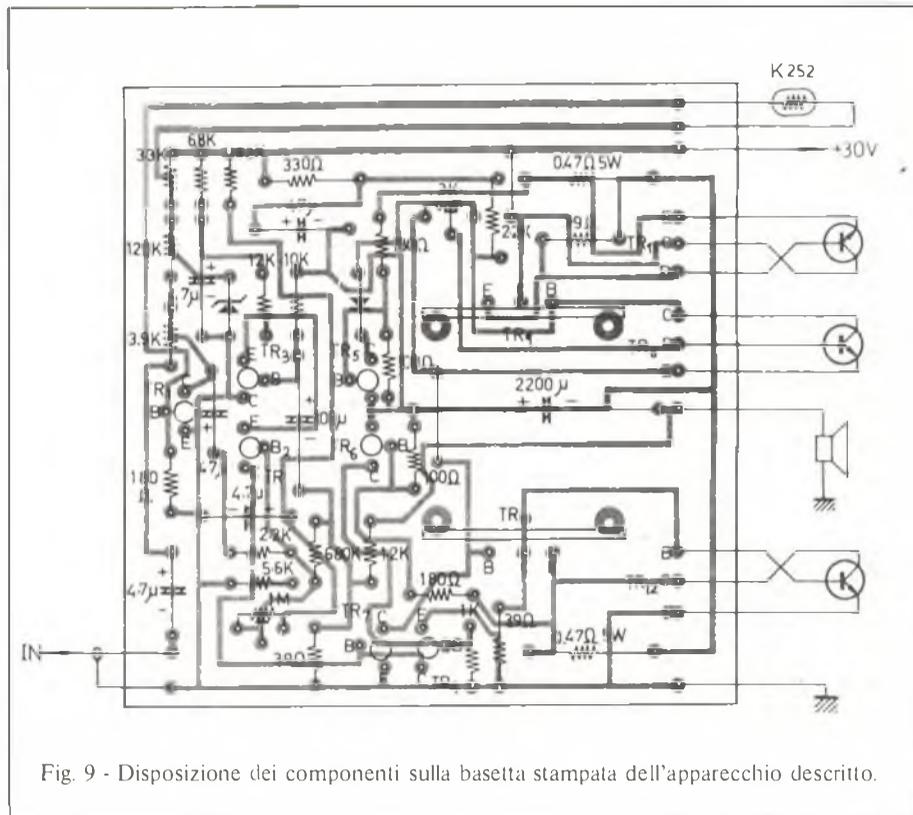
Fig. 9 - Disposizione dei componenti sulla basetta stampata dell'apparecchio descritto.
