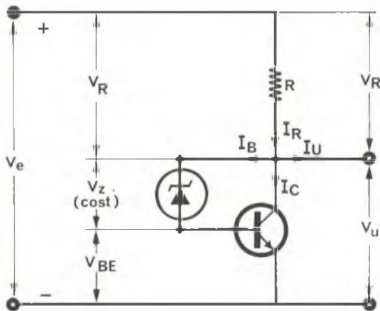
Una diminuzione della tensione entrante  $V_e$  provoca una diminuzione proporzionale della caduta di tensione  $V_R$ .
