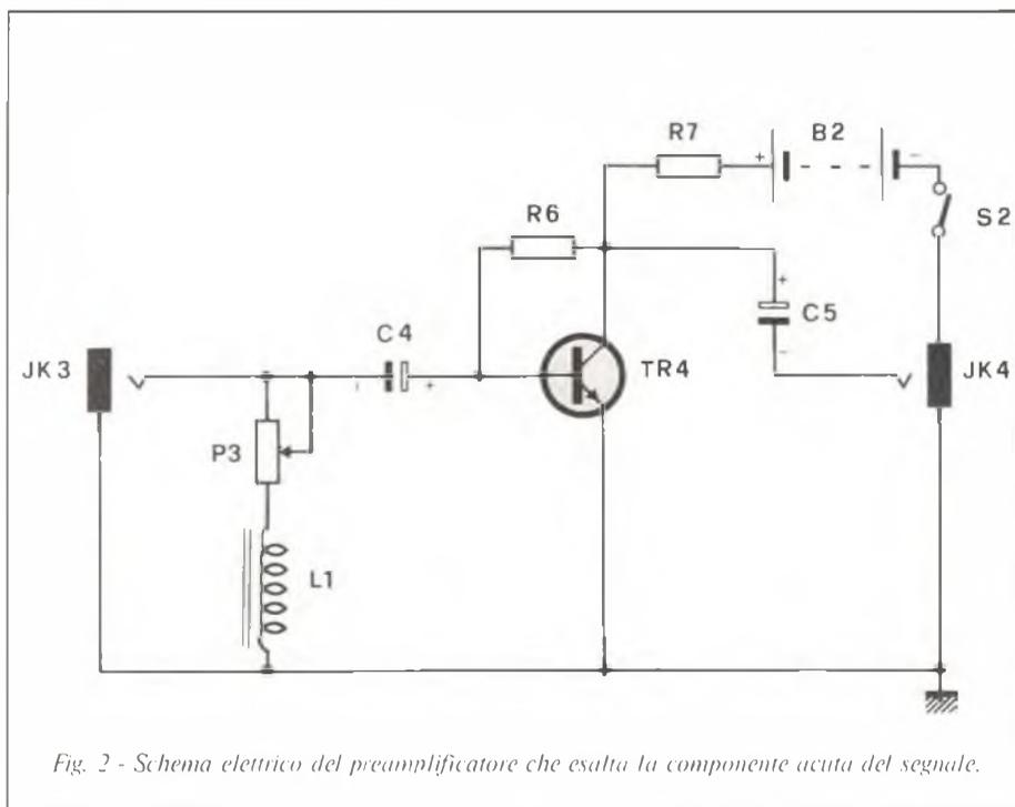
Fig. 2 - Schema elettrico del preamplificatore che esalta la componente acuta del segnale.
