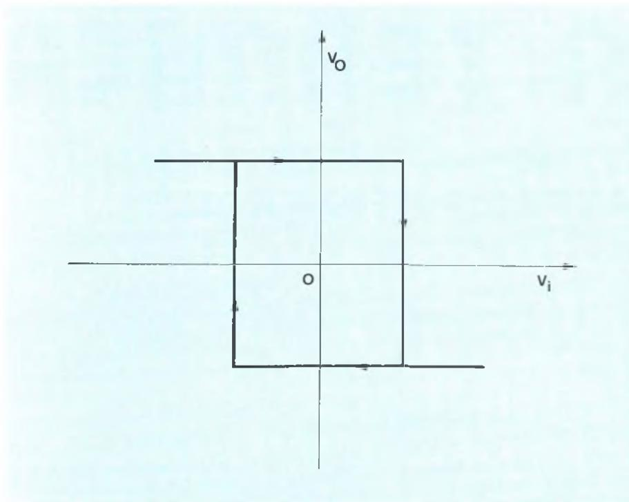
Fig. 5 - Ciclo di isteresi del circuito di fig. 4.
