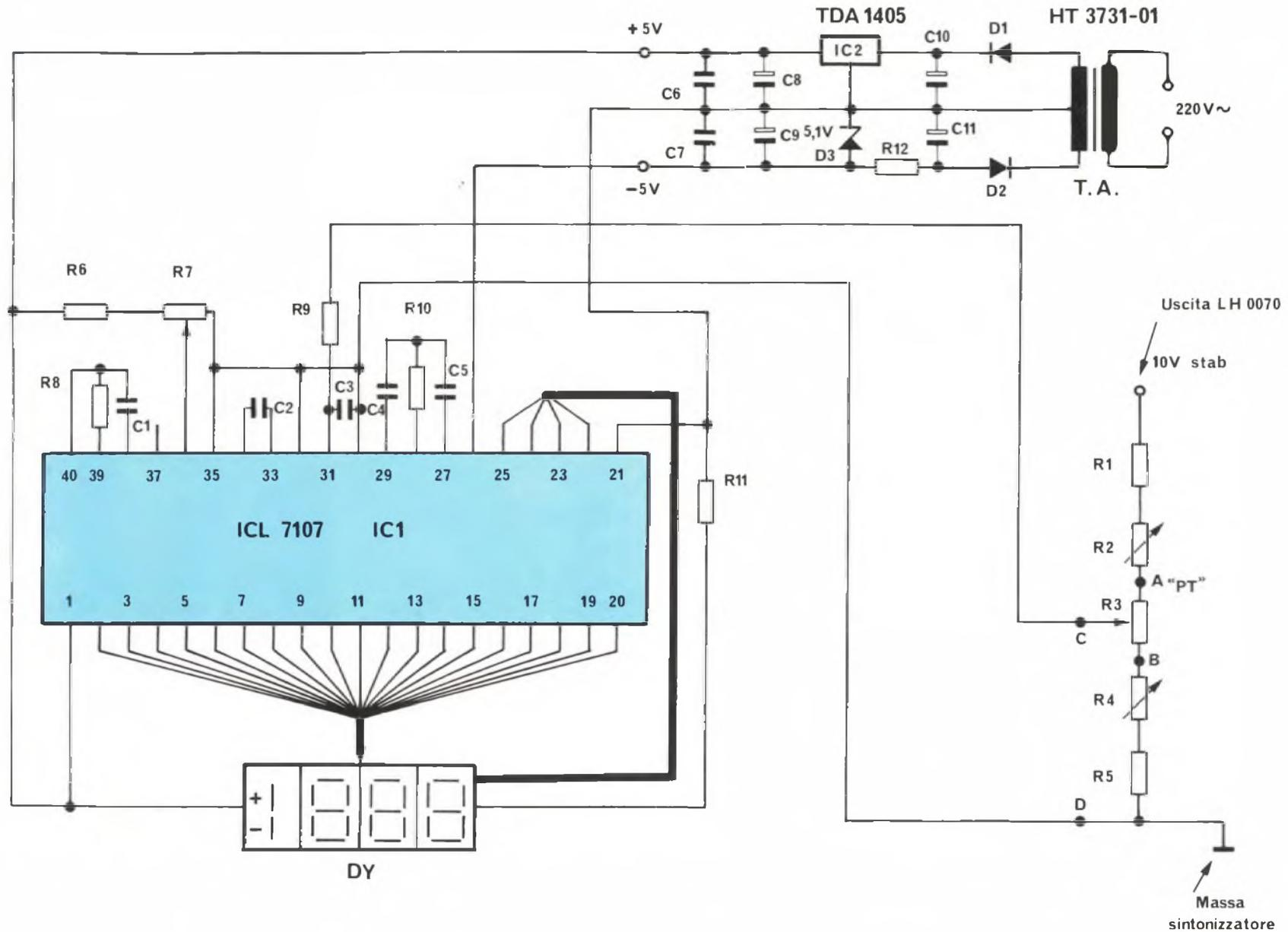
Fig. 1 - Circuito elettrico del visore digitale della sintonia. I componenti attorno all'integrato ICL 7107 formano un semplice millivoltmetro digitale; a destra in basso nella figura notiamo il partitore variabile ('PT' = potenziometro di sintonia); sempre sulla destra in alto il circuito di alimentazione.
