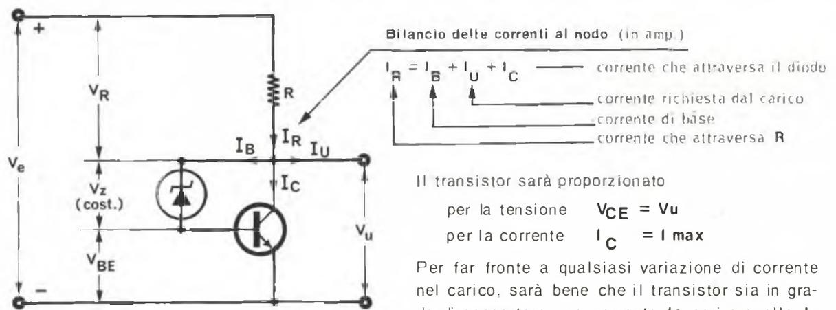
Il diodo zener sarà proporzionato per una corrente pari a quella IB di base e per una tensione
