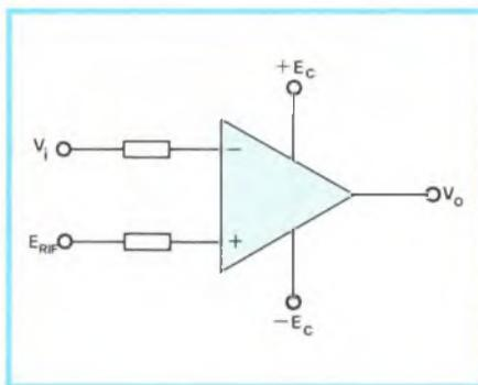
Fig. 7 - Comparatore semplice con amplificatore operazionale.
