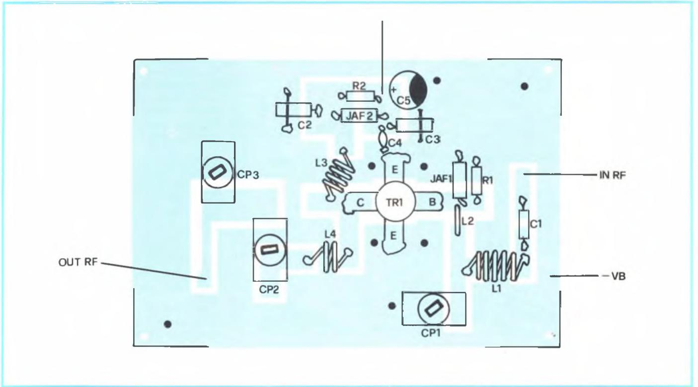
Fig. 3 - Disposizione dei componenti sulla basetta ramata. Effettuare buone connessioni con un saldatore di discreta potenza. I punti neri indicano i rivetti in ottone che uniscono i piani di massa inferiore e superiore.
