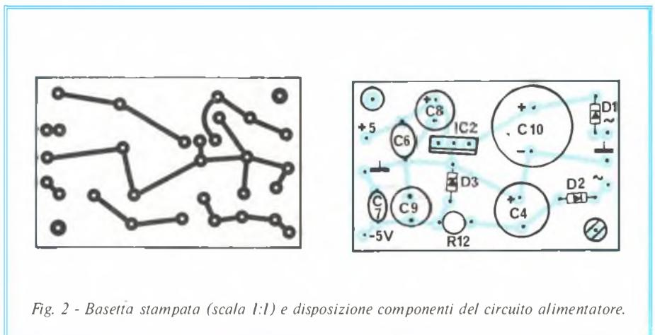
Fig. 2 - Basetta stampata (scala 1:1) e disposizione componenti del circuito alimentatore.
