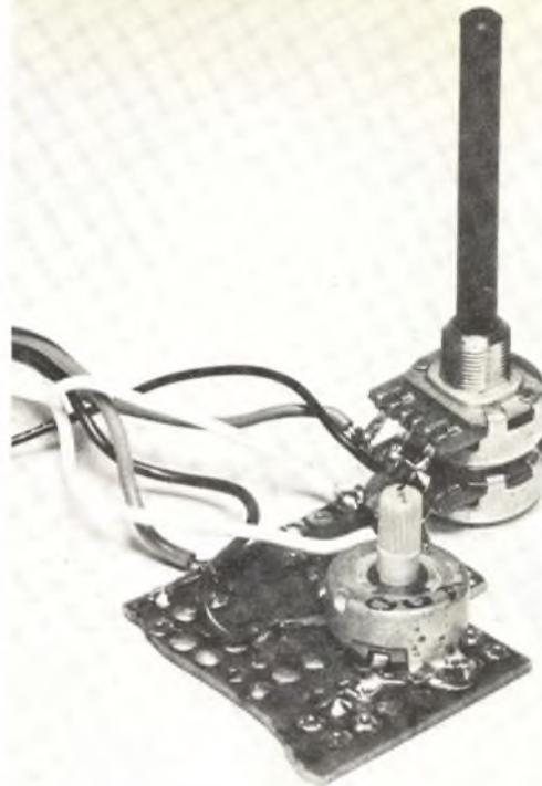
Montaggio della regolazione di uscita del Tremolo e del preamplificatore.
