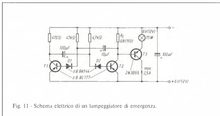
Fig. 11 - Schema elettrico di un lampeggiatore di emergenza.
