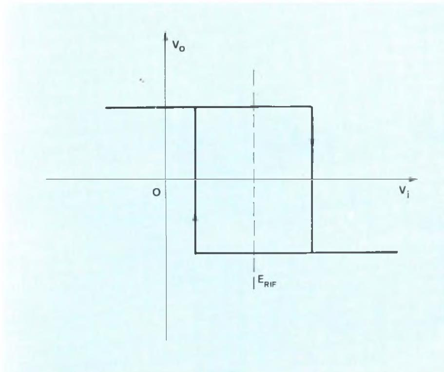
Fig. 6 - Ciclo di isteresi del circuito di fig. 4 con applicata al punto B una tensione di riferimento ( $E_{RIF}$ ).
