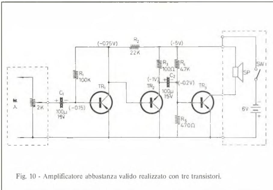
Fig. 10 - Amplificatore abbastanza valido realizzato con tre transistori.
