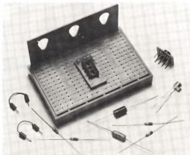
Doppie molle in bronzo fosforoso assicurano ottimi contatti fino a 10.000 inserimenti. Il diametro massimo dei conduttori dei componenti che si possono inserire è di 1 mm:
