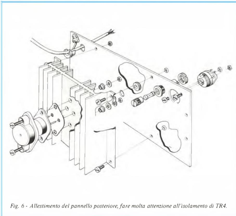
Fig. 6 - Allestimento del pannello posteriore, fare molta attenzione all'isolamento di TR4.
