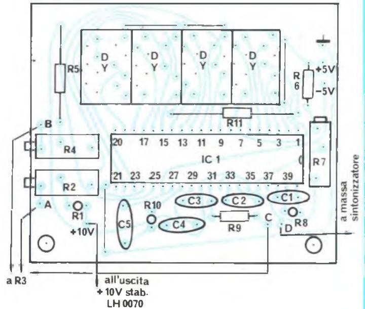
Fig. 3 - Basetta stampata e disposizione dei componenti relativa all'indicatore digitale. Tenere presente che IC1 deve essere maneggiato con estrema cura, senza toccare nessuno dei suoi piedini finché non è alloggiato nello zoccolo.
