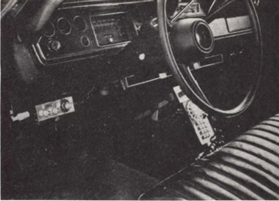
Fig. 5 - Sistemazione errata di un baracchino CB.
