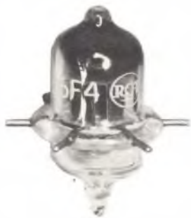
Fig. 14 - Ecco un vero e proprio tubo "ghianda". Si tratta del 6F4, che ogni collezionista paga volentieri, se nuovo, un migliaio di lire.
