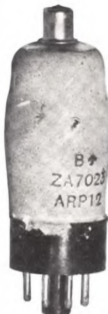
Fig. 13 - Pentodo ad accensione diretta ARP12-ZA7023. È il tubo più comune in assoluto in tutte le apparecchiature militari britanniche della seconda guerra mondiale. Anche questo, data la diffusione è ritenuto un "ricambio" e come tale venduto sulle 1.600 lire, nuovo.
