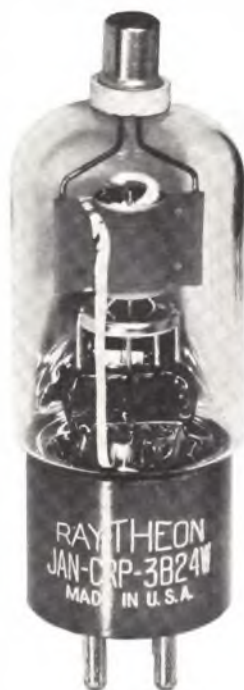
Fig. 11 - Rettificatore per radar e strumenti di misura 3B24. Si tratta di un tubo speciale, ambito dai collezionisti "specializzati" che se nuovo costa intorno alle 4.000 lire.
