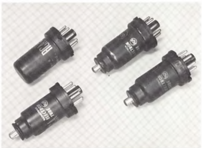
Fig. 8 - Altri tubi - pseudo-ghianda" Wehrmacht, da considerarsi, all'epoca in cui furono progettati, veri capolavori di tecnica. I modelli sono RV12P2000 ed STV150/15, il loro valore è intorno alle 1.000 lire l'uno se usati, ed il doppio nuovi; il triplo se nella scatola originale.
