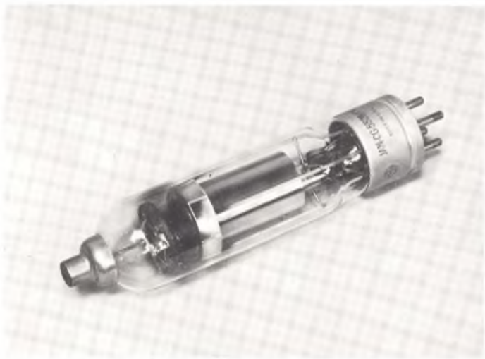
Fig. 15 - Tyratron per Radar C6L/JAN5528. Si tratta di un elemento dalla mole già importante, trattato sulle 5.000 lire usato (nuovo ha un prezzo ancora attuale, nel mercato dei ricambi speciali - militari).
