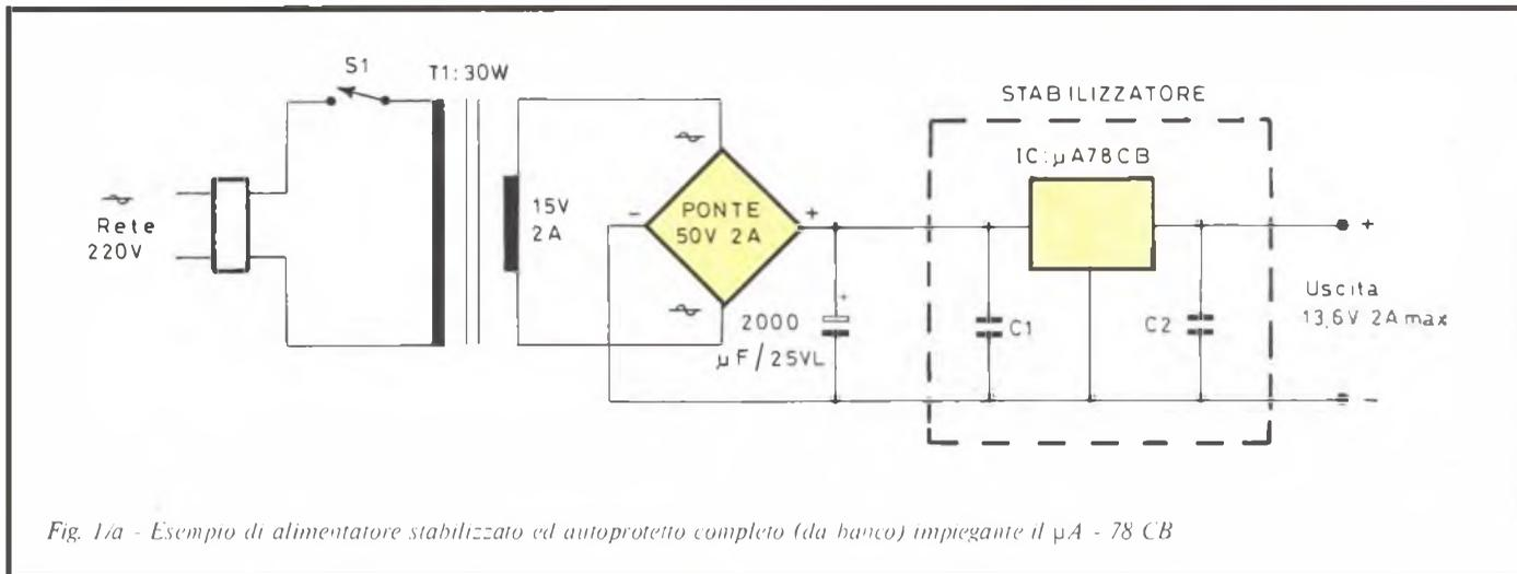
Fig. 1/a - Esempio di alimentatore stabilizzato ed autoprotetto completo (da banco) impiegante il  $\mu A - 78 CB$
