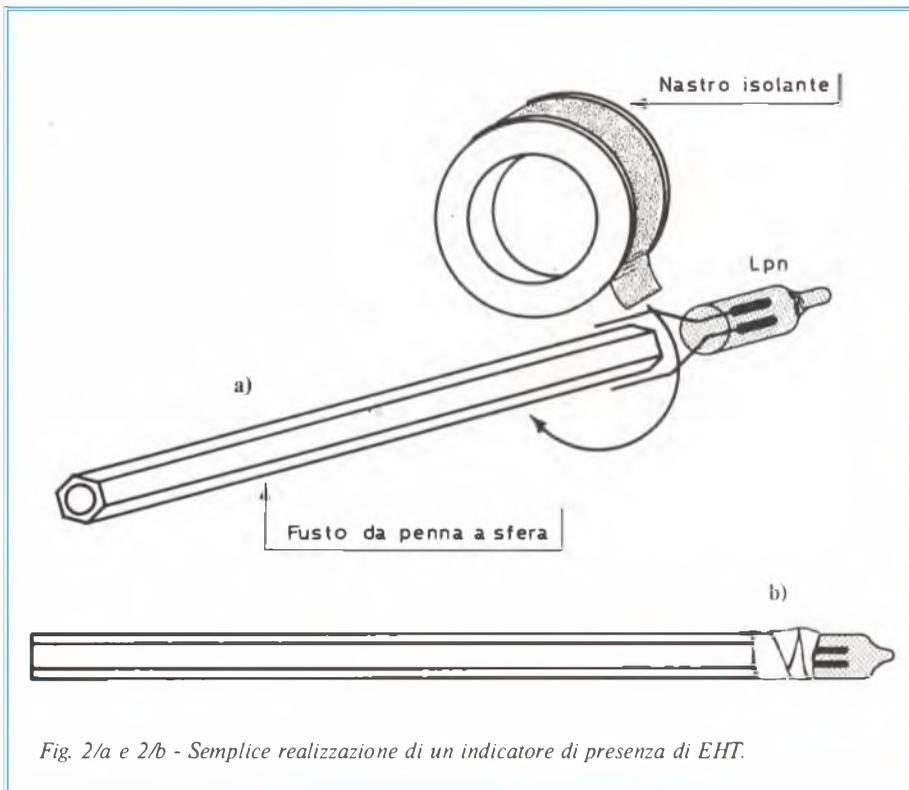
Fig. 2/a e 2/b - Semplice realizzazione di un indicatore di presenza di EHT.
