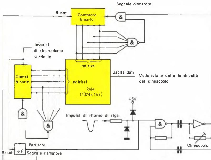
Fig. 1 - Schema di principio del caleidoscopio elettronico. Suddividendo lo schermo in quattro superfici riflesse specularmente si riduce la capacità della RAM a 256 bit.
