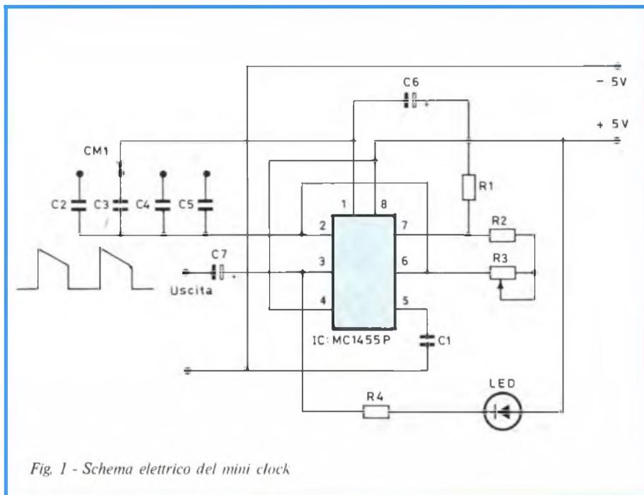
Fig. 1 - Schema elettrico del mini clock
