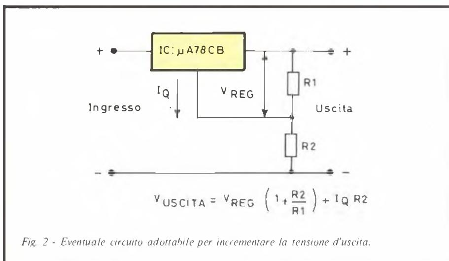
Fig. 2 - Eventuale circuito adottabile per incrementare la tensione d'uscita.
