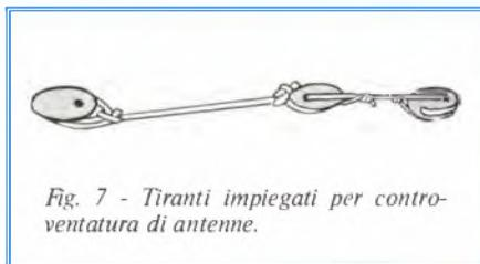
Fig. 7 - Tiranti impiegati per controventatura di antenne.
