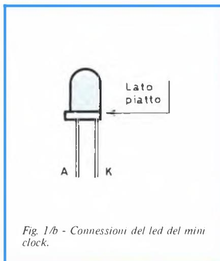
Fig. 1/b - Connessioni del led del mini clock.
