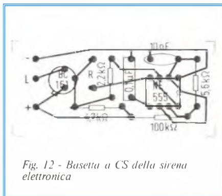
Fig. 12 - Basetta a CS della sirena elettronica
