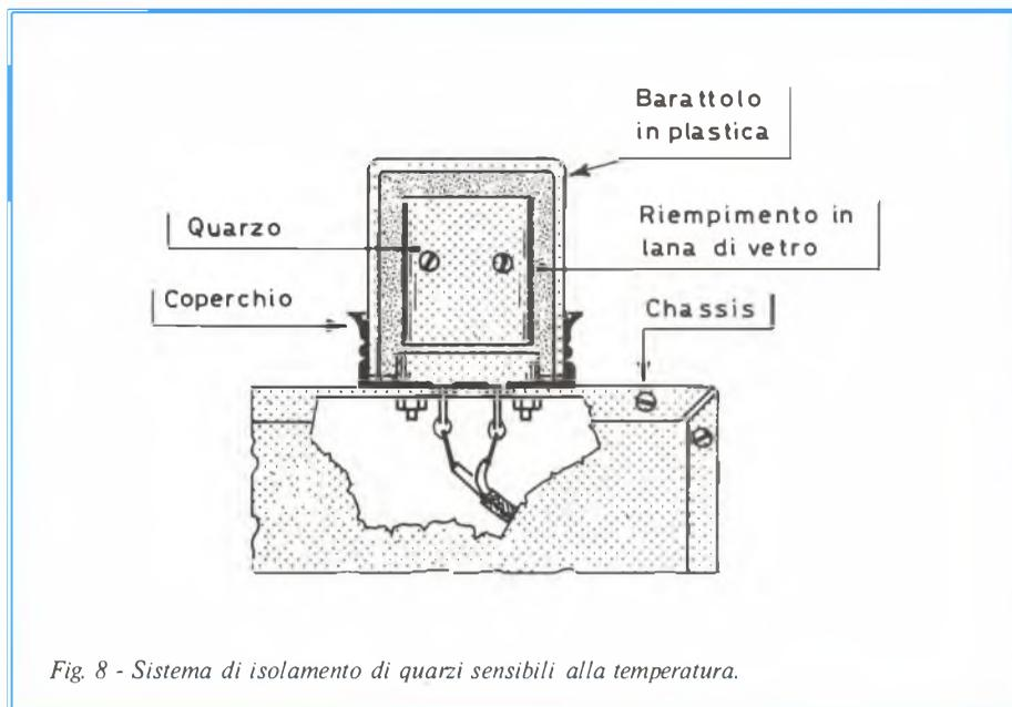
Fig. 8 - Sistema di isolamento di quarzi sensibili alla temperatura.
