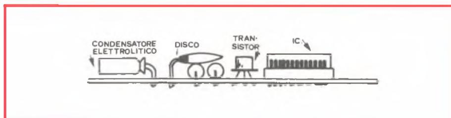
Fig. 3 - Basetta stampata tipo a montaggio ultimato e vista in sezione: notare i componenti piegati, anche su altri, per contenere l'altezza del montaggio.
