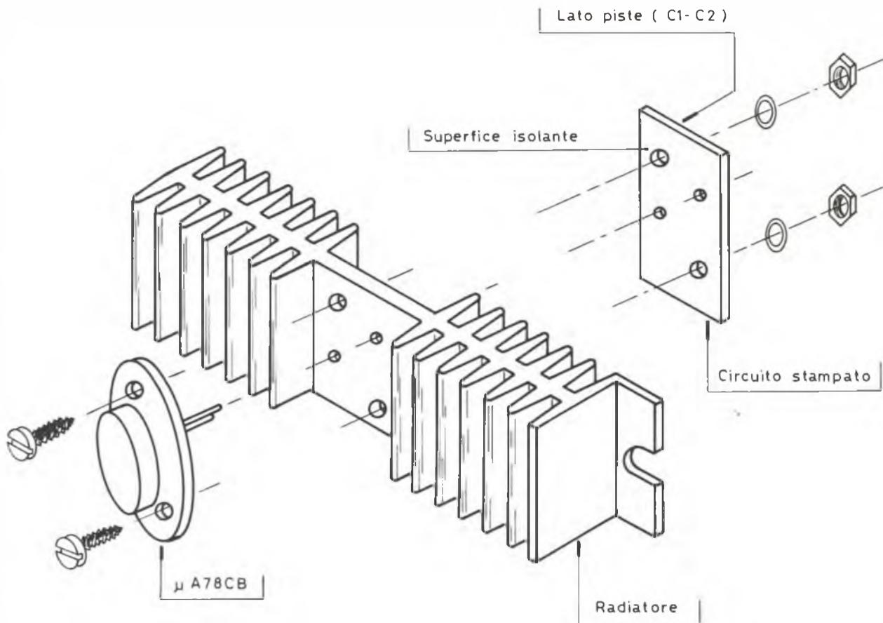
Fig. 4 - Esploso di montaggio dello stabilizzatore.
