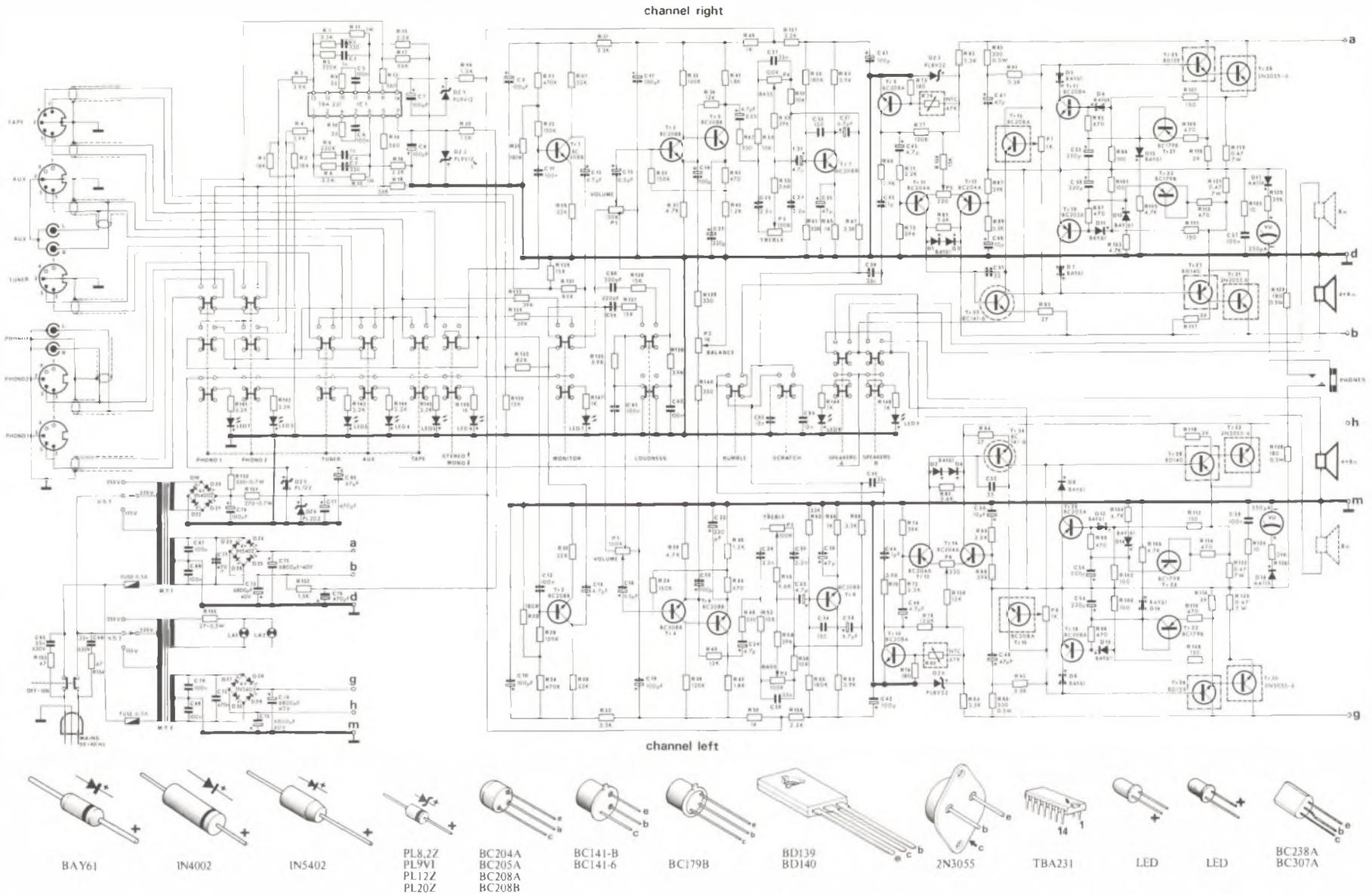
Fig. 1 - Schema elettrico dell'amplificatore da 50 + 50 W, UK 193 e disposizione dei terminali dei semiconduttori impiegati.
