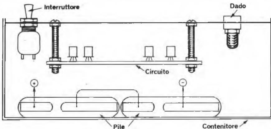
Fig. 7 - Alloggiamento delle parti nella scatola.
