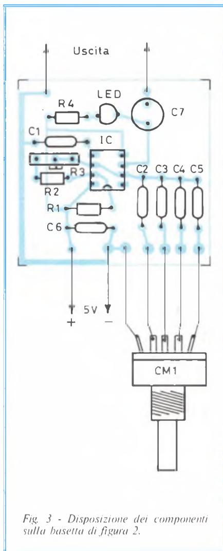
Fig. 3 - Disposizione dei componenti sulla basetta di figura 2.
