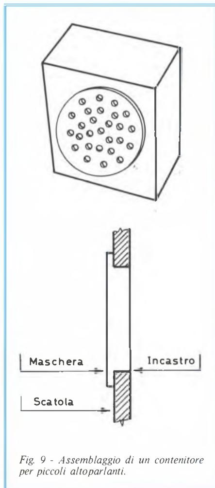
Fig. 9 - Assemblaggio di un contenitore per piccoli altoparlanti.
