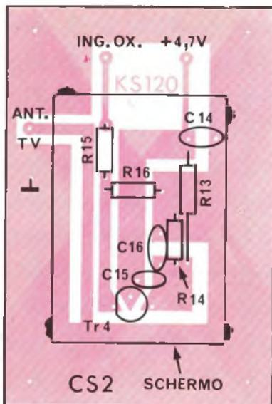
Fig. 3 - Disposizione dei componenti sulla bauletta dell'oscillatore R.F. (I componenti sono saldati sul lato rame).
