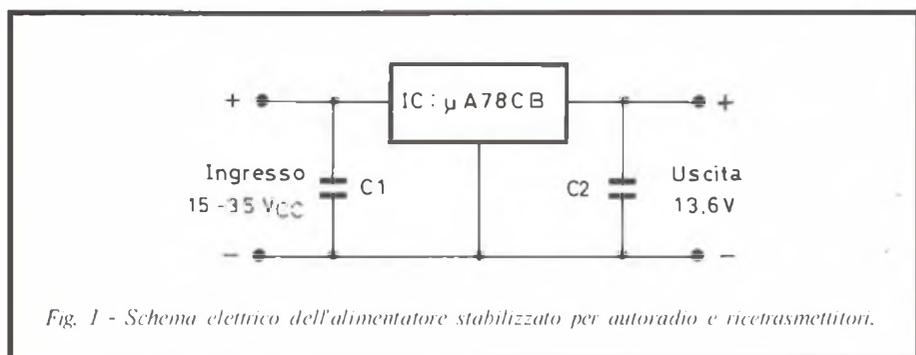
Fig. 1 - Schema elettrico dell'alimentatore stabilizzato per autoradio e ricetrasmittitori.
