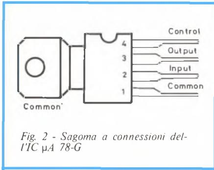
Fig. 2 - Sagoma a connessioni dell'IC  $\mu A$  78-G
