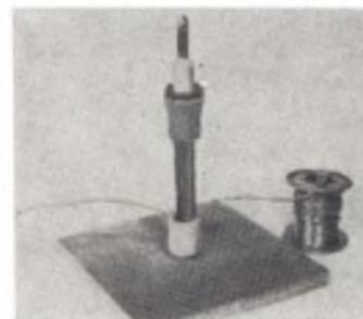
Fig. 16 - Portasaldatore realizzato con un'assicella e un piede in gomma per tavolini o seggiole.
