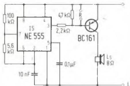
Fig. 11 - Schema elettrico di una sirena elettronica miniatura.
