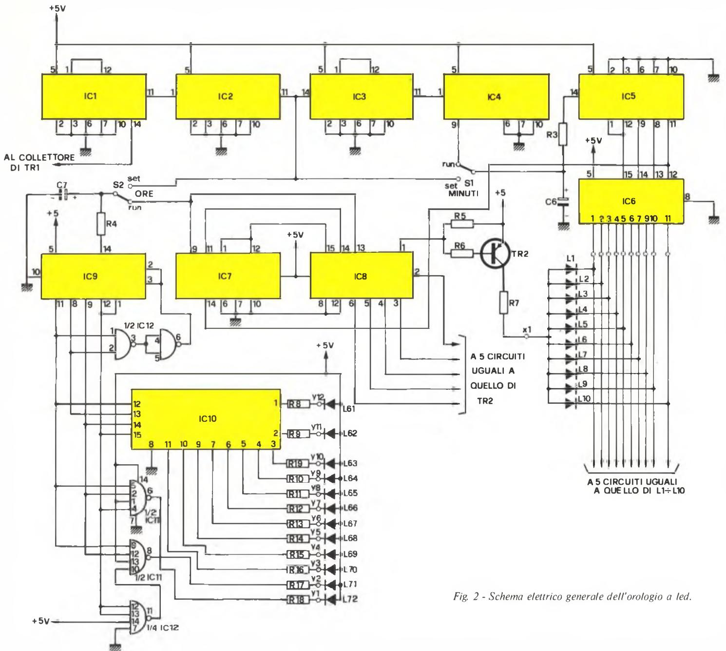
Fig. 2 - Schema elettrico generale dell'orologio a led.
