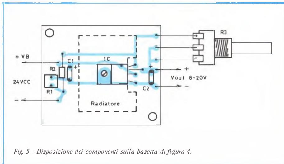
Fig. 5 - Disposizione dei componenti sulla bassetta di figura 4.
