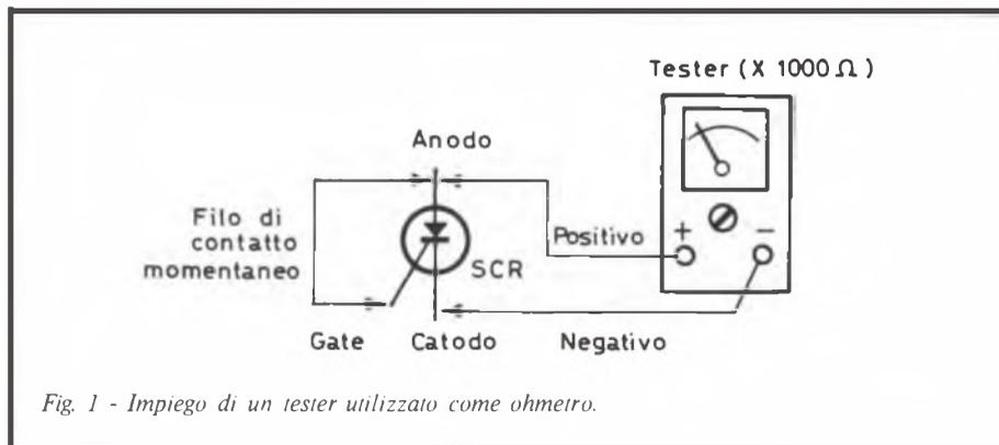
Fig. 1 - Impiego di un tester utilizzato come ohmetro.
