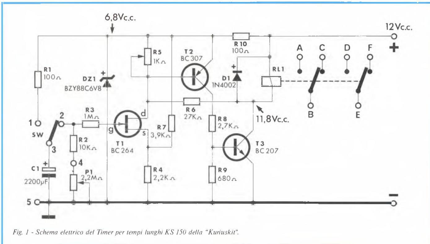
Fig. 1 - Schema elettrico del Timer per tempi lunghi KS 150 della "Kuriuskit".
