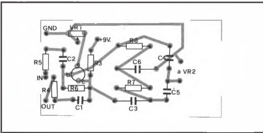
Fig. 10 - Piano di montaggio dell'effetto WAA-WAA.
