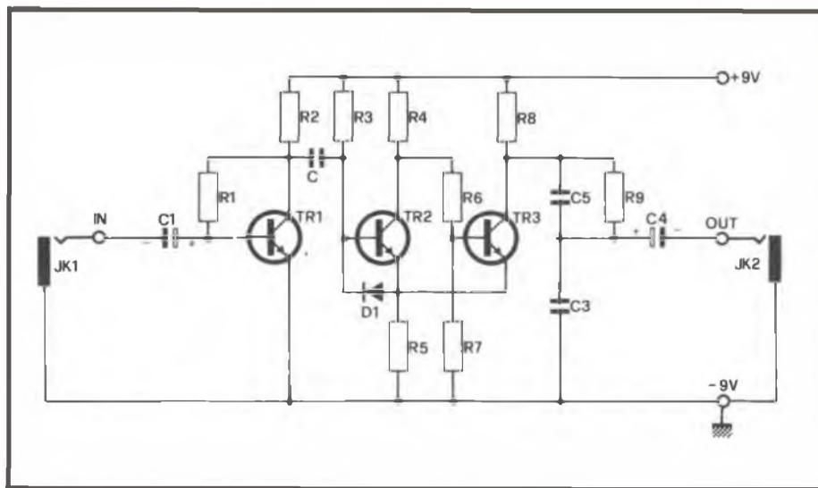
Fig. 5 - Schema elettrico dell'effetto di FUZZ MELLOW.
