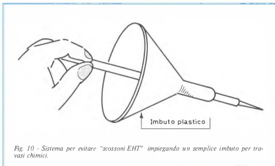
Fig. 10 - Sistema per evitare "scossoni EHT" impiegando un semplice imbuto per travasi chimici.
