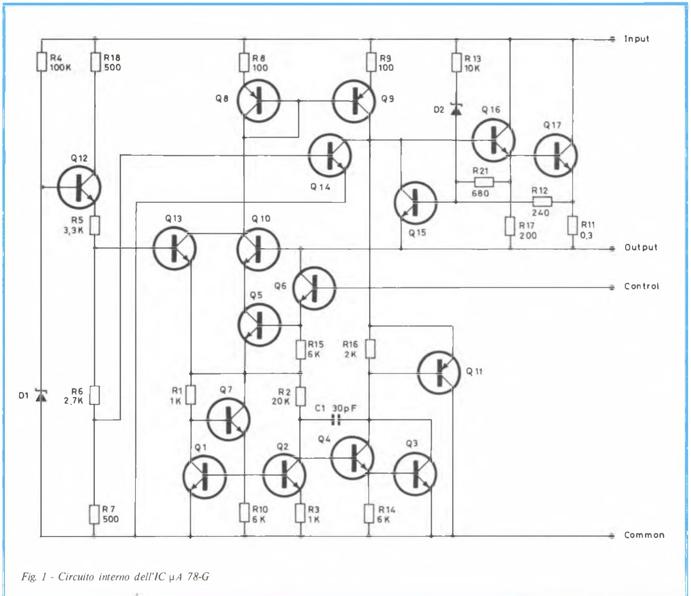
Fig. 1 - Circuito interno dell'IC  $\mu A$  78-G
