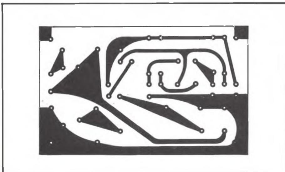
Fig. 4 - Bassetta a circuito stampato in scala 1:1.
