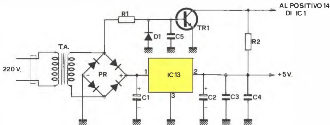
Fig. 1 - Circuito alimentatore dell'orologio a led.
