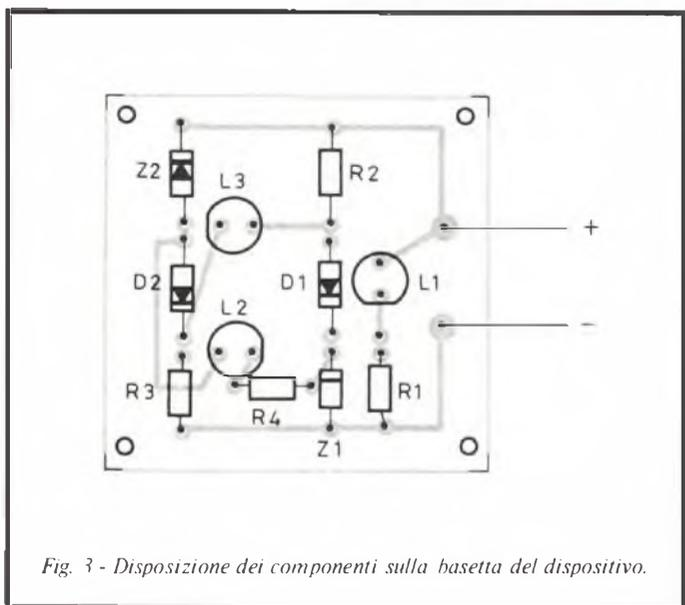
Fig. 3 - Disposizione dei componenti sulla basetta del dispositivo.
