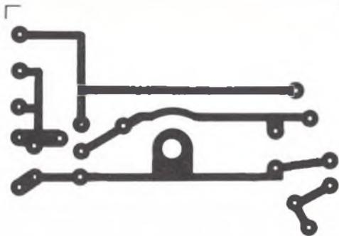
Fig. 4 - Basetta a circuito stampato in scala 1:1 del regolatore di velocità per motorini.
