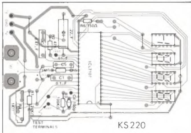
Fig. 2 - Disposizione dei componenti sulla basetta del millivolmetro KS 220 della "Kariuskit".
