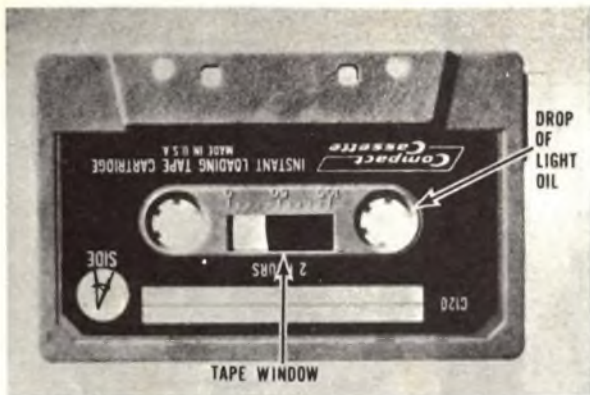
Fig. 10 - Punto di applicazione di olio al silicone su cassette da diverso tempo non usate.
