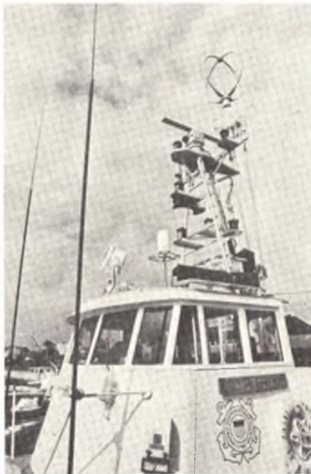
Fig. 4 - Torretta di un guardacoste U.S.A. attrezzata con un sofisticatissimo radiogoniometro per C.B.
