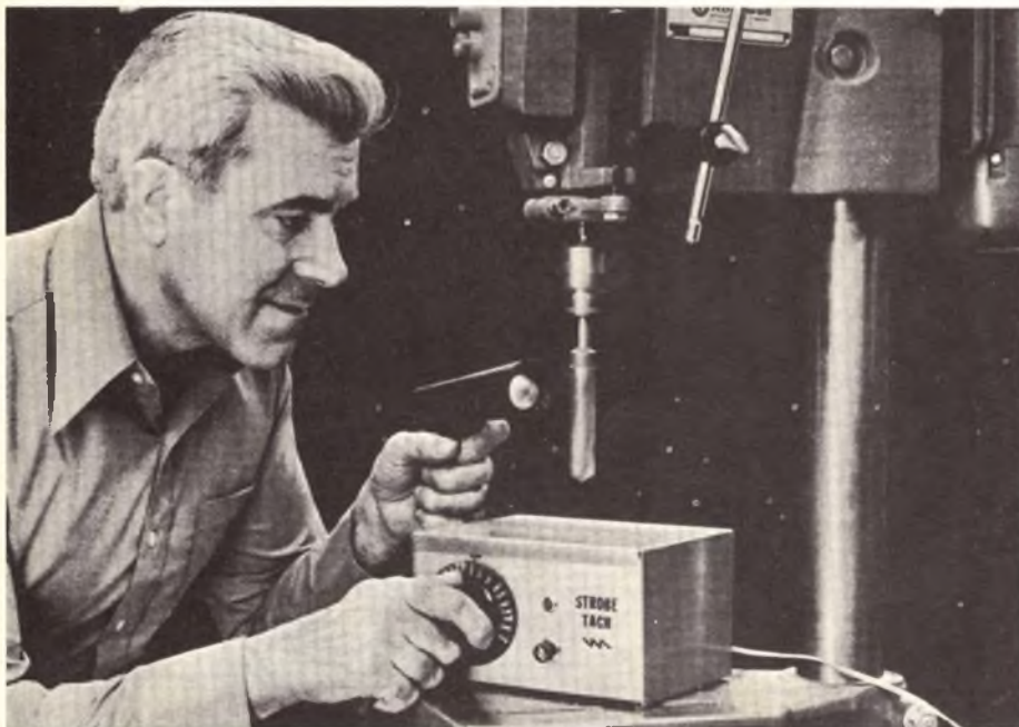
Fig. 5 - Impiego dello stroboscopio (da "Electronics Illustrated").
