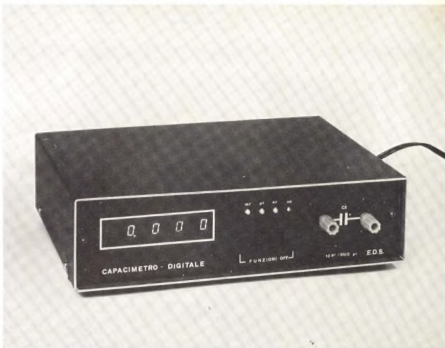
Vista esterna del capacimetro digitale a 4 cifre 10 pF - 1000 \mu F a realizzazione ultimata.
