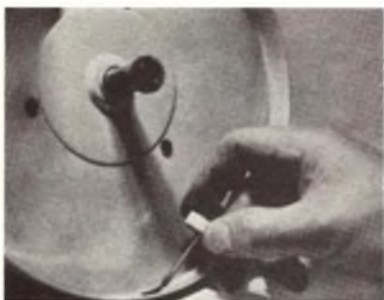
Fig. 3 - Gomma siliconica applicata all'interno di un piatto per giradischi per evitare lo slittamento della puleggia.
