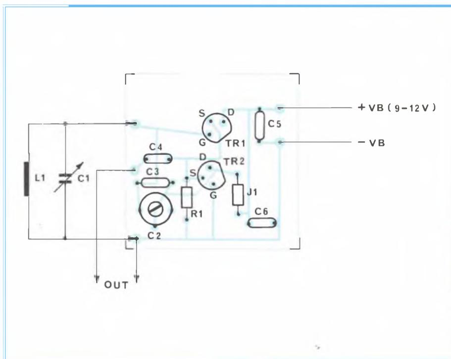
Fig. 4 - Disposizione dei componenti sulla bassetta a circuito stampato.
