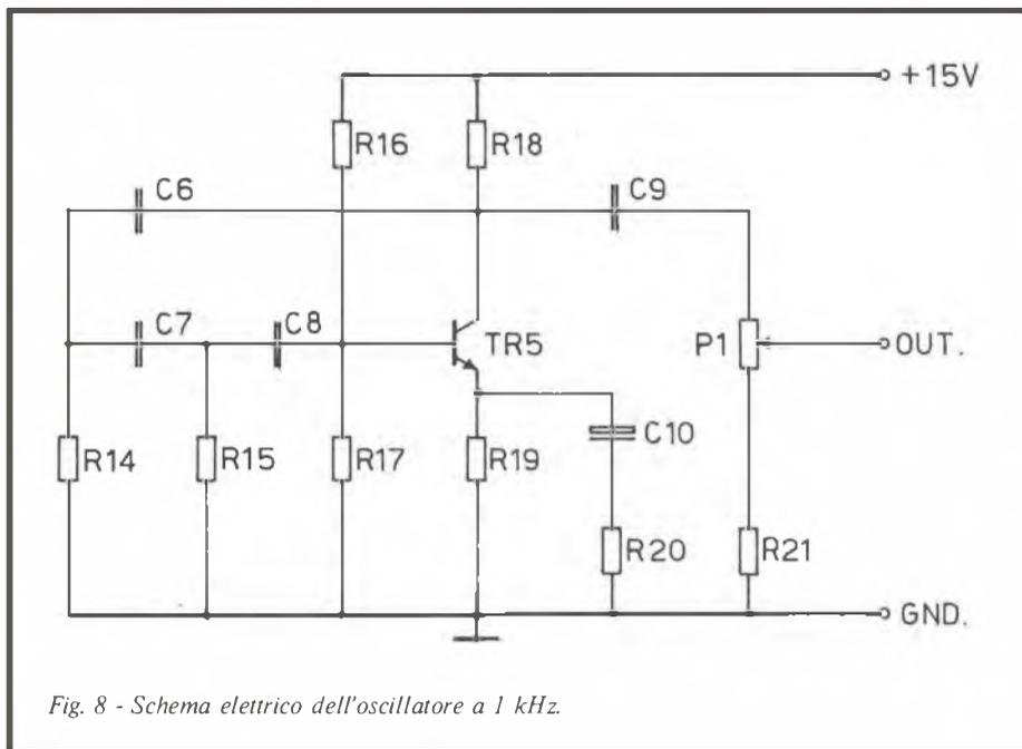
Fig. 8 - Schema elettrico dell'oscillatore a 1 kHz.
