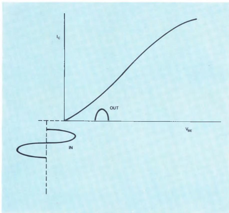
Fig. 9 - Curva di trasferimento di un amplificatore in classe C; questa classe non è utilizzabile in bassa frequenza ma è utilmente sfruttata nelle apparecchiature per alta e altissima frequenza.
