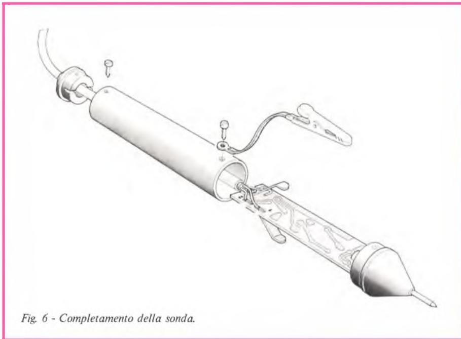
Fig. 6 - Completamento della sonda.
