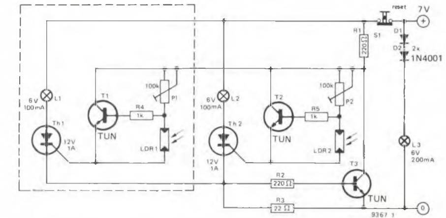
Fig. 8 - Schema elettrico di sistema fotoelettrico per autopiste.
