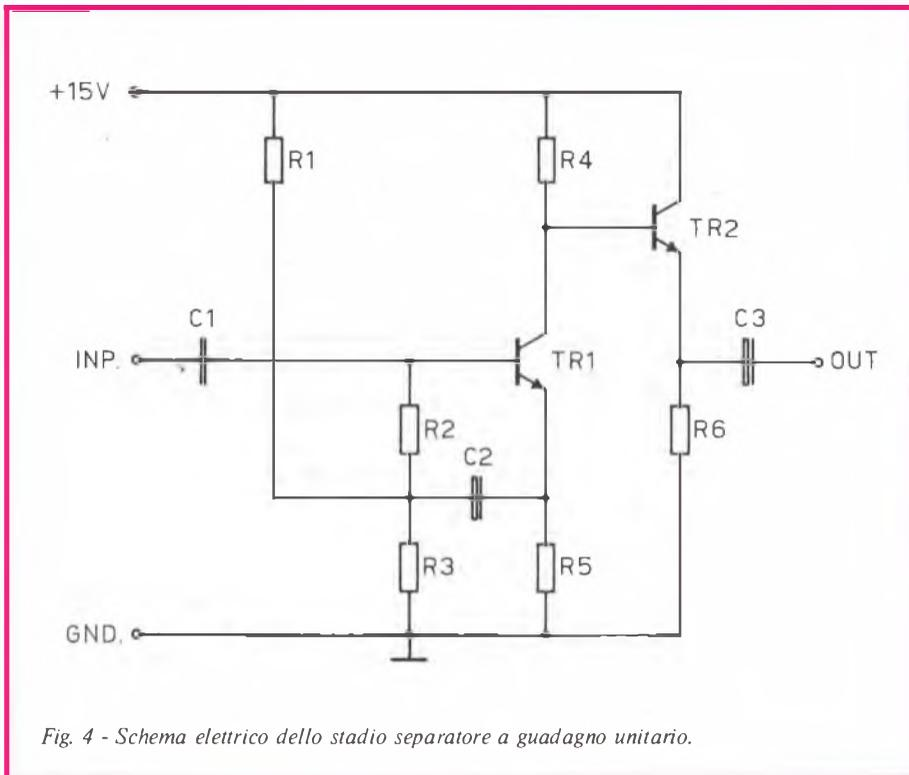
Fig. 4 - Schema elettrico dello stadio separatore a guadagno unitario.
