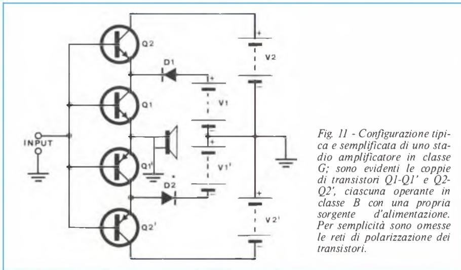
Fig. 11 - Configurazione tipica e semplificata di uno stadio amplificatore in classe G; sono evidenti le coppie di transistori Q1-Q1' e Q2-Q2', ciascuna operante in classe B con una propria sorgente d'alimentazione. Per semplicità sono omesse le reti di polarizzazione dei transistori.
