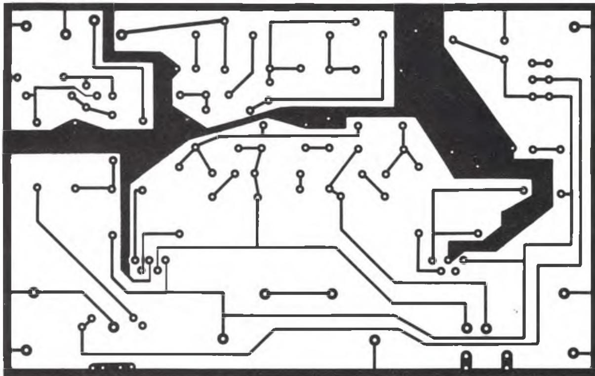
Fig. 2 - Basetta a circuito dell'amplificatore in grandezza naturale
