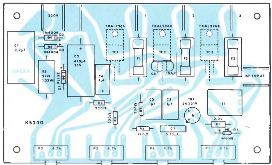
Fig. 3 - Disposizione dei componenti sulla basetta a C.S.
