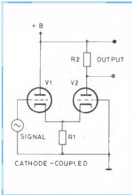
Fig. 1 - Circuito di principio a tubi.
