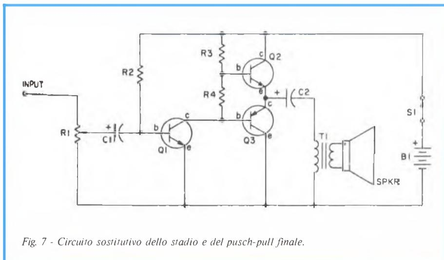
Fig. 7 - Circuito sostitutivo dello stadio e del push-pull finale.
