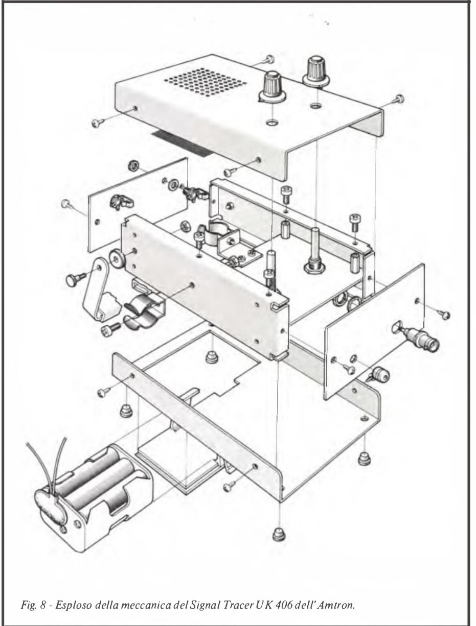
Fig. 8 - Esploso della meccanica del Signal Tracer UK 406 dell'Amtron.
