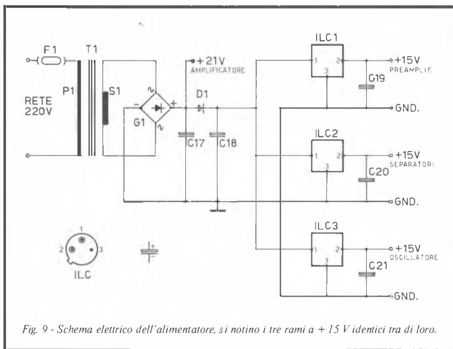
Fig. 9 - Schema elettrico dell'alimentatore, si notino i tre rami a +15 V identici tra di loro.
