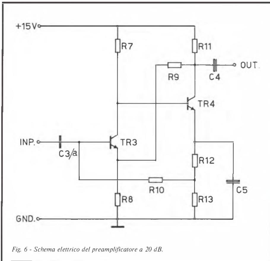
Fig. 6 - Schema elettrico del preamplificatore a 20 dB.
