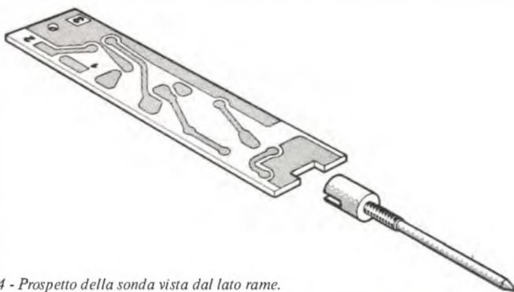
Fig. 4 - Prospetto della sonda vista dal lato rame.
