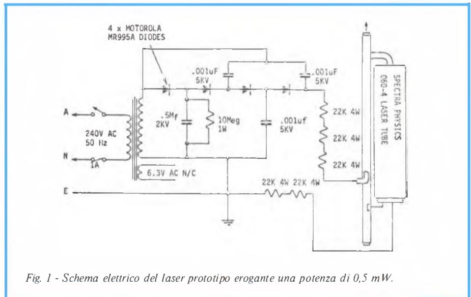
Fig. 1 - Schema elettrico del laser prototipo erogante una potenza di 0,5 mW.
