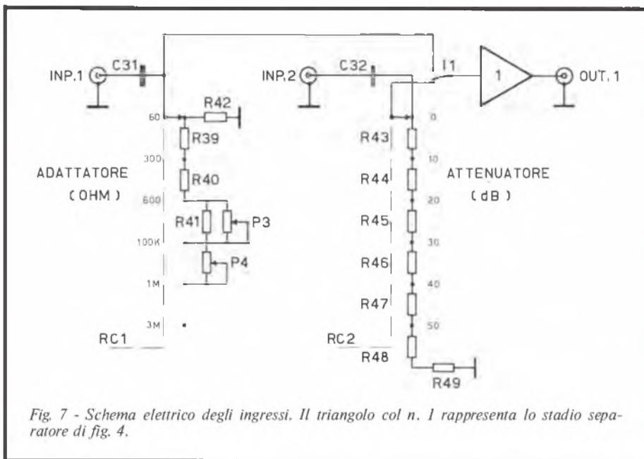
Fig. 7 - Schema elettrico degli ingressi. Il triangolo col n. 1 rappresenta lo stadio separatore di fig. 4.
