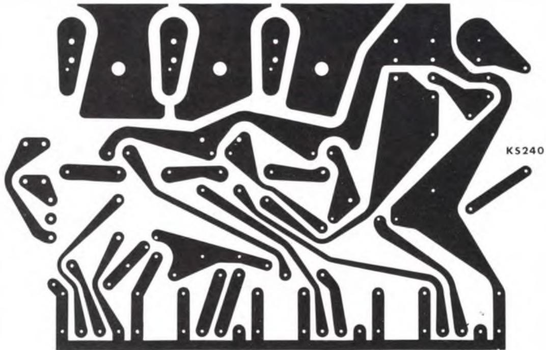
Fig. 2 - Basetta a circuito stampato in scala 1 : 1 - KS240.
