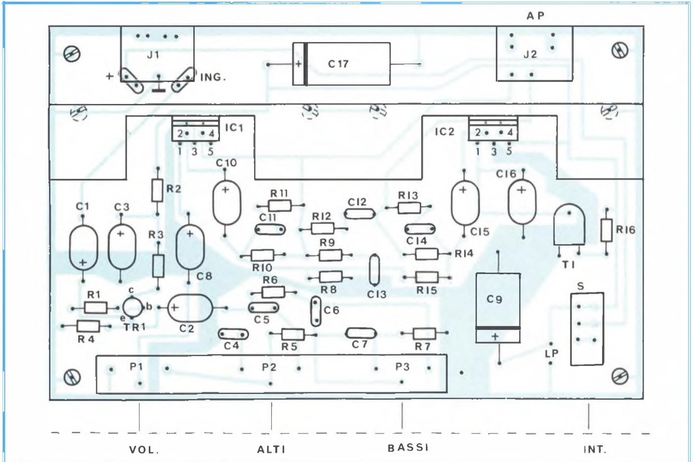
tazione e l'interruttore generale. Sul retro, due fori permetteranno di accedere alle prese "DIN" J1-J2. Il fissaggio dello stampato è tradizionalissimo, con viti angolari e dadi. Come distanziatori, si possono impiegare dei semplici dadi, o rondelle alte 2,5 mm.
