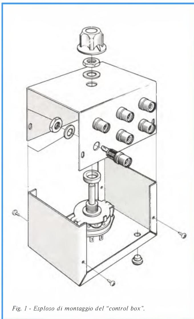
Fig. 1 - Esploso di montaggio del "control box".
