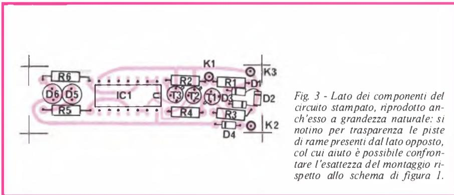
Fig. 3 - Lato dei componenti del circuito stampato, riprodotto anch'esso a grandezza naturale: si notino per trasparenza le piste di rame presenti dal lato opposto, col cui aiuto è possibile confrontare l'esattezza del montaggio rispetto allo schema di figura 1.
