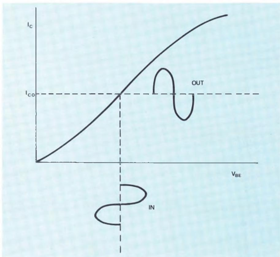
Fig. 1 - Tipica curva di trasferimento di uno stadio amplificatore in classe A; con  $I_{CO}$  è indicata la corrente di riposo circolante nell'elemento amplificatore necessaria per garantire la linearità del trasferimento.
