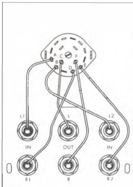
Fig. 2 - Cablaggio dell'unità di commutazione per giradischi
