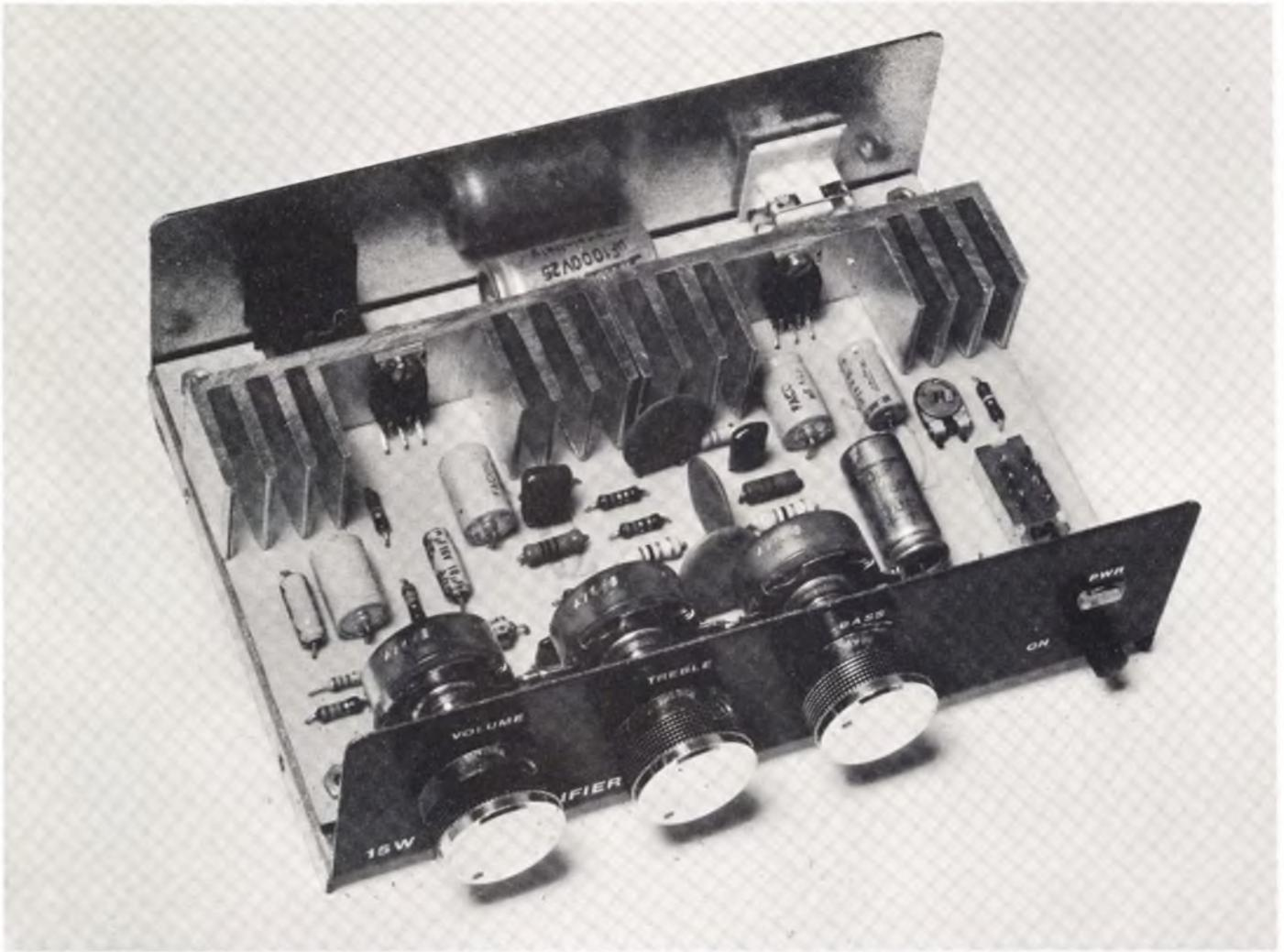
Vista interna dell'amplificatore da 15 W per auto a realizzazione ultimata.
