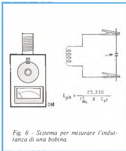
Fig. 6 - Sistema per misurare l'induttanza di una bobina.
