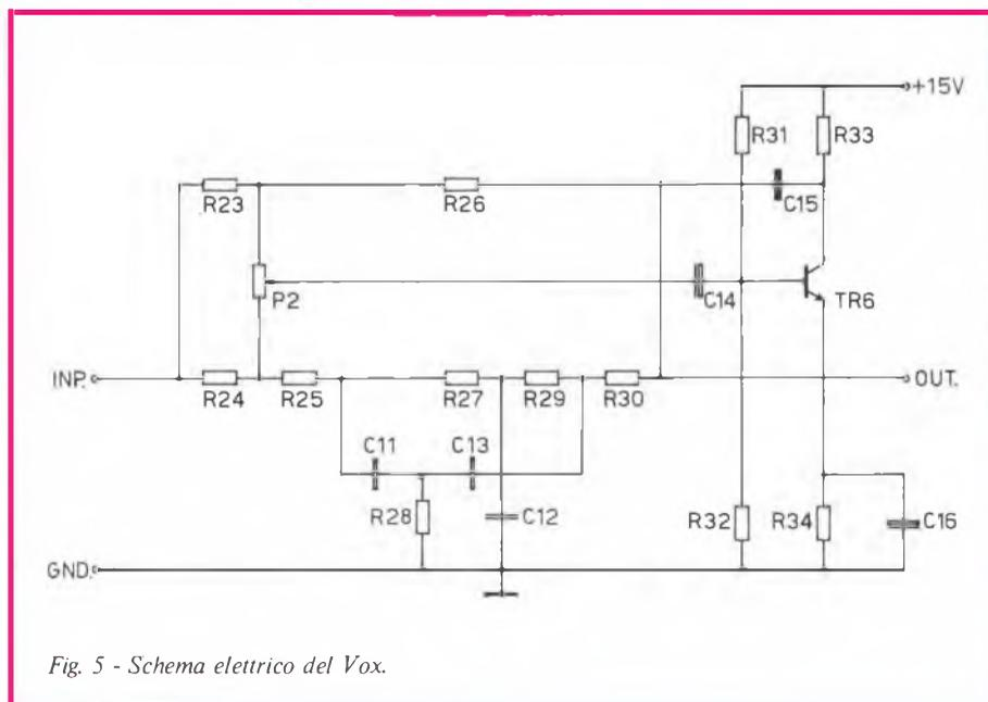
Fig. 5 - Schema elettrico del Vox.
