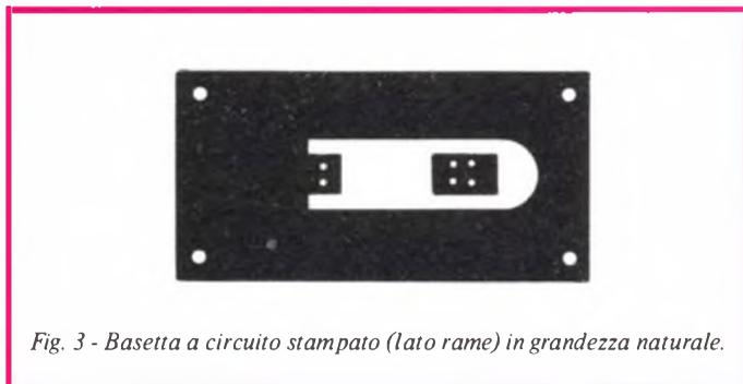
Fig. 3 - Basetta a circuito stampato (lato rame) in grandezza naturale.
