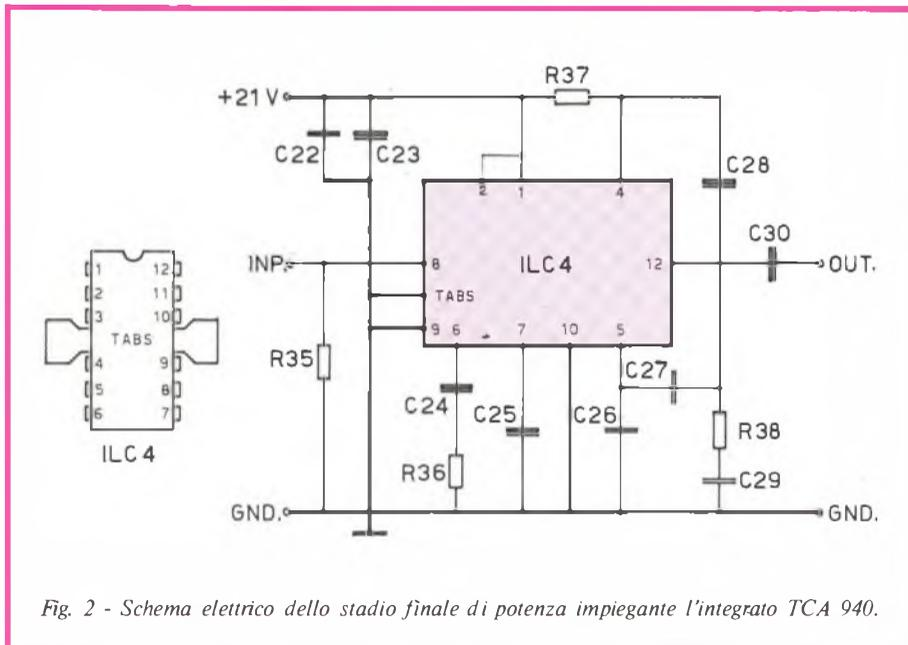
Fig. 2 - Schema elettrico dello stadio finale di potenza impiegante l'integrato TCA 940.
