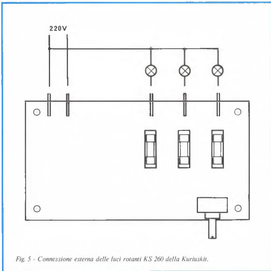
Fig. 5 - Connessione esterna delle luci rotanti KS 260 della Kuriuskit.
