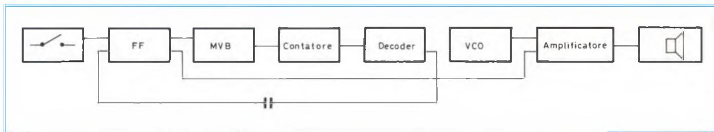
Fig. 1 - Schema di principio del campanello elettronico.
