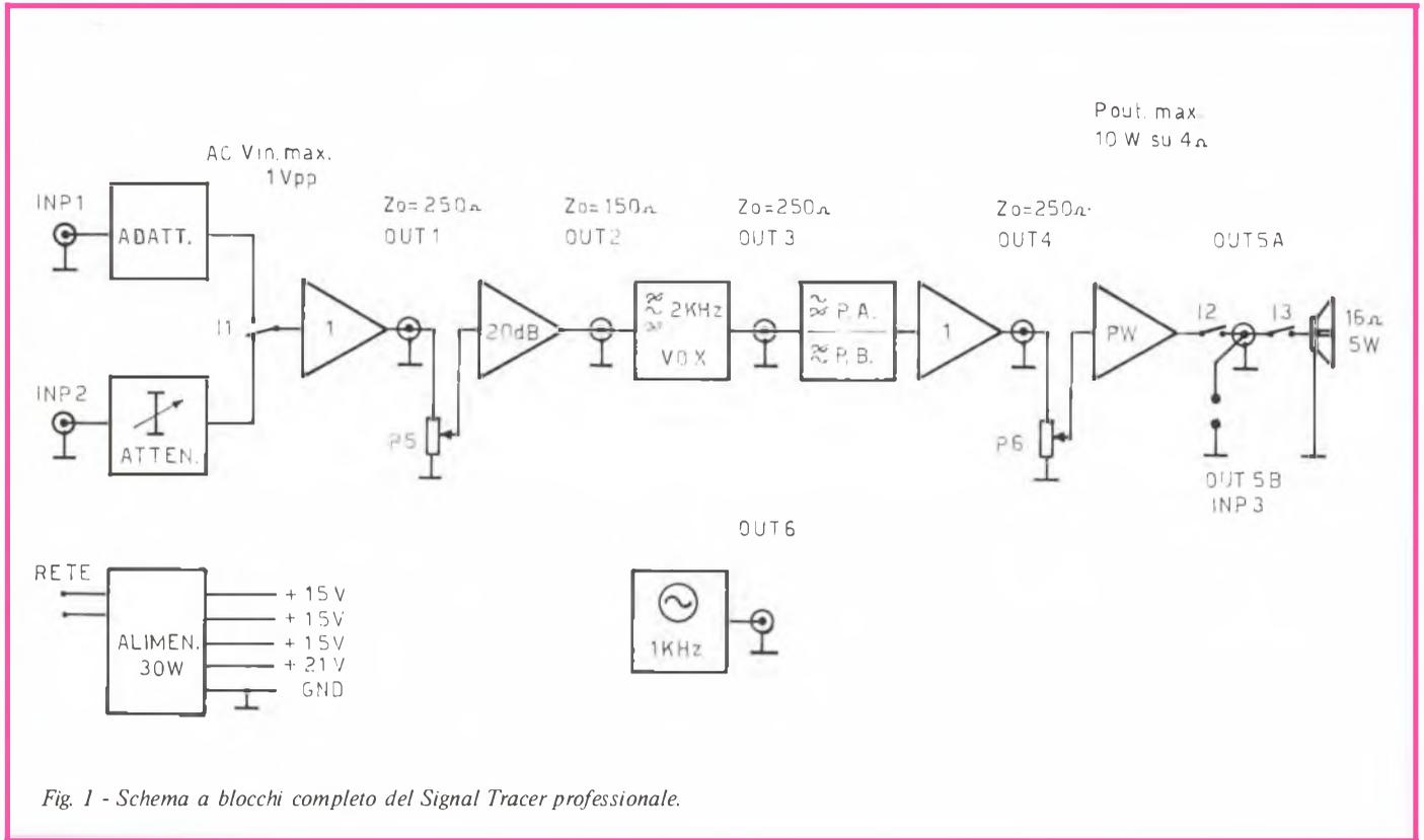
Fig. 1 - Schema a blocchi completo del Signal Tracer professionale.
