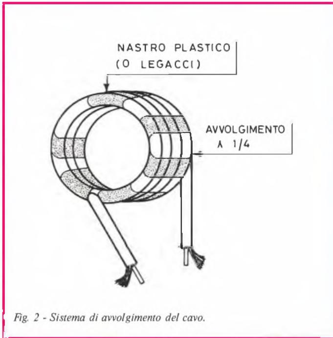
Fig. 2 - Sistema di avvolgimento del cavo.
