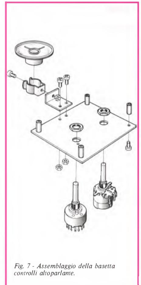
Fig. 7 - Assemblaggio della basetta controlli altoparlante.
