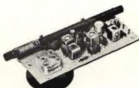
Un sintonizzatore supereterodina per AM di ottime caratteristiche, atto a venire inserito in un complesso audio colmando una lacuna che spesso impedisce l'ascolto di interessantissime trasmissioni radiofoniche irradiate nella banda delle onde medie.
