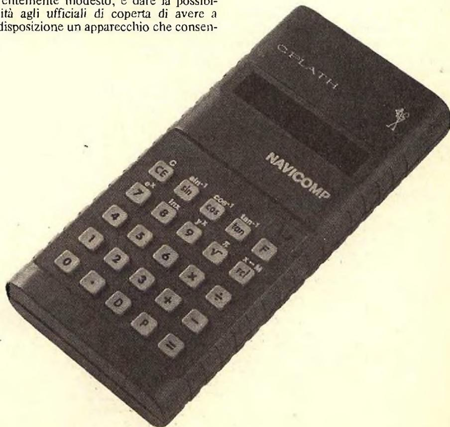
Fig. 1 - Il NAVICOMP il primo computer per la navigazione ed i calcoli astronomici, di tipo tascabile, con incorporati i dati del Sole, della Luna, di Venere, di Marte e di ben 58 stelle oltre ad un cronometro digitale a quarzo. Precisione di calcolo interno 12 digit. (S.I.R.M.).
