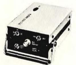
Economico ed efficiente generatore di reticolo per regolazione della convergenza statica e dinamica del televisori a colori e per sostituire il monoscopio nelle regolazioni di linearità verticale e orizzontale.
