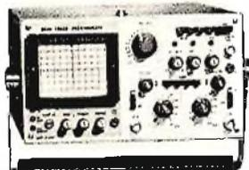
**Oscilloscopio a doppia traccia "UNAOHM"**
