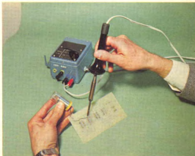
Fig. 10 - Per saldare i circuiti integrati si adoperi un saldatore di modello leggero e maneggevole, a punta fine e pulita. Si scelga di preferenza un tipo da 28 W 6 V, con adeguato trasformatore di rete. Durante l'operazione di montaggio, isolarsi - se possibile - da rumori e frastruoni e tener d'occhio lo schema.
