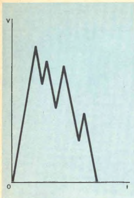
Fig. 3 - Si crede generalmente che, schiacciando un pulsante, il contatto che si stabilisce fra le lamelle elastiche è franco e immediato, mentre invece non è affatto vero. Quando le lamelle elastiche vengono a toccarsi, l'aggancio dell'una con l'altra è sempre accompagnato da piccoli e ripetuti rimbalzi generatori di piccole e ripetute creste di tensione che - se non fossero eliminate - sarebbero interpretate dal circuito logico come altrettanti impulsi di comando, cosicché il conteggio - invece di avanzare di un'unità alla volta - avanzerebbe di tante unità quante sono le creste spurie.
