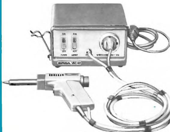
Dispositivo costituito da un dissaldatore a pistola e da una pompa pneumatica. Consente di risolvere tutti i problemi relativi alla dissaldatura di componenti dai c.s. aspirando tutto lo stagno fuso e lasciando liberi i fori.
