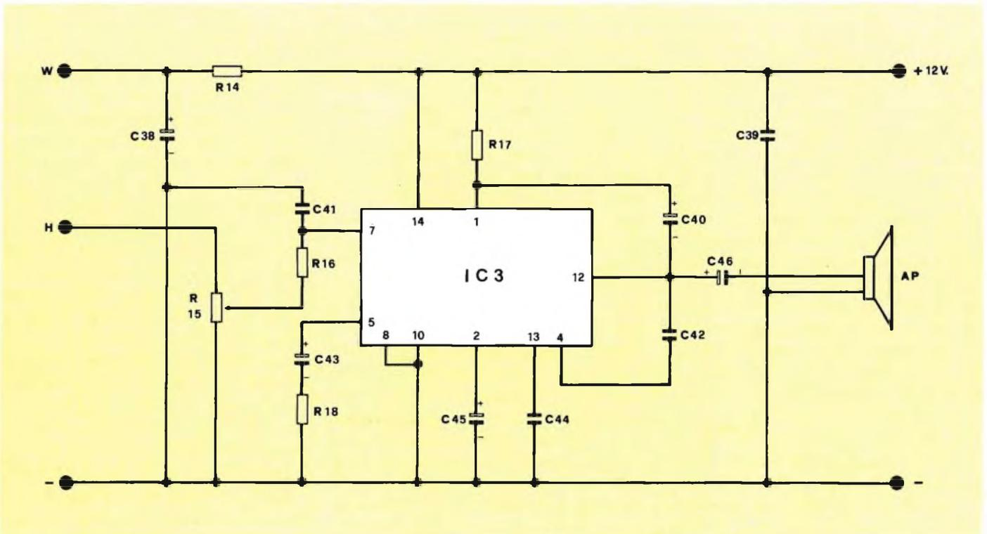
Fig. 3 - Schema elettrico completo della sezione Bassa Frequenza.
