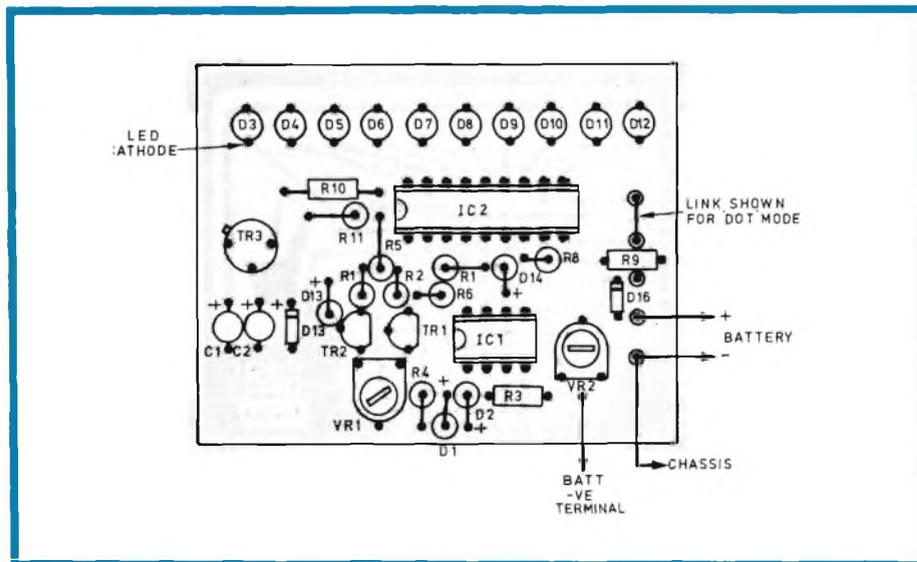
Fig. 5 - Realizzazione pratica dell'amplificatore a LED.
