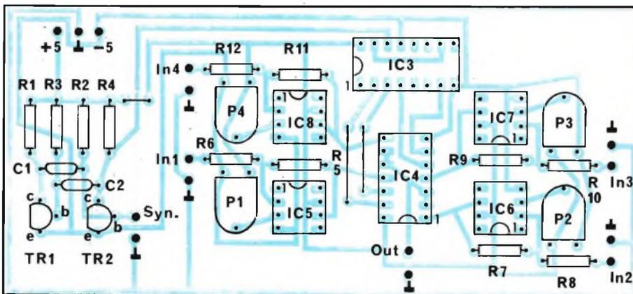
Fig. 4 - Disposizione dei componenti sulla basetta di fig. 3.
