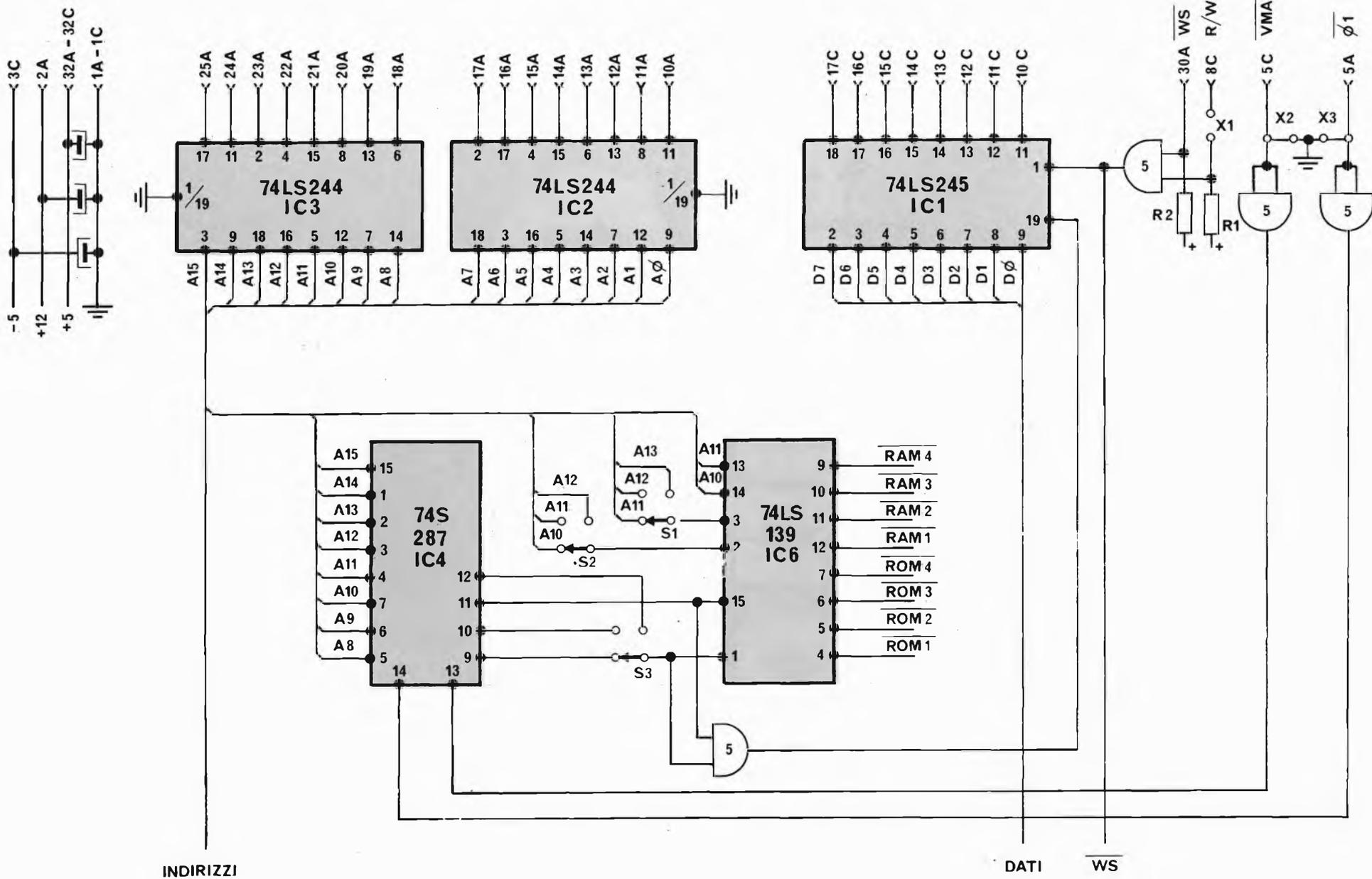
Fig. 5 - Schema elettrico 3ª parte: Interfaccia Bus e decodifica.
