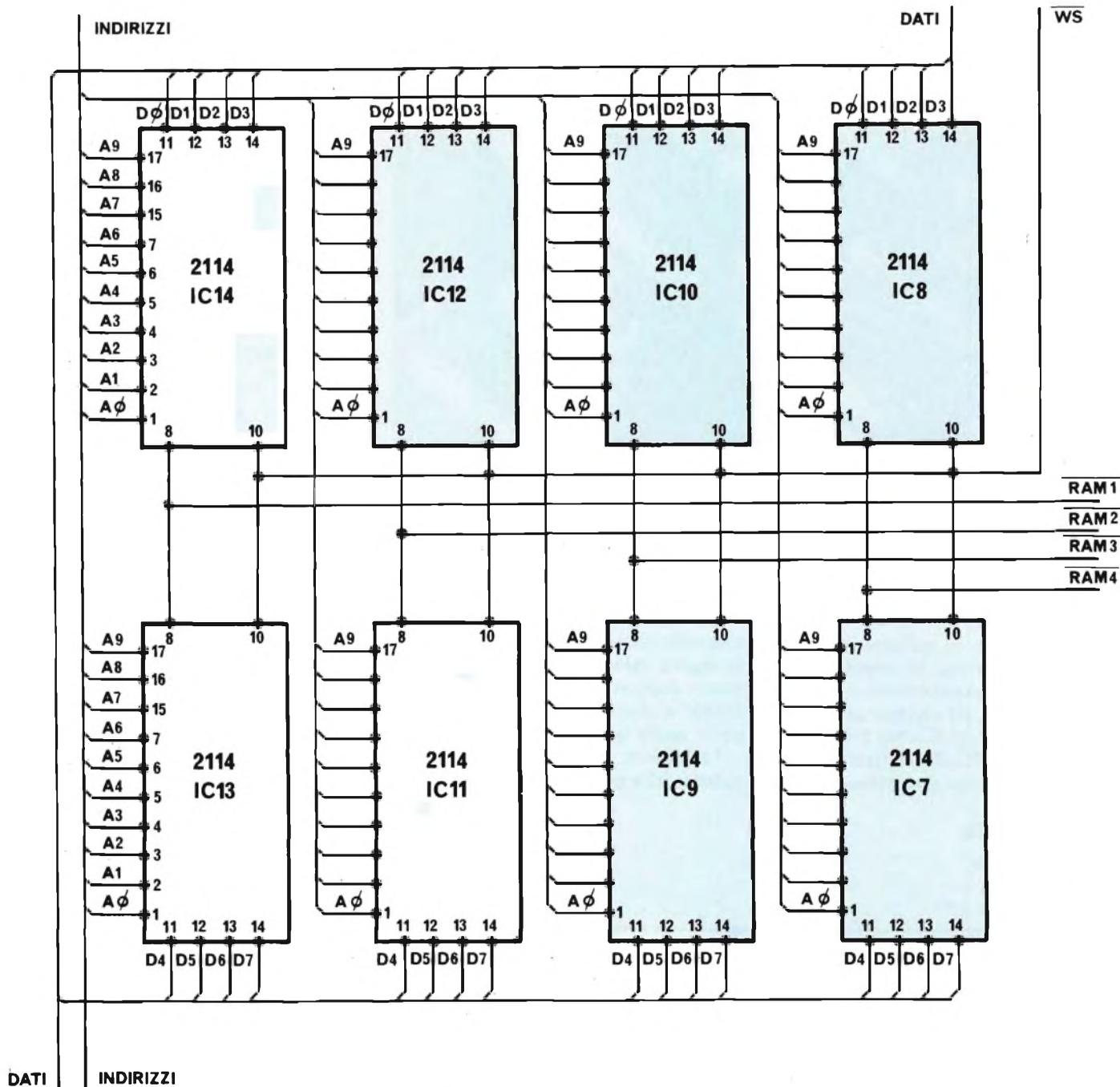
Fig. 3 - Schema elettrico 1ª parte: RAM da 4 kbyte.
