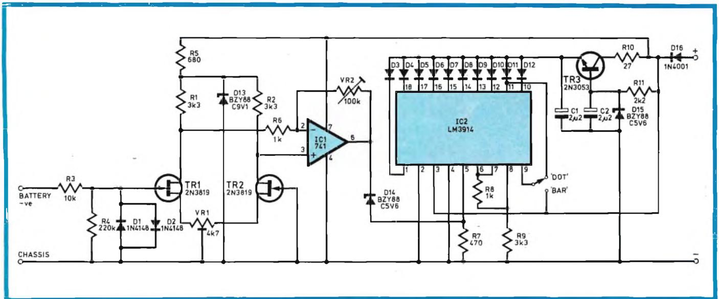
Fig. 2 - Schema elettrico dell'amplificatore a LED.
