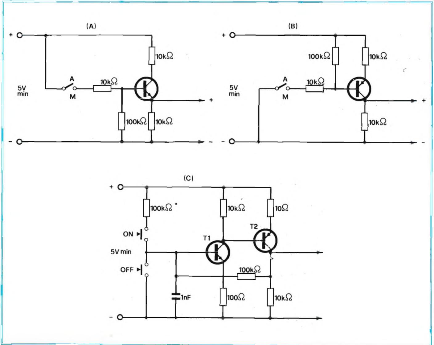
Fig. 3 - Transistore impiegato come relè statico per il controllo di una tensione continua. A) Transistore NPN; B) Transistore PNP; C) Flip-flop NPN-PNP.
