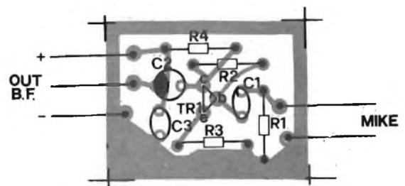
fig. 9 - Disposizione componenti sul circuito stampato del preamplificatore per microfoni piezoelettrici.
