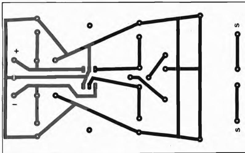
Fig. 5 - Lato rame dello stampato riguardante l'alimentatore.
