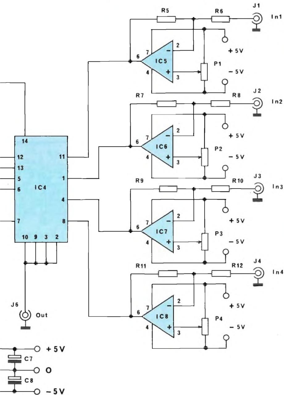
Fig. 2 - Schema elettrico del "commutatore" e del relativo alimentatore "duale".
