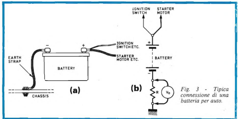
Fig. 3 - Tipica connessione di una batteria per auto.
