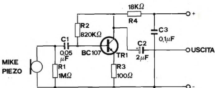
*fig. 5 - Schema elettrico dell'adattatore per microfoni piezoelettrici.*
