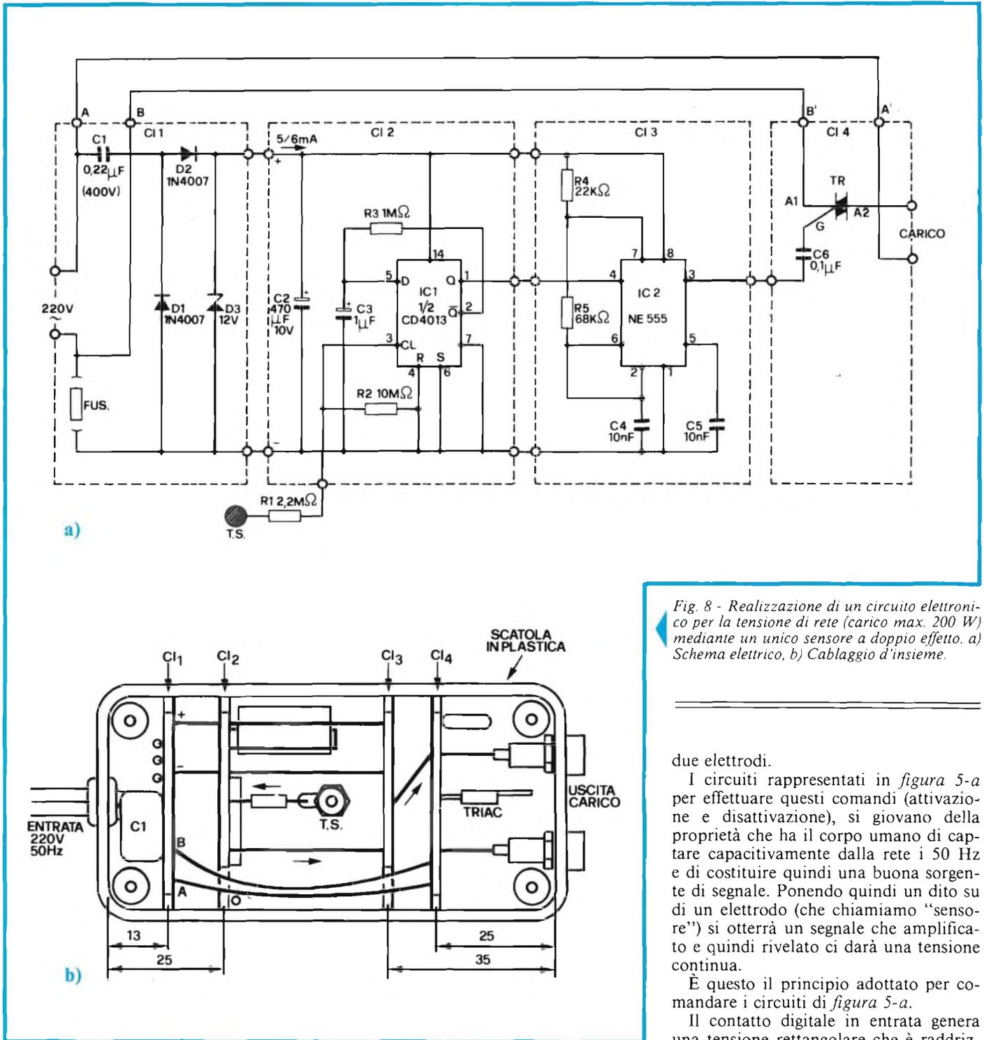
Fig. 8 - Realizzazione di un circuito elettronico per la tensione di rete (carico max. 200 W) mediante un unico sensore a doppio effetto. a) Schema elettrico, b) Cablaggio d'insieme.
