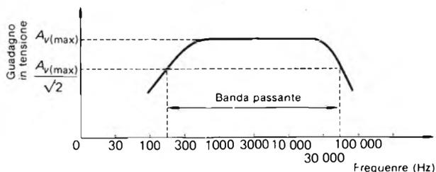
Fig. 6.9 - Tipica caratteristica guadagno/frequenza per un amplificatore operante in audiofrequenza.
