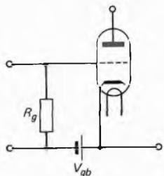
Fig. 6.3 - Polarizzazione della griglia controllo di una valvola mediante una batteria.
