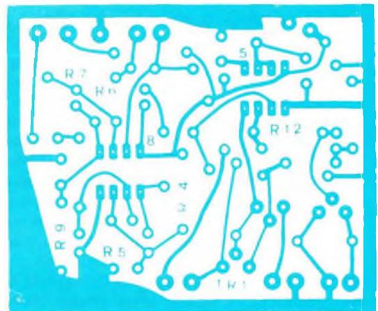
*fig. 6 - Circuito stampato lato rame dello snap-flash.*
