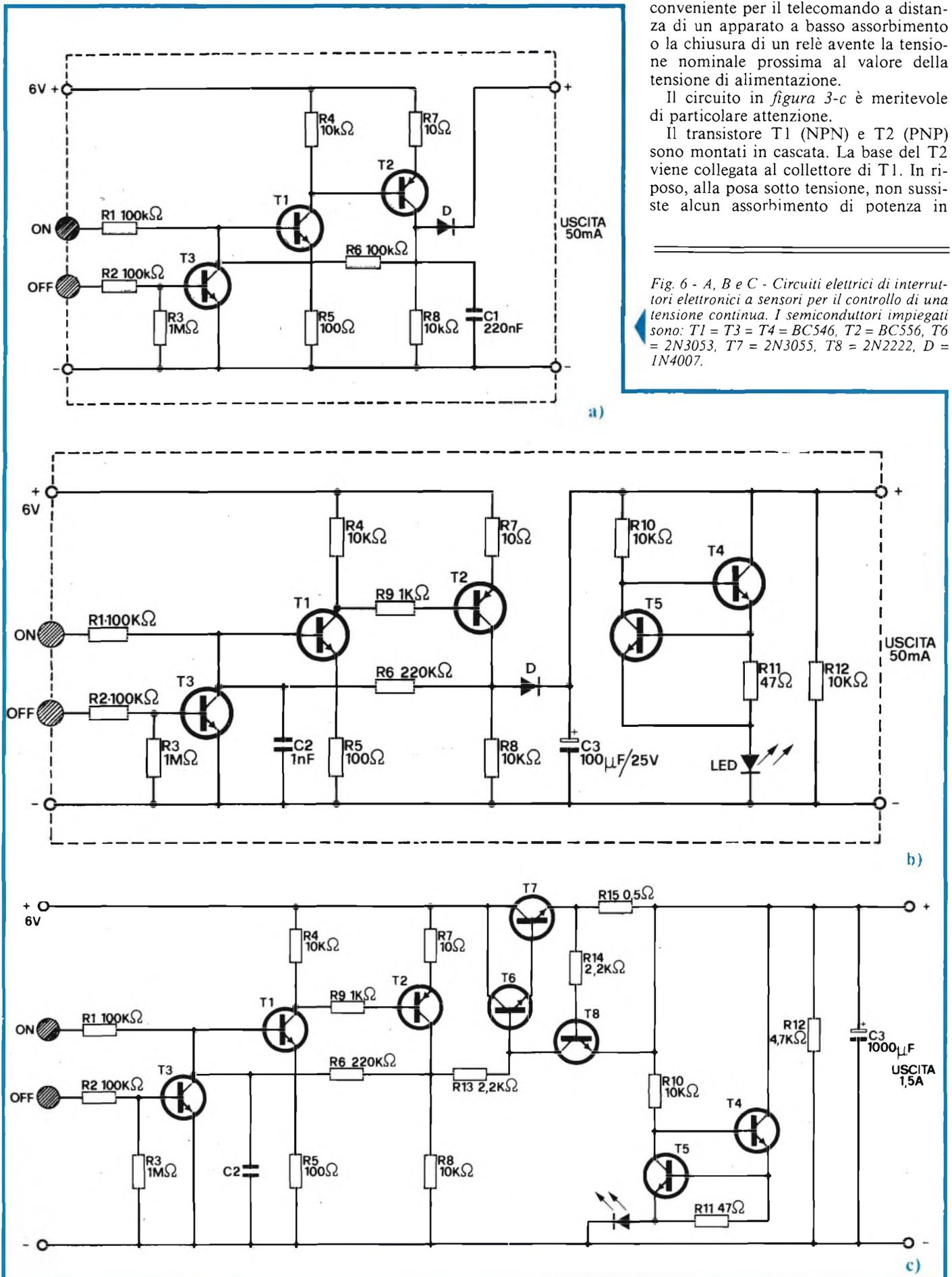
Fig. 6 - A, B e C - Circuiti elettrici di interruttori elettronici a sensori per il controllo di una tensione continua. I semiconduttori impiegati sono: T1 = T3 = T4 = BC546, T2 = BC556, T6 = 2N3053, T7 = 2N3055, T8 = 2N2222, D = 1N4007.
