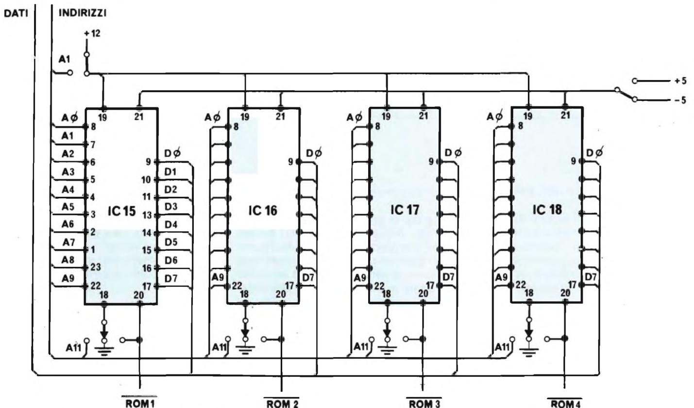
Fig. 4 - Schema elettrico 2ª parte: ROM/EPROM.
