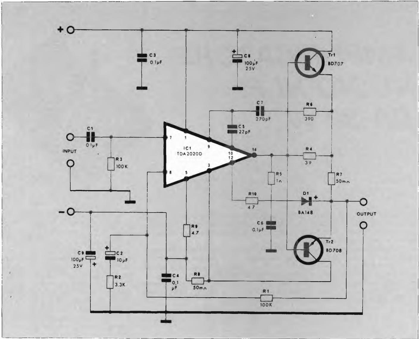
Fig. 1 - Schema elettrico dell'amplificatore audio HI-FI da 30 W. KS395 della Kurioskit.
