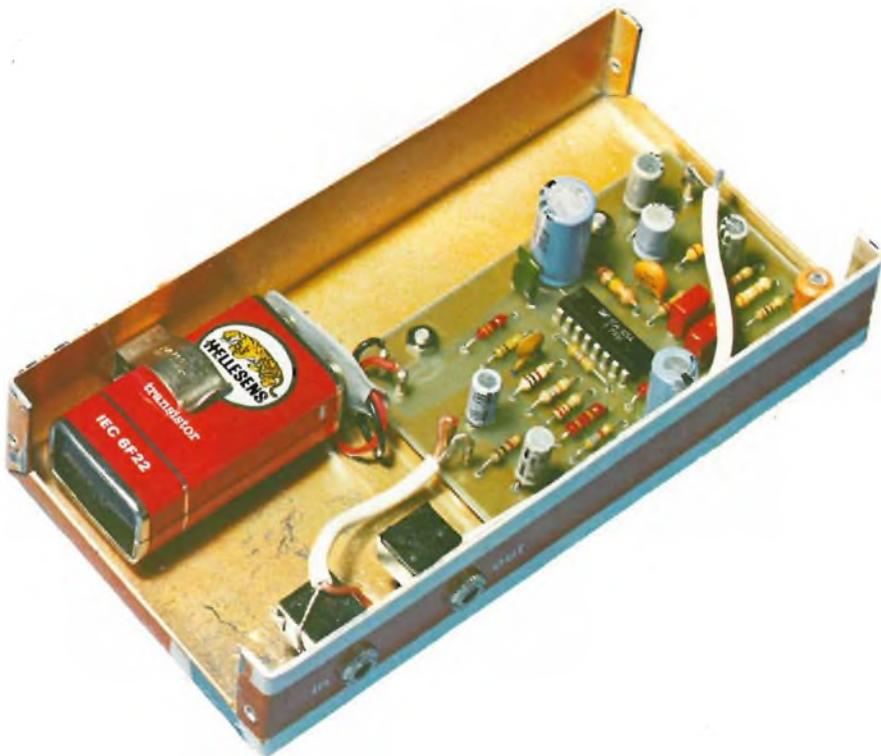
Vista interna del preamplificatore microfonico con A.L.C.
