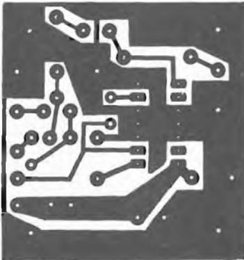
Figura 8 - Lato-rame del circuito stampato dell'interfonico di figura 7.
