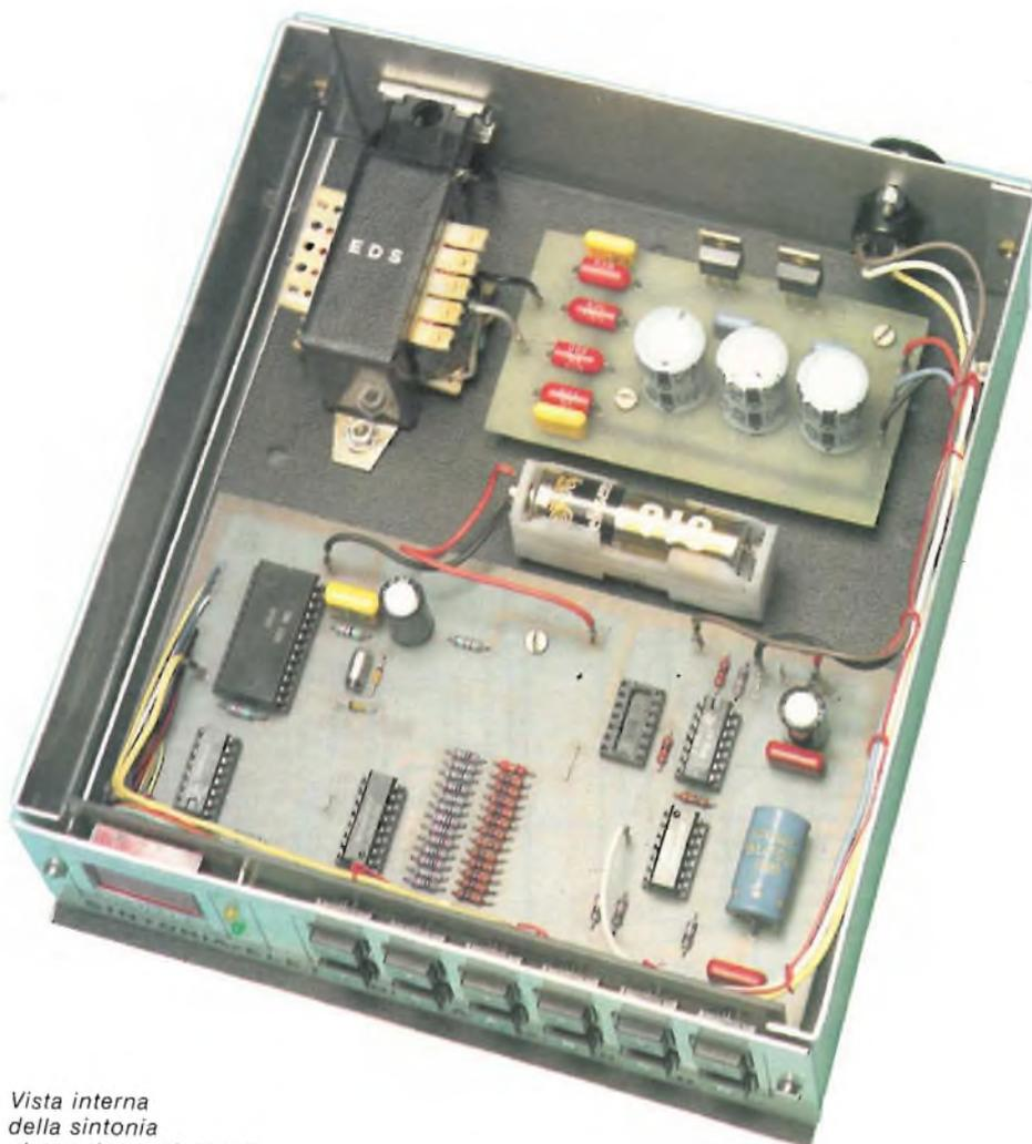
Vista interna della sintonia elettronica a 16 canali.
