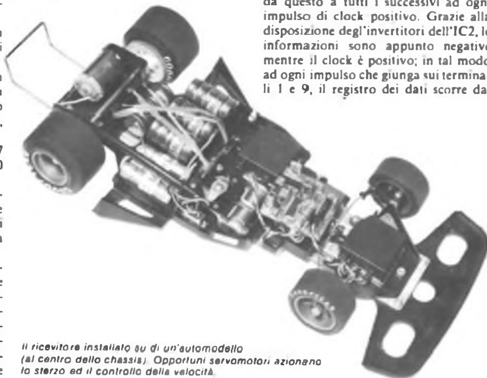
Il ricevitore installato su di un'automodello (al centro dello chassis). Opportuni servomotori azionano lo sterzo ed il controllo della velocità.
