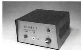
Alimentatore stabilizzato da 12 volt particolarmente idoneo per il funzionamento di radiotelefoni. Circuito a basso livello di ripple ed elevata stabilità anche nelle condizioni di massimo carico (2 ampère). Le dimensioni particolarmente ridotte consentono una facile sistemazione nel laboratorio o nella stazione radio. L'apparecchio è disponibile esclusivamente montato e collaudato.
