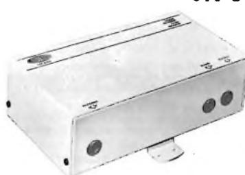
Questo ricevitore in unione al trasmettitore UK 943 forma un dispositivo di comando a distanza applicabile a cancelli, porte, saracinesche, ecc. Il sistema di ricezione con segnale codificato con 4095 combinazioni diverse rende sicuro il dispositivo di comando.
