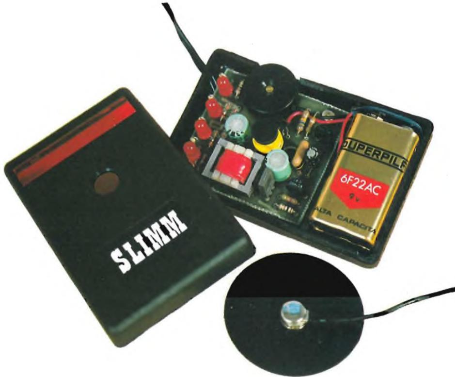
Lo Slimm visto internamente; dalla foto si nota l'estrema compattezza dello strumento, che permette di presentarsi in elegante contenitore di dimensioni ridotte.
