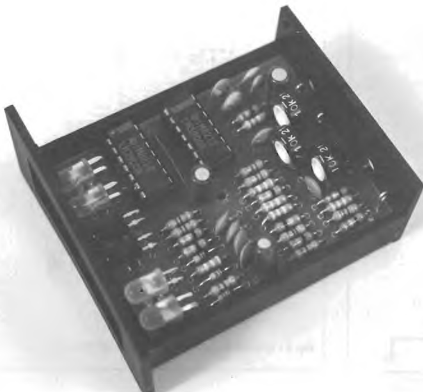
Basetta MK 225 alloggiata all'interno del contenitore GPE 023.
