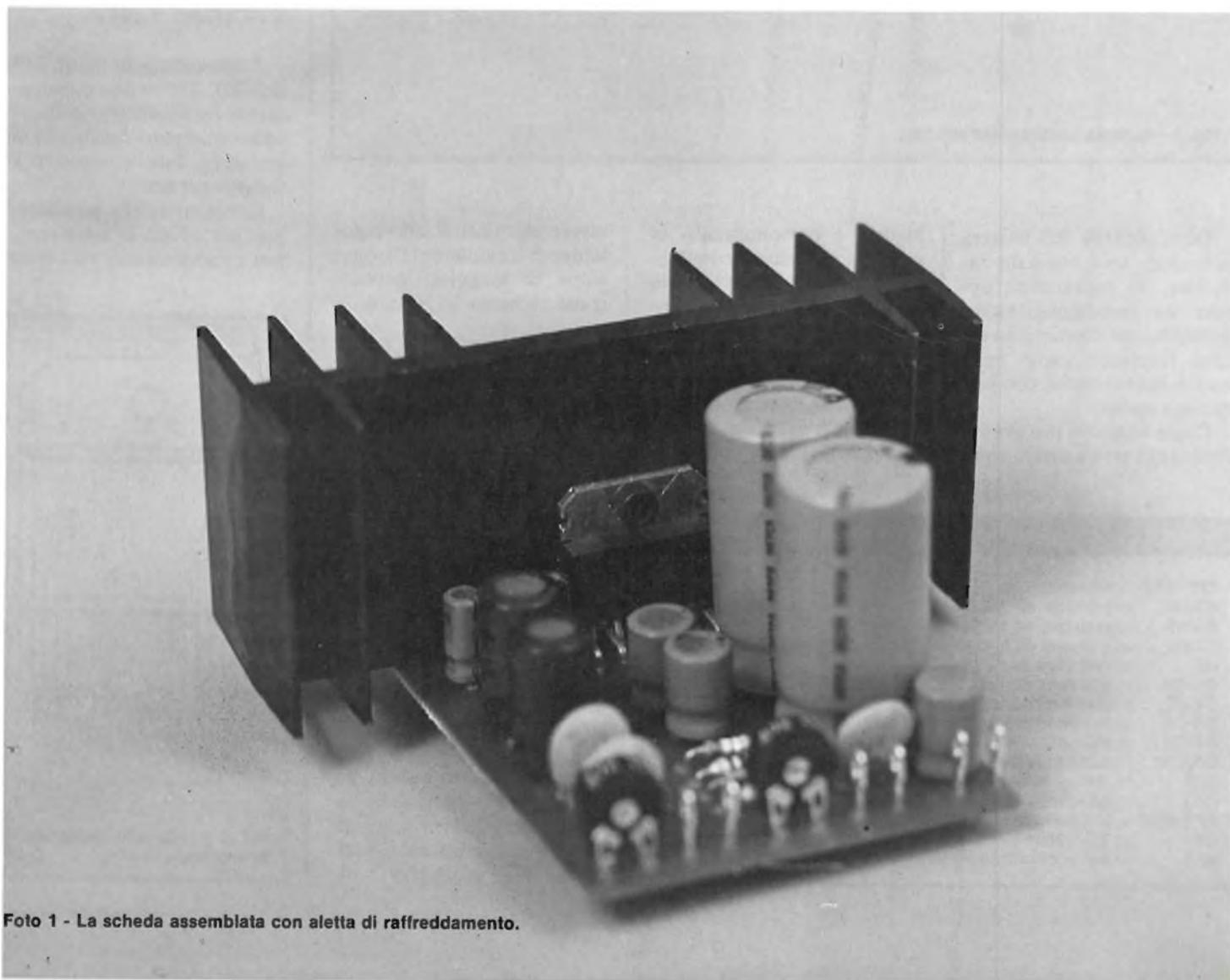
Foto 1 - La scheda assemblata con aletta di raffreddamento.
