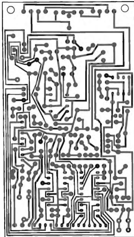
Fig. 14 - Circuito stampato della piastra base in scala 1:1.
