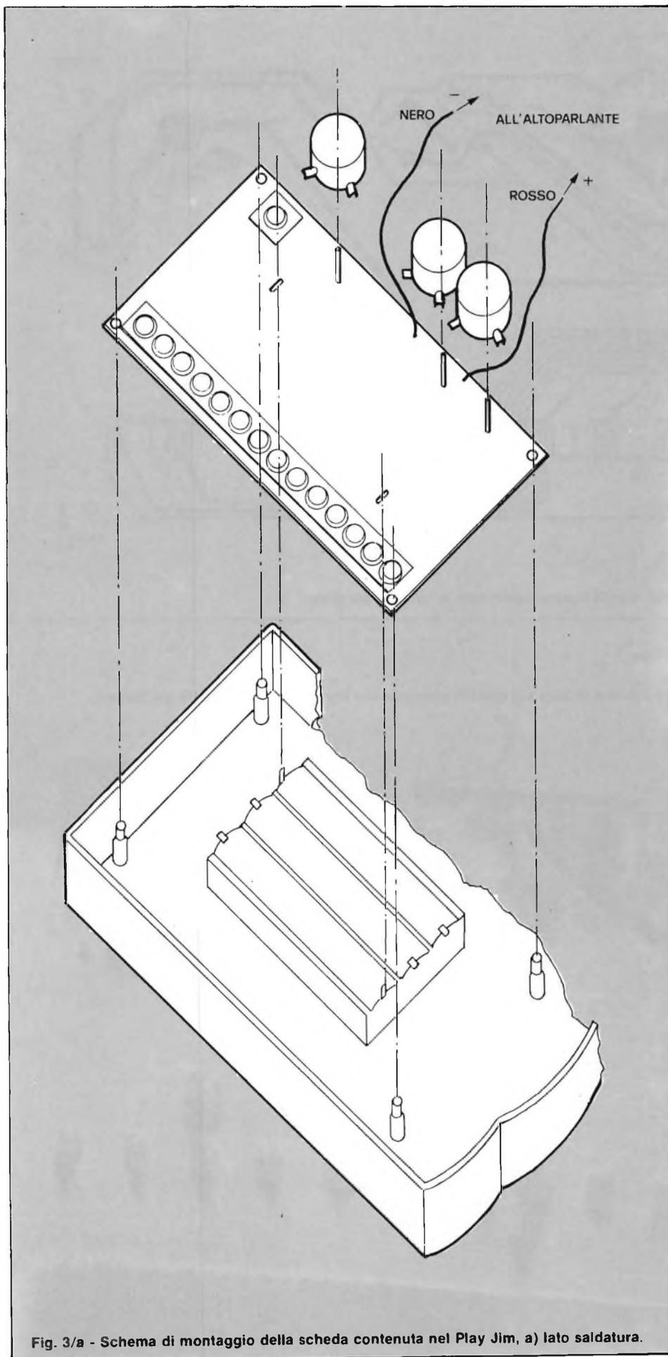
Fig. 3/a - Schema di montaggio della scheda contenuta nel Play Jim, a) lato saldatura.
