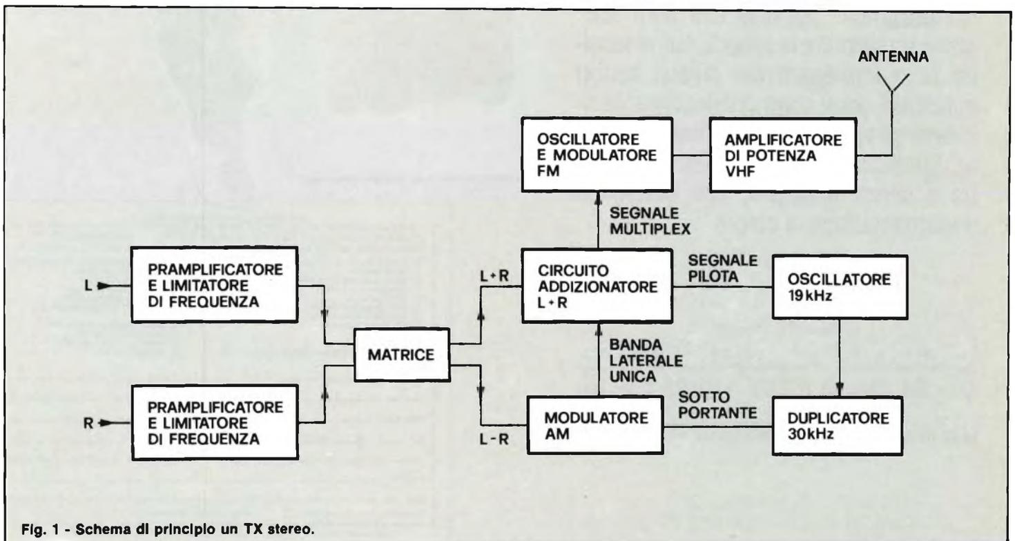
Fig. 1 - Schema di principio un TX stereo.
