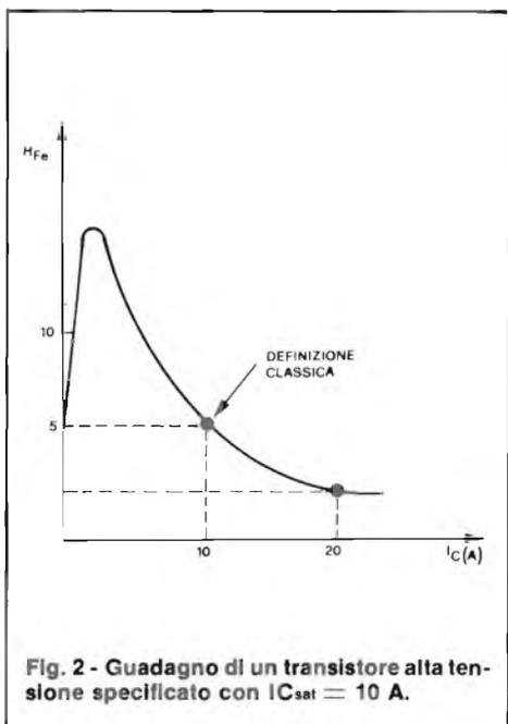
Fig. 2 - Guadagno di un transistor a tensione specificato con  $I_{Csat} = 10$  A.
