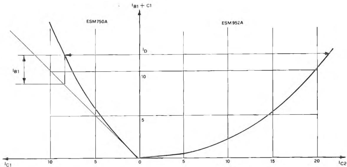
Fig. 6 - Grafico per il calcolo di un Darlington "alta tensione" 700 V, composto da un transistor pilota ESM 750 e da un transistor di uscita ESM 952, entrambi di costruzione Thomson-CSF.
