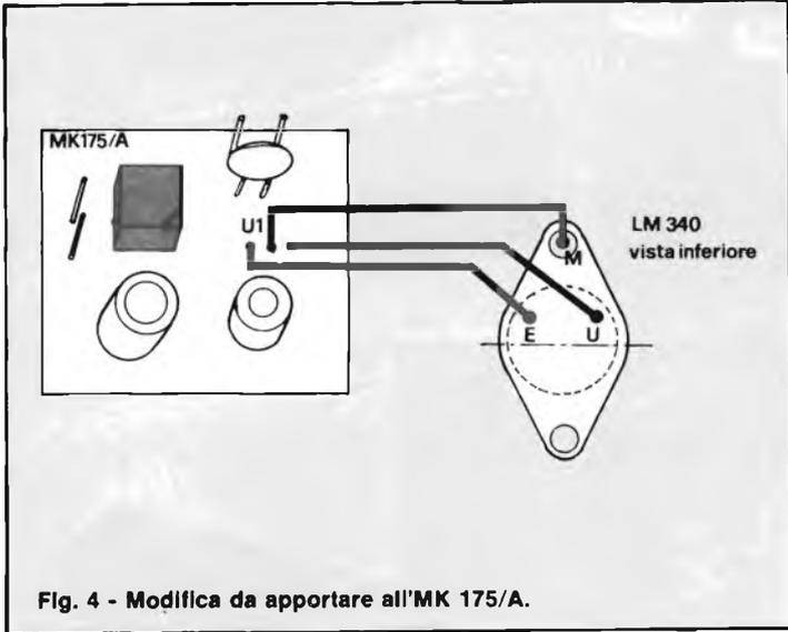
to) da 1 A, con un altro in grado di sopportare 5 A. Ovviamente quest'ultimo con alettatura adeguata. (figura 4) e foto 2.
