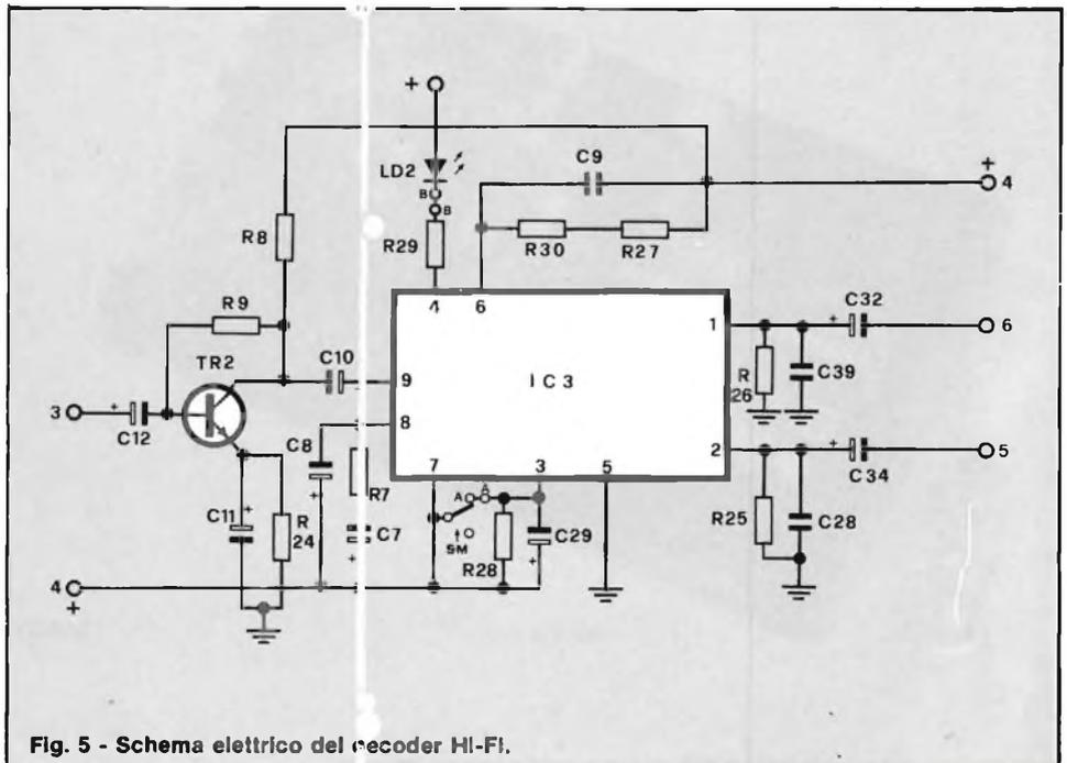
Fig. 5 - Schema elettrico del recoder HI-FI.
