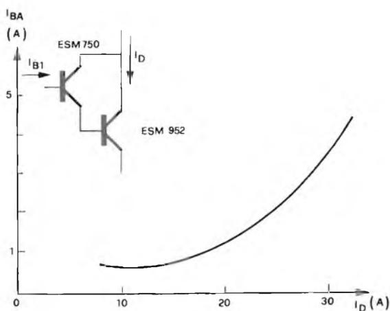
Fig. 7 - Corrente di base necessaria per saturare il Darlington ESM 750/952. La corrente di definizione  $I_{Csat}$  dell'ESM 952 è 12 A. In Darlington questo transistor può commutare più del doppio. Questa curva è attenuata a partire dal grafico della Fig. 6.
