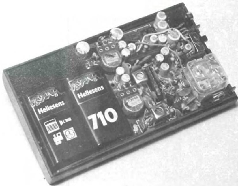
Vista interna del minricevitore FM stereo a realizzazione ultimata.
