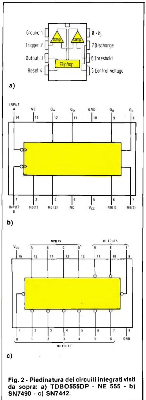
Fig. 2 - Piedinatura dei circuiti integrati visti da sopra: a) TDB0555DP - NE 555 - b) SN7490 - c) SN7442.
