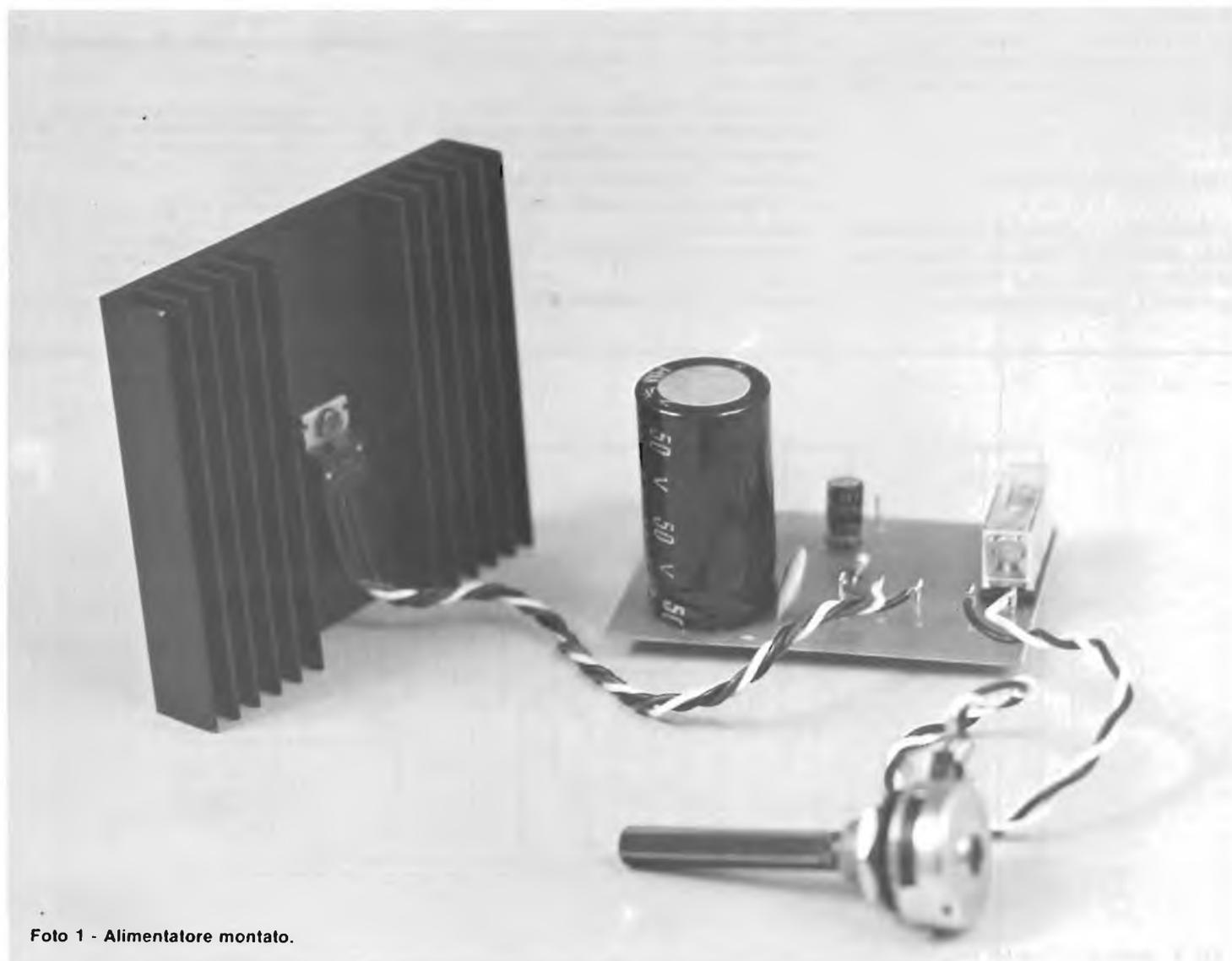
Foto 1 - Alimentatore montato.
