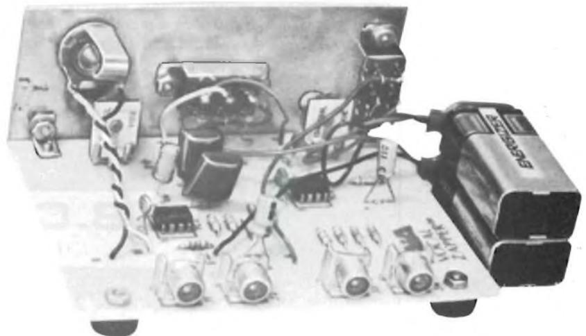
Fig. 4 - Fotografia dell'interno del prototipo assemblato dagli autori. Si noti l'intreccio del collegamenti che giungono alla presa microfonica. In questo esemplare, s'impiegano del jack (J1 ... J4) d'ingresso-uscita passo RCA, con montaggio ad angolo retto. Tall Jack possono esser sostituiti con delle prese "DIN" volendo, il che vale anche per la presa microfonica "J5".
