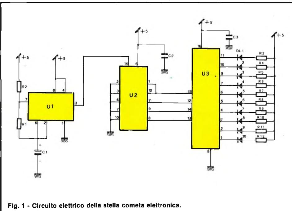
Fig. 1 - Circuito elettrico della stella cometa elettronica.
