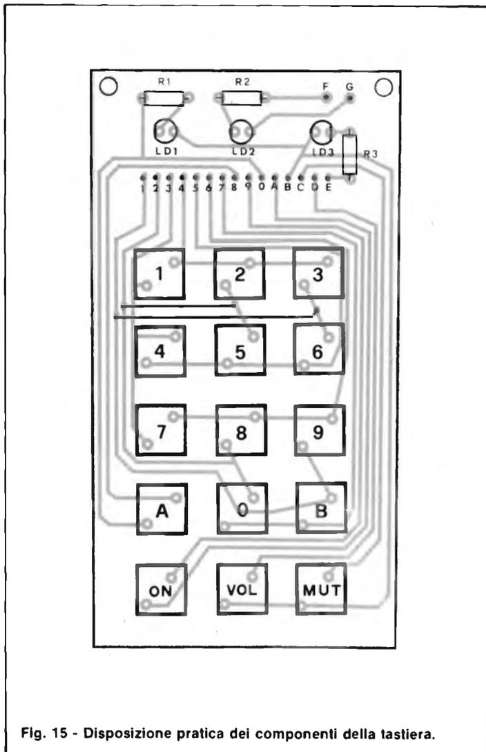
Fig. 15 - Disposizione pratica dei componenti della tastiera.
