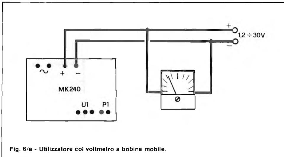
Fig. 6/a - Utilizzatore col voltmetro a bobina mobile.
