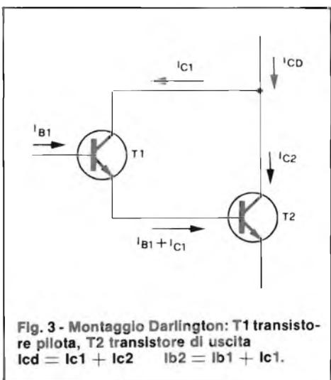
Fig. 3 - Montaggio Darlington: T1 transistor pilota, T2 transistor di uscita
