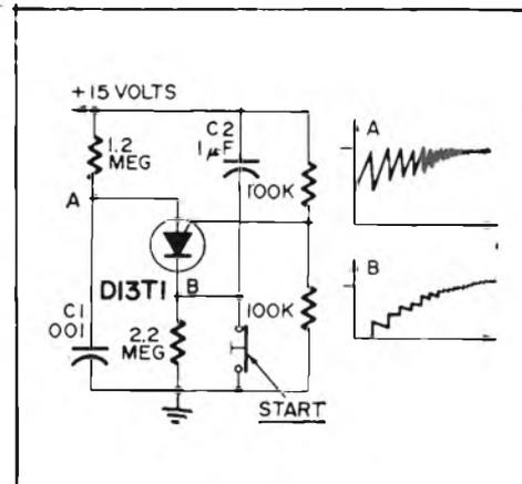
**Fig. 5 - Oscillatore audio PUT che genera un segnale "pigolante".**
