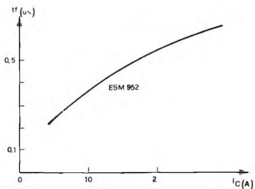
Fig. 8 - Variazione del tempo di discesa  $t_f$  con livello di corrente.
