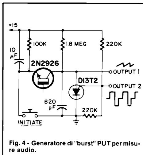
Fig. 4 - Generatore di "burst" PUT per misure audio.
