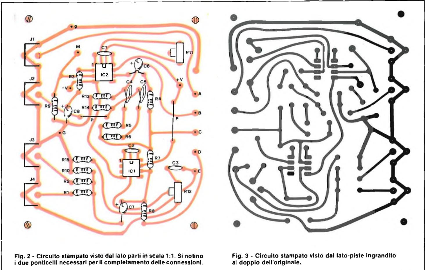
Fig. 2 - Circuito stampato visto dal lato parti in scala 1:1. Si notino i due ponticelli necessari per il completamento delle connessioni.
