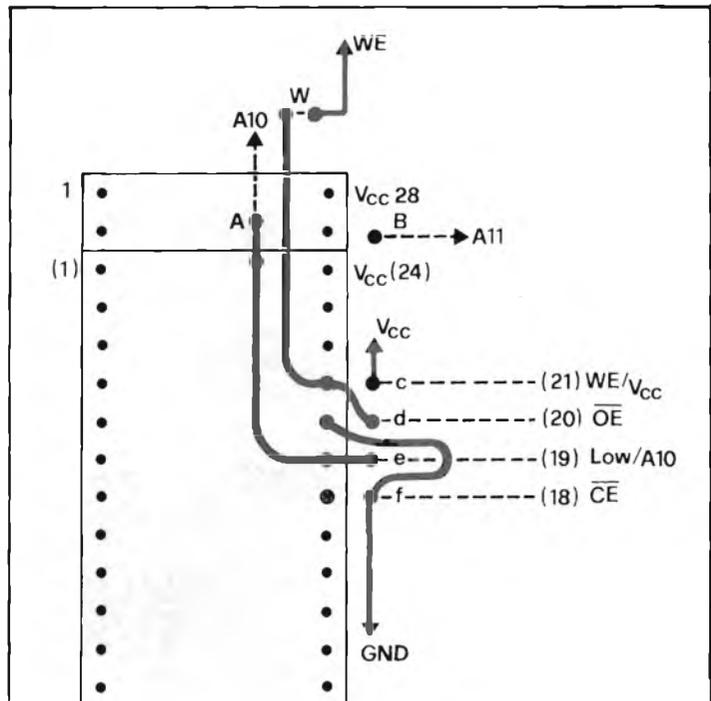
Fig. 3 - Zoccolo di collegamento memorie Eprom o Ram in cui si evidenziano le differenze tra i componenti a 24 pin e quelli a 28 pin (la numerazione del 24 pin e quelli a 28 pin (la numerazione del 24 pin è indicata tra parentesi).
