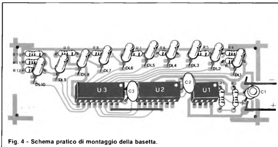
Fig. 4 - Schema pratico di montaggio della basetta.
