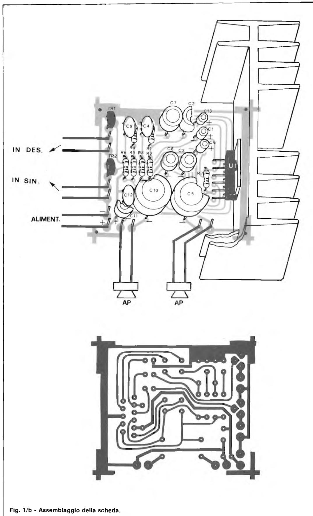
Fig. 1/b - Assemblaggio della scheda.
