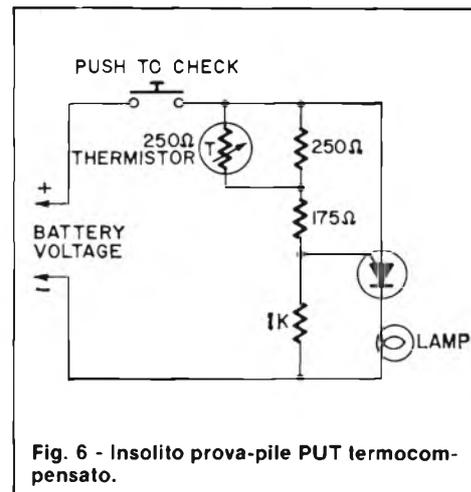
**Fig. 6 - Insolito prova-pile PUT termocompensato.**
