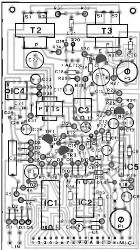
Fig. 13 - Disposizione pratica dei componenti dell'Andropov.
