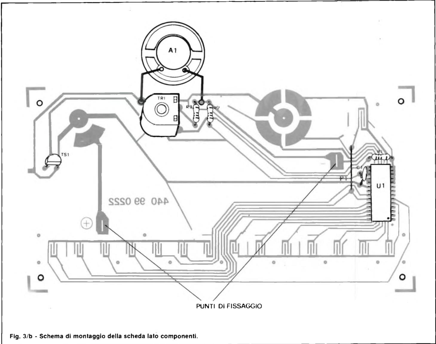
Fig. 3/b - Schema di montaggio della scheda lato componenti.
