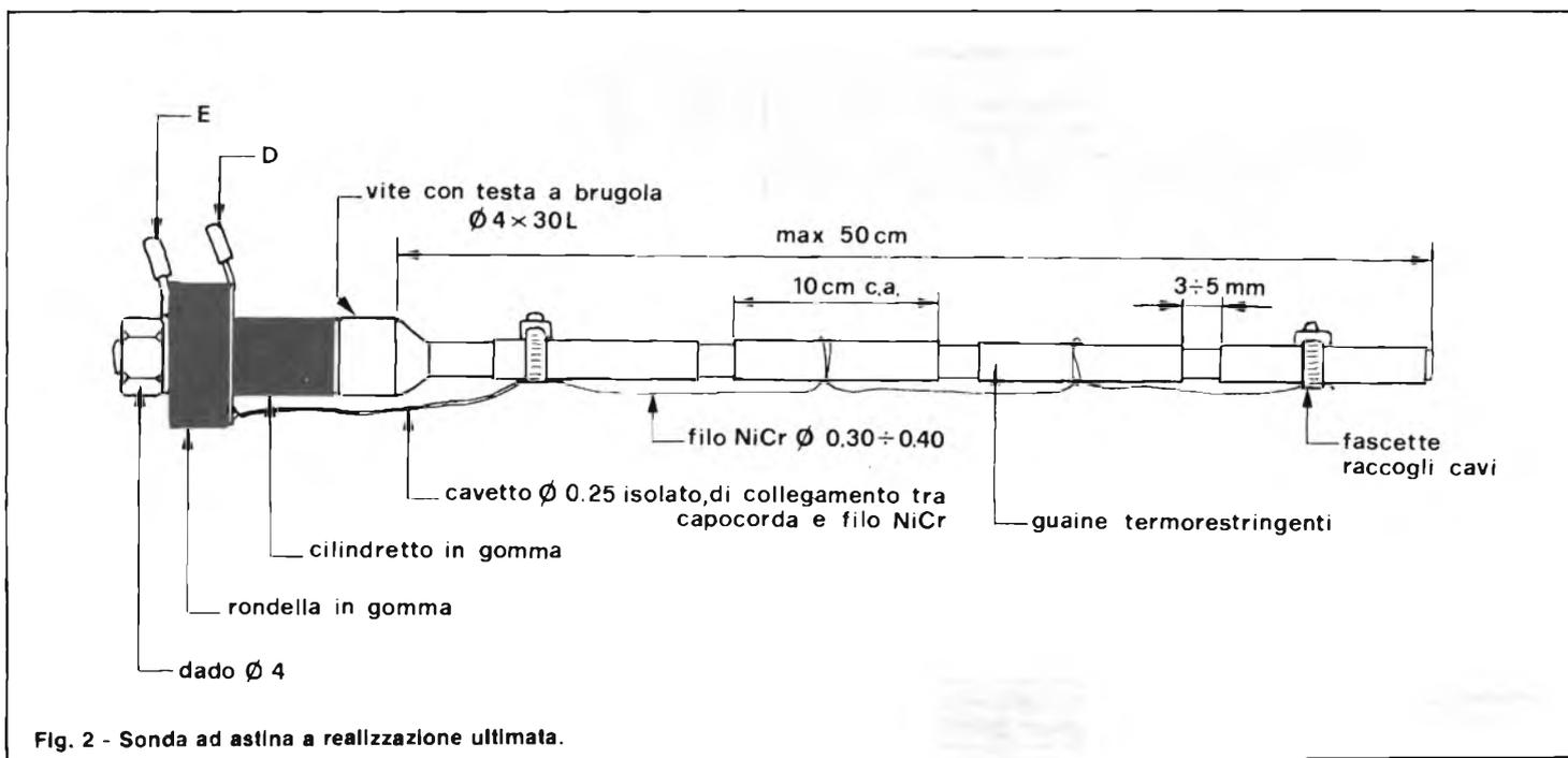
Fig. 2 - Sonda ad astina a realizzazione ultimata.
