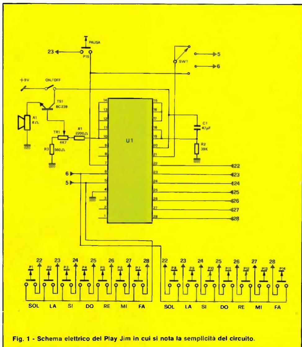
Fig. 1 - Schema elettrico del Play Jim in cui si nota la semplicità del circuito.
