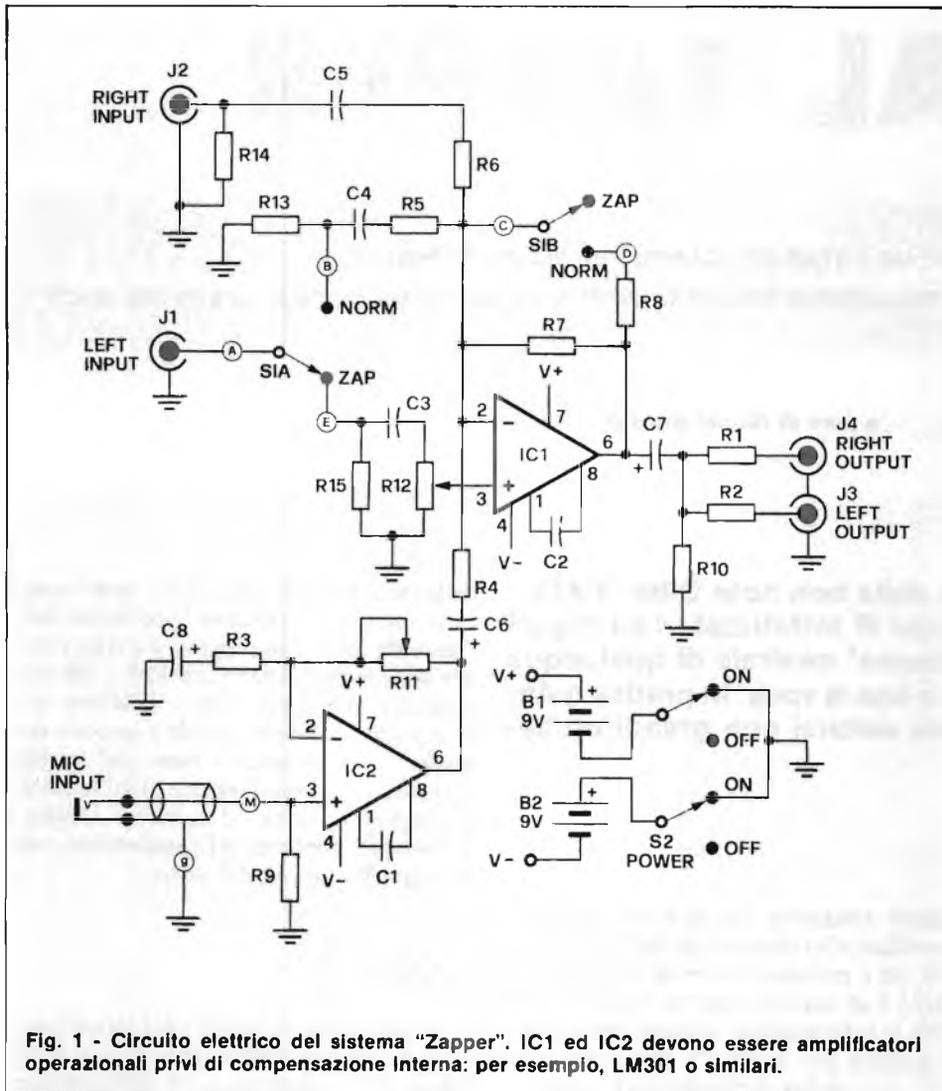
Fig. 1 - Circuito elettrico del sistema "Zapper". IC1 ed IC2 devono essere amplificatori operazionali privi di compensazione interna: per esempio, LM301 o similari.
