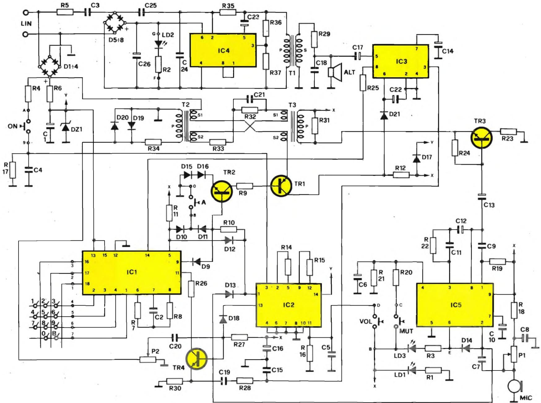
Fig. 12 - Schema elettrico completo del telefono.
