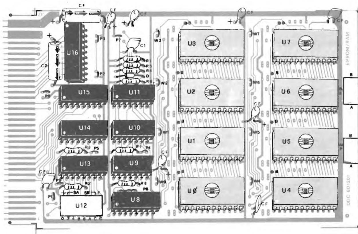
Fig. 4 - Schema di montaggio della scheda Eprom - Ram.
