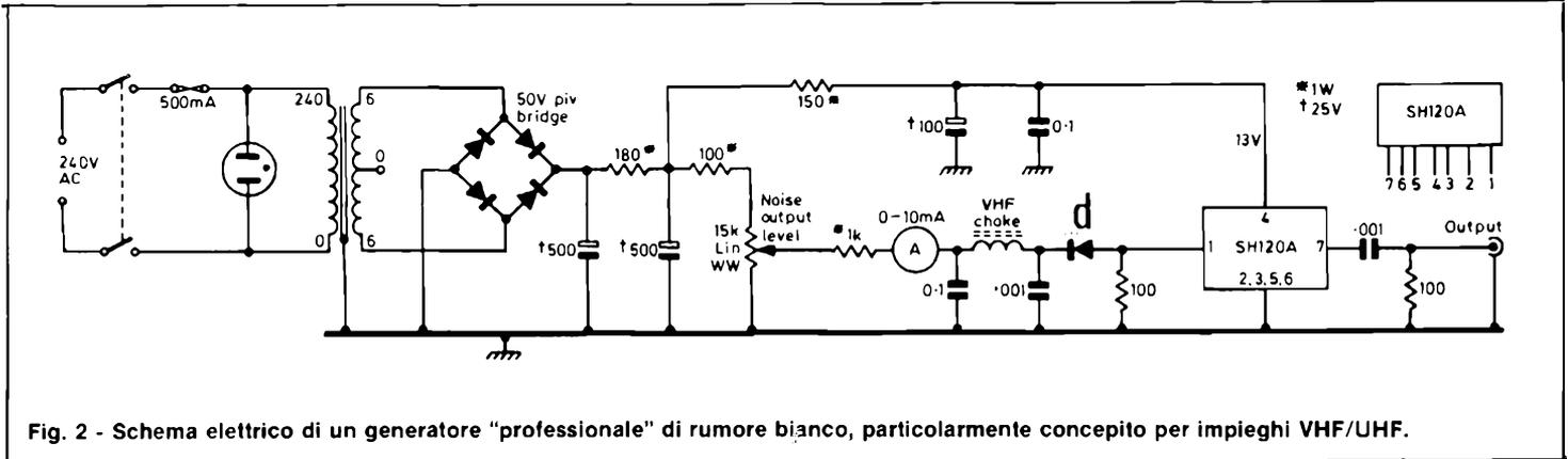
Fig. 2 - Schema elettrico di un generatore "professionale" di rumore bianco, particolarmente concepito per impieghi VHF/UHF.
