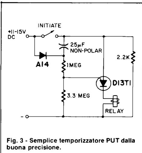
Fig. 3 - Semplice temporizzatore PUT dalla buona precisione.
