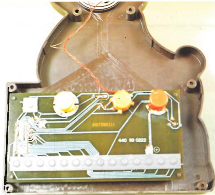
Foto 1 - Vista interna dello strumento, si noti il montaggio del corpo dei pulsanti.
