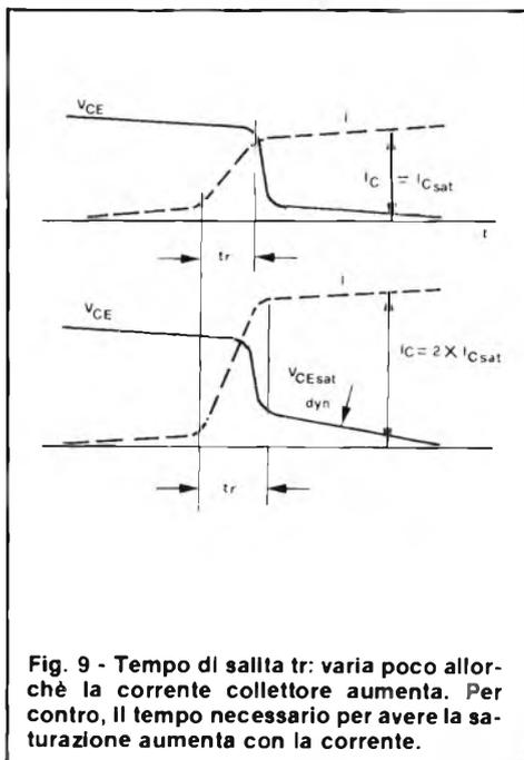
Fig. 9 - Tempo di salita tr: varia poco allorchè la corrente collettore aumenta. Per contro, il tempo necessario per avere la saturazione aumenta con la corrente.
