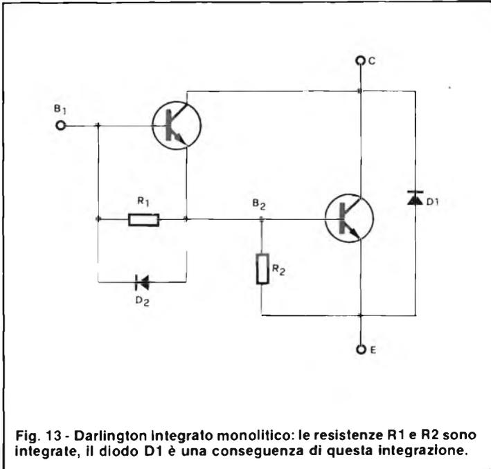
Fig. 13 - Darlington Integrato monolitico: le resistenze R1 e R2 sono integrate, il diodo D1 è una conseguenza di questa integrazione.
