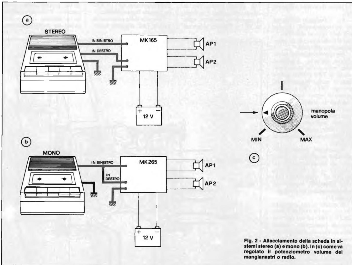
Fig. 2 - Allacciamento della scheda in sistemi stereo (a) e mono (b). In (c) come va regolato il potenziometro volume del mangianastri o radio.
