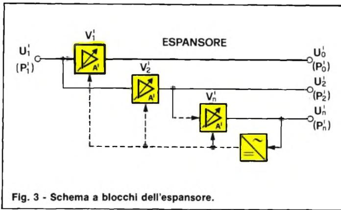
Fig. 3 - Schema a blocchi dell'espansore.
