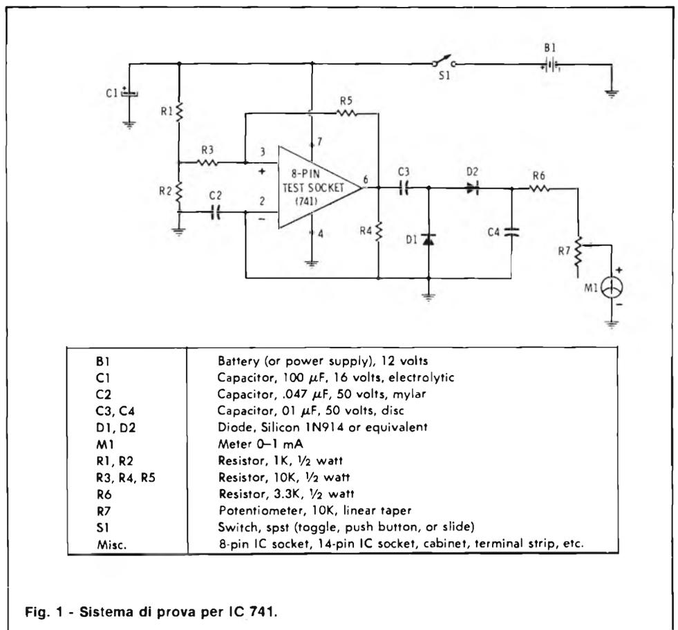
Fig. 1 - Sistema di prova per IC 741.
