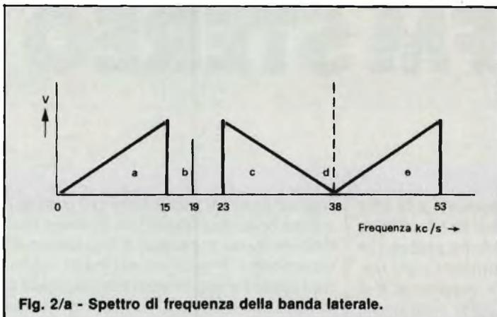
Fig. 2/a - Spettro di frequenza della banda laterale.
