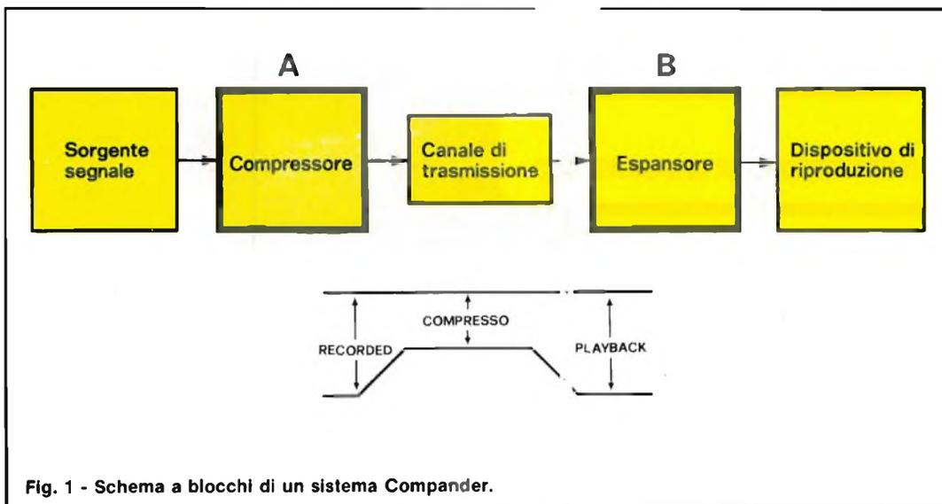
Fig. 1 - Schema a blocchi di un sistema Compander.
