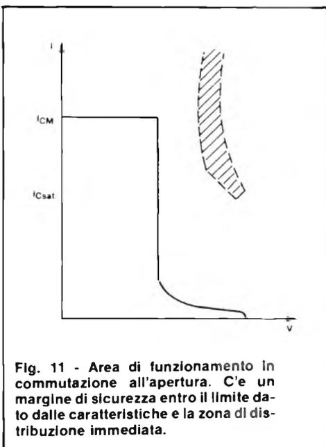
Fig. 11 - Area di funzionamento in commutazione all'apertura. C'è un margine di sicurezza entro il limite dato dalle caratteristiche e la zona di distribuzione immediata.
