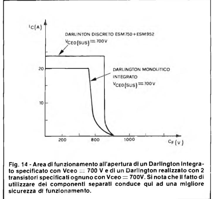
Fig. 14 - Area di funzionamento all'apertura di un Darlington Integrato specificato con  $V_{CE0} = 700V$  e di un Darlington realizzato con 2 transistori specificati ognuno con  $V_{CE0} = 700V$ . Si nota che il fatto di utilizzare dei componenti separati conduce qui ad una migliore sicurezza di funzionamento.
