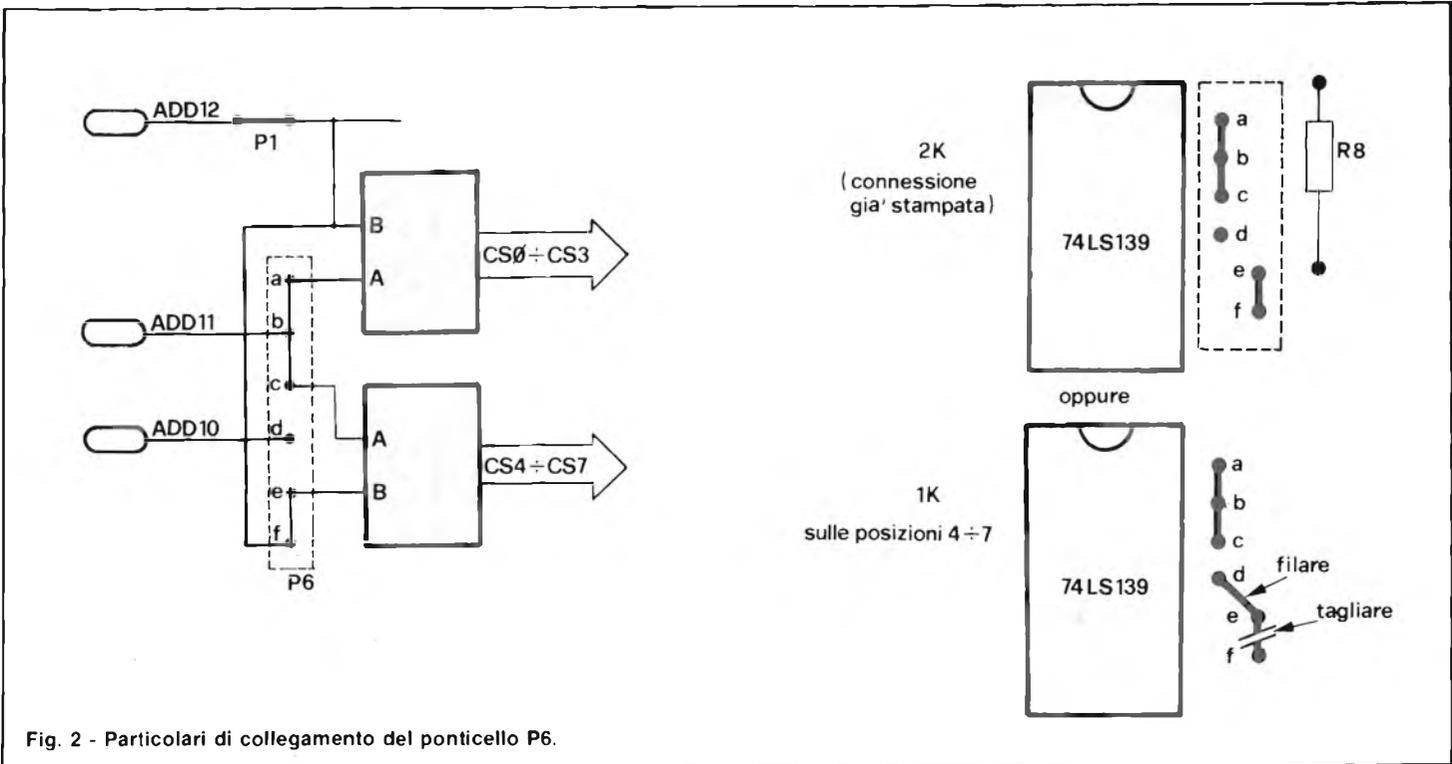
Fig. 2 - Particolari di collegamento del ponticello P6.
