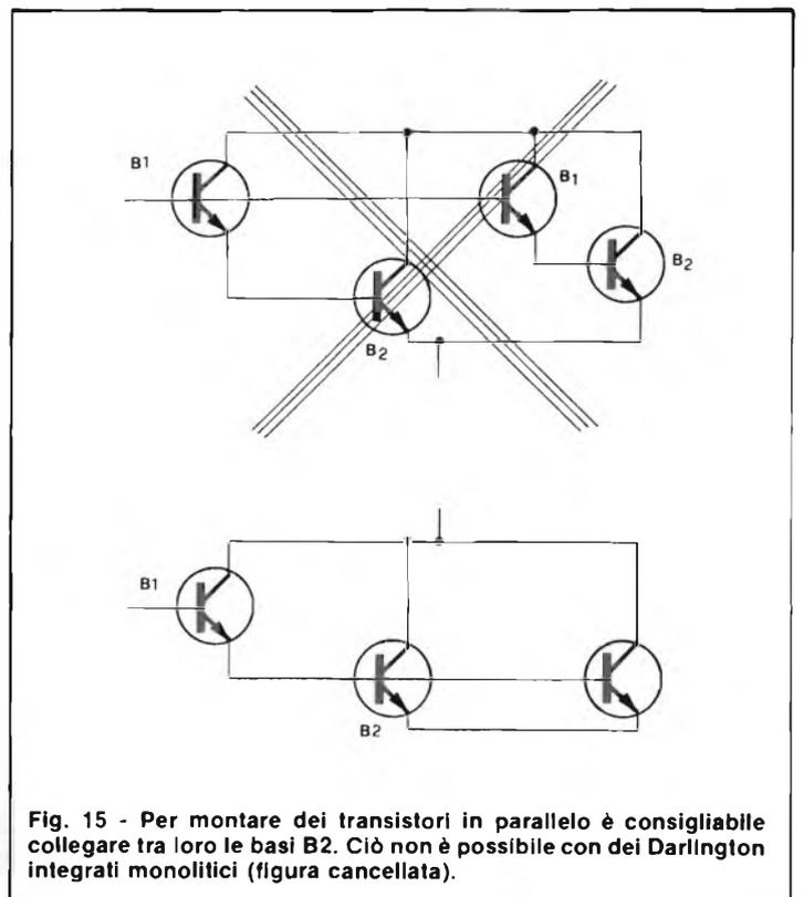
Fig. 15 - Per montare dei transistori in parallelo è consigliabile collegare tra loro le basi B2. Ciò non è possibile con dei Darlington integrati monolitici (figura cancellata).
