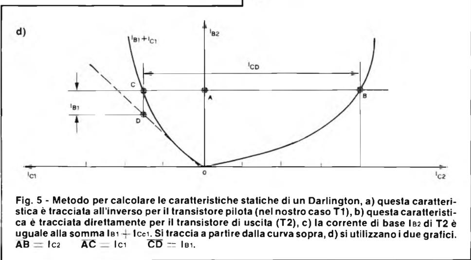
Fig. 5 - Metodo per calcolare le caratteristiche statiche di un Darlington, a) questa caratteristica è tracciata all'inverso per il transistor pilota (nel nostro caso T1), b) questa caratteristica è tracciata direttamente per il transistor di uscita (T2), c) la corrente di base  $I_{B2}$  di T2 è uguale alla somma  $I_{B1} + I_{C1}$ . Si traccia a partire dalla curva sopra, d) si utilizzano i due grafici.  $AB = I_{C2}$      $AC = I_{C1}$      $CD = I_{B1}$ .
