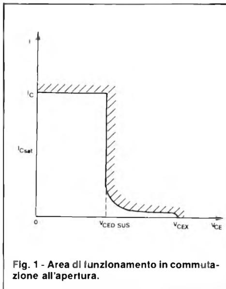
Fig. 1 - Area di funzionamento in commutazione all'apertura.
