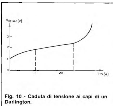
Fig. 10 - Caduta di tensione ai capi di un Darlington.
