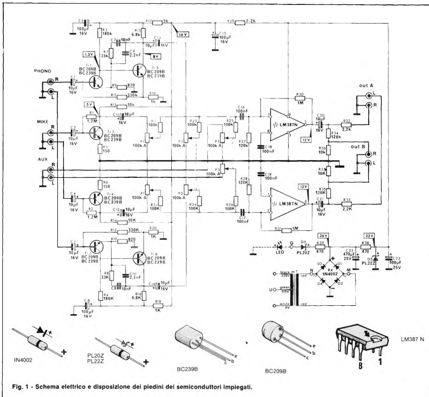
Fig. 1 - Schema elettrico e disposizione dei piedini dei semiconduttori impiegati.
