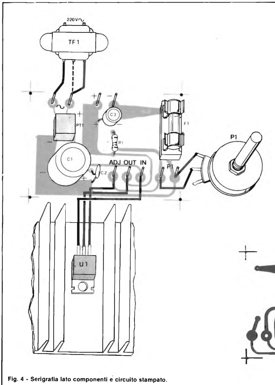
Fig. 4 - Serigrafia lato componenti e circuito stampato.
