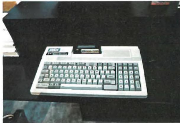
Il nuovo modello SV 728 della Spectravideo si uniforma al nuovo standard giapponese MSX che prevede specifiche tecniche identiche per tutti i computer.
