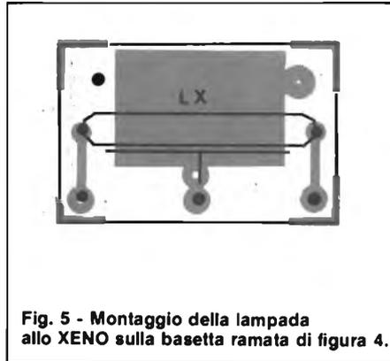
Fig. 5 - Montaggio della lampada allo XENO sulla basetta ramata di figura 4.
