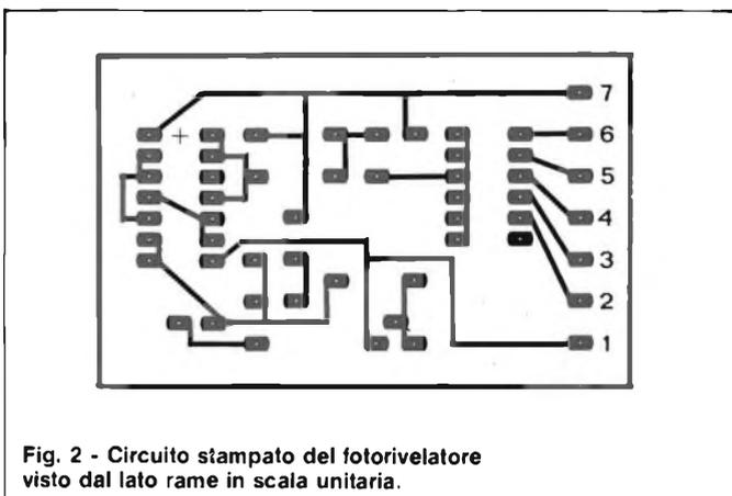
Fig. 2 - Circuito stampato del fotorivelatore visto dal lato rame in scala unitaria.
