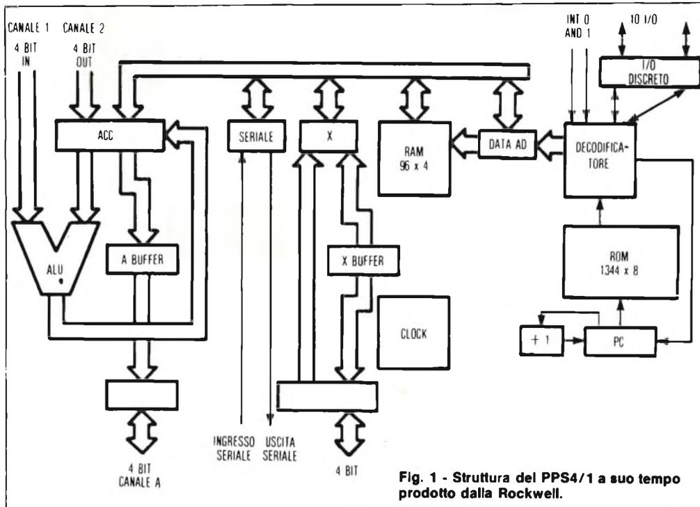
Fig. 1 - Struttura del PPS4/1 a suo tempo prodotto dalla Rockwell.
