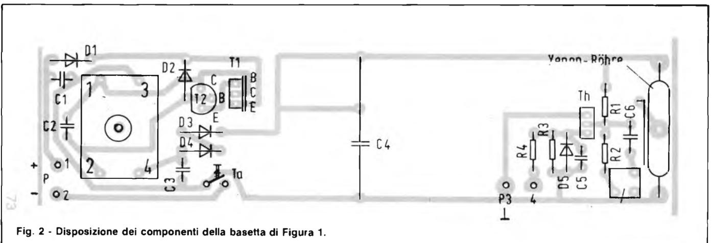
Fig. 2 - Disposizione dei componenti della basetta di Figura 1.
