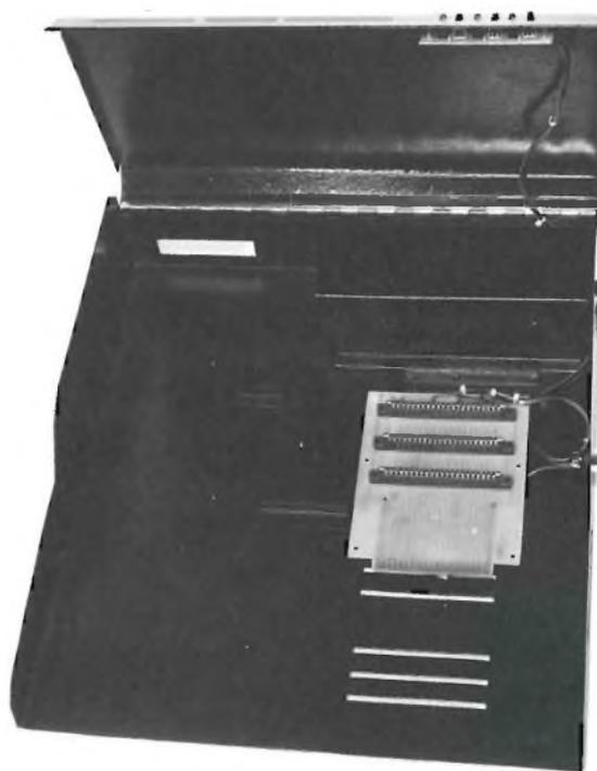
La "mother board" è trattenuta al fondello in modo che il pettine stampato si innesti senza sforzo nel connettore della porta di espansione del VIC.
