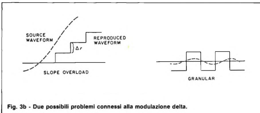
Fig. 3b - Due possibili problemi connessi alla modulazione delta.
