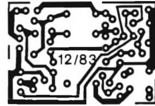
Fig. 2 - Circuito stampato visto dal lato rame in scala 1:1.
