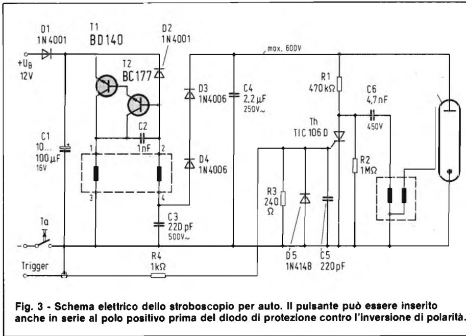
Fig. 3 - Schema elettrico dello stroboscopio per auto. Il pulsante può essere inserito anche in serie al polo positivo prima del diodo di protezione contro l'inversione di polarità.
