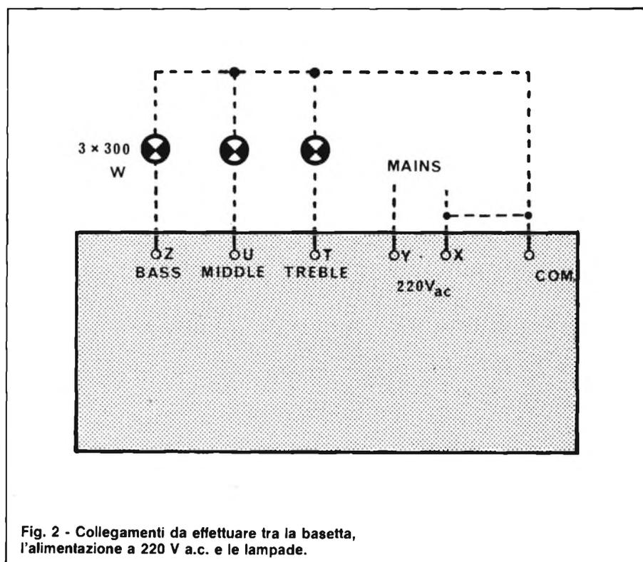
**Fig. 2 - Collegamenti da effettuare tra la basetta, l'alimentazione a 220 V a.c. e le lampade.**
