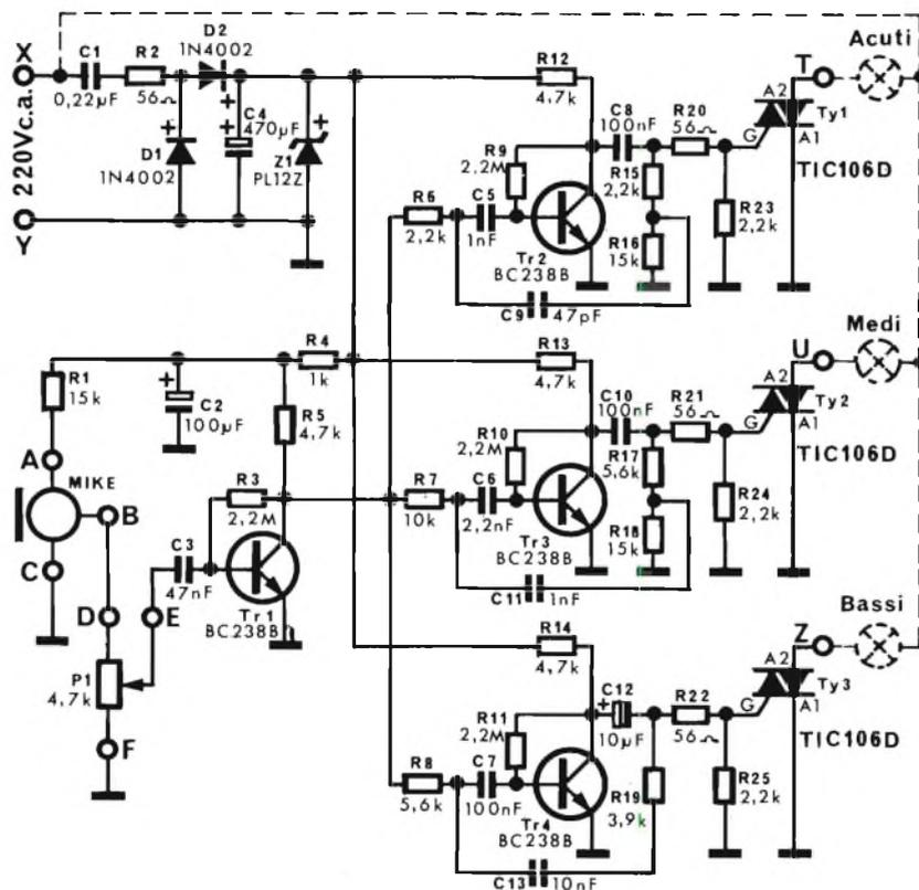
Fig. 1 - Schema elettrico delle luci psichedeliche microfoniche a 3 vie - 1 kW.
