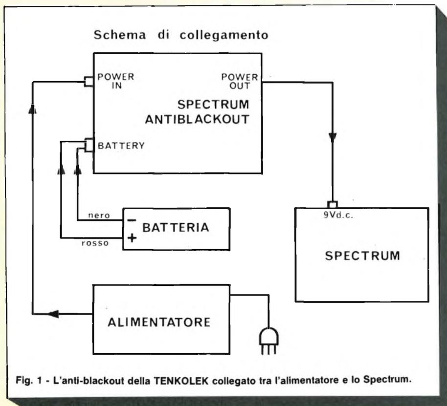
Fig. 1 - L'anti-blackout della TENKOLEK collegato tra l'alimentatore e lo Spectrum.
