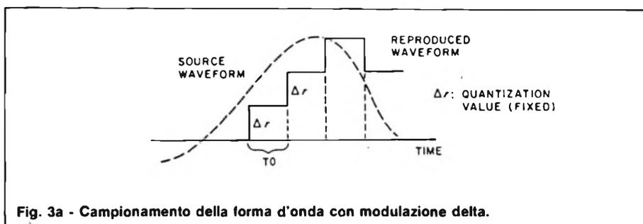
Fig. 3a - Campionamento della forma d'onda con modulazione delta.
