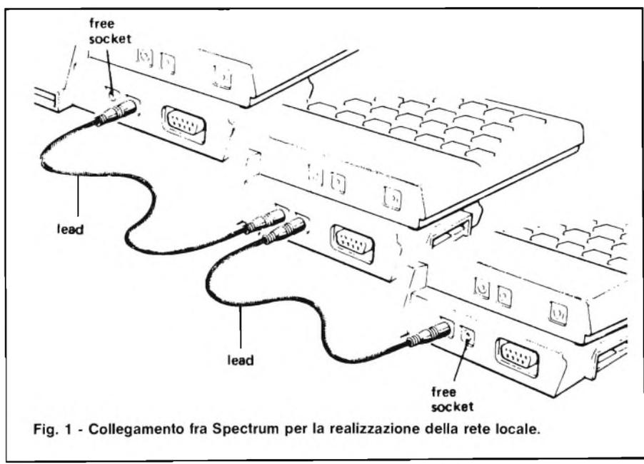
Fig. 1 - Collegamento fra Spectrum per la realizzazione della rete locale.
