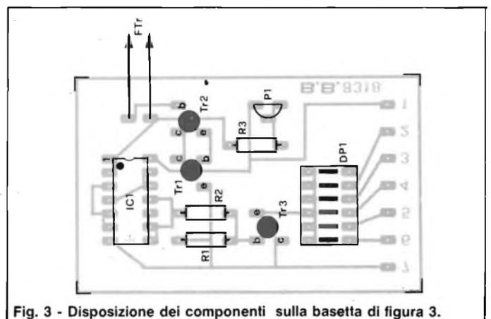
Fig. 3 - Disposizione dei componenti sulla basetta di figura 3.
