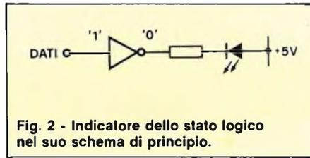
Fig. 2 - Indicatore dello stato logico nel suo schema di principio.
