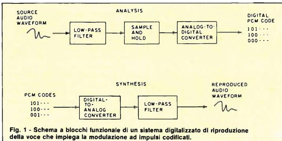
Fig. 1 - Schema a blocchi funzionale di un sistema digitalizzato di riproduzione della voce che impiega la modulazione ad impulsi codificati.
