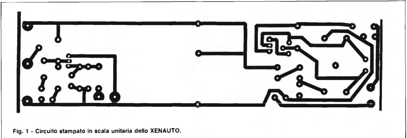
Fig. 1 - Circuito stampato in scala unitaria dello XENAUTO.
