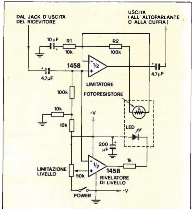
Forse la più interessante caratteristica di questo circuito limitatore audio è che esso può essere impiegato con qualsiasi ricevitore, sia esso un ricevitore ad onde corte a valvole od un moderno scanner a stato solido. Le vostre
