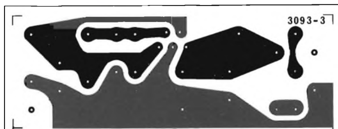
Fig. 2 - Basetta stampata vista dal lato rame in scala naturale. La larghezza delle piste permette senza difficoltà il passaggio di alte correnti.
