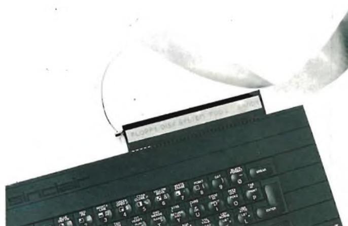
**Il disc drive si collega molto facilmente allo Spectrum con l'interposizione dell'apposita interfaccia, che si innesta direttamente nel connettore della user port.**
