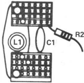
UNDERSIDE OF BOARDS AROUND L1
